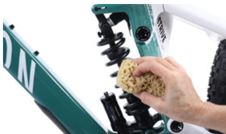
Reiniging van de demper met een spons en water
