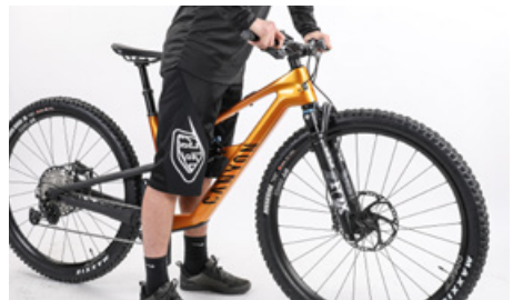
Druk de vork bij aangetrokken voorwielrem omlaag
