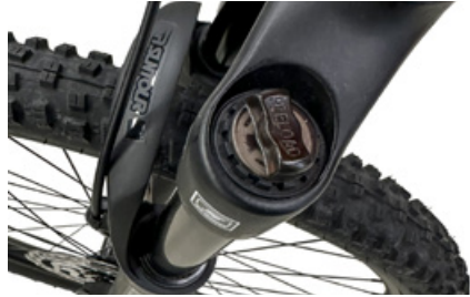
Voorspanning vork met stalen veren
