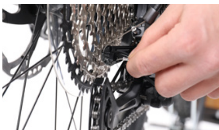
Vervolgens kun je de bowdenkabel met de hand opspannen
