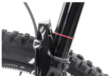
Aan de hand van de verschoven kabelbinder kun je de gebruikte veerweg meten
