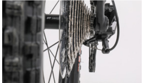
Bekijk de tandkranscassette van de achterkant en controleer of de geleidewieltjes van de achterderailleur precies onder de tandpunten van het juiste rondsel liggen
