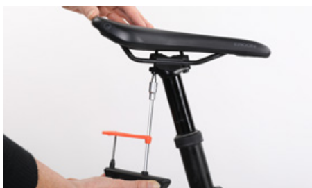
Draai de bouten afwisselend en gelijkmatig aan met het voorgeschreven aanhaalmoment
