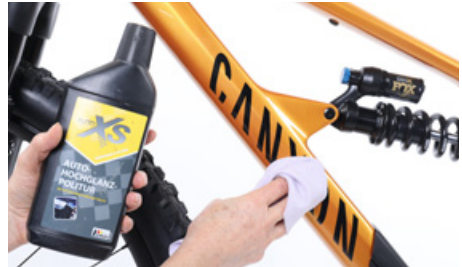
Lak en metaaloppervlakken met harde was conserveren
