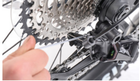
Voor het instellen van de afstand tussen de wieljesbehuizing en de tandkrans verdraai je de bout die op de voorkant van de uitvalpad steunt
