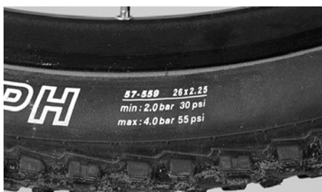
Opgave luchtdruk op de zijkant van de band
