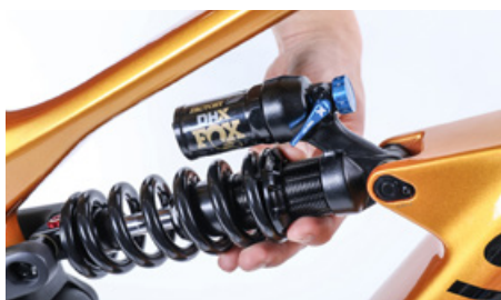
Bij stalen veren draai je aan de gekartelde instelring om de veerspanning te wijzigen
