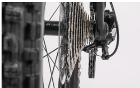
Bekijk de tandkranscasette van de achterkant en controleer of de geleidewieltjes van de achterderailleur precies onder de tandpunten van het juiste ronsel liggen
