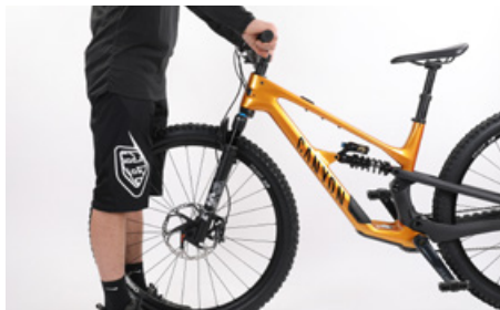
Probeer het stuur ten opzichte van het voorwiel te verdraaien
