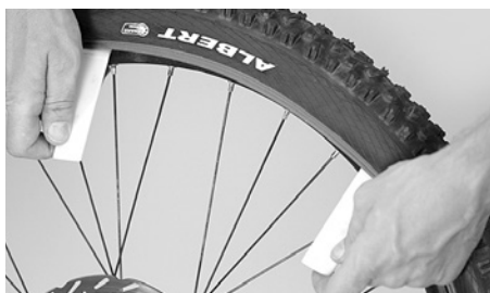
Plaatsen van de bandenlichter en lichten van de zijkant van de band over de rand van de velg
