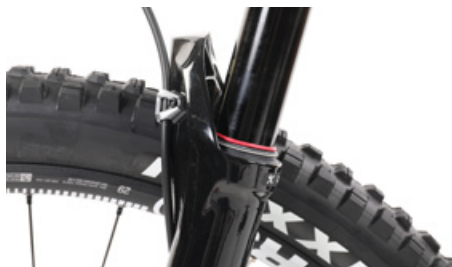
Trek een kabelbinder over de binnenpoot
