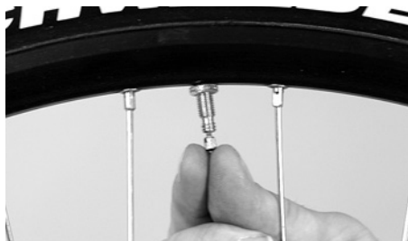
Bij een race- of sclaverandventiel moet het ventiel worden opgeschroefd
