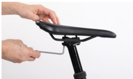
Maak beide bouten met twee tot maximaal drie slagen los
