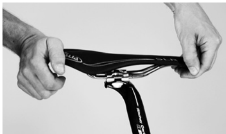
Controleer of het weer vastgeschroefde zadel kantelt
