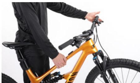
Controleer de soepele loop van het lager door het voorwiel op te tillen en te kijken of het heel soepel draait
