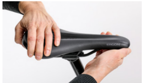
Probeer het zadel ten opzichte van het frame te verdraaien
