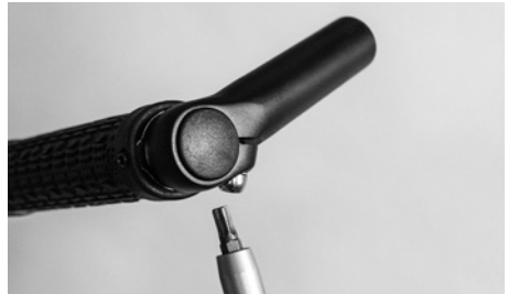
Draai de bouten met het vereiste aanhaalmoment weer vast
