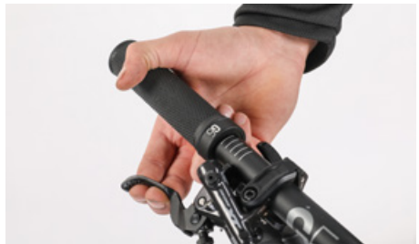
Je mag de remgreep niet tot aan het stuur kunnen doortrekken
