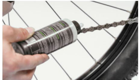
Smeer de ketting na afloop van de reinigingswerkzaamheden
