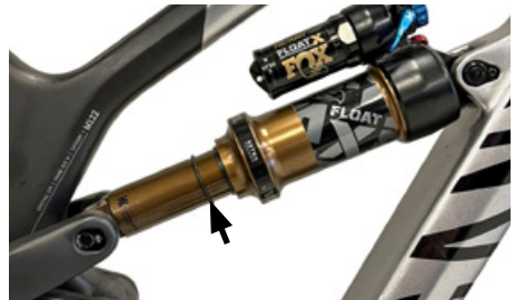
De verschoven O-ring op de demper geeft de gebruikte veerweg aan
