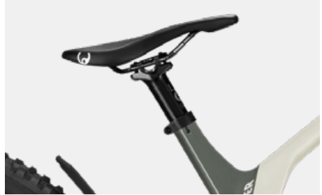
Bij freeriden etc. is het zadel gewoonlijk naar achteren gekanteld
