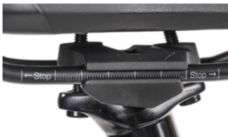
Stel het zadel zo af dat het zadelframe binnen de markeringen wordt geklemd
