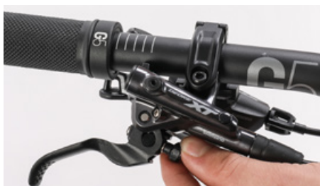
Instellen van de greepafstand van de remgrepen
