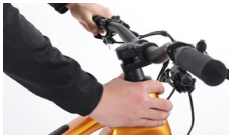
Controleer de speling in het stuurlager door de vingers om de lagerschaal te leggen en de Canyon met aangetrokken remmen voor- en achteruit te duwen
