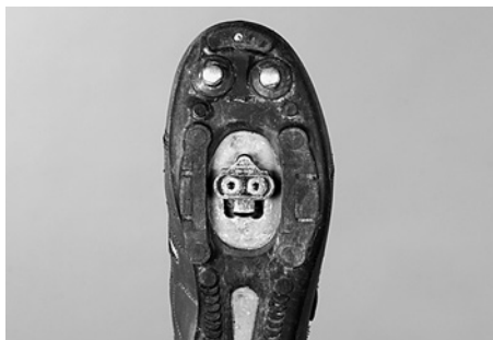
In de zolen zijn kleine schoenplaatjes ("cleats") geïntegreerd
