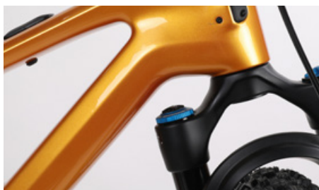
De vorkkop moet zonder iets te raken onder het frame kunnen draaien
