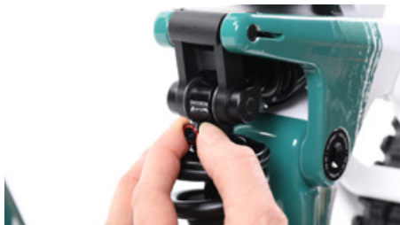
Rebounddemping aan de demper
