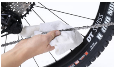
Verwijder met een doek vuil en olie van de ketting
