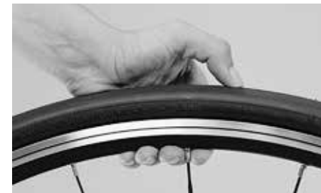
Překontrolujte tlak vzduchu v pláštích
