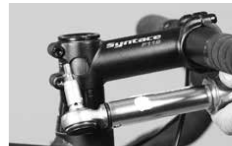
Překontrolujte boční utahovací šrouby představce momentovým klíčem podle natištěných údajů
