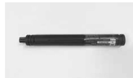
Di2 baterie může být zamontována také skrytá v dolní rámové trubce
