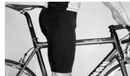
Výška nad horní rámovou trubkou musí poskytovat dostatečnou volnost v kroku
