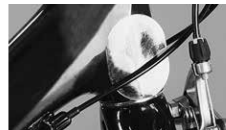
Speciální nálepky chrání karbon proti poškození
