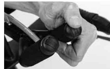
Řadící páčky na koncích řídítek ovládají přehazovačku a přední měnič
