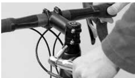
Boční utahovací šrouby představce opět pevně utáhněte momentovým klíčem
