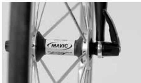
Páka rychloupínáku musí ležet přibližně paralelně s kolem a nesmí bočně odstávat
