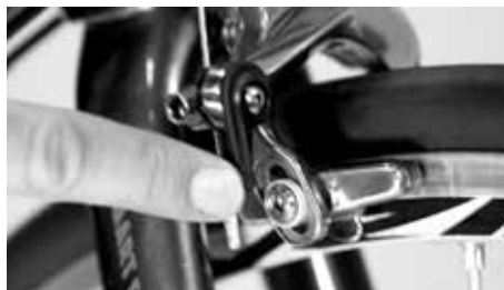
Kontrola neházigosti pomocí brzdových obložení
