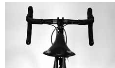
Pohlédněte přes sedlo podél horní rámové trubky, abyste si ověřili, že nestojí šikmo
