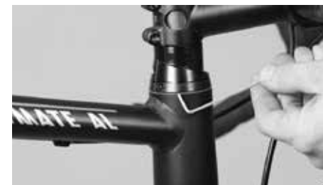
Seřídte vůli ložiska bočním stavěcím šroubem
