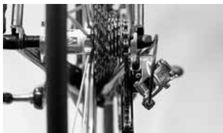
Před demontáží zadního kola přeřadit na nejmenší pastorek
