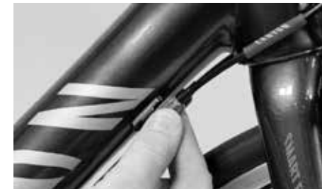
Dodatečné napnutí lanka řazení regulačním šroubem na rámu
