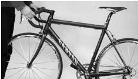
Pokuste se otočit řídítka vůči přednímu kolu a vůči představci
