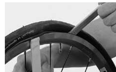
Nasazení páčidla a vypáčení boku pláště přes okraj ráfku
