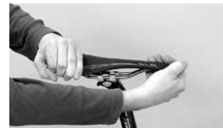
Pokuste se sedlo v rámu otočit
