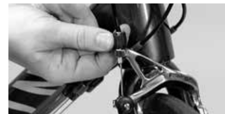
Zdvih brzdy naprázdno se nastavuje rýhovanou maticí
