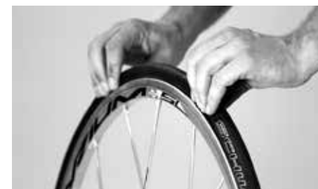
Stlačte plášť, abyste se ujistili, že není duše uskřípnutá
