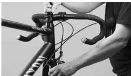
Nasaďte víko uzávěru a stiskněte je směrem k přidržené vidlici a poté vyrovnaný představec opět pevně utáhněte předepsaným utahovacím momentem
