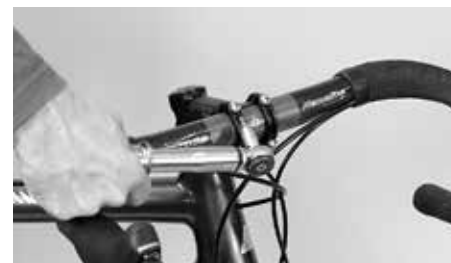
Předepsaným utahovacím momentem šrouby opět pevně utáhněte
