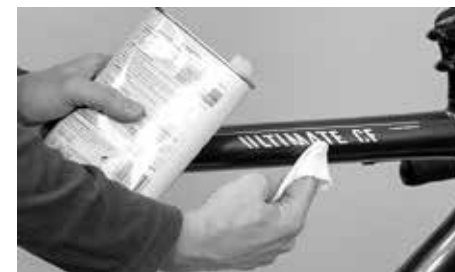
Konzervování laku a kovových povrchů tvrdým voskem
