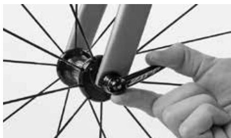
Překontrolujte upevnění tak, že se pokusíte zavřenou páku otočit
