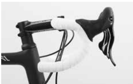
Přímá část dolní části řídítek má být paralelně se zemí nebo ukazovat lehce směrem dolů
