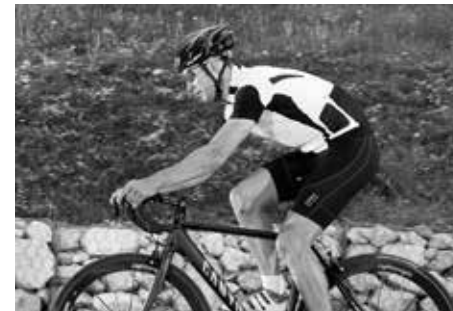
Vzdálenost mezi rukojetěmi řídítek a sedlem ovlivňuje sklon zad
