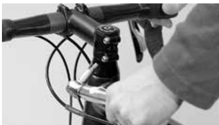
Potom představec opět pevně utáhněte předepsaným utahovacím momentem
