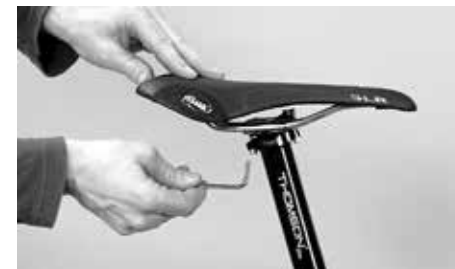
Povolte oba šrouby o dvě až maximálně tři otáčky
