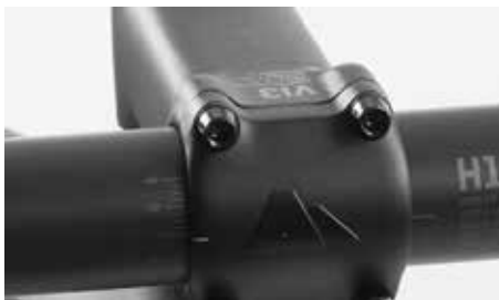
Horní štěrbina se musí úplně uzavřít
