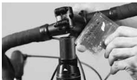
Navlhčete sloupek vidlice karbonovou montážní pastou
