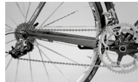
Odstavit kolo s řetězem na nejmenším pastorku a malém převodníku
