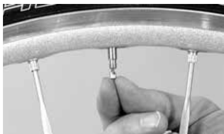
U závodních či Sclaverand ventilků je nutné ventilek našroubovat
