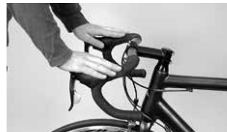
Řídítka se nesmí ani po silném trnutí pootočit
