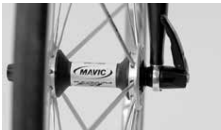
Překontrolujte, zda jsou obě kola stále ještě pevně uchycena v patkách
