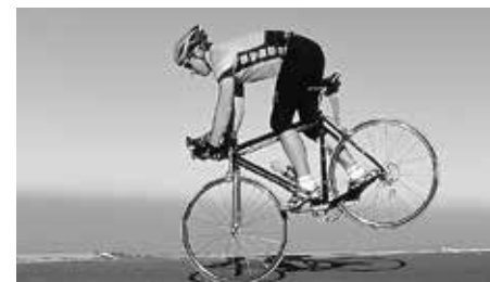
Při brzdění se přesune váha zezadu dopředu
