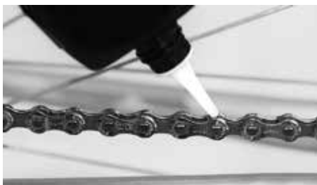
Naneste na pokud možné holé články řetězu řetězový olej
