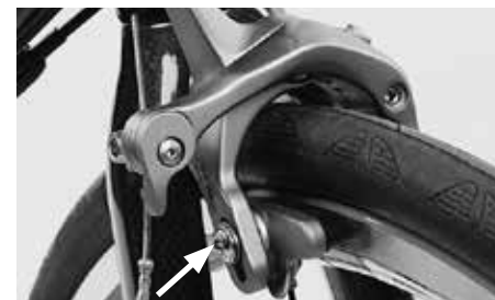
Pro změnu výšky utáhněte upevňovací šroub špalíku pevně předepsaným utahovacím momentem
