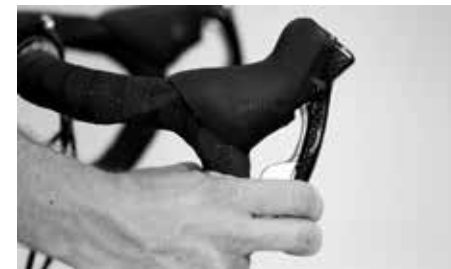
Páka brzdy se při stisknutí nesmí dotýkat řídítek
