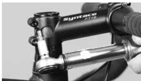
Všechny utahovací šrouby představce utáhněte momentovým klíčem podle předepsaných hodnot
