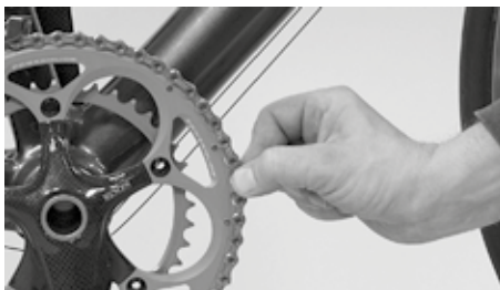
Kontrola stavu řetězu
