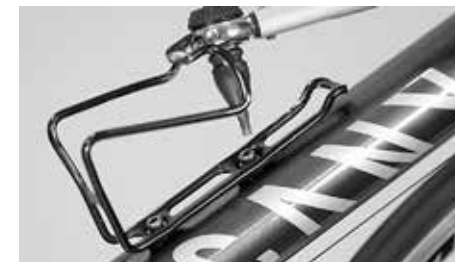
U držáku láhve dodržujte maximální utahovací moment 2 Nm
