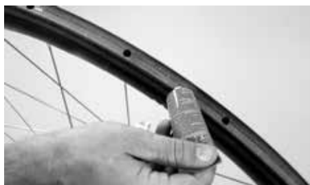
Nanášení lepidla na plášť přímo z tuby
