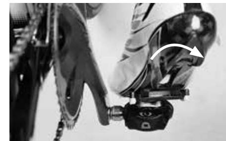
Spojení se uvolní otočením paty směrem ven
