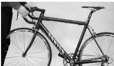
Pokuste se otočit řídítka vůči přednímu kolu
