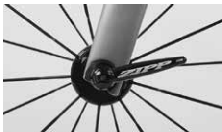
V koncové poloze musí páka svírat pravý úhel s rychloupínacím středovým hřídelem
