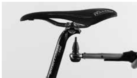
Utahujte oba šrouby střídavě a stejnoměrně, nikdy nepřekračujte maximálně přípustný utahovací moment
