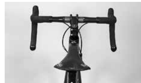
Pohlédněte přes sedlo podél horní rámové trubky, abyste si ověřili, že není zkřivený
