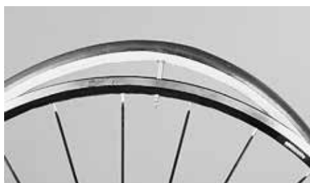
Zastrčte ventilek lehce nahuštěného pláště do otvoru pro ventilek v ráfku
