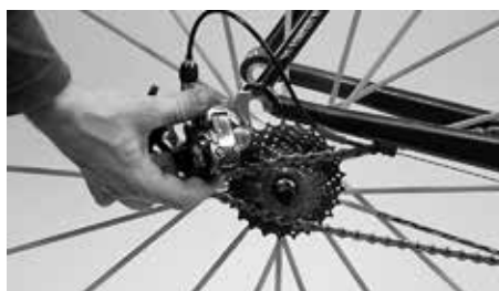
Za účelem demontáže zadního kola stáhněte přehazovačku trochu dozadu
