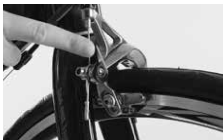
Otevření uvolňovací páky na brzdě
