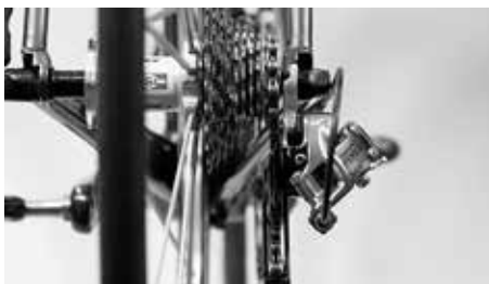
Pohlédněte zezadu na kazetu pastorků a překontrolujte, zda se vodící kladky přehazovačky nachází přesně pod špičkami zubů příslušného pastorku
