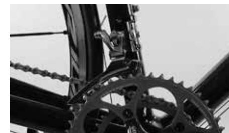
Nastavení akčního okruhu předního měniče
