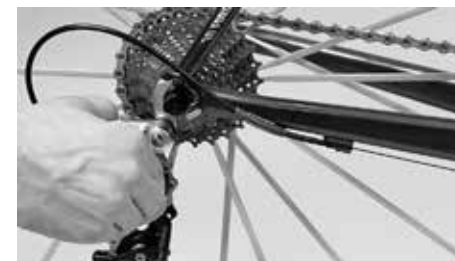
Překontrolujte, zda se může přehazovačka dostat do paprsků kola
