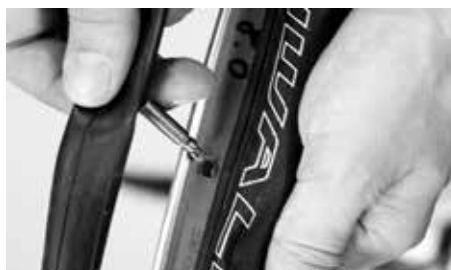
Zastrčit ventilek do otvoru v ráfku
