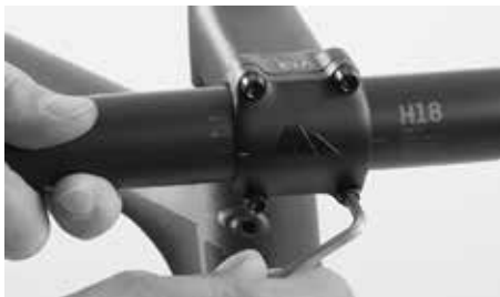
Povolte inbusový/é šroub/y na přední straně představce
