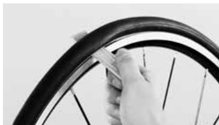
Pomocí montážní páky lze plášť přes okraj ráfku vypáčit
