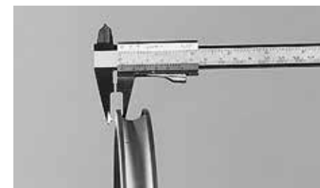
Nechte přeměřit tloušťku stěny Vašich ráfků nejpozději po 2. sadě brzdových špalíků
