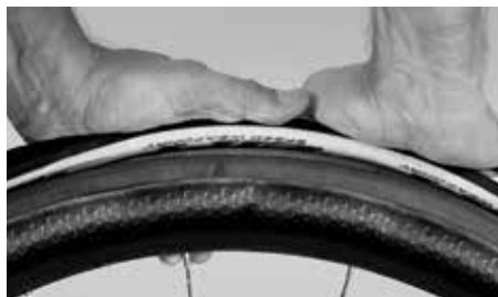
Odtlačte plášť na stranu, až vznikne mezera
