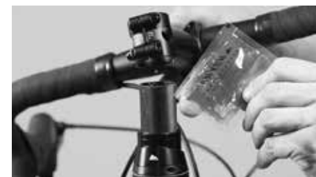
Navlhčete sloupek vidlice karbonovou montážní pastou
