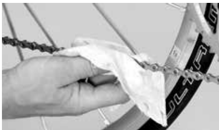
Vyčistěte řetěz od nečistoty a oleje hadrem
