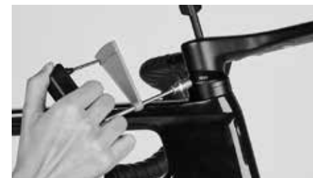
Utáhněte šroub na zadní straně čepičky hlavového složení pevně předepsaným utahovacím momentem 9 Nm
