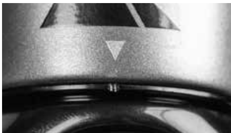
Správné nastavení jednotky IPU – šipka a drážka nad sebou
