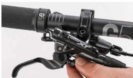
Indstilling af bremsegrebs gribebredde
