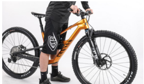
Tryk gafflen nedad med trukket forhjulsbremse
