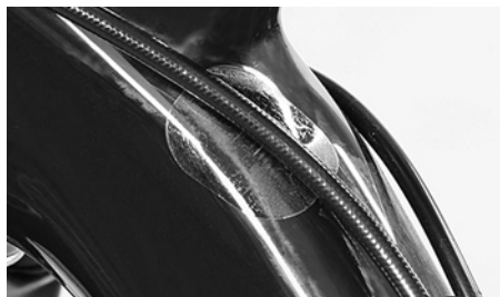
Specielle klæbemærker beskytter carbon mod beskadigelse
