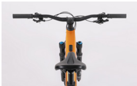
Kig hen over sadlen langs overrøret for at forvisse dig om, at sadlen ikke er kommet til at sidde skævt
