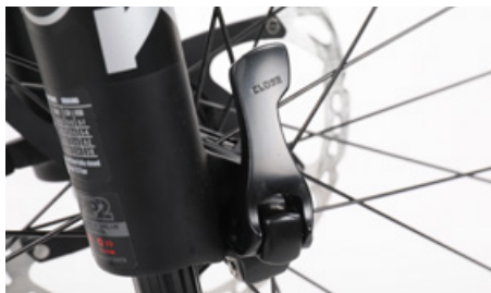
Sørg for, at quick release-spænderen sidder korrekt
