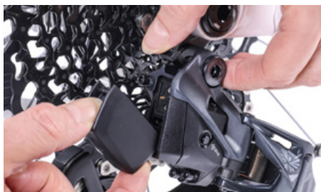
Tag SRAM-batteriet ud til opladning
