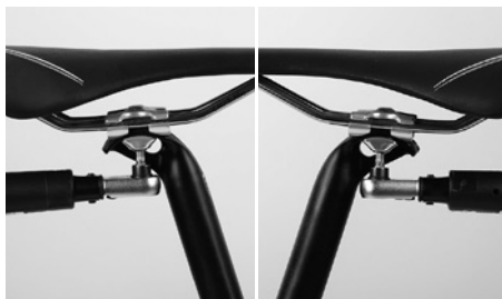
Skrue skruerne skiftevis og ensartet fast, overskrid aldrig det maksimalt tilladte tilspændingsmoment
