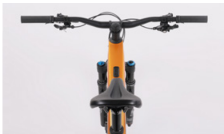
Kig hen over sadlen langs overrøret for at forvisse dig om, at sadlen ikke er kommet til at sidde skævt
