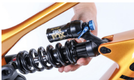
På stålfjedre drejes den riflede indstillingsring, når fjederspændingen skal ændres
