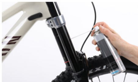
Påfør lidt godkendt smøremiddel efter rengøringen
