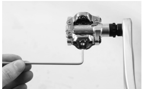
Indstil pedalens udløsningshårdhed efter dine behov
