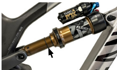
Den forskubbete O-ring på dæmperen viser den udnyttede fjedervandring
