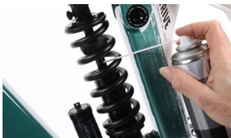
Påfør lidt godkendt smøremiddel efter rengøringen
