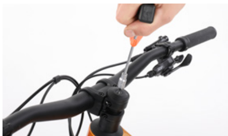
Indstil lejet på ny og spænd frempinden fast igen
