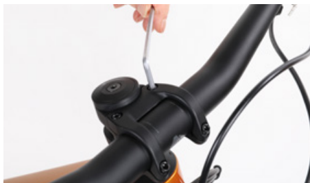
Løsn de(n) indvendige unbrakoskrue(r) på forsiden af frempinden
