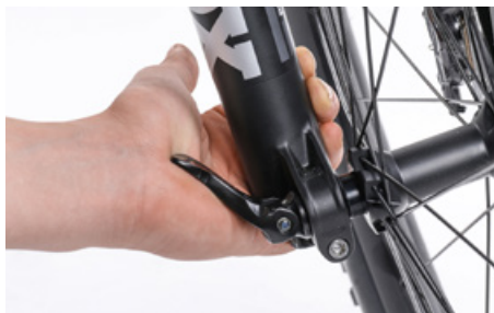
Kontrollér, om hjulene stadig er klemt sikkert fast
