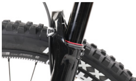
Træk en ledningsholder over inderbenet
