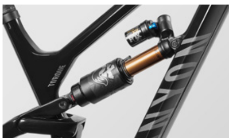
Fjederben med luftfjederelement
