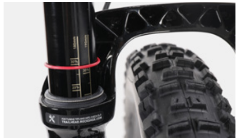
Negativ fjedervandring – "sag" på fjedergafflen
