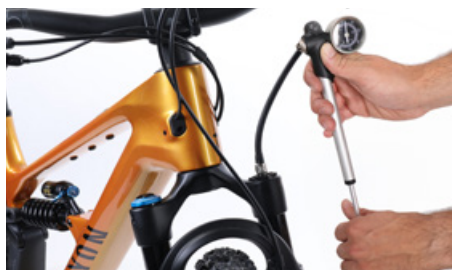
Kontroller lufttrykket regelmæssigt ved luftaffjedringer
