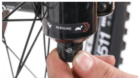
Træktrinsdæmpning forsinker udfjedringen
