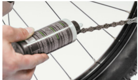
Smør kæden, når du er færdig med rengøringsarbejderne
