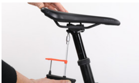
Spænd skrueene skiftevis og ensartet fast igen med det foreskrevne tilspændingsmoment
