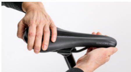
Prøv på at dreje sadlen i forhold til rammen
