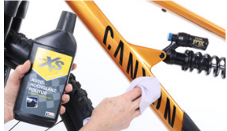
Konservering af lak og metaloverflader med hårdvoks
