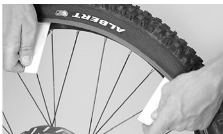
Sæt dækjernet til, og vip dæksiden ind over fælgkanten
