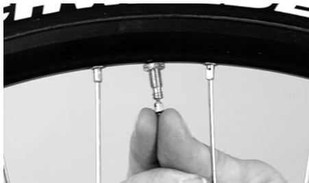
På racer- eller Sclaverand-ventiler skal ventilen skrues ud
