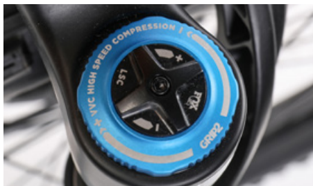
Tryktrinsdæmpning forsinker indfjedringen
