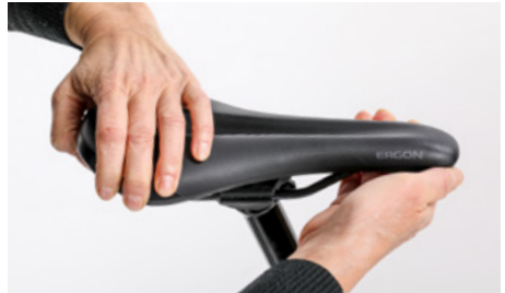
Prøv på at dreje sadlen i forhold til rammen
