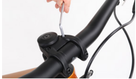
Åbn skruerne foran på frempinden
