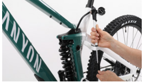
Kontroller lufttrykket regelmæssigt ved luftaffjedringer
