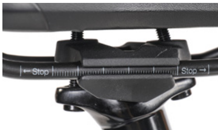
Juster sadlen, så stellet kan klemmes fast inden for markeringerne
