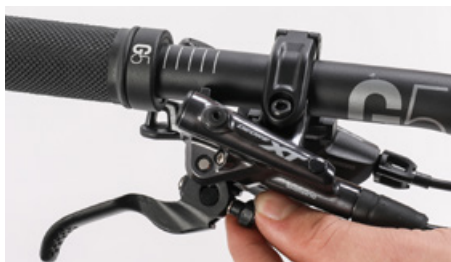
Indstilling af bremsegrebets gribebredde
