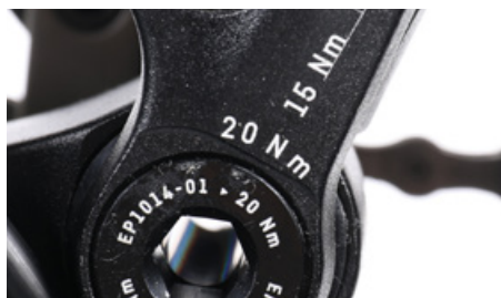
Overhold altid de angivne tilspændingsmomenter
