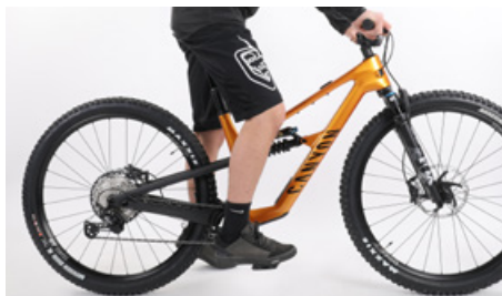
Den perfekte trædeposition: Når storetåens balle befinder sig i midten af pedalen, skal knæet være let bøjet
