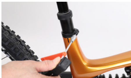
Montering med Canyon momentnøgle
