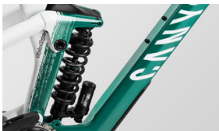
Fjederben med stålfjederelement
