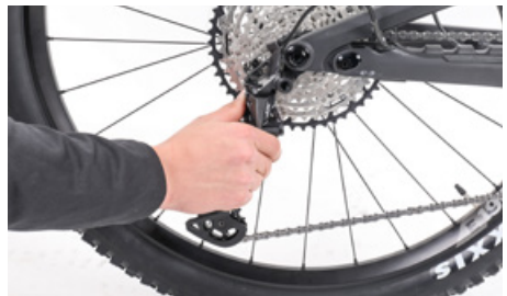
Træk bagskifteren lidt bagud, når du afmonterer baghjulet
