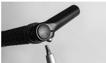
Spænd skruerne fast igen med det påkrævede tilspændingsmoment
