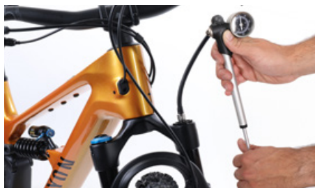
Indstilling af fjederhårdhed med en dæmperpumpe
