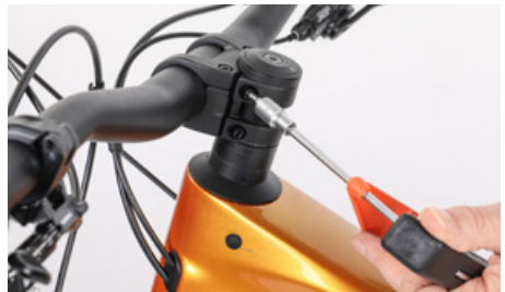
Spænd frempindsklemmskruerne i siden fast igen med momentnøglen
