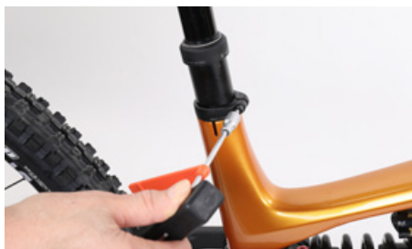
Overhold det anførte tilspændingsmoment på sadelpind-klemmen
