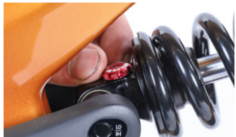
Negativ fjedervandring – "sag" på bagstiveraffjedringen
