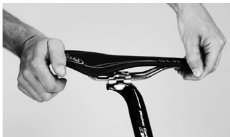
Kontrollér, om den fastskruede sadel kan vippe
