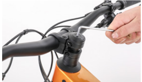
Indstil lejespillerummet med den forsænkede ovenliggende stilleskrue, når du har løsnet klemmskruerne i siden
