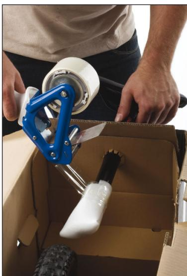
22. Stecke jetzt die Sattelstütze durch die Aussparung und umwickle die Stütze mit Schaumstoff. Klappe die Sattelstütze jetzt nach innen.
