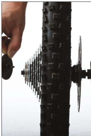
**3. Schraube den Schnellspanner vollständig ab und ziehe ihn aus der Achse. Stecke jetzt anstelle des Schnellspanners die mitgelieferten Kunststoff-Schutzkappen links und rechts auf die Achse.**
