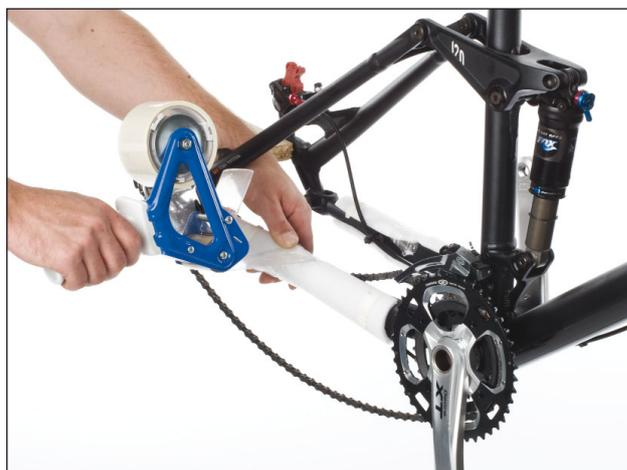
9. Wickel die Schaumstoffröllchen um die Kettenstreben und fixiere sie mit Klebeband.
