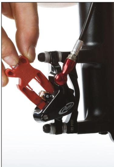
**4. Stecke die Scheibenbrems-Sicherung zwischen die Bremsbacken.**
