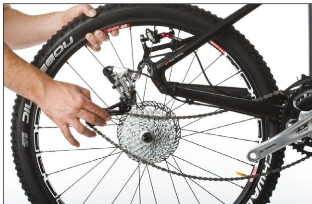
**5. Entferne jetzt das Hinterrad. Dazu musst Du den hinteren Schnellspanner lösen.**
