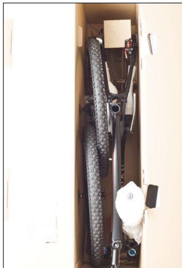
19. Packe jetzt erst das Hinterrad, dann das Vorderrad dazu, wie Du es auf der Abbildung siehst. Das mit Schaumstoff geschützte Ritzelpaket des Hinterrades findet zwischen Sitz- und Kettenstreben im Hinterbaudreieck Platz.
