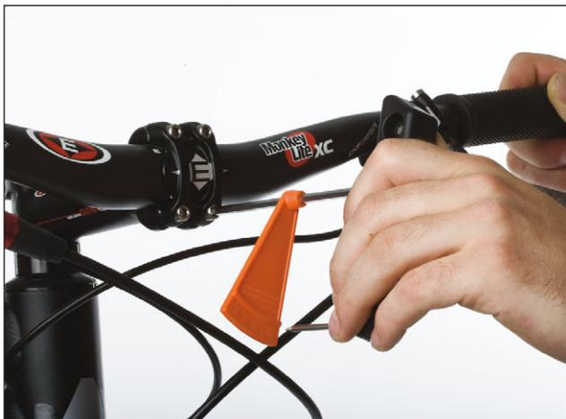
12. Demontiere jetzt den Lenker. Löse dazu die Schrauben der Vorbaukappe mit dem Drehmomentschlüssel (Torque Wrench).
