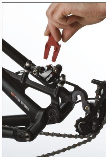
7. Stecke die Bremsicherung zwischen die Bremsbacken der hinteren Bremse.
