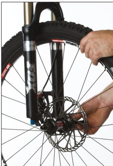
**2. Löse den vorderen Schnellspanner und entferne das Vorderrad aus der Gabel.**
