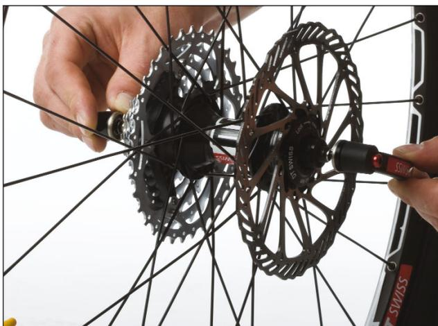
6. Entferne jetzt den Schnellspanner und stecke die Kunststoff-Schutzkappen links und rechts in die Achsen.
