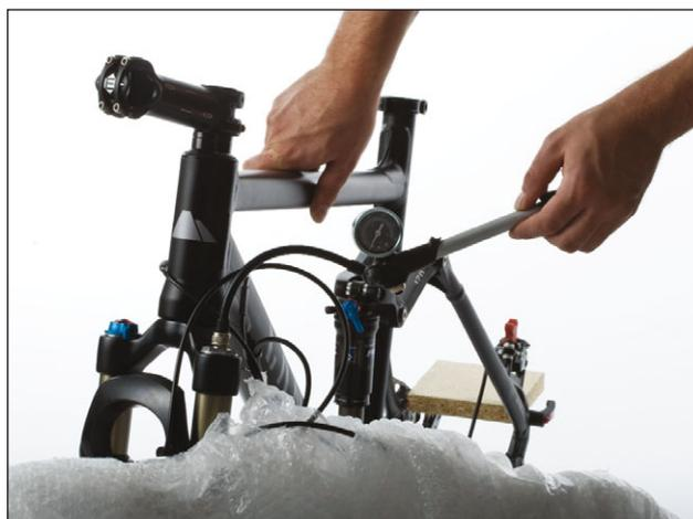
15. Lasse mit der Federgabelpumpe die Luft aus der Gabel und komprimiere sie, damit das Bike von der Höhe her in den BikeGuard passt.
