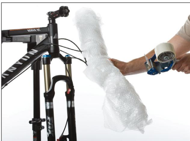
14. Der Lenker hängt jetzt nur noch an den Zügen und Bremsleitungen. Wickel den Lenker jetzt mit Luftpolsterfolie ein und fixiere ihn mit Klebeband.
