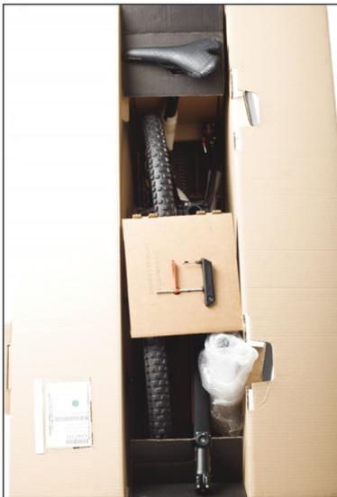
**26.** So sollte der fertig gepackte BikeGuard später von oben aussehen.
