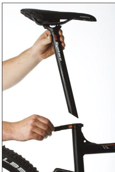
11. Löse den Sattelschnellspanner und entnehme die Sattelstütze samt Sattel.
