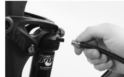
Pumpen Sie das Federbein mit der speziellen Pumpe, die dem BikeGuard beiliegt, gemäß den Empfehlungen des Federbeinherstellers auf. Die Anleitung des Federbeinherstellers finden Sie auf der beiliegenden CD.
