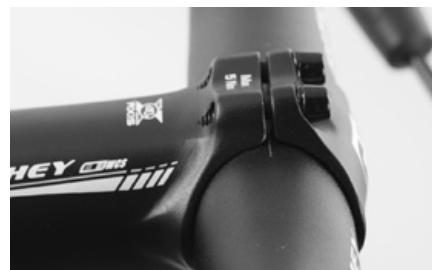
Kontrollieren Sie, ob die Slitze zwischen Vorbaudeckel und Vorbaukörper in sich parallel und oben und unten gleich breit sind. Lösen Sie ggf. die Klemmschrauben und drehen Sie sie gleichmäßig leicht an.
