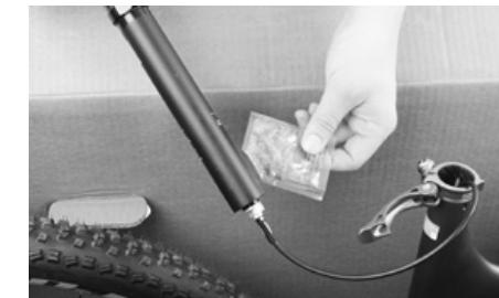
Das ist besonders in den Klemmbereichen von Lenker und Vorbau, Gabelschaftröhr und Vorbau und Sattelstütze und Sitzrohr sinnvoll – drei Klemmbereichen, bei denen zu hohe Klemmkraft die Bauteile zerstören kann, wodurch diese versagen können oder die Garantie erlischt.
