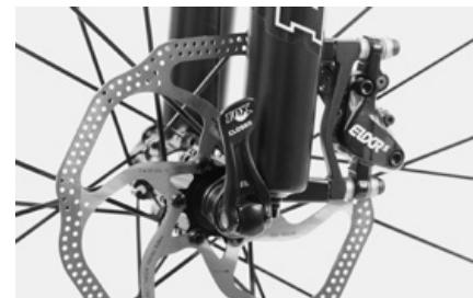
Der Schnellspannhebel darf sich nach dem Schließen nicht mehr drehen lassen. Achten Sie darauf, dass der Schnellspannhebel nicht nach vorne oder außen absteht. Am besten wird er vor dem Tauchrohr nahezu senkrecht nach oben geschlossen.
