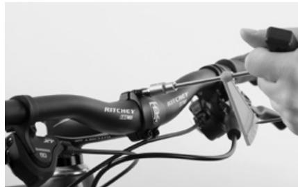
Benutzen Sie den Canyon Drehmomentschlüssel und drehen Sie die Klemmschrauben abschließend über kreuz an. Überschreiten Sie die meist auf dem Vorbau aufgedruckten maximalen Anzugsdrehmomente nicht!
