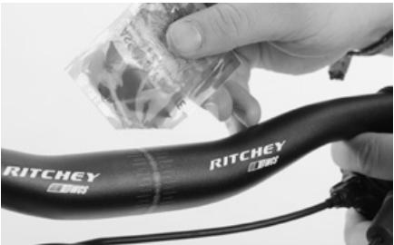
Bevor Sie Canyon Montagepaste aufbringen, entfernen Sie Schmutzpartikel und Schmierstoffrückstände von der zu behandelnden Oberfläche. Als nächstes streichen Sie mit einem Pinsel oder einem Ledertuch eine dünne und gleichmäßige Schicht Canyon Montagepaste auf die sauberer Oberflächen.
