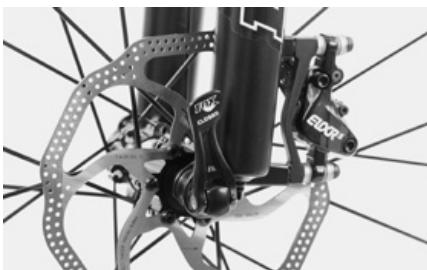
Die Bremsscheibe darf dabei nicht am Bremssattel und in der Regel nicht stark an den Bremsbelägen schleifen. Versetzen Sie beide Laufräder in Drehbewegung und kontrollieren Sie, ob die Räder rund laufen.
