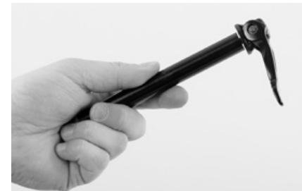
Nehmen Sie die Steckachse für das Vorderrad aus dem Karton mit den Kleinteilen.
