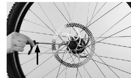
Schieben Sie den Schnellspanner in die hohle Achse des Vorderrades.
