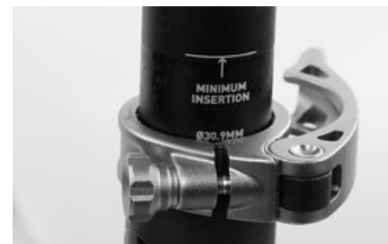
Ihre Sattelstütze muss mindestens bis unterhalb des Oberrohrs bzw. bis zur MIN-/MAX-Markierung der Stütze im Rahmen stecken.
