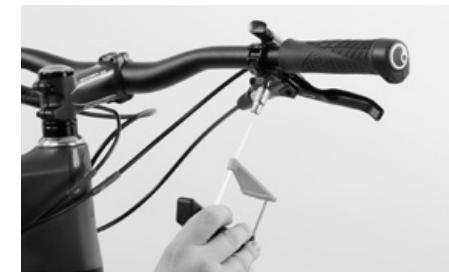
Drehen Sie die Schraube mit dem seitens SRAM vorgegebenen Drehmoment von 5-6 Nm an.
