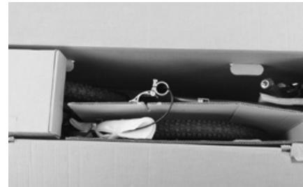
Im BikeGuard befindet sich das montierte Rahmenset mit eingebautem Hinterrad und allen Anbauteilen, separat davon das Vorderrad, das ggf. in einer Laufradtasche verpackt ist, der Sattel mit Sattelstütze, die ggf. mit einer Leitung mit einer Bedieneinheit für die Lenkermontage verbunden ist.
