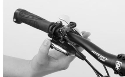
Lösen Sie die Schraube der benachbarten Schelle des Bremshebels und verdrehen Sie den Bremshebel nach unten.
