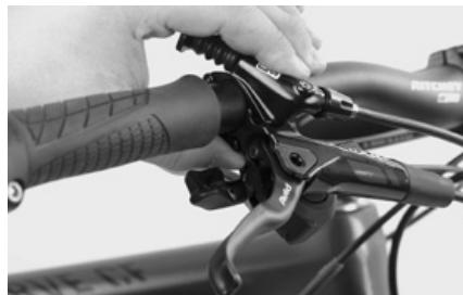
Der Schalthebel ist am Lenker montiert, der Bremshebel jedoch nicht.
