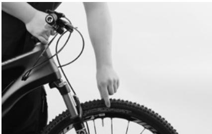
Ziehen Sie mehrmals am Bremshebel, nachdem Sie das Laufrad eingebaut und die Steckachse bzw. den Schnellspanner geschlossen haben und versetzen Sie anschließend das Laufrad in Drehbewegung.
