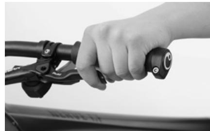
Machen Sie nach der Laufradmontage eine Bremsprobe im Stillstand. Der Hebel muss einen Druckpunkt aufweisen und darf sich nicht bis zum Lenker ziehen lassen. Weitere Informationen finden Sie im Kapitel „**Die Bremsanlage**“ in Ihrem Fahrradhandbuch Mountainbike auf der beiliegenden CD.
