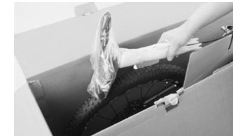
Legen Sie die Sattelstütze vorsichtig auf das Hinterrad. Entnehmen Sie das Vorderrad samt Schutzkarton und stellen Sie es beiseite. Entfernen Sie vorsichtig die Schutzfolie von der Sattelstütze.
