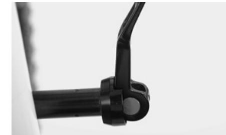
Achten Sie darauf, dass der Schnellspannhebel komplett geöffnet ist und in der Aussparung der Achse liegt. Wenn das Gewinde der Achse im Gewinde des linken Gabelholms greift, drehen Sie die Achse im Uhrzeigersinn. Die ersten Umdrehungen muss sich die Steckachse leicht drehen lassen.
