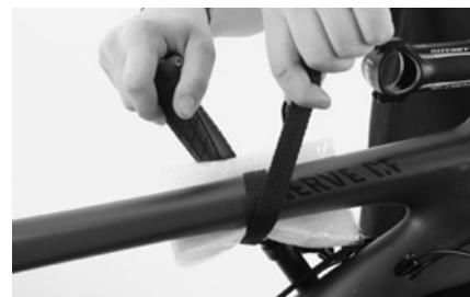
Halten Sie den Lenker fest und lösen Sie oben am Rahmen das zweite Band mit Klettver- schluss.
