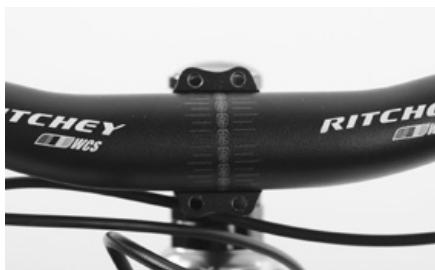
Positionieren Sie den Lenker anhand der Markierungen mittig im Vorbauauge. Achten Sie dabei darauf, dass die Bowdenzüge und Leitungen nicht verdreht oder abgeknickt sind und in gleichmäßigen Radien zu den Anschlägen oder der Bremse verlaufen.
