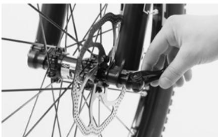
Wenn das Gewinde der Achse im Gewinde des rechten Gabelholms greift, drehen Sie diese im Uhrzeigersinn. Die ersten Umdrehungen muss sich die Steckachse leicht drehen lassen. Drehen Sie die Achse leicht an und dann um ca. eine Drittel Umdrehung zurück.
