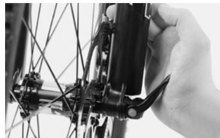
Schließen Sie den E-Thru-Schnellspannhebel wie einen üblichen Schnellspannhebel.
