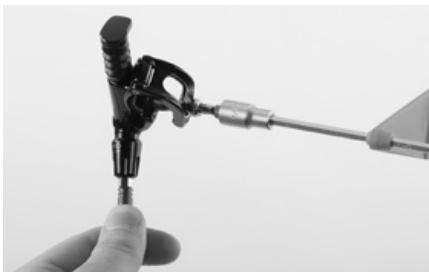
Nehmen Sie den passenden Bit aus dem Toolcase und lösen Sie die Torx-Schraube am Bedienhebel.
