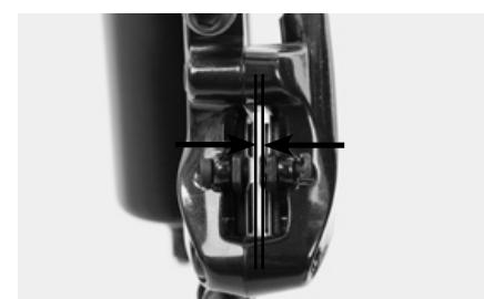
Kontrollieren Sie bei Scheibenbremsen vor dem Einbau des Laufrades, ob die Bremsbeläge exakt in den Aufnahmen im Bremsattel sitzen. Erkennbar ist dies daran, dass der Schlitz zwischen den Belägen parallel verläuft.
