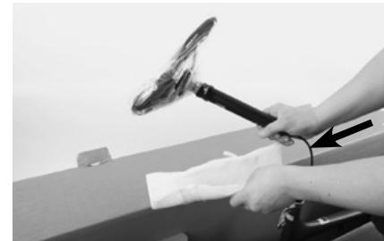
Ist Ihr Canyon mit einer höhenverstellbaren Sattelstütze ausgestattet, montieren Sie die höhenverstellbare Sattelstütze, bevor Sie das Canyon aus dem BikeGuard heben. Die höhenverstellbare Sattelstütze ist im fahrerfreien Zustand durch eine Leitung, die durch das Sitzrohr führt, mit dem Bedienhebel, der am Lenker montiert ist, verbunden.
