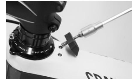
Achten Sie darauf, dass der Vorbau samt Lenker nach vorne zeigt. Positionieren Sie die IPU so am Oberrohr, dass die abgerundete Seite nach vorne und der abgeschrägte Teil nach hinten weist und weich zum Rahmenrohr ausläuft.
