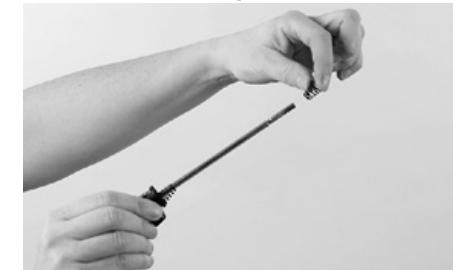
Nehmen Sie den Schnellspanner für das Vorderrad aus dem Karton mit den Kleinteilen. Drehen Sie die Gegenmutter ab und ziehen Sie eine der Federn von dem Schnellspanner.
