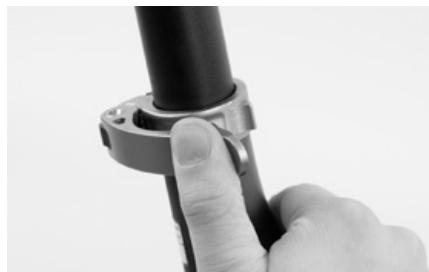
Schieben Sie die Sattelstütze bis zur minimalen Einstechtiefe, erkennbar an der MIN-/ MAX-Markierung, in das Sattelrohr ein. Rich- ten Sie den Sattel aus und schließen Sie den Schnellspanner oder die Schraube an der Sat- telrohrklemmung. Drehen Sie die Schraube bzw. den Schnellspanner der Sattelrohrklem- mung nicht zu fest an.
