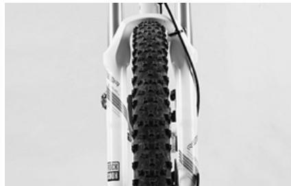
Prüfen Sie anschließend, ob das Vorderrad mittig zwischen den Gabelbeinen sitzt. Achten Sie auf einen korrekten Sitz des Schnellspanners und der Ausfallsicherungen.
