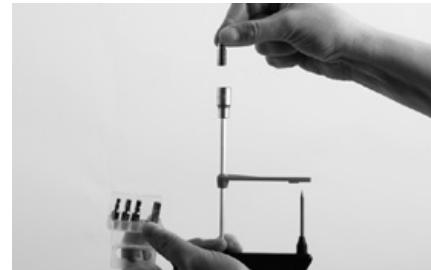
Stecken Sie den passenden Bit in die Aufnahme des Canyon Drehmomentschlüssels.
