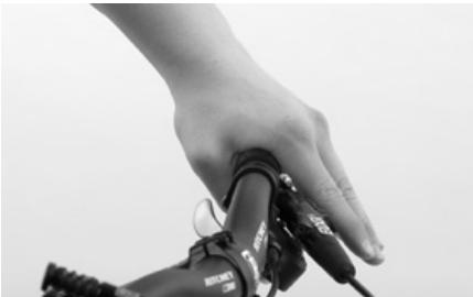
Stellen Sie den Lenker bei montiertem Vorderrad und angepasstem Luftdruck ein. Die Bremsgriffe zeigen beim fahrbereiten Mountainbike leicht nach unten. Wenn Sie im Sattel sitzen, bilden der ausgestreckte Arm und die Finger eine gerade Linie, wenn die Finger auf dem Bremshebel liegen.
