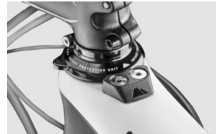
Einige Canyon Modelle mit Carbonrahmen sind mit einem Anschlag, Impact Protection Unit oder IPU genannt, versehen. Diese IPU verhindert, dass der Lenker oder dessen Armaturen gegen das Oberrohr schlagen.
