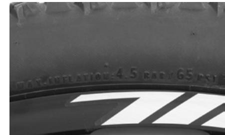
Pumpen Sie beide Reifen maximal mit dem auf der Reifenflanke ausgewiesenen Druck auf. Mehr zum Thema Reifen und Schläuche finden Sie im Kapitel „**Die Laufräder – Reifen, Schläuche und Luftdruck**“ in Ihrem Fahrradhandbuch Mountainbike auf der beiliegenden CD.
