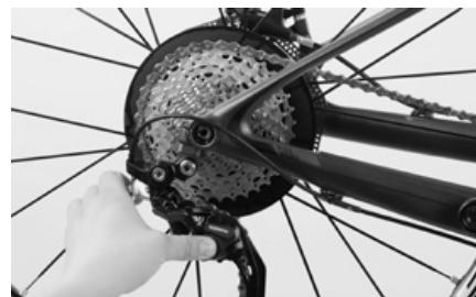
Kontrollieren Sie die Schaltungsfunktion. Schalten Sie alle Gänge durch und prüfen Sie, ob sichergestellt ist, dass das hintere Schaltwerk nicht mit den Speichen in Kontakt geraten kann, wenn die Kette auf dem größten Zahnrad läuft.
