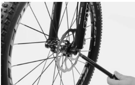
Setzen Sie das Vorderrad in die Gabel und fädeln Sie gleichzeitig die Bremsscheibe in den Bremssattel. Richten Sie das Vorderrad zwischen den Radaufnahmen aus und schieben Sie die Achse mit geöffnetem E-Thru-Schnellspannhebel von links durch die Radaufnahme und die Nabe.
