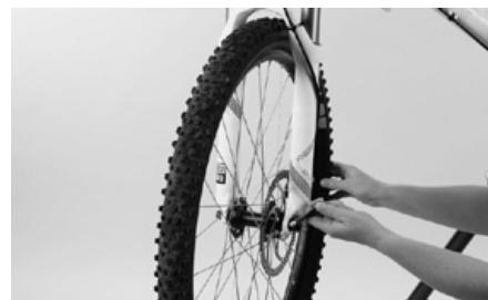
Bauen Sie das Vorderrad ein und achten Sie darauf, dass Sie die Bremsscheibe zwischen die Bremsbeläge schieben. Schließen Sie den Schnellspanner so, dass das Laufrad sicher befestigt ist. Lesen Sie zuvor das Kapitel „**Umgang mit Schnellspannern und Steckachsen**“ in Ihrem Fahrradhandbuch Mountainbike.
