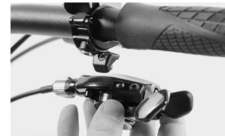
Montieren Sie den Schalthebel am Matchmaker. Drehen Sie die Schraube mit dem seitens SRAM vorgegebenen Drehmoment von 2,8-3,4 Nm an.
