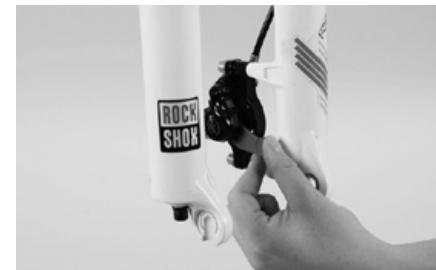
Entfernen Sie die eventuell vorhandene Schutzfolie an der Gabel. Versuchen Sie dies grundsätzlich von Hand. Wenn dies nicht gelingt, verwenden Sie bevorzugt eine Schere und keinesfalls ein Teppichschneidemesser. Entfernen Sie nun die Transportsicherungen an der Vorderrad-Bremse. Näheres zu Bremsen finden Sie im Kapitel „**Die Bremsanlage**“ in Ihrem Fahrradhandbuch Mountainbike; beachten Sie auch die Anleitung des Komponentenherstellers auf der beiliegenden CD.
