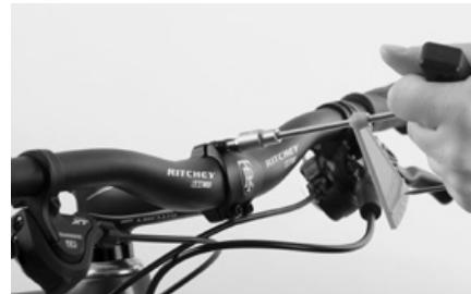
Legen Sie den Vorbaudeckel auf. Drehen Sie die Klemmschrauben des Vorbaudeckels gleichmäßig und über kreuz an, bis der Lenker leicht klemmt.
