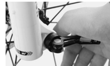
Drehen Sie den Hebel nun mit Kraft im Uhrzeigersinn bis die Achse handfest zugedreht ist. Achten Sie darauf, dass der Schnellspannhebel beim Anziehen nicht aus der Aussparung der Achse rutscht.
