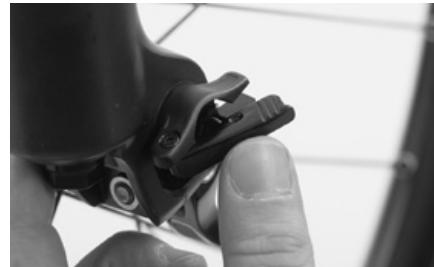
Das 20-mm-Steckachsensystem weist mehrere Einrichtungen auf, um das Vorderrad festzusetzen. Klappen Sie zur Montage des Vorderrades die beiden Schnellspannhebel an beiden unteren Gabelenden ganz auf. Setzen Sie das Vorderrad in die Gabel und fädeln Sie gleichzeitig die Bremsscheibe in den Bremssattel.
