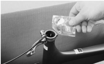
Verteilen Sie nun etwas Canyon Montage-paste auf dem unteren Teil der Sattelstütze und innen am Sitzrohr des Rahmens bzw. im Klemmbereich der Sattelstütze.
