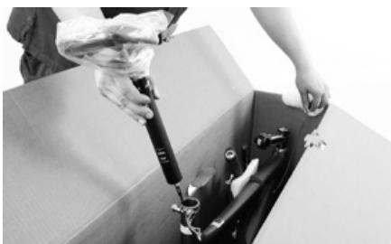
Halten Sie die Sattelstütze in der einen Hand und greifen Sie die Leitung der Sattelstütze, wo diese aus dem Rahmen austritt. Während Sie die Sattelstütze mit der einen Hand vorsichtig in das Sitzrohr einführen, ziehen Sie mit der anderen Hand die Leitung vorsichtig nach.
