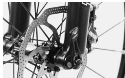
Sollte sich der Hebel nicht komplett schließen lassen, öffnen Sie ihn wieder und drehen Sie die Achse ein wenig entgegen dem Uhrzeigersinn. Versuchen Sie erneut, den Schnellspannhebel zu schließen.
