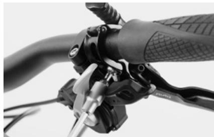
Richten Sie den Bremshebel aus wie den werkseitig bereits montierten linken Bremshebel. Drehen Sie die Schraube mit dem seitens SRAM vorgegebenen Drehmoment von 5-6 Nm an.
