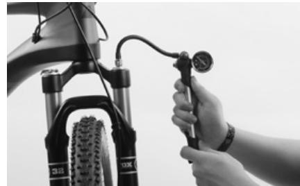
Für den Transport wurde die Luft komplett aus der Federgabel gelassen. Sie müssen Ihre Federgabel mit dem entsprechenden Gabel-luftdruck befüllen.
