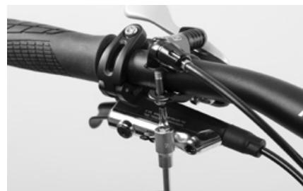
Nun können Sie die Schraube des Bedienhebels mit dem Canyon Drehmomentschlüssel andrehen.
