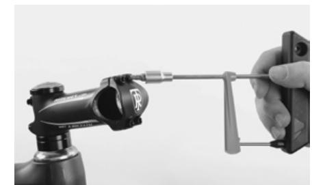
Nehmen Sie den Canyon Drehmomentschlüs- sel zur Hand und stecken Sie das zu den Vor- bauschrauben passende Bit auf den Schlüssel.
