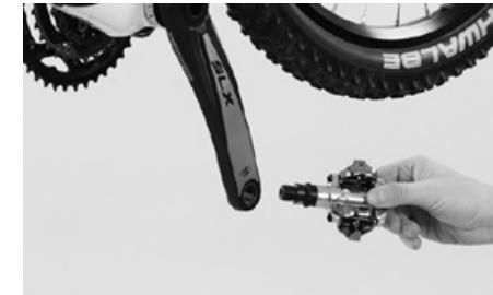
Drehen Sie die Pedale von Hand die ersten zwei bis drei Umdrehungen in die Gewinde der Kurbeln ein. Nehmen Sie erst dann einen Pedalschlüssel zu Hilfe und drehen Sie damit die Pedale fest.
