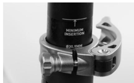
Schieben Sie die Sattelstütze bis zur minimalen Einstekttiefe, erkennbar an der MIN-/MAX-Markierung, in das Sitzrohr ein.
