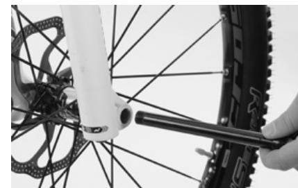
Beim Maxle-Steckachsensystem mit Spannhebel setzen Sie das Vorderrad in die Gabel und fädeln gleichzeitig die Bremsscheibe in den Bremssattel.
