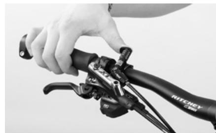
Positionieren Sie den Hebel so, dass Sie diesen bedienen können.
