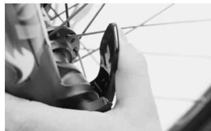
Richten Sie das Vorderrad zwischen den Radaufnahmen aus und schieben Sie die Achse von rechts durch die Radaufnahme und die Nabe. Klappen Sie den Hebel aus der Achse aus.
