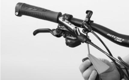
Bremshebel und Schalthebel sind am Lenker montiert. Montieren Sie den Bedienhebel am Lenker auf der Innenseite der Schellen von Brems- und Schalthebel. Drehen Sie die Schraube nur leicht an, so dass Sie den Bedienhebel noch frei verdrehen und verschieben können.
