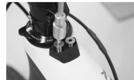
Wenn diese Bohrungen vorhanden sind, entnehmen Sie die Impact Protection Unit mit den zwei Innensechskantschrauben aus dem Karton mit den Kleinteilen.
