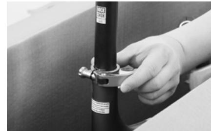
Richten Sie den Sattel aus und schließen Sie den Schnellspanner oder die Schraube an der Sattelrohrklemmung. Drehen Sie die Schraube bzw. den Schnellspanner der Sattelrohrklemmung nicht zu fest an. Entfernen Sie ggf. die Schutzfolie am Sattel.
