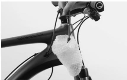
Der Bedienhebel der höhenverstellbaren Sattelstütze kann bereits am Lenker montiert sein oder noch frei an der Leitung hängen.
