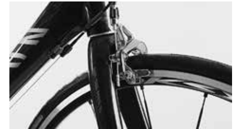
Überprüfen des Rundlaufs anhand der Bremsbeläge
