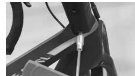
Drehen Sie die Schraube der Transitionplate an
