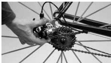
Zum Ausbau des Hinterrades das Schaltwerk etwas nach hinten ziehen
