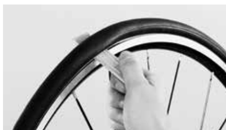
Mit einem Montierhebel lässt sich der Reifen herunterheben
