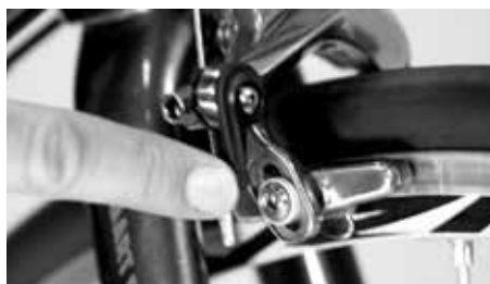
Prüfen des Rundlaufs mit Hilfe der Bremsbeläge
