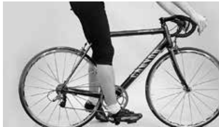
Wenn die Ferse auf dem Pedal steht, welches sich in der untersten Position befindet, muss das Bein ganz durchgestreckt sein
