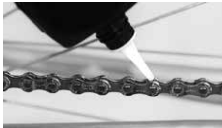
Tragen Sie auf die möglichst blanken Kettenglieder Kettenöl auf
