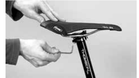
Lösen Sie die beiden Schrauben zwei bis maximal drei Umdrehungen
