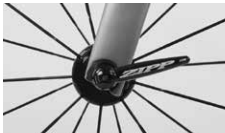
In der Endstellung muss der Hebel rechtwinklig zur Schnellspann-achse liegen
