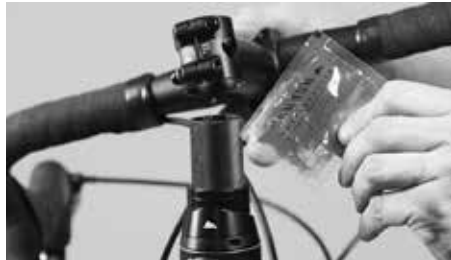
Benetzen Sie gegebenenfalls den Gabelschaft oder den Lenker mit Carbon-Montagepaste
