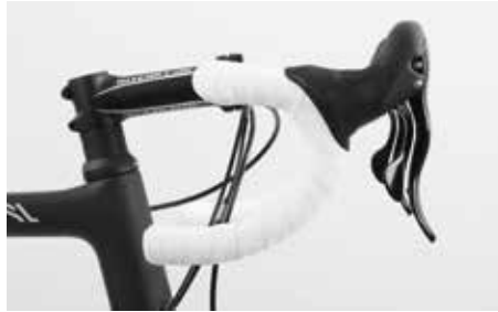
Das gerade Stück des Unterlenkers sollte parallel zum Boden oder leicht nach unten weisen
