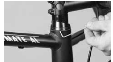
Stellen Sie das Lagerspiel mit der seitlich liegenden Einstellschraube ein
