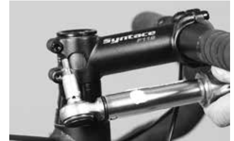
Kontrollieren Sie die seitlichen Vorbau-Klemmschrauben mit dem Drehmomentschlüssel gemäß den aufgedruckten Angaben
