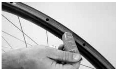
Verteilen des Reifenklebers direkt aus der Tube
