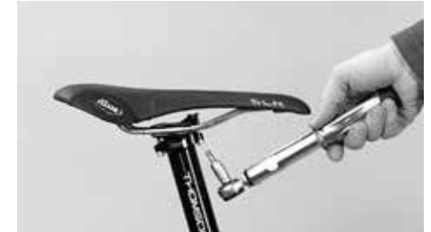
Ziehen Sie die Schrauben abwechselnd und gleichmäßig mit dem vorgeschriebenen Drehmoment wieder fest
