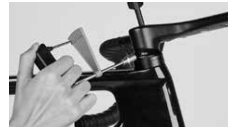
Drehen Sie die Schraube an der Rückseite der Kappe des Steuerlagers mit dem angegebenen Drehmoment von 9 Nm fest
