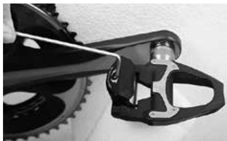
Einstellen der Auslösehärte des Pedals
