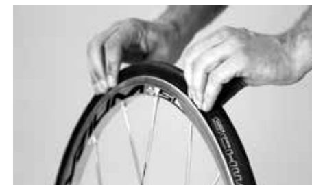
Drücken Sie den Reifen um sicher zu gehen, dass der Schlauch nicht eingeklemmt ist
