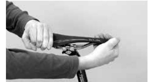
Versuchen Sie den Sattel gegenüber dem Rahmen zu verdrehen
