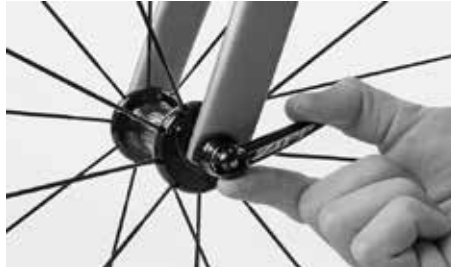
Überprüfen Sie den Sitz, indem Sie versuchen, den geschlossenen Hebel zu verdrehen
