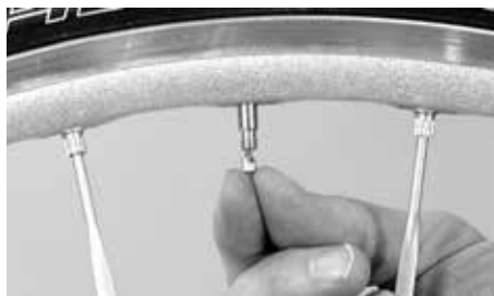
Beim Renn- oder Slaverandventil muss das Ventil aufgeschraubt werden
