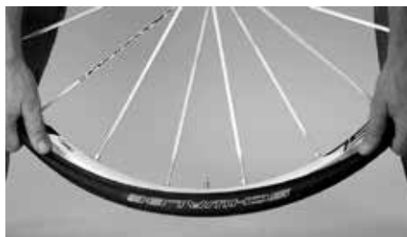
Reifen per Hand in die Felge drücken
