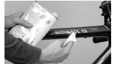
Benutzen Sie Autowachs um die Oberfläche zu schützen
