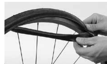
Schlauch aus dem Reifen ziehen
