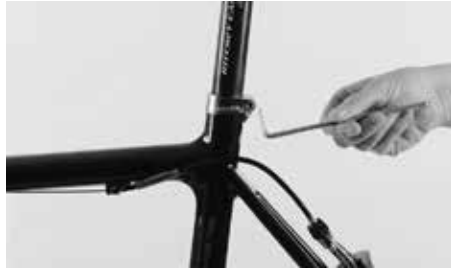
Um die Sitzhöhe einzustellen, müssen Sie die Sattelstützenschraube der Sattelklemmung lösen
