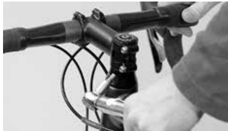
Ziehen Sie die seitlichen Vorbau-Klemmschrauben mit dem Drehmomentschlüssel wieder an
