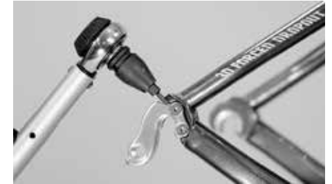
Beim Austausch des wechselbaren Schaltauges dürfen sie keinesfalls das maximale Drehmoment von 1,5 Nm überschreiten
