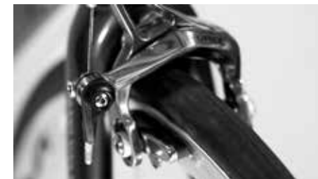
Prüfen des Rundlaufs mit Hilfe der Bremse
