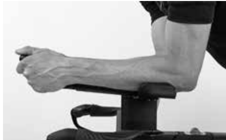
Die Ellenbogen sollten etwas nach hinten über die Schalen überstehen
