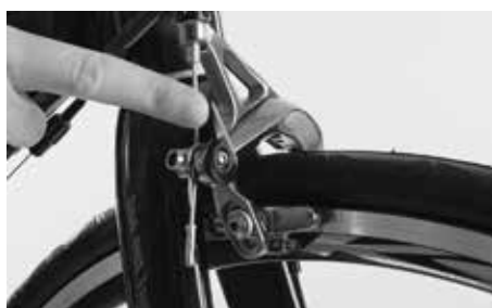
Öffnen des Entspannhebels an der Bremse
