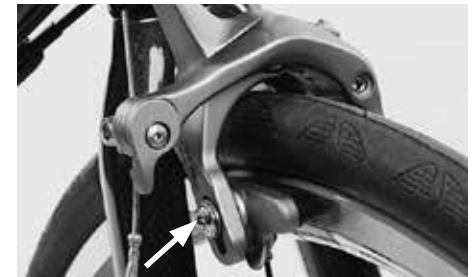
Drehen Sie zur Höhenverstellung die Belagsbefestigungsschraube mit dem vorgeschriebenen Drehmoment fest
