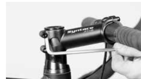
Lösen Sie die Schrauben seitlich am Vorbau
