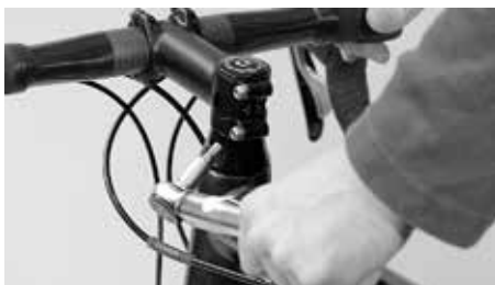
Ziehen Sie dann den Vorbau mit dem vorgeschriebenen Drehmoment wieder fest
