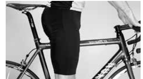
Die Überstandhöhe muss genügend Schrittfreiheit bieten
