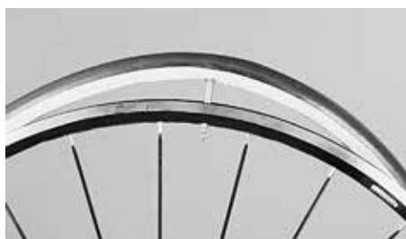
Stecken Sie das Ventil des leicht aufgepumpten Reifens ins Ventilloch der Felge
