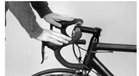
Der Lenker darf sich bei einem kräftigen Ruck nicht verdrehen lassen
