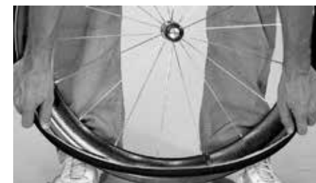
Den Reifen in das Felgenbett heben
