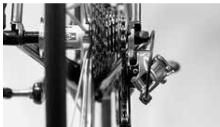
Schauen Sie von hinten auf das Zahnkranzpaket und prüfen Sie ob die Leitrollen des Schaltwerkes genau unter den Zahnspitzen des passenden Ritzels liegen
