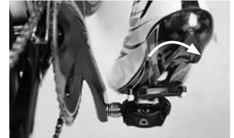
Die Verbindung wird durch Drehen der Ferse nach außen gelöst
