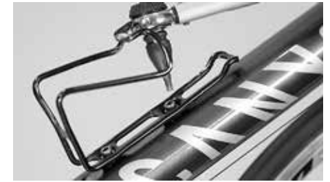
Halten Sie sich beim Flaschenhalter an ein maximales Drehmoment von 2 Nm
