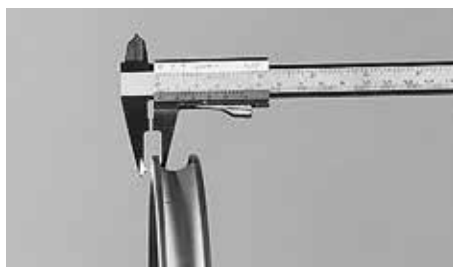
Lassen Sie die Wandstärke Ihrer Felgen spätestens nach dem 2. Satz Bremsbeläge überprüfen
