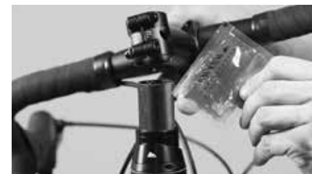
Benetzen Sie den Gabelschaft mit Carbon-Montagepaste
