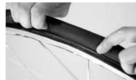
Drücken des Reifens in die Felgenmitte
