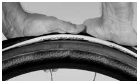
Drücken Sie den Reifen zur Seite, bis sich ein Spalt bildet
