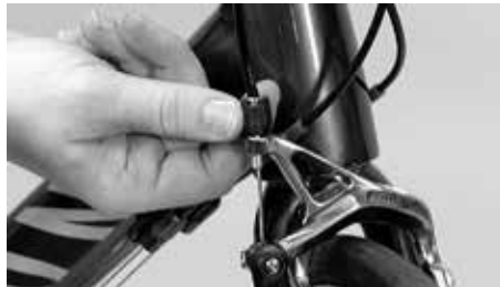
Stellen Sie mit der Rändelmutter den notwendigen Bremshebelweg am Lenker ein
