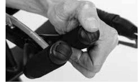
Lenkerendschalthebel steuern Schaltwerk und Umwerfer an
