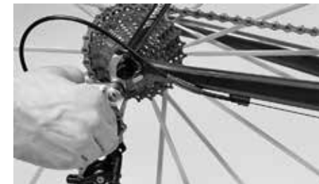
Prüfen Sie, ob das Schaltwerk in die Speichen geraten kann
