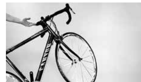
Überprüfen Sie die Leichtgängigkeit des Lagers, indem Sie das Vorderrad anheben und prüfen, ob es sich sehr leichtgängig bewegen lässt
