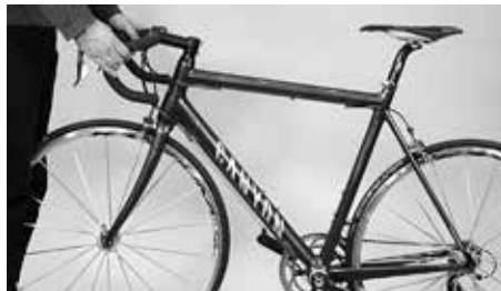
Versuchen Sie den Lenker gegenüber dem Vorderrad zu verdrehen
