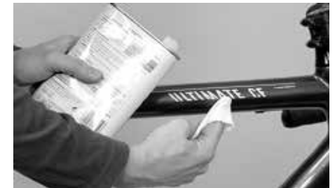
Konservieren von Lack und metallischen Oberflächen mit Hartwachs
