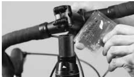
Benetzen Sie den Gabelschaft mit Carbon-Montagepaste
