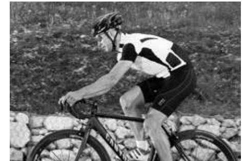
Der Abstand zwischen den Handgriffen des Lenkers und dem Sattel beeinflusst die Rücken-Neigung
