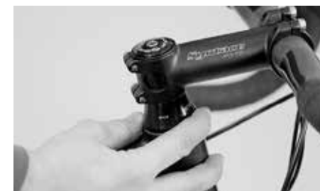
Überprüfen Sie das Spiel im Lenkungs-lager, indem Sie die Finger um die Lagerschale legen und das Canyon mit gezogener Bremse vor- und zurückschieben
