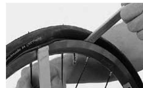
Ansetzen des Montierhebels und Hebeln der Reifenflanke über den Felgenrand
