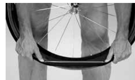
Reifen mit den Daumen über den Felgenrand drücken
