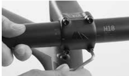
Öffnen Sie die Innensechskantschraube(n) an der Vorderseite des Vorbaus
