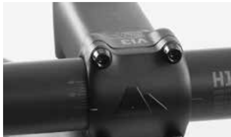
Der obere Schlitz muss komplett geschlossen werden
