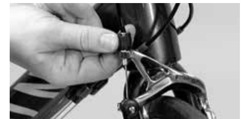
Mit der Rändelmutter stellen Sie den Leerweg der Bremse ein
