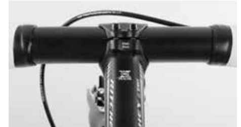
Die Schlitz zwischen Vorbaudeckel und Vorbaukorpus müssen in sich parallel und oben und unten gleich breit sein
