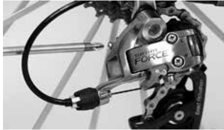
Zum Einstellen des Abstandes zwischen Rollenkäfig und Kranz drehen Sie die Schraube, die sich auf der Stirnseite des Ausfallendes abstützt
