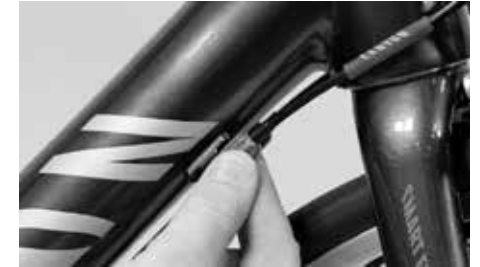
Nachspannen des Schaltzuges an der Stellschraube am Rahmen
