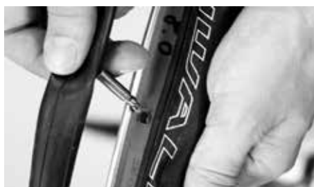
Ventil in das Felgenloch stecken
