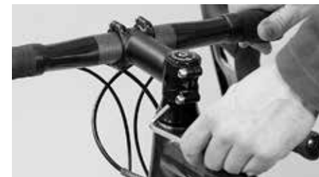
Lösen Sie die Schrauben seitlich am Vorbau
