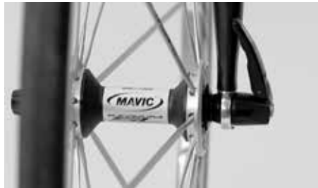
Der Hebel des Schnellspanners muss annähernd parallel zum Rad liegen und darf nicht seitlich abstehen
