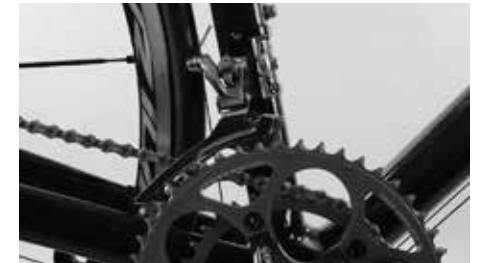
Einstellen des Schwenkbereiches des Umwerfers
