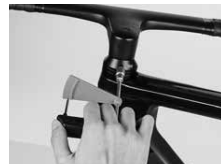
Montage mit dem Canyon Drehmomentschlüssel
