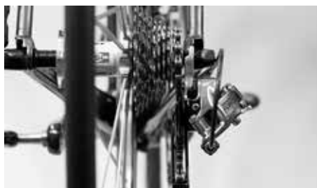
Vor der Demontage des Hinterrades auf das kleinste Ritzel schalten
