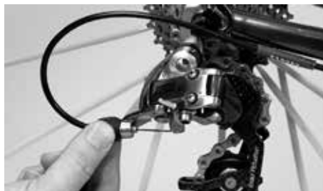
Nachspannen des Schaltzuges an der Stellschraube am Schaltwerk
