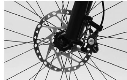
Überprüfen Sie bei Scheibenbremsen vor dem Einbau des Laufrades, ob die Bremsbeläge exakt in den Aufnahmen im Bremssattel sitzen. Erkennbar ist dies daran, dass der Schlitz zwischen den Belägen parallel verläuft und die Verschleißindikatoren an der dafür vorgesehenen Stelle sind. Achten Sie darauf, dass Sie die Bremsscheibe zwischen die Bremsbeläge schieben.
