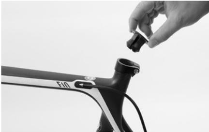
Nehmen Sie die Schutzkappe am oberen Ende des Sitzrohrs ab. Öffnen Sie die Schraube an der Sattelrohrklemmung. Lesen Sie zuvor das Kapitel „Anpassen des Canyon Rennrades an den Fahrer“ in Ihrem Fahrradhandbuch Rennrad und auf der beiliegenden CD.
