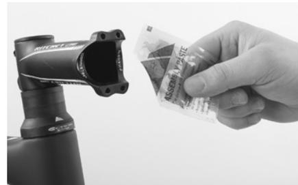
Das ist besonders in den Klemmbereichen von Lenker und Vorbau, Gabelschaftrohr und Vorbau, Sattelstütze und Vorbau sinnvoll – drei Klemmbereichen, bei denen zu hohe Klemmkraft die Bauteile zerstören kann, wodurch diese versagen können oder die Garantie erlischt. Mit Canyon Montagepaste wird durch die Verringerung der Klemmkraft der eventuellen Zerstörung der Carbonfasern vorgebeugt. Außerdem wird häufig vorkommendes Knacken an den Klemmstellen verhindert.
