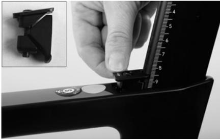
Schieben Sie die Sattelstütze bis zur gewünschten Sitzhöhe in das Sattelrohr. Setzen Sie die integrierte Sattelstützenklemme ein.
