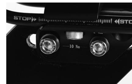
Ein Überschreiten des maximalen Drehmomentes an den Klemmschrauben (z.B. am Vorbau, Gabelschaft, Lenker oder Sattelstütze) führt zu einer zu hohen Klemmkraft. Diese kann das Versagen des Bauteils mit sich bringen und birgt daher ein hohes Unfallrisiko. Darüber hinaus wird in diesem Fall die Produktgarantie unwirksam. Zu lockere oder übermäßig festgedrehte Schrauben können zu einem Versagen und deshalb zu einem Unfall führen. Halten Sie sich genau an die Drehmomentangaben von Canyon.
