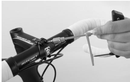
Benutzen Sie den Canyon Drehmoment-schlüssel und drehen Sie die Klemmschrauben abschließend über Kreuz an. Überschreiten Sie die maximalen Anzugsdrehmomente nicht!
