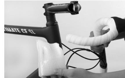
Entfernen Sie die Schutzfolie und die Schutzhüllen am Lenker. Versuchen Sie dies grundsätzlich von Hand. Wenn dies nicht gelingt, verwenden Sie bevorzugt eine Schere, nur zur Not ein Teppichschneidmesser. Lassen Sie den Lenker vorsichtig herunterhängen.
