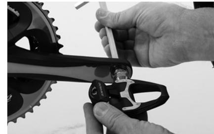
Drehen Sie die Pedale von Hand die ersten zwei bis drei Umdrehungen in die Gewinde der Kurbeln ein. Nehmen Sie erst dann einen Pedalschlüssel zu Hilfe und drehen Sie damit die Pedale fest. Bei einigen Pedaltypen müssen diese immer mit einem Innensechskantschlüssel angezogen werden.
