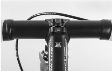
Kontrollieren Sie, ob die Schlitze zwischen Vorbaudeckel und Vorbaukorpus in sich parallel und oben und unten gleich breit sind. Lösen Sie ggf. die Klemmschrauben und drehen Sie sie gleichmäßig leicht an.
