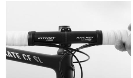
Positionieren Sie den Lenker anhand der Markierungen mittig im Vorbauauge. Achten Sie dabei darauf, dass die Bowdenzüge und Leitungen nicht verdreht oder abgeknickt sind und in gleichmäßigen Radien zu den Anschlüssen oder der Bremse verlaufen.
