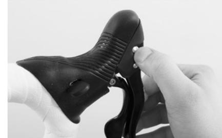
Entfernen Sie die Schutzfolie am Brems-/Schalthebel.
