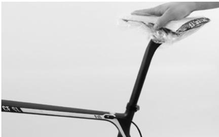
Die Sattelstütze muss ohne Drücken oder Drehen leicht in den Rahmen gleiten. Sollte dies nicht gelingen, öffnen Sie die Sattelrohrklemmung etwas mehr.
