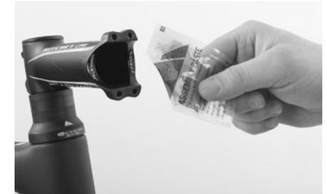
Öffnen Sie eine Ecke der Canyon Montagepaste. Drücken Sie etwas Montagepaste heraus und bestreichen Sie sowohl den Vorbaudeckel innen als auch den Klemmbereich des Vorbaukorpus dünn mit Canyon Montagepaste.
