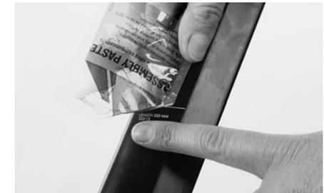
Verteilen Sie etwas Canyon Montagepaste auf dem unteren Teil der Sattelstütze und innen am Sitzrohr des Rahmens.
