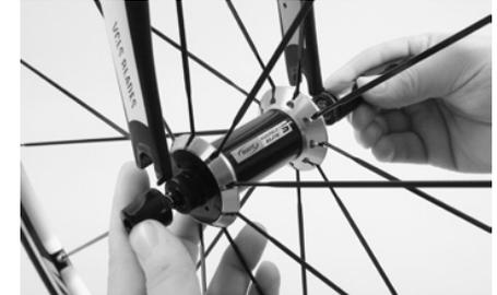
Bauen Sie das Vorderrad ein, indem Sie die Nabenachse mit Schnellspanner in die Ausfallenden schieben.
