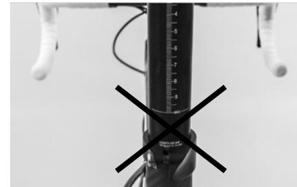
Ihre Sattelstütze muss mindestens bis unterhalb des Oberrohres bzw. bis zur MAX-Markierung der Stütze im Rahmen stecken.
