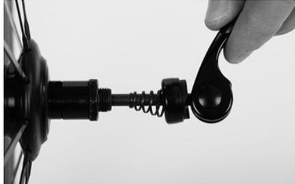
Auf jeder Seite der Nabe muss jeweils eine Feder platziert werden. Achten Sie darauf, dass die Feder mit dem kleinen Durchmesser auf beiden Seiten des Schnellspanners zur Nabenachse zeigt. Der Bedienungshebel des Schnellspanners wird auf der linken Seite (der Gegenseite des Kettenantriebs) montiert.
