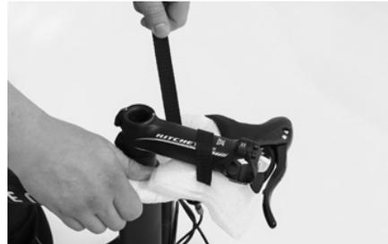
Halten Sie den Lenker fest und lösen Sie oben am Vorbau das Band mit Klettverschluss, das den Lenker fixiert.
