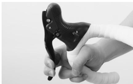
Ziehen Sie (bei Scheibenbremsen mehrmals) am Bremshebel, nachdem Sie das Laufrad eingebaut und den Schnellspanner geschlossen haben. Kontrollieren Sie, ob der Druckpunkt in beiden Bremsen nach gleichem Weg kommt und sofort stabil ist.
