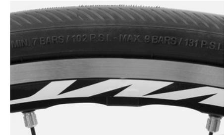
Pumpen Sie beide Reifen maximal mit dem auf der Reifenflanke ausgewiesenen Druck auf. Mehr zum Thema „Reifen und Schläuche“ finden Sie im Kapitel „Die Laufräder – Reifen Schläuche und Luftdruck“ in Ihrem Fahrradhandbuch Rennrad auf der beiliegenden CD. Führen Sie zum Abschluss der Montage die im Kapitel „Vor der ersten Fahrt“ beschriebenen Prüfungen sorgfältig durch.
