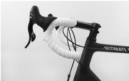
Kontrollieren Sie, ob die oberen Griffbereiche der Brems-Schaltgriffe waagrecht positioniert sind. Die Endbereiche des Unterlenkers liegen dann waagrecht oder leicht nach unten gerichtet.
