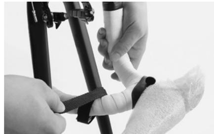
Halten Sie den Lenker weiterhin fest, damit er sich nicht verdreht oder herunterkippt und beschädigt wird. Lösen Sie unten an der Gabel das Band mit Klettverschluss, das den Lenker fixiert.
