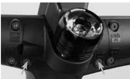
Anschließend müssen Sie die Abdeckung des Scheinwerfers an der Unterseite des Lenkers entfernen. Drehen Sie dafür die beiden Schrauben an der Unterseite des Lenkers mit dem 3 mm-Innensechskantschlüssel heraus.
