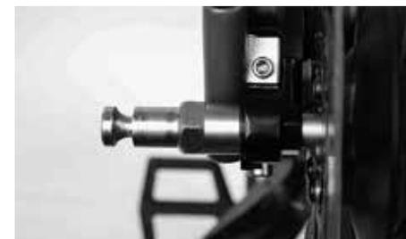
Bei Pedelec Modellen mit Nabenschaltung muss nicht die gesamte Achse getauscht werden, um den Croozer-Anhänger nutzen zu können. Sie müssen lediglich die Achsmutter auf der linken Achsseite ersetzen.
