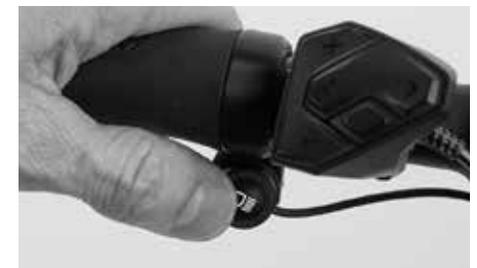
Nach Aktivierung des Lichtes, kann die Beleuchtung anschließend am Remote-Schalter per lang anhaltendem Druck an- bzw. ausgeschaltet werden.
