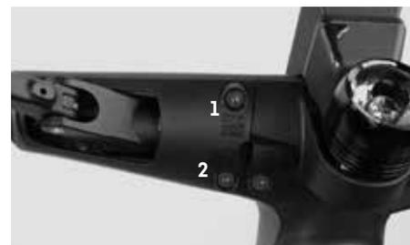
Die Schrauben sind mit „1st“ (1) und „2nd“ (2) gekennzeichnet.
