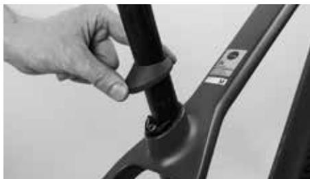
Schieben Sie zuerst die Abdeckung aus Gummi nach oben.
