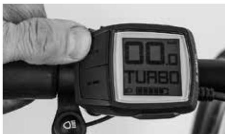
Die Leistungsunterstützung schaltet sich bei einer Geschwindigkeit von über 25 km/h ab.
