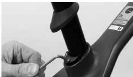
Lösen Sie anschließend die Innensechskantschraube am Klemmmechanismus (rückseitig am Sitzrohr), der die Sattelstütze im Sitzrohr klemmt gegen den Uhrzeigersinn ca. eine Umdrehung. Drehen Sie die Schraube nicht ganz heraus, da die Schraube ein essenzieller Bestandteil des Klemmsystems ist.
