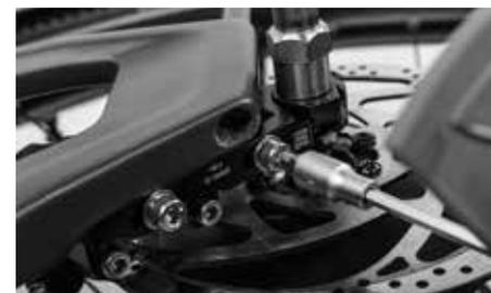
Nachdem Sie die Riemen Spannung eingestellt haben, drehen Sie die vier Befestigungsschrauben an der Unterseite der Kettenstrebe (zwei auf jeder Seite) abwechselnd und schrittweise mit 8 Nm fest (siehe Aufdruck).
