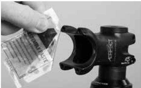
Das ist besonders in den Klemmbereichen von Lenker und Vorbau, Gabelschaftrohr und Vorbau sowie Sattelstütze und Sitzrohr sinnvoll – drei Klemmbereichen, bei denen zu hohe Klemmkraft die Bauteile zerstören kann, wodurch diese versagen können oder die Garantie erlischt.
