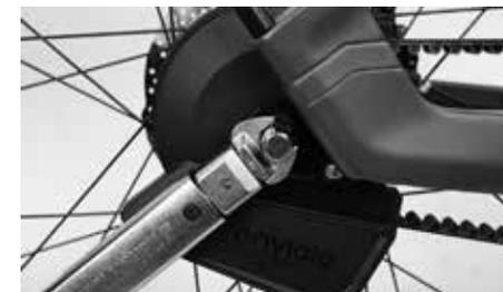
Drehen Sie die Achsmutter mit einem Schraubendrehermoment von 30–40 Nm fest.
