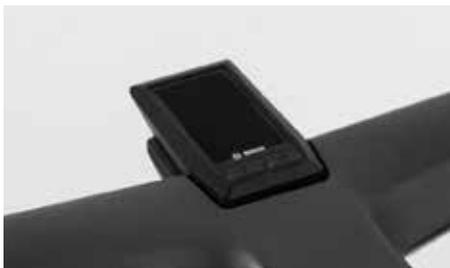
Einige Modelle mit Bosch-Antrieb sind mit dem KIOX-Display ausgestattet. Dieses Display wird durch Magnete gehalten.
