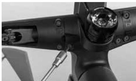
Im Anschluss müssen Sie wieder die Abdeckung des Scheinwerfers montieren. Drehen Sie dafür die beiden Schrauben an der Unterseite des Lenkers mit 2 Nm an.
