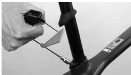
Nachdem Sie die richtige Sattelhöhe eingestellt haben, drehen Sie die Innensechskantschraube am Klemmmechanismus mit 7 bis 8 Nm fest. Benutzen Sie einen Drehmomentschlüssel. Schieben Sie zuletzt die Abdeckung aus Gummi wieder über den Klemmmechanismus bis dieser abgedeckt ist.
