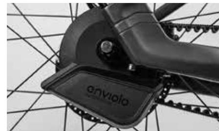
Im Automatik-Modus passt eine Software die Übersetzung automatisch auf die gewünschte Trittfrequenz des Fahrers an. D.h. Sie müssen nicht mehr selbst schalten, sondern können die für Sie ideale Trittfrequenz voreinstellen.
