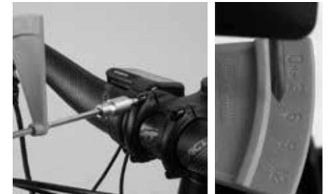
Drehen Sie langsam am Griff des Canyon Drehmomentschlüssels. Wird die Schraube fest, wandert der Zeiger über die Skala. Beenden Sie die Drehbewegung, sobald der Zeiger auf der Markierung des vorgegebenen Drehmomentes steht.
