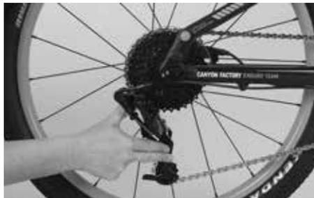
Kontrollieren Sie zusammen mit Ihrem Kind die Schaltungsfunktion. Schalten Sie bei einem Canyon Kid's MTB mit Kettenschaltung alle Gänge durch und prüfen Sie, ob sichergestellt ist, dass das hintere Schaltwerk nicht mit den Speichen in Kontakt geraten kann oder die Kette nach innen fällt, wenn die Kette auf dem größten Zahnrad läuft.
