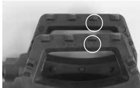
Schauen Sie bei der Montage der Pedale zuerst auf die Beschriftung der Achsen. Ein „R“ steht für das rechte Pedal und ein „L“ für das linke.
