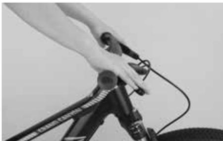
Stellen Sie den Lenker bei montiertem Vorderrad und angepasstem Luftdruck ein. Die Bremsgriffe zeigen beim fahrbereiten Mountainbike leicht nach unten. Wenn Ihr Kind im Sattel sitzt, sollen der ausgestreckte Arm und die Finger eine gerade Linie bilden, wenn die Finger auf dem Bremshebel liegen.
