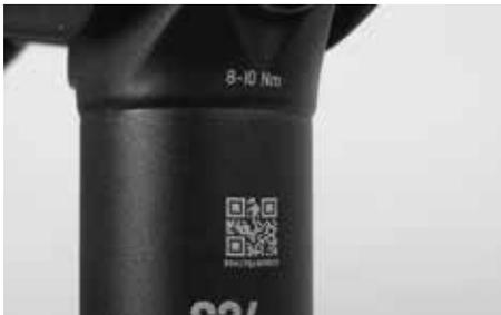
Ein Überschreiten des maximalen Drehmomentes an den Klemmschrauben (z.B. an der Sattelstütze oder an der Sattelstützenklemmung) führt zu einer zu hohen Klemmkraft. Diese kann das Versagen des Bauteils mit sich bringen und birgt daher ein hohes Unfallrisiko. Darüber hinaus wird in diesem Fall die Produktgarantie unwirksam. Zu lockere oder übermäßig festgedrehte Schrauben können zu einem Versagen und deshalb zu einem Unfall führen. Halten Sie sich genau an die Drehmomentangaben von Canyon.
