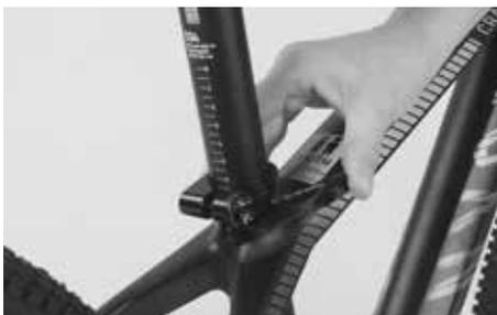
Richten Sie den Sattel aus und schließen Sie den Schnellspanner oder drehen Sie die Schraube der Sattelrohrklemmung nicht zu fest, d.h. nicht über das maximal zulässige Drehmoment an. Verwenden Sie ggf. den Canyon Drehmomentschlüssel. Hinweise zum Schnellspanner finden Sie im Kapitel „Umgang mit Schnellspannern und Steckachsen“.
