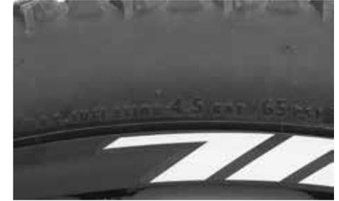
Pumpen Sie beide Reifen maximal mit dem auf der Reifenflanke ausgewiesenen Druck auf. Mehr zum Thema Reifen und Schläuche finden Sie im Kapitel „Die Laufräder – Reifen, Schläuche und Luftdruck“ in der Vollversion des Canyon Fahrradhandbuchs Mountainbike auf unserer Website [www.canyon.com](http://www.canyon.com)
