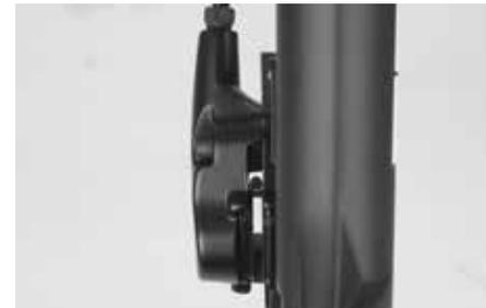
Kontrollieren Sie bei Scheibenbremsen vor dem Einbau des Laufrades, ob die Bremsbeläge exakt in den Aufnahmen im Bremssattel sitzen. Erkennbar ist dies daran, dass der Schlitz zwischen den Belägen parallel verläuft.
