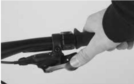
Heben Sie das Canyon Kid's MTB am Sattel hoch und drehen Sie an der Kurbel. Kontrollieren Sie die Schaltungsfunktion. Weitere Information zur Schaltungseinstellung finden Sie im Kapitel „Die Schaltung“.
