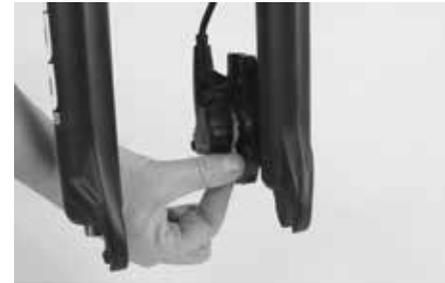
Entfernen Sie nun die Transportsicherungen an der Vorderrad-Bremse. Näheres zu Bremsen finden Sie im Kapitel „Die Bremsanlage“ in der Vollversion des Canyon Fahrradhandbuchs Mountainbike auf unserer Website [www.canyon.com](http://www.canyon.com). Beachten Sie auch die Anleitung des Komponentenherstellers.
