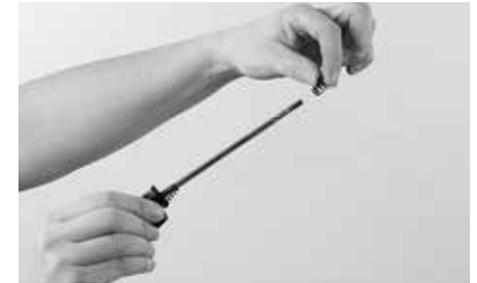
Nehmen Sie den Schnellspanner für das Vorderrad aus dem Tool Kit. Drehen Sie die Gegenmutter ab und ziehen Sie eine der Federn von dem Schnellspanner.
