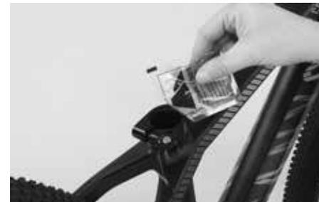
Das ist besonders in den Klemmbereichen von Gabelschaftrohr und Vorbau und Sattelstütze und Sitzrohr sinnvoll – zwei Klemmbereichen, bei denen zu hohe Klemmkraft die Bauteile zerstören kann, wodurch diese versagen können oder die Garantie erlischt.
