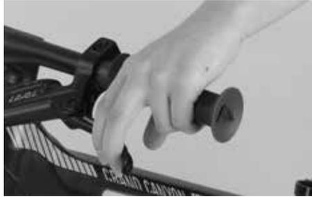
Machen Sie zusammen mit Ihrem Kind nach der Laufradmontage eine Bremsprobe im Stillstand. Der Hebel muss einen Druckpunkt aufweisen und darf sich nicht bis zum Lenker ziehen lassen. Weitere Informationen finden Sie im Kapitel „Die Bremsanlage“ in der Vollversion des Canyon Fahrradhandbuchs Mountainbike auf unserer Website [www.canyon.com](http://www.canyon.com)
