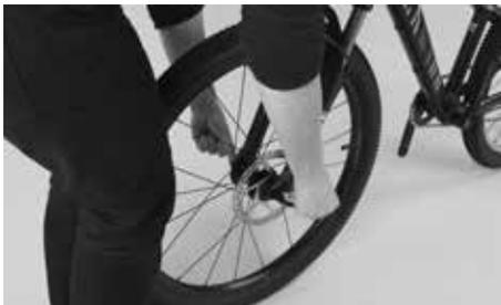
Bauen Sie das Vorderrad ein und achten Sie darauf, dass Sie die Bremsscheibe zwischen die Bremsbeläge schieben. Schließen Sie den Schnellspanner so, dass das Laufrad sicher befestigt ist. Lesen Sie zuvor das Kapitel „Umgang mit Schnellspannern und Steckachsen“.
