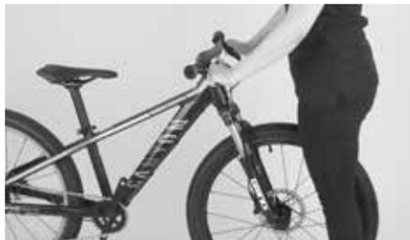
**⚠** Beachten Sie, dass die Verschraubungen von Vorbau, Lenker und Bremsen mit den vorgeschriebenen Drehmomenten angedreht werden müssen. Die entsprechenden Werte finden Sie auf dem jeweiligen Bauteil aufgedruckt, im Kapitel „Allgemeine Pflegehinweise und Inspektionen“ oder in den beiliegenden Anleitungen der Komponentenhersteller. Andernfalls wäre es möglich, dass die Bauteile sich lösen oder brechen. Dies kann zu einem schwerwiegenden Unfall führen.
