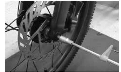
Wenn das Gewinde der Achse im Gewinde des rechten Gabelholms greift, drehen Sie die Steckachse gemäß dem vorgegebenen Drehmoment an. Verwenden Sie hierfür den Canyon Drehmomentschlüssel.
