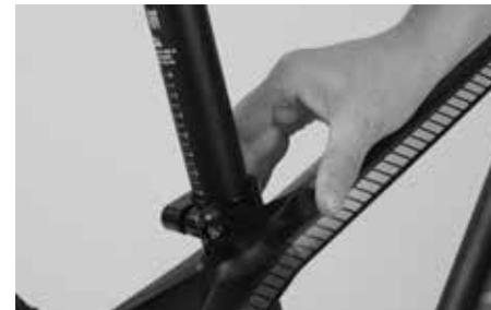
Die Sattelstütze muss mindestens bis unterhalb des Oberrohres bzw. bis zur MIN-/MAX-Markierung der Stütze im Rahmen stecken.
