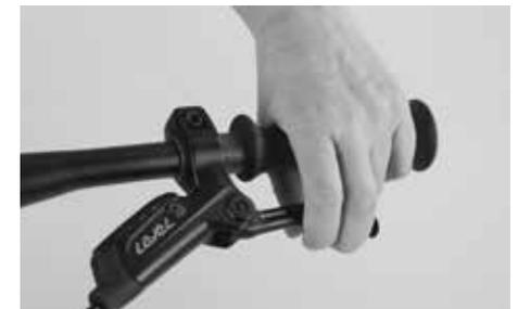
Betätigen Sie mehrfach den Bremshebel, um die Bremse betriebsbereit zu machen. Es muss sich ein Druckpunkt nach maximal ein Drittel des Hebelweges ergeben. Heben Sie das Laufrad an und geben Sie dem Laufrad einen starken Klaps von oben. Das Laufrad muss sicher befestigt sein und darf nicht klappern.
