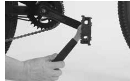
Bei einigen Pedaltypen müssen diese mit einem Innensechskantschlüssel von der Innenseite her angedreht werden.
