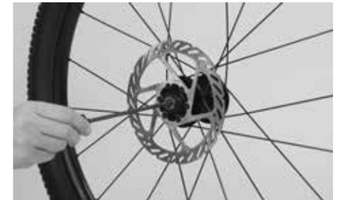
Schieben Sie den Schnellspanner in die hohle Achse des Vorderrades.
