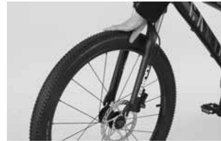
Nehmen Sie die Steckachse für das Vorderrad aus dem Tool Kit mit den Kleinteilen.
