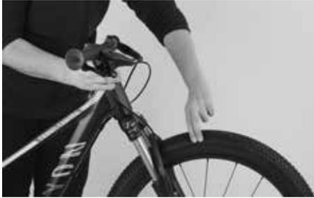
Lassen Sie Ihr Kind mehrmals am Bremshebel ziehen, nachdem Sie das Laufrad eingebaut und die Steckachse bzw. den Schnellspanner geschlossen haben und versetzen Sie anschließend das Laufrad in Drehbewegung.
