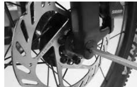
Richten Sie das Vorderrad zwischen den Radaufnahmen aus und schieben Sie die Steckachse von links durch die Radaufnahme und die Nabe.
