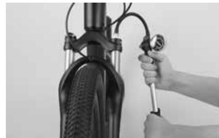
Pumpen Sie die Federgabel mit der speziellen Pumpe, die dem BikeGuard beiliegt, gemäß den Empfehlungen des Gabelherstellers zur Einstellung der Federhärte auf. Wenn Sie sich nicht absolut sicher sind oder Fragen haben, wenden Sie sich an unsere Service-Hotline +49 261 40 400-0.
