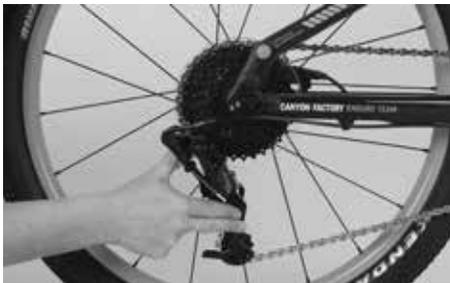
Schalten Sie alle Gänge durch und prüfen Sie, ob sichergestellt ist, dass das hintere Schaltwerk nicht mit den Speichen in Kontakt geraten kann oder die Kette nach innen zu den Speichen fällt, wenn die Kette auf dem größten Zahnrad läuft.
