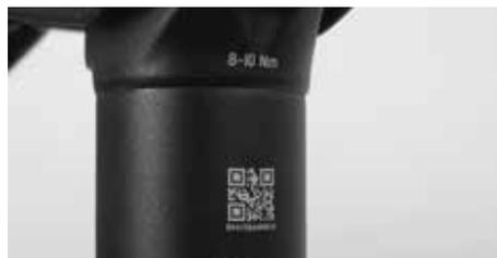
**i** Auf den weiteren Bauteilen stehen die Schraubendrehmomente auf dem Bauteil selbst. Halten Sie sich an die Werte auf den Aufklebern oder Aufdrucken.
