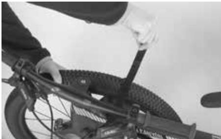
Halten Sie das Vorderrad fest. Lösen Sie vorsichtig das Band mit Klettverschluss, mit dem das Vorderrad am Oberrohr fixiert ist. Stellen Sie das Vorderrad vorsichtig beiseite.
