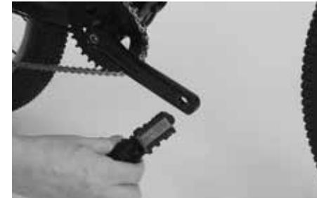
Drehen Sie die Pedale von Hand die ersten zwei bis drei Umdrehungen in die Gewinde der Kurbeln ein. Nehmen Sie erst dann einen Pedalschlüssel zu Hilfe und drehen Sie damit die Pedale fest.
