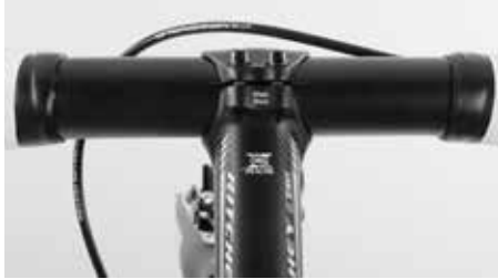
Ohjainkannattimen kannen ja ohjainkannattimen rungon välisten rakojen on oltava keskenään yhdensuuntaisia ja yhtä leveitä sekä ylhäällä että alhaalla
