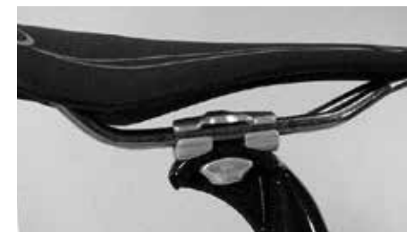
Kohdista satula niin, että satularunko kiinnitetään merkintöjen välille
