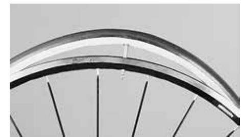
Työnnä hieman pumpattun renkaan venttiili vanteen venttiiliaukkoon
