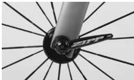
Loppuasnossa vivun on oltava suorassa kulmassa pikalukitusakseliin
