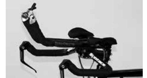
Ohjaustangon päässä sijaitsevilla vaihdeviivilla ohjataan takavaihtajaa ja etuvaihtajaa
