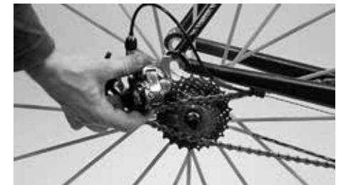
Vedä takavaihtajaa hieman taaksepäin takapyörän irrottamiseksi
