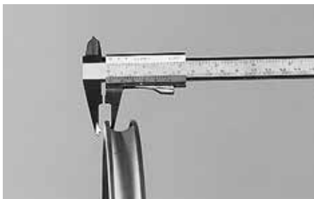
Tarkastuta ja mittautta vanteet säännöllisesti
