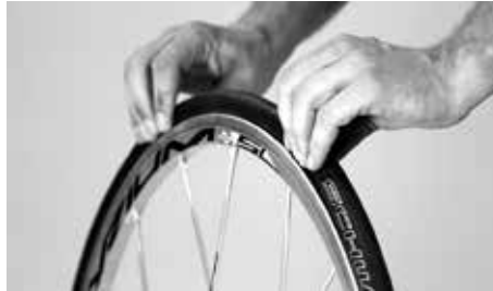
Painele rengasta varmistaaksesi, ettei sisärenkas ole jäänyt puristuksiin
