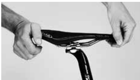
Kokeile, ettei kiinnitetty satula kallistu
