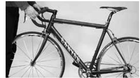
Yritä kääntää ohjaustankoa etupyörää vastaan
