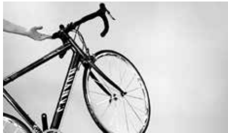
Tarkasta laakerin kevyt liikkuvuus nostamalla etupyörää ja tarkastamalla, voiko sitä liikuttaa helposti
