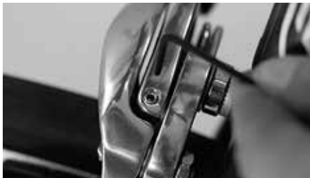
Kierrä pientä ruuvia, kunnes vasemman- ja oikeanpuoleisten jarrupalojen etäisyys vanteeseen on sama
