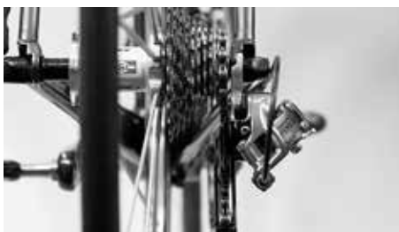
Katso takaa rataspakkaa ja tarkasta, että takavaihtajan ohjainrullat ovat täsmälleen asianomaisen takarattaan hammaskärkien alla
