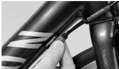
Kytöntäviajerin kiristäminen rungon säätöruuvista
