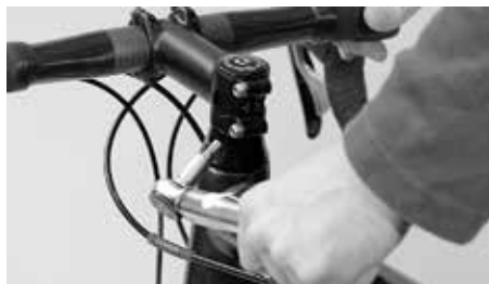
Kiristä tämän jälkeen ohjainkannatin ohjeenmukaiseen kiristysmomenttiin
