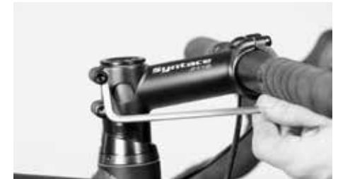
Avaa ohjainkannattimen sivulla olevat ruuvit
