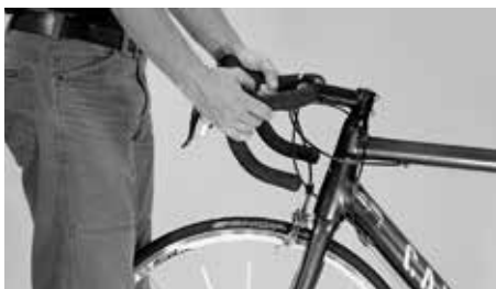
Yritä kääntää ohjaustankoa etupyörää vastaan
