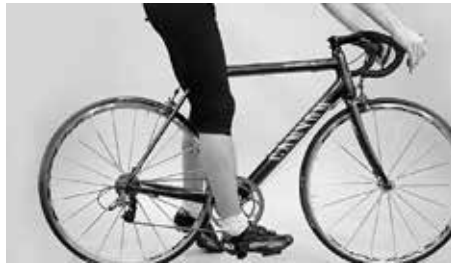
Kun kantapääsi on alimmassa asennossa olevalla polkimella, jalan on oltava täysin suorassa
