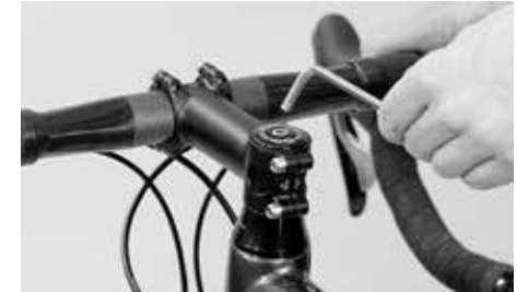
Säädä laakerin vällys ylhäällä olevalla upotetulla säätöruuvilla avattuasi sivulla olevat kiinnitysruuvit
