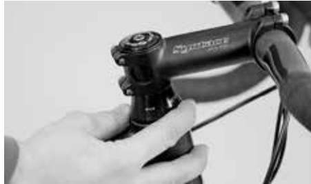
Tarkasta ohjainlaakerin vällys asettamalla sormesi laakerin kuoren ympärille ja liikuttamalla Canyonia edestakaisin jarrun ollessa vedettynä
