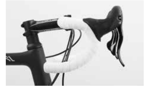
Ohjaustangon alaosan suoran osuuden tulisi olla samansuuntainen maan pinnan kanssa tai osoittaa takaa hieman alaspäin
