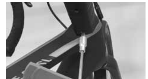
Kierrä siirtolevyn ruuvi kiinni
