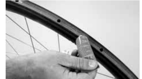
Rengasliiman levittäminen suoraan putkilosta
