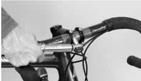
Kiristä ruuvit ohjeenmukaiseen kiristysmomenttiin
