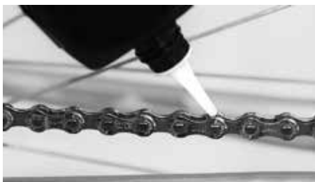
Levitä mahdollisimman hyvin puhdistettuihin ketjuniveliin ketjuöljyä
