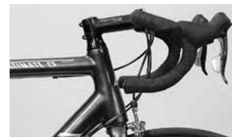
Jos olet kaatunut pyörällä, vaihda turvallisuussyistä kevytrakennemateriaalista valmistetut komponentit
