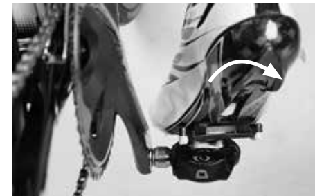
Kiinnitys avataan kääntämällä kantapäätä ulospäin
