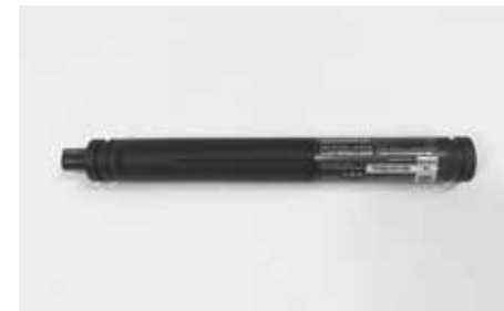
Di2:n akku voi olla myös näkymättömissä viistoputkeen asennettuna
