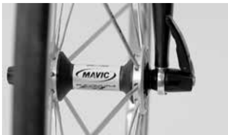
Tarkasta, ovatko molemmat kiekot vielä tiukasti kiinni haarukan päissä
