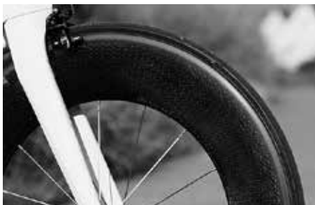
Hiilikuituvanteilla varustetuilla kiekkoilla on erityisiä jarrutusominaisuuksia
