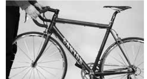
Yritä kääntää ohjaustankoa etupyörää ja ohjainkannattinta vastaan
