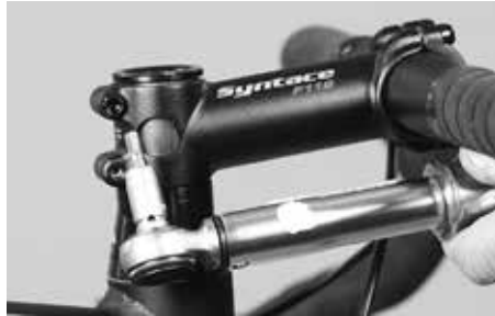
Tarkista ohjainkannattimen sivuilla olevat kiinnitysruuvit momenttiavaimella osiin painettujen tietojen mukaisesti
