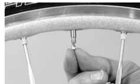
Kilpa- tai Sclaverand-venttiilien kohdalla venttiili on kierrettävä auki
