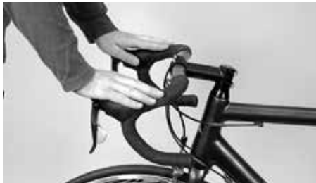
Ohjaustanko ei saa vääntyä voimakkaastikaan nykäistäessä
