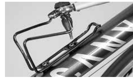
Noudata pullotelineen kiinnityksessä suurinta sallittua 5 Nm:n kiristysmomenttia
