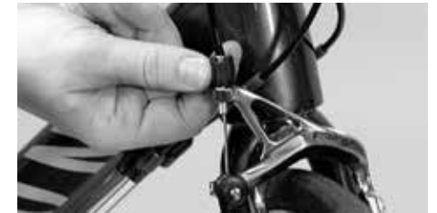
Pyälletyllä mutterilla säädät jarrujen tyhjän matkan
