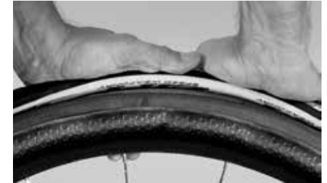
Paina rengasta sivuun, kunnes renkaan ja vanteen väliin muodostuu rako
