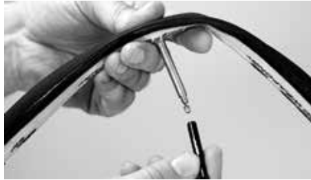
Venttiilin pidennyskappaleen asennus
