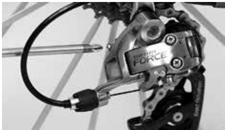
Kierrä rullakehikon ja kehän välisen etäisyyden säätämiseksi ruuvia, joka tukeutuu haarukan pään (drop out) päätypuoleen
