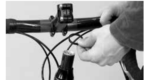
Poista välirenkaat ja työnnä ne takaisin paikalleen ohjainkannattimen yläpuolelle
