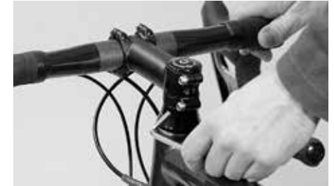
Avaa ohjainkannattimen sivulla olevat ruuvit
