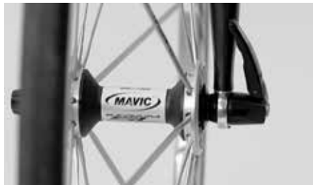
Pikalukituksen vivun on oltava lähes samansuuntainen pyörän kanssa, eikä se saa työntyä esiin sivulta
