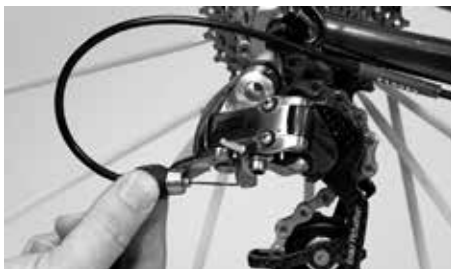
Kytkevävaijerin kiristäminen takavaihtajan säätöruuvista
