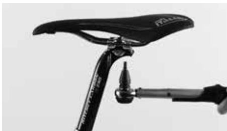
Kiristä molemmat ruuvit vuorotellen ja tasaisesti, älä missään tapauksessa ylitä suurinta sallittua kiristysmomenttia
