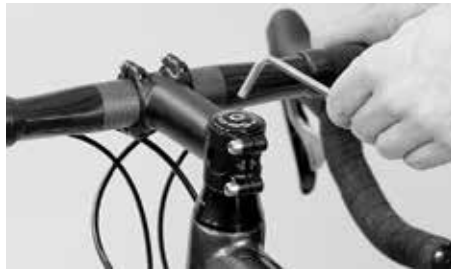
Säädä laakeri uudelleen
