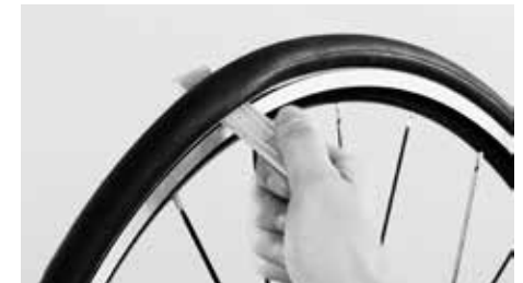
Renkaan saa irrotettua asennusvivulla
