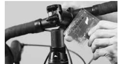
Levitä tarvittaessa etuhaarukan varteen tai ohjaustankoon hiilikuituosien asennuspastaa
