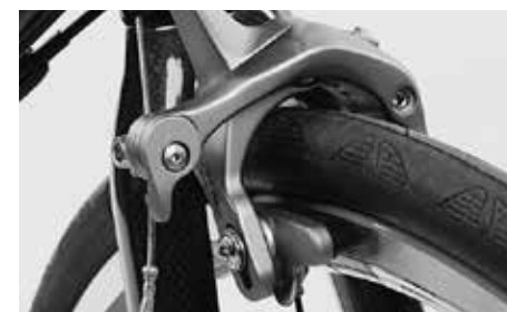
Kiristä jarrupalan kiinnitysruuvi määrättyllä kiristysmomentilla korkeuden säätämiseksi
