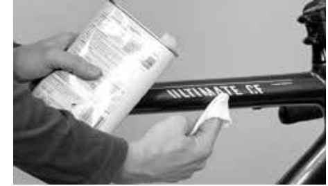
Maali- ja metallipintojen suojaaminen kovavahalla
