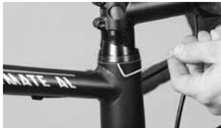
Säädä laakerin välykset sivuilla olevalla säätöruuvilla
