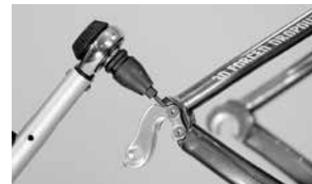
Jos vaihdat vaihtajankorvakkeen, älä missään tapauksessa ylitä suurinta sallittua 1,5 Nm:n kiristysmomenttia
