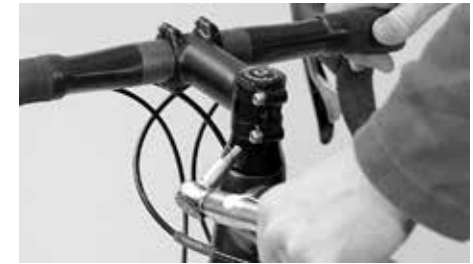
Kiristä sivuilla olevat ohjainkannattimen kiinnitysruuvit jälleen momenttiavaimella
