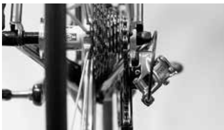
Tarkasta, onko ketju vielä eturattaan ja takarattaan päällä
