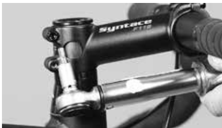
Kiristä kaikki etukannattimen kiinnitysruuvit momenttiavaimella ohjeiden mukaan
