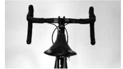
Varmista, ettei satula ole vinoissa. Tämän teet katsomalla, että satula on linjassa vaakaputken kanssa
