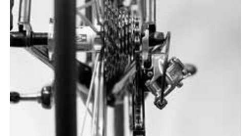
Vaihda pienimmälle takarattaalle ennen takapyörän irrottamista
