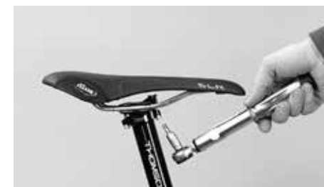
Kiristä ruuvit vuorotellen ja tasaisesti ohjeenmukaiseen kiristystiukkuuteen
