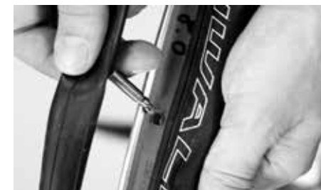
Venttiilin työntäminen vanteen lukkoon
