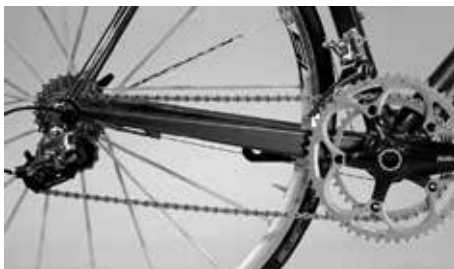
Pyörän pysäköinti siten, että ketju on pienimmällä takarattaalla ja pienellä eturattaalla
