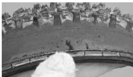
Humedezca la base del neumático con agua jabonosa antes del montaje
