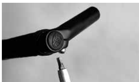
Vuelva a apretar los tornillos con el par de apriete necesario
