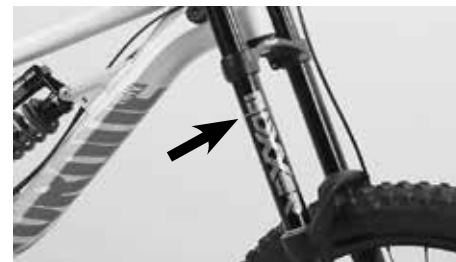
Horquilla de suspensión - Ajuste del recorrido del muelle
