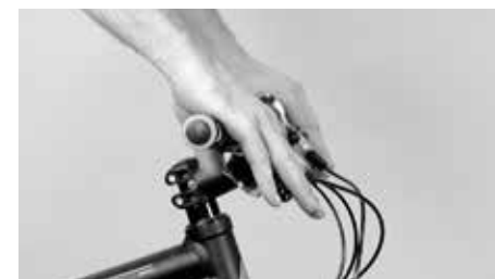
Al colocar sus dedos en las manetas de freno, su mano y su antebrazo deberían formar una línea recta
