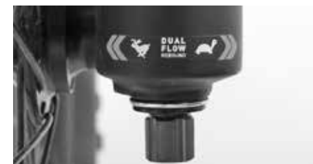
La amortiguación de rebote frena el rebote
