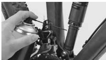
Después de la limpieza, aplique un lubricante homologado
