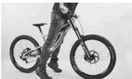
Presione hacia abajo la horquilla con el freno delantero accionado
