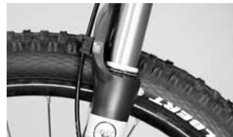
Coloque una brida sujetacables sobre la barra fija
