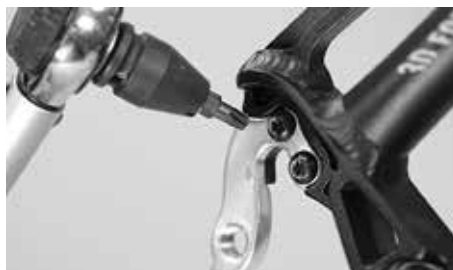
No sobrepase nunca el par máximo de apriete de 1,5 Nm al sustituir la patilla de cambio
