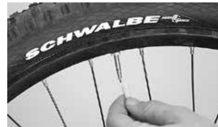
Desenroscar la caperuza protectora de plástico
