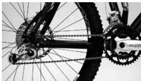
Coloque la bicicleta con la cadena en el piñón y el plato más pequeños
