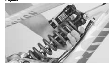
En el caso de muelles de acero, gire la ruedecilla de ajuste moleteada para aumentar la precarga del muelle
