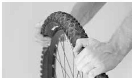
Presione el neumático hacia ambos lados para evitar que la cámara quede aplastada
