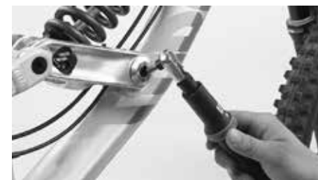
Compruebe regularmente el asiento de los tornillos de la parte trasera conforme a los partes de apriete indicados
