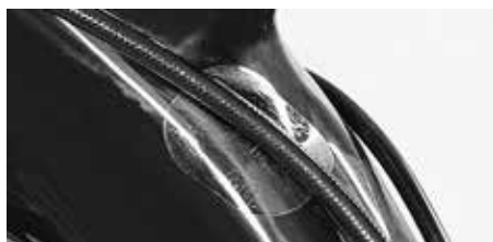
Etiquetas autoadhesivas especiales protegen de los daños a los componentes de carbono
