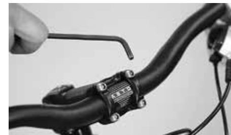
Abra el (los) tornillo(s) Allen situado(s) en la cara delantera de la potencia
