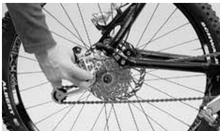
Para desmontar la rueda trasera, empuje el cambio trasero un poco hacia atrás
