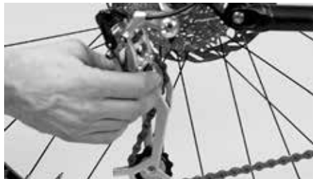
El cambio trasero no debe engancharse en los radios
