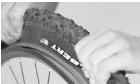
Presione el neumático hacia el centro de la llanta
