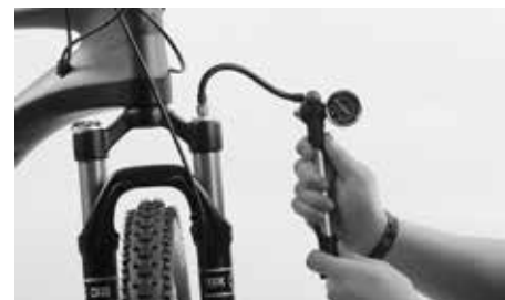
Ajuste de la dureza con una bomba para amortiguadores
