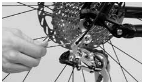
Para ajustar la distancia entre el balancín y el casete, gire el tornillo que se apoya en la cara frontal de la puntera
