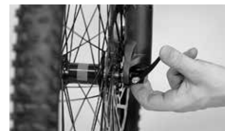
Asegúrese de la colocación correcta del cierre rápido
