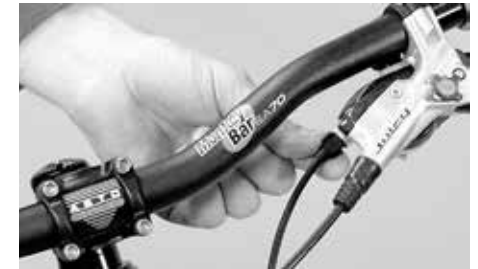
Reajustar la tensión del cable del cambio actuando sobre el tornillo de ajuste
