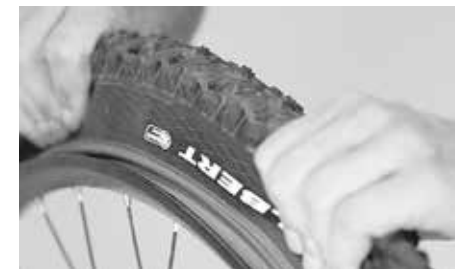
Empuje el neumático sin cámara hacia el centro de la llanta
