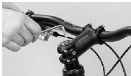
Reajuste el juego de dirección y luego vuelva a apretar la potencia
