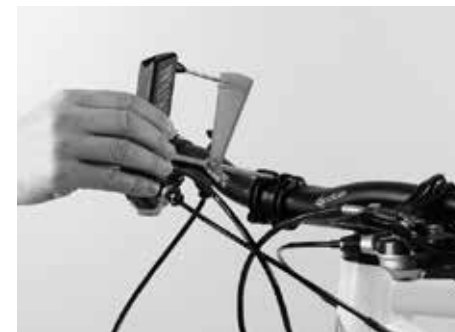
Montaje del manillar con la llave dinamométrica de Canyon
