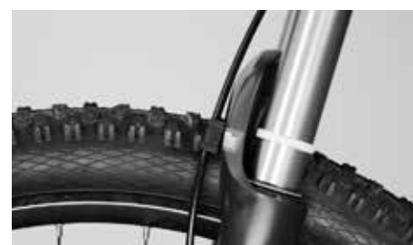
Según se desplace la brida sujetacables, podrá constatar el recorrido usado
