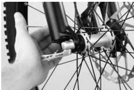
Cierre el cierre rápido con la base del pulgar
