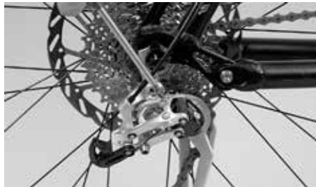
Limite la zona de movimiento del cambio trasero actuando sobre los tornillos que hacen de tope final
