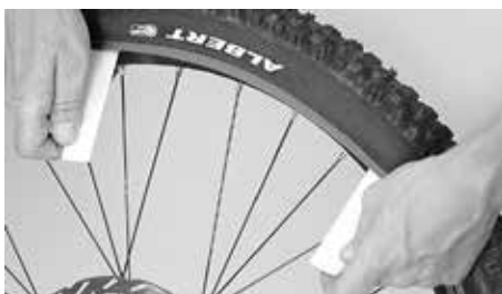
Coloque el desmontable y haga palanca en el borde de la llanta para sacar el neumático
