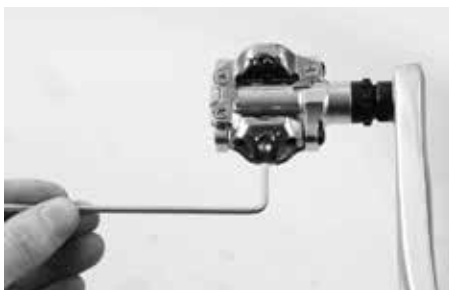
Ajuste la fuerza de desenganche del pedal según sus propias necesidades
