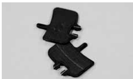
Zapatas / pastillas cuyo grosor queda por debajo de un milímetro, deben cambiarse por piezas de recambio originales
