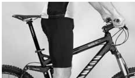
Compruebe la distancia entre el tubo superior y la entrepierna
