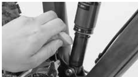
Limpieza del amortiguador con una esponja y agua
