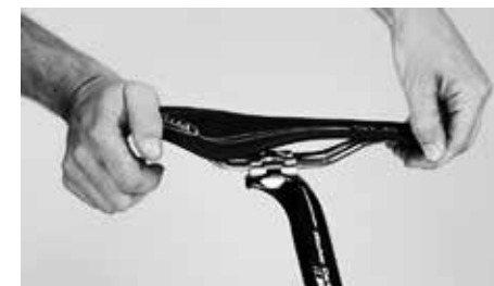
Compruebe si el sillín que acaba de fijar bascula
