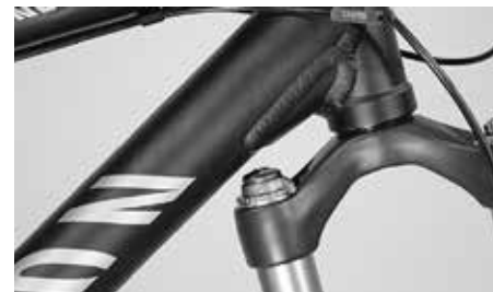
La corona de la horquilla debe girar libremente por debajo del cuadro
