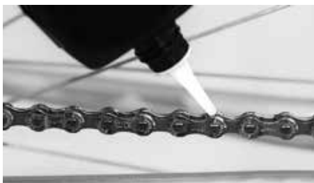
Aplique aceite para cadenas en los eslabones, cuando estén brillantes
