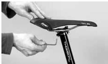
Suelte los dos tornillos dos o tres vueltas como máximo
