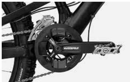
No sobrepase los pares de apriete indicados por los fabricantes de los juegos de pedalier
