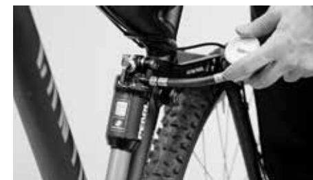
En amortiguadores de aire, se varía la presión de aire para realizar el ajuste
