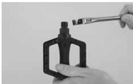
Lubrifique levemente a rosca do pedal antes de proceder ao aparafusamento com uma massa consistente para montagem à venda no mercado.
