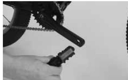
Aparafuse os pedais à mão na rosca do pedaleiro, as primeiras duas ou três voltas. Só depois deve recorrer à ajuda de uma chave de pedais, apertando-os bem.
