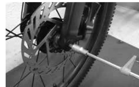
Quando a rosca do eixo encaixar na rosca da barra esquerda do garfo, aperte o eixo passante de acordo com o binário prescrito. Para isso, utilize a chave dinamométrica Canyon.
