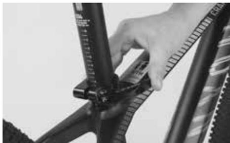
Alinhe o selim e feche o aperto rápido ou aperte o parafuso de fixação do tubo do selim não demasiado, i. e. não ultrapasse o binário máximo autorizado. Utilize event. a chave dinamométrica Canyon. Encontrará indicações sobre apertos rápidos no capítulo "Como lidar com apertos rápidos e eixos passantes".
