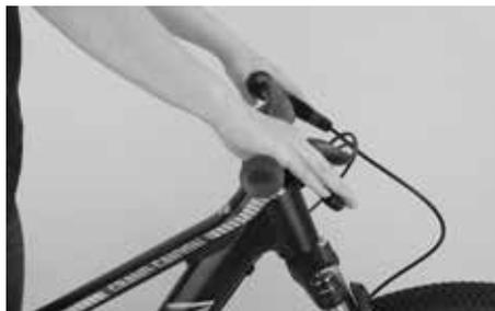
Ajuste o guiador com a roda dianteira montada e a pressão adequada do pneu. Nas bicicletas de montanha prontas a utilizar, as manetes do travão ficam ligeiramente a apontar para baixo. Quando o seu filho está sentado no selim, o braço esticado e os dedos devem formar uma linha reta, quando os dedos estiverem assentes na manete do travão.
