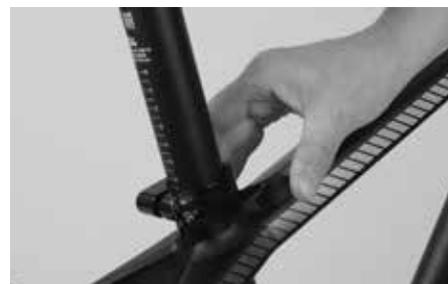
O espigão do selim tem de estar inserido no quadro, no mínimo abaixo do tubo superior ou até à marca MIN/MAX do espigão no quadro.
