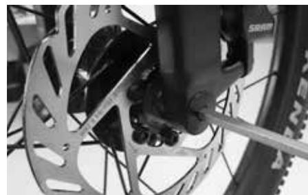
Alinhe a roda dianteira entre as ponteiros e desloque o eixo passante pela esquerda através da ponteira e do cubo.
