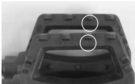
Antes de montar os pedais, repare nas inscrições marcadas nos eixos. Um "R" significa pedal direito e um "L" significa pedal esquerdo.
