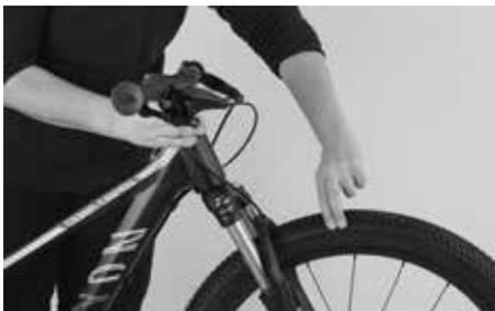
Deixe o seu filho acionar várias vezes a manete de travão, após ter montado a roda e fechado o eixo passante ou o aperto rápido, e, por fim, ponha a roda a rodar.
