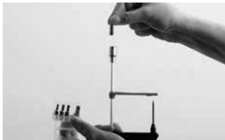
Introduza a chave allen completamente na cabeça do parafuso.
