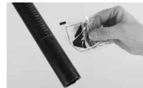
Antes de aplicar a pasta para montagem Canyon, retire todas as partículas de sujidade e resíduos de lubrificantes da superfície a tratar. A seguir, aplique com um pincel ou uma camurça, uma camada fina e uniforme de pasta para montagem Canyon sobre as superfícies limpas.
