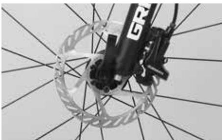
Normalmente, o disco do travão não pode roçar na pinça de travão nem nas pastilhas de travão com força. Ponha as duas rodas a rodar e verifique, se as rodas rodam de forma concêntrica.
