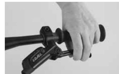
Acione várias vezes a manete do travão para que o travão fique pronto para funcionar. Tem de surgir um ponto de resistência após, no máximo, um terço do percurso da alavanca. Levante a roda e dê-lhe uma pancada de cima para baixo. A roda tem de estar fixa de forma segura e não pode chocalhar.
