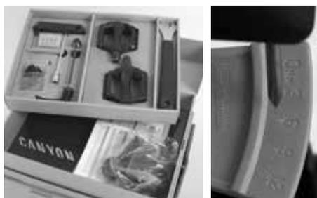
Rode devagar o punho da chave dinamométrica Canyon. Se o parafuso começar a apertar, o ponteiro vai-se deslocando sobre a escala. Termine o movimento rotativo, assim que o ponteiro esteja sobre o número do binário prescrito.
