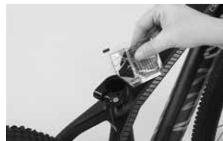
Isto é especialmente importante nas zonas de aperto do tubo do garfo, do avanço, do espigão do selim e do tubo do selim - duas zonas de aperto, nas quais uma força de aperto demasiado grande pode danificar os componentes, dando origem a que eles falhem ou a garantia perca a validade.
