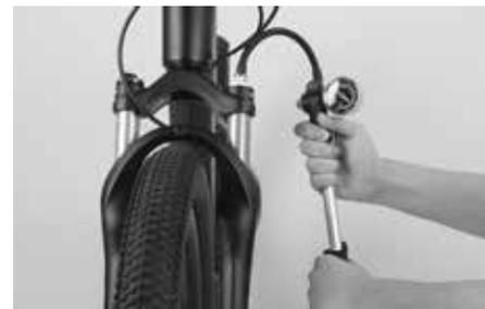
Encha o garfo de suspensão, acionando a bomba especial que acompanha o BikeGuard, de acordo com as recomendações do fabricante do garfo sobre o ajuste do valor da pressão da suspensão. Se não tiver a certeza absoluta ou se tiver alguma questão, contacte a nossa linha direta de assistência técnica +351 922 127 885.
