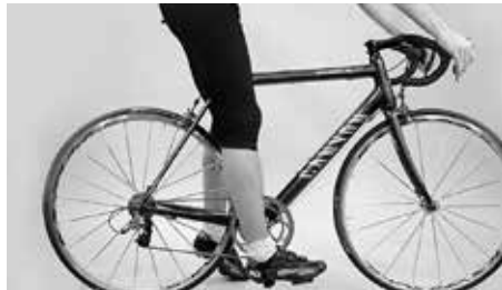
Cuando el talón está en el pedal, el cual se encuentra en la posición más baja, la pierna debe estar completamente extendida
