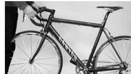
Intente girar el manillar con respecto a la rueda delantera y la potencia
