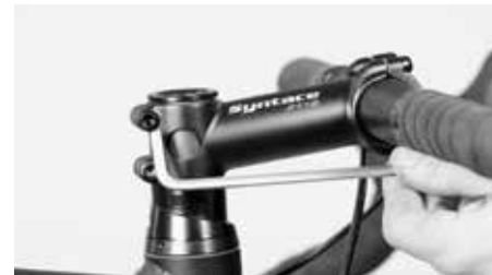
Suelte los tornillos laterales de la potencia
