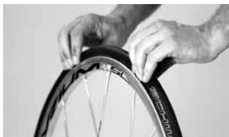
Presione el neumático para evitar que la cámara quede aplastada
