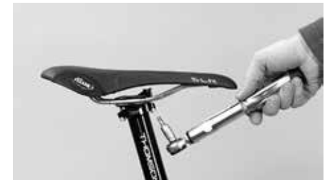
Vuelva a apretar los tornillos uniforme y alternativamente con el par de apriete prescrito
