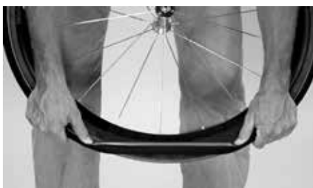
Haga pasar el tubular por el borde de la llanta con los pulgares
