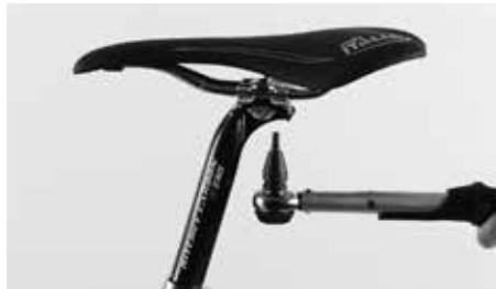
Apriete los dos tornillos uniforme y alternativamente y no sobrepase nunca el par máximo de apriete
