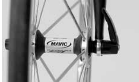
Compruebe que las dos ruedas siguen bien fijadas en las punteras
