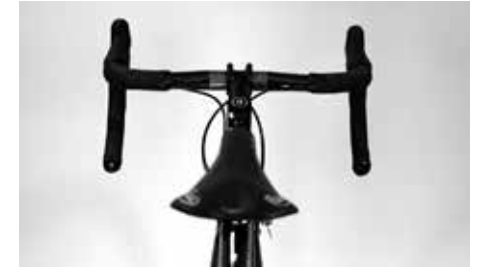
Compruebe la posición del sillín mirando a lo largo del tubo superior para asegurarse de que no se ha desplazado
