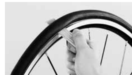
Haciendo palanca con un desmontable se puede sacar el tubular
