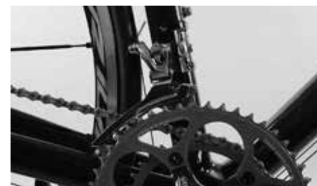
Ajuste la zona de movimiento del desviador delantero
