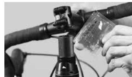
Aplique algo de pasta de montaje para componentes de carbono al cuello de la horquilla
