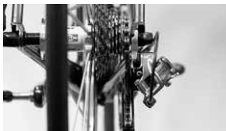
Observe el casete desde atrás fijándose en las ruedecillas del cambio trasero: ¿quedan exactamente debajo de los dientes del piñón correspondiente?
