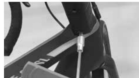
Apriete el tornillo de la placa de transición
