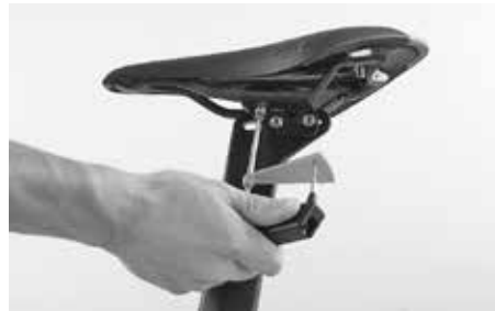
Apriete el tornillo con una llave dinamométrica Canyon
