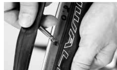
Introduzca la válvula en el orificio de la llanta
