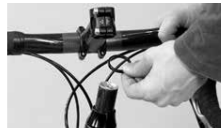
Extraiga los separadores y vuelva a colocarlos por encima de la potencia
