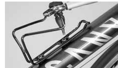
No sobrepase un par máximo de apriete de 5 Nm para el portabidón
