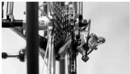
Cambie al piñón más pequeño antes de desmontar la rueda trasera
