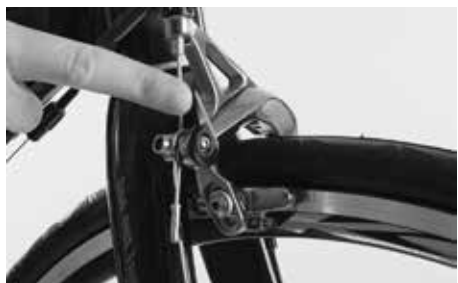
Abra la palanca de desacople rápido en el freno
