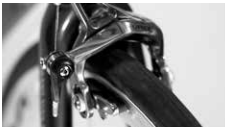
Control del centrado mediante el freno
