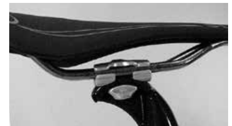
Coloque el sillín de manera que las varillas queden fijas dentro de las marcas
