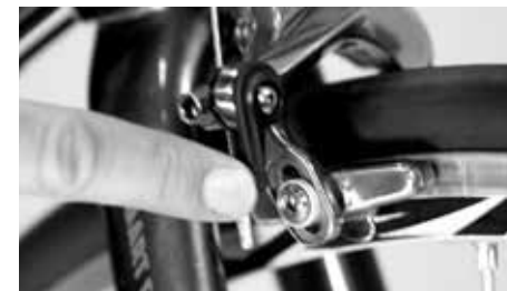
Control del centrado mediante las zapatas
