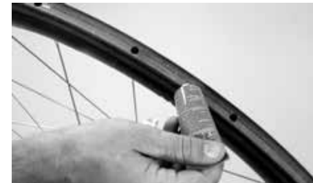
Aplicar el pegamento directamente del tubo
