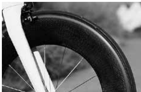
Las ruedas con llantas de carbono tienen un comportamiento particular a la hora de frenar
