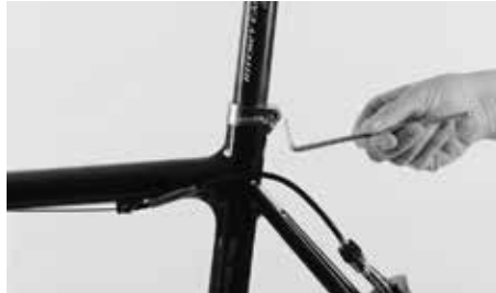
Para ajustar la altura de sentado, suelte el tornillo que sujeta la tija de sillín
