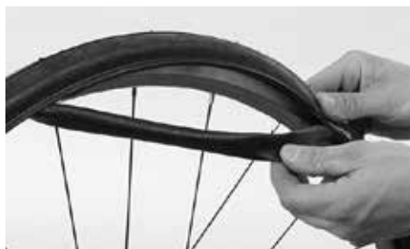
Saque la cámara del neumático
