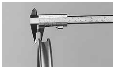
Haga revisar el espesor de las paredes de sus llantas a más tardar después de reponer el segundo juego de zapatas
