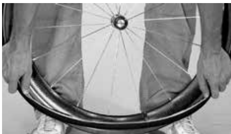
Coloque el tubular en el fondo de la llanta
