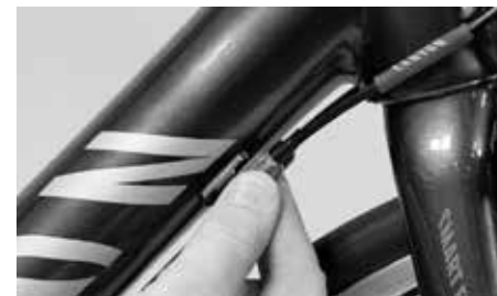
Vuelva a tensar el cable con el tornillo de ajuste en el cuadro
