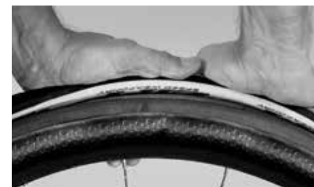
Presione el tubular a un lado hasta que se forme un espacio
