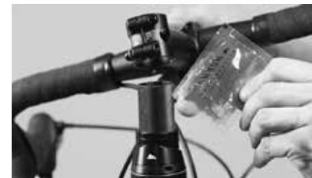
Si fuera necesario, aplique algo de pasta de montaje para componentes de carbono al cuello de la horquilla o al manillar
