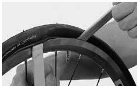
Coloque el desmontable y haga palanca en el borde de la llanta para sacar el neumático
