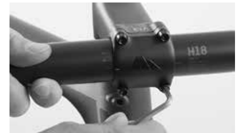
Abra el (los) tornillo(s) Allen situado(s) en la cara delantera de la potencia
