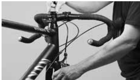
Coloque el tapón, empujelo hacia la horquilla que se mantiene sujeta y vuelva a apretar la potencia alineada con el par de apriete prescrito
