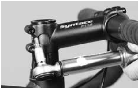
Compruebe la fijación de los tornillos de apriete laterales de la potencia con una llave dinamométrica siguiendo los valores indicados
