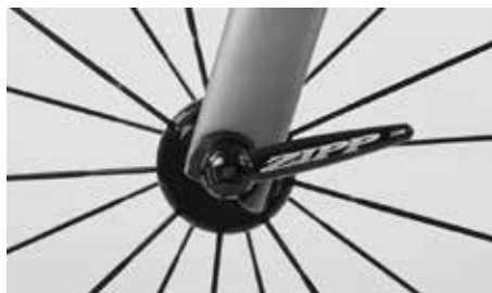
En su posición final, la palanca debe quedar perpendicular al eje del cierre rápido
