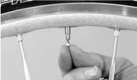
En la válvula Sclaverand, hay que aflojar la válvula
