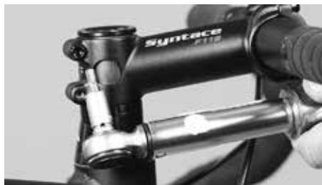
Apriete todos los tornillos de apriete de la potencia con la llave dinamométrica, siguiendo los valores indicados
