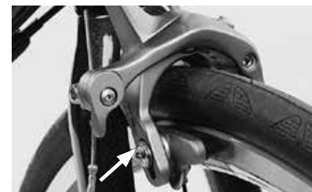
Después de ajustar la altura, apriete el tornillo de fijación de la zapata con el par de apriete prescrito
