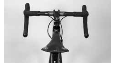
Compruebe la posición del sillín mirando a lo largo del tubo superior para asegurarse de que no se haya desplazado
