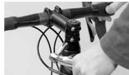
Vuelva a apretar los tornillos de apriete laterales de la potencia con la llave dinamométrica
