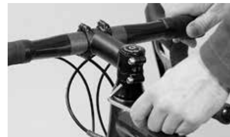
Suelte los tornillos laterales de la potencia
