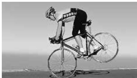
Al frenar, el peso tiende a desplazarse hacia delante
