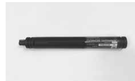
La batería Di2 también se puede montar oculta en el tubo inferior
