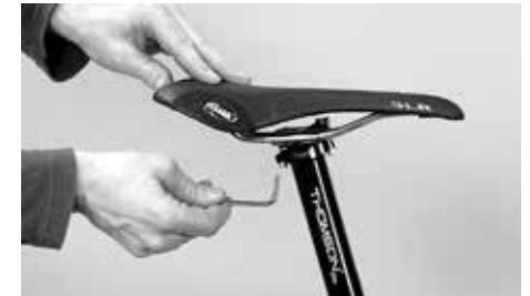
Suelte los dos tornillos como máximo dos o tres vueltas
