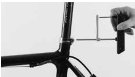
Tenga cuidado de no apretar demasiado el tornillo que sujeta la tija de sillín
