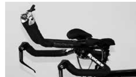
Con los mandos de cambio en los extremos del manillar se accionan el cambio trasero y el desviador delantero
