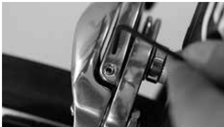
Gire el tornillo pequeño hasta que las zapatas queden a la misma distancia de la llanta, a la izquierda y a la derecha
