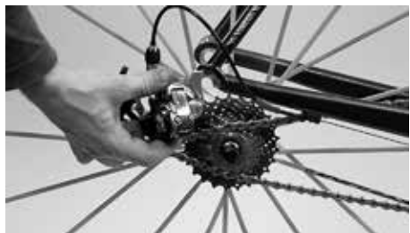
Para facilitar el desmontaje de la rueda trasera, tire el cambio trasero un poco hacia atrás
