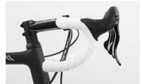
La parte recta del manillar inferior debe estar paralela al suelo o estar orientada ligeramente hacia abajo
