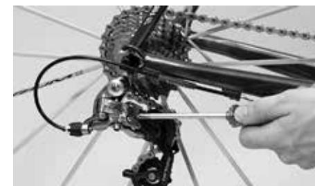
Limite la zona de movimiento del cambio trasero actuando sobre los tornillos que hacen de tope final
