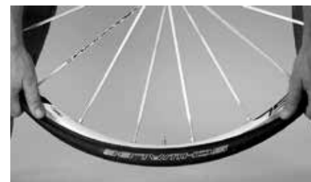
Empuje con las manos el neumático en la llanta
