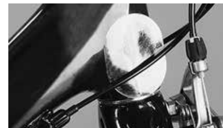
Etiquetas autoadhesivas especiales protegen de los daños a los componentes de carbono
