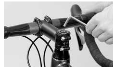
Afloje los tornillos de apriete laterales y ajuste la holgura del juego de dirección actuando sobre el tornillo de ajuste, hundido en la parte de arriba
