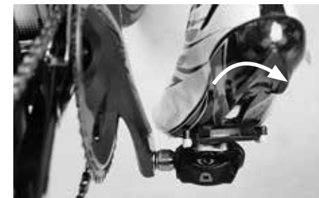
Basta girar el talón hacia fuera para soltar la fijación de los pedales automáticos
