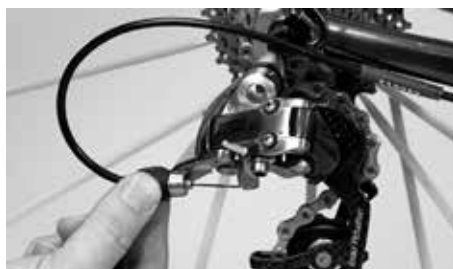
Retensar el cable con el tornillo de ajuste en el cambio trasero
