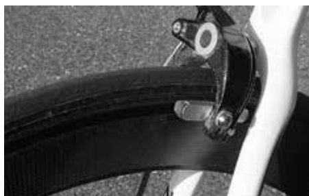
Para las llantas de carbono se necesitan zapatas especiales que se indican en las instrucciones de uso del fabricante de las ruedas
