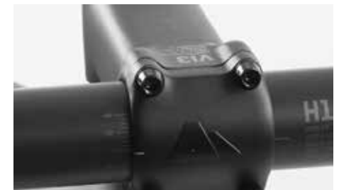
La ranura superior tiene que estar completamente cerrada
