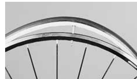
Introduzca la válvula del tubular ligeramente inflado en el orificio de la llanta
