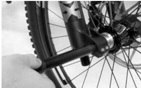
Centrare la ruota anteriore tra i forcellini e spostare il perno da destra attraverso i forcellini ed il mozzo. Inserire una chiave a brugola adatta nel perno.
