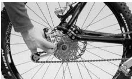
Per smontare la ruota posteriore sposti leggermente indietro il cambio posteriore
