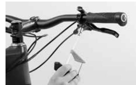
Serrare la vite con la coppia di serraggio prescritta da SRAM di 5-6 Nm.
