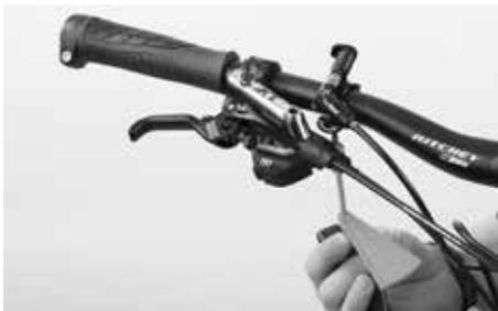
La leva del freno e la leva del cambio sono montate sul manubrio. Montare sul manubrio la leva di comando e precisamente sul lato interno delle fascette delle leve del freno e del cambio. Avvitare leggermente le viti in modo che la leva di comando si possa ancora muovere e spostare leggermente.
