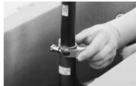
Raddrizzare la sella e chiudere il bloccaggio rapido o la vite sul bloccaggio rapido del reggisella. Non serrare eccessivamente la vite o il bloccaggio rapido del reggisella. Se necessario rimuovere la pellicola di protezione dalla sella.
