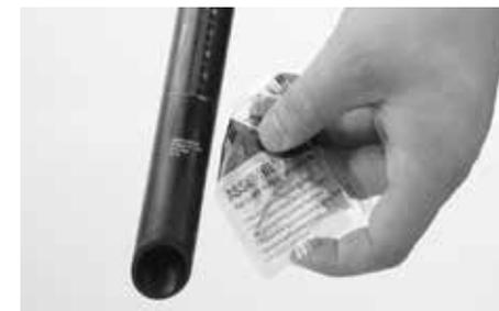
Applicare ora della pasta di montaggio Canyon sulla parte inferiore del reggisella e all'interno del piantone del telaio, ovvero sulle zone di bloccaggio del reggisella. Il reggisella deve scivolare facilmente nel telaio senza che sia necessario spingerlo o ruotarlo. Se ciò non dovesse essere possibile, aprire ulteriormente il bloccaggio rapido del reggisella.
