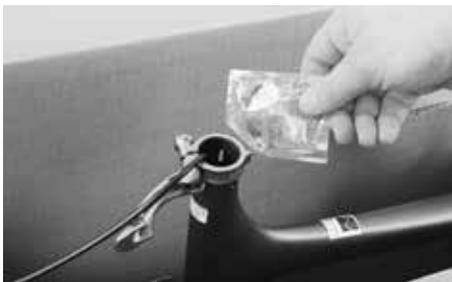
Applicare ora della pasta di montaggio Canyon sulla parte inferiore del reggisella e all'interno del piantone del telaio, ovvero sulle zone di bloccaggio del reggisella.
