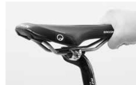
Regolare la sella e avvitare il bloccaggio rapido o la vite sul bloccaggio rapido del reggisella senza serrare troppo, ovvero senza superare la coppia di serraggio consentita. Eseguire questa operazione utilizzando la chiave dinamometrica Canyon.
