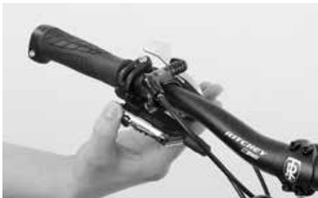
Allentare la vite della fascetta della leva del freno adiacente e ruotare la leva del freno verso il basso.
