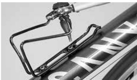
Per il portaborraccia utilizzare una coppia di serraggio massima pari a 5 Nm
