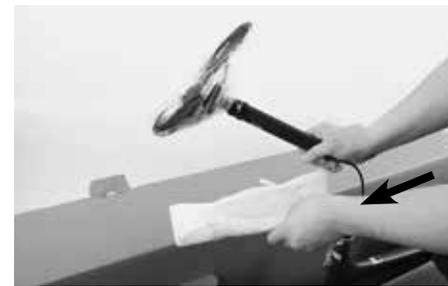
Se la Canyon è dotata di reggisella regolabile in altezza, questo deve essere montato prima di estrarre la Canyon dal BikeGuard. Il reggisella regolabile, una volta assemblato con il resto della bicicletta, è collegato alla leva montata sul manubrio tramite un tubo che scorre attraverso il piantone.
