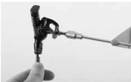
Prendere la punta adeguata dalla scatola della minuteria e svitare la vite Torx sulla leva di comando.
