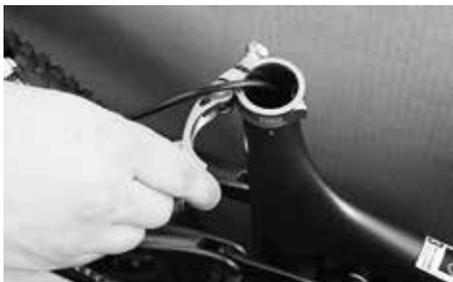
Il reggisella deve scivolare facilmente nel telaio senza che sia necessario spingerlo o ruotarlo. Se ciò non dovesse essere possibile, aprire ulteriormente il bloccaggio rapido del reggisella.
