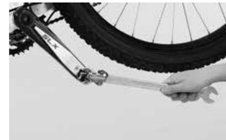
Nel caso di alcuni pedali sarà necessario serrare i pedali con l'ausilio di una punta con testa Allen.
