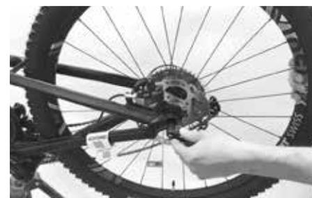
Infine controllare che la ruota posteriore sia centrata tra i foderi del carro posteriore. Verificare la stabilità del perno passante o del bloccaggio rapido e dei bloccaggi di sicurezza.
