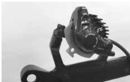
Rimuovere ora le staffe di sicurezza per il trasporto sul freno della ruota posteriore. Nel caso di freni a disco, prima di montare la ruota, verificare se le pastiglie dei freni si trovano esattamente nella pinza freno: la fessura tra le pastiglie deve essere parallela in tutte le sue parti e gli indicatori di usura devono trovarsi nella posizione prevista.
