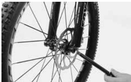
Introdurre la ruota anteriore nella forcella e contemporaneamente infilare il disco del freno nella pinza. Centrare la ruota anteriore tra i forcellini e spostare il perno con la leva di bloccaggio rapido E-Thru aperta, da destra attraverso i forcellini ed il mozzo.
