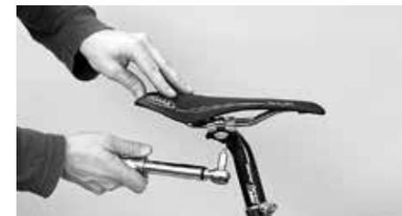
Avviti entrambe le viti progressivamente ed in senso alternato, non superi mai la coppia di bloccaggio massima consentita
