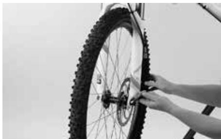
Montare la ruota anteriore e assicurarsi di infilare il disco del freno tra le pastiglie. Chiudere il bloccaggio rapido in modo tale che la ruota sia fissata saldamente. Leggere prima il capitolo **“Uso di bloccaggi rapidi e di perni passanti”** nel manuale **“Mountain bike”**.
