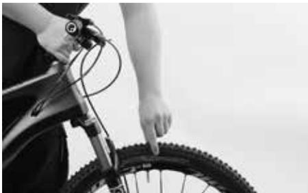
Azionare la leva del freno più volte, dopo aver montato la ruota e chiuso il perno passante o il bloccaggio rapido, quindi fare girare la ruota.
