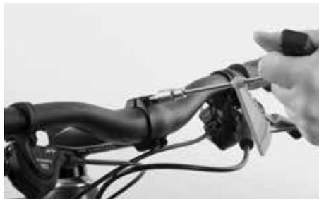
Per concludere utilizzare la chiave dinamometrica Canyon per avvitare le viti di serraggio in modo alternato. Non superate la coppia di serraggio massima che solitamente è impressa sull'attacco manubrio!
