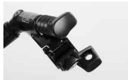
Né la leva del cambio né la leva del freno sono montate sul manubrio. Sulla fascetta della leva di comando è montato anche un pezzo di raccordo, detto Matchmaker.
