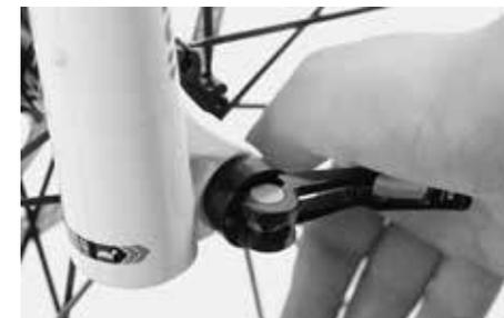
Ruotare ora la leva con forza in senso orario fino a che il perno sarà ben avvitato. Controllare che la leva di bloccaggio rapido nell'avvitare non sia uscita dall'apposita cavità del perno.
