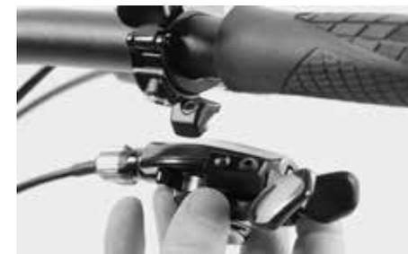
Montare la leva del cambio sul Matchmaker. Serrare la vite con la coppia di serraggio prescritta da SRAM di 2,8-3,4 Nm.
