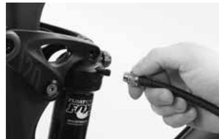
Gonfiare l'ammortizzatore con la speciale pompa inclusa nel BikeGuard, rispettando le indicazioni del produttore dell'ammortizzatore. Le istruzioni del produttore dell'ammortizzatore sono contenute nel CD allegato.
