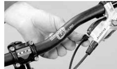
Usi la vite di registrazione per regolare la tensione del cavo del cambio
