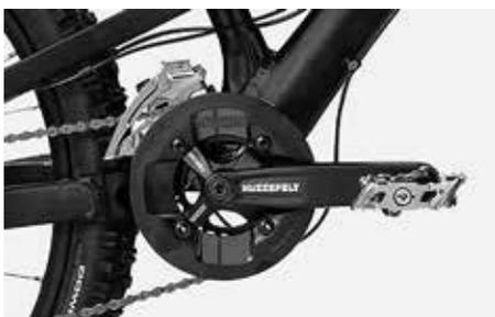
Non superi la coppia di bloccaggio del produttore di movimenti centrali
