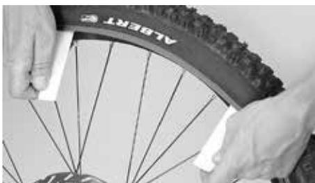
Collocazione della leva di montaggio e sollevamento del fianco della copertura facendo leva sul bordo del cerchio
