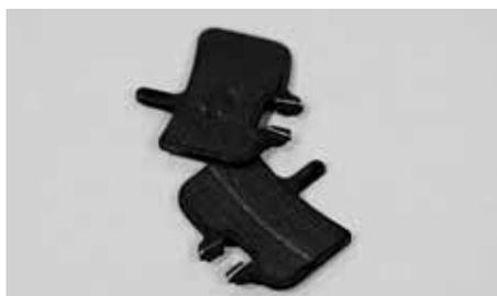
Pattini con uno spessore inferiore ad un millimetro devono essere sostituiti con parti di ricambio originali
