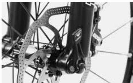
Se la leva non dovesse chiudersi completamente, aprirla di nuovo e ruotare leggermente il perno in senso antiorario. Provare nuovamente a chiudere la leva di bloccaggio rapido.
