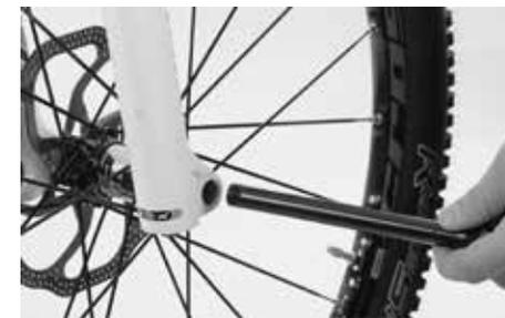
Sistema con perno passante RockShox Maxle e Maxle Lite 15 e 20 mm
