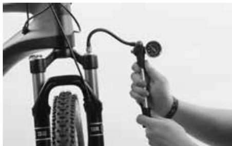
Gonfiare la forcella ammortizzata con la speciale pompa inclusa nel BikeGuard, rispettando le indicazioni del produttore della forcella per la regolazione della rigidità. Le istruzioni del produttore della forcella ammortizzata sono contenute nel CD allegato.
