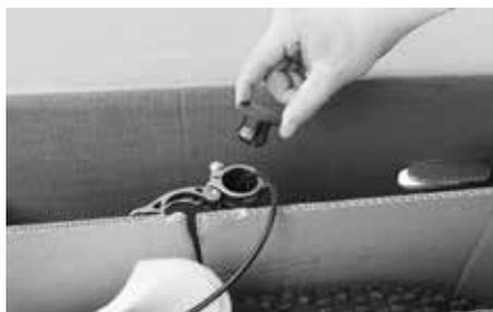
Rimuovere il cappuccio protettivo del piantone del telaio.
