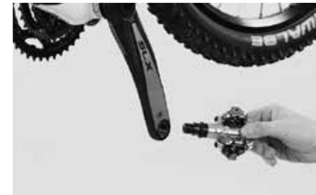
Con la mano fare girare due-tre volte i pedali fissandoli nei filetti delle pedivelle. Servirsi quindi di una chiave per pedali per fissare i pedali.
