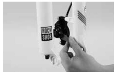
Rimuovere la pellicola di protezione dalla forcella se presente. Cercare di eseguire questa operazione solo con le mani. Se ciò non dovesse essere possibile, servirsi di una forbice e in nessun caso di un cutter.
