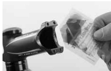
Questo accorgimento è utile soprattutto nelle zone di bloccaggio del manubrio e dell'attacco manubrio, del canotto della forcella e dell'attacco manubrio o del reggisella e del piantone, tre zone di bloccaggio in cui le forze di serraggio eccessive possono rovinare i componenti causandone il cedimento o la perdita della garanzia.
