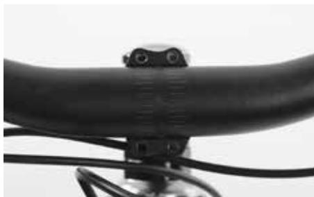
Posizionare il manubrio in base alle marcature all'interno della zona di bloccaggio. Controllare che i cavi bowden e tubi non siano storti o piegati e che scorrano con raggi uniformi al manubrio o al freno.
