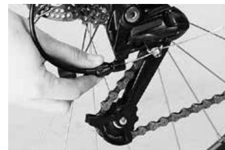
Regolazione del cavo del cambio con la vite di registrazione sul cambio posteriore
