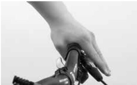
Regolare il manubrio con la ruota anteriore montata e con la pressione di gonfiaggio ottimale. Sulla mountain bike pronta per la messa in strada le leve del freno sono leggermente inclinate verso il basso. Una volta in sella, con le dita appoggiate sulla leva del freno, le braccia distese e le dita devono formare una linea retta.
