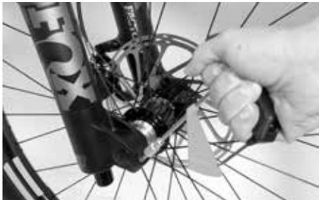
Avvitare uniformemente le 4 viti e quindi serrarle a una coppia di bloccaggio di 2,2 Nm con la chiave dinamometrica Canyon.
