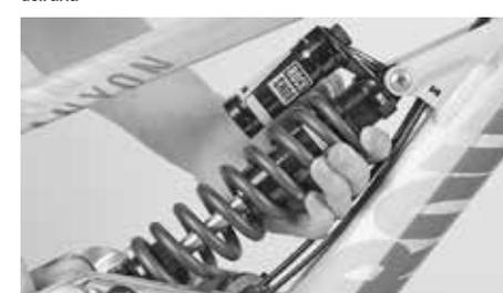
Il tensionamento delle molle di acciaio viene modificata girando l'anello di registrazione zigrinato
