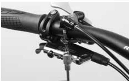
Adesso è possibile avvitare la vite della leva di comando con la chiave dinamometrica Canyon.
