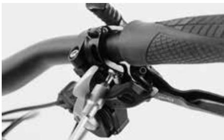
Ruotare la leva del freno nella stessa posizione della leva sinistra, già montata in fabbrica. Serrare la vite con la coppia di serraggio prescritta da SRAM di 5-6 Nm.
