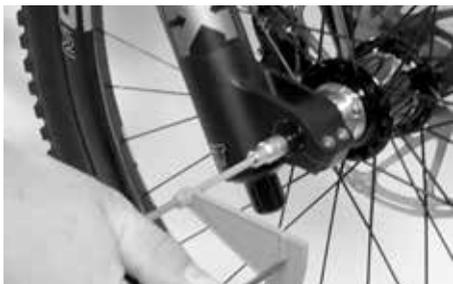
Quando il filetto del perno avrà fatto presa sul filetto dello stelo sinistro del foderò, ruotare il perno in senso orario. Per i primi giri il perno passante deve girare senza resistenza. Quindi serrare il perno a una coppia di bloccaggio di 2,2 Nm con la chiave dinamometrica Canyon.
