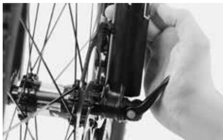
Serrare la leva di bloccaggio rapido E-Thru come una comune leva di bloccaggio rapido.
