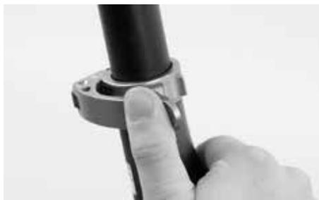
Spingere il reggisella nel piantone fino alla profondità di inserimento minima, riconoscibile dalle marcature MIN/MAX. Raddrizzare la sella e chiudere il bloccaggio rapido o la vite sul bloccaggio rapido del reggisella. Non serrare eccessivamente la vite o il bloccaggio rapido del reggisella.
