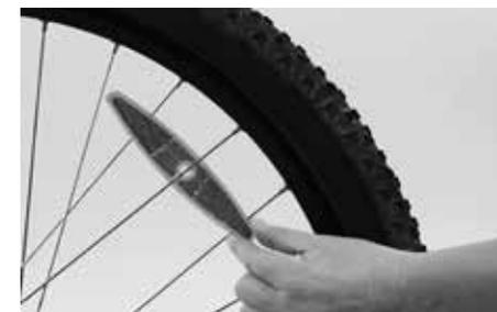
Montare anche i riflettori sui raggi. Assicurarsi di montare due riflettori sui raggi di ogni ruota, sia su quella anteriore che su quella posteriore.
