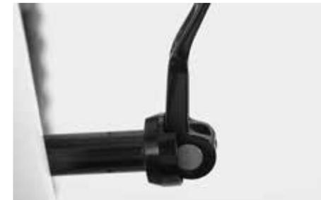
Accertarsi che la leva di bloccaggio rapido sia completamente aperta e posizionata nell'apposita cavità del perno. Quando il filetto del perno avrà fatto presa sul filetto del fodero sinistro, ruotare il perno in senso orario. Per i primi giri il perno passante deve girare senza resistenza.
