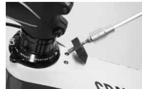
Accertarsi che l'attacco manubrio, insieme al manubrio, sia rivolto in avanti. Posizionare la IPU sul tubo orizzontale in modo tale che la parte arrotondata sia rivolta in avanti e la parte smussata all'indietro e che si inserisca in modo morbido nel tubo del telaio.
