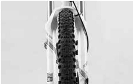
Controllare infine che la ruota anteriore sia centrata tra i foderi della forcella. Verificare la sede corretta del bloccaggio rapido e dei bloccaggi di sicurezza.
