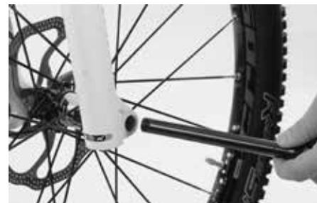
Nel caso del sistema con perno passante Maxle con leva di serraggio, introdurre la ruota anteriore nella forcella e contemporaneamente infilare il disco del freno nella pinza.
