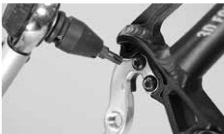
Sostituendo il forcellino del cambio sostituibile non superi mai la coppia di bloccaggio massima di 1,5 Nm
