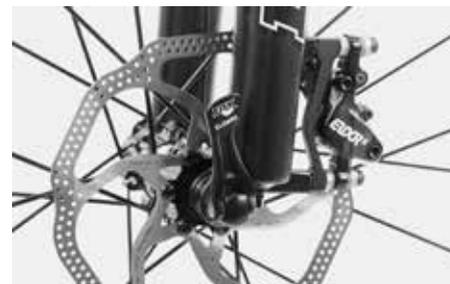
Una volta chiusa, la leva di bloccaggio rapido non deve più girare. Controllare che la leva di bloccaggio rapido non sporga in avanti o all'infuori. Si consiglia di chiuderla in modo che sia praticamente parallela al foderò e orientata verso l'alto.
