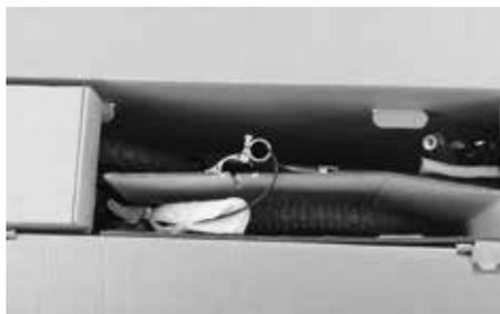
Nel BikeGuard è contenuto il telaio assemblato con la ruota posteriore montata e tutti i componenti, la ruota anteriore non montata (eventualmente imballata in un'apposita borsa), la sella con il reggisella (eventualmente collegato mediante tubo con una unità di controllo per il montaggio del manubrio).
