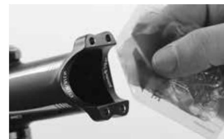
Prendere in mano la chiave dinamometrica Canyon e inserire nel portautensile la punta adeguata alla vite dell'attacco manubrio. Svitare completamente le viti di serraggio del coperchio dell'attacco manubrio e rimuovere il coperchio.
