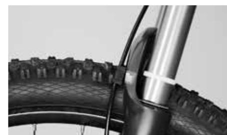
Osservando lo spostamento della fascetta è possibile riconoscere la corsa della sospensione
