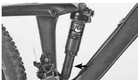
L'O-Ring spostato sull'ammortizzatore indica la corsa della sospensione
