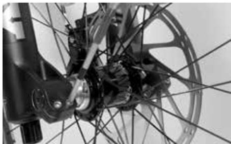
Il sistema con perno passante 20 mm ha diversi dispositivi che lo bloccano alla ruota anteriore. Per montare la ruota anteriore svitare le 2 viti su entrambi i lati finali inferiori della forcella per 2 o 3 giri. Introdurre la ruota anteriore nella forcella e contemporaneamente infilare il disco del freno nella pinza.
