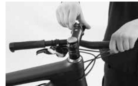
Ruotare in avanti, quindi in direzione di marcia, l'attacco manubrio e la forcella. Verificare che nell'operazione i cavi e i tubi non si girino.
