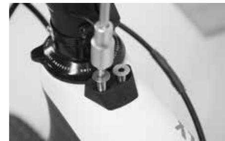
Inserire le due viti di fissaggio nei fori e stringerle con le dita di uno o due giri. Le due viti si devono poter essere girate molto facilmente.
