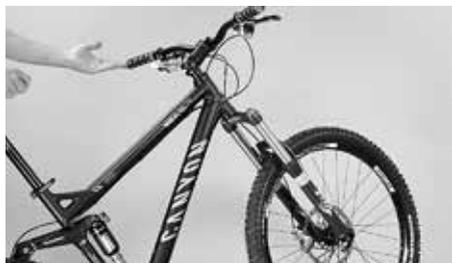
Per verificare la scorrevolezza dello sterzo sollevi la ruota anteriore e si accerti che oscilli con molta facilità
