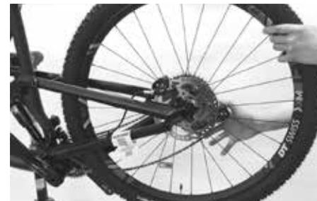
Inserire il bloccaggio rapido o il perno passante, chiuderli e verificare che la ruota sia fissata saldamente.
