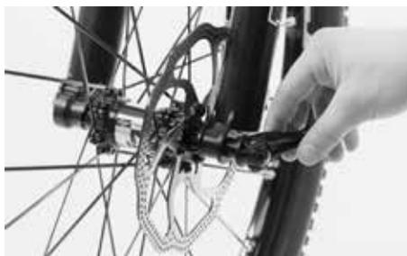
Quando il filetto del perno avrà fatto presa sul filetto del foderò destro, ruotare il perno in senso orario. Per i primi giri il perno passante deve girare senza resistenza. Avvitare leggermente il perno, quindi svitare di circa un terzo di giro.
