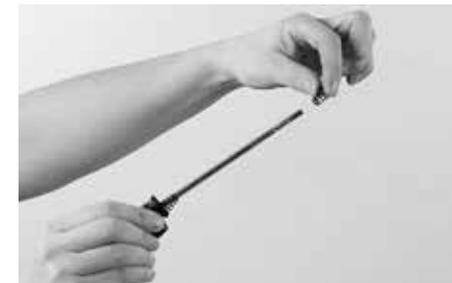
Prendere dalla scatola con parti piccole il bloccaggio rapido per la ruota anteriore. Svitare il controdado e tirare una delle molle dal bloccaggio rapido.
