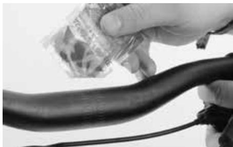
Prima di applicare la pasta di montaggio Canyon sulle superfici interessate rimuovere lo sporco e i residui di lubrificante. Successivamente spalmare sulle superfici pulite uno strato sottile e uniforme di pasta di montaggio Canyon con un pennello o un panno in pelle.
