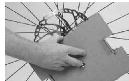
Saque la rueda delantera de la bolsa especial para ruedas y retire el cartón protector del disco de freno.
