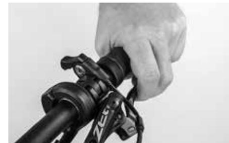
Tras el montaje de la rueda, haga una prueba de frenado con la bicicleta parada. Ambas manetas de freno deben presentar un punto de presión definido y no deben llegar hasta el manillar. Para obtener más información, consulte el capítulo "**Sistema de frenos**" de su extenso manual Canyon de bicicleta específico del tipo en el sitio [www.canyon.com](http://www.canyon.com)
