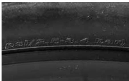
Infle ambos neumáticos con la presión máxima de inflado indicada en sus flancos. Para más información sobre los neumáticos y las cámaras, consulte el capítulo **"Ruedas - neumáticos, cámaras y presión de inflado"** de su extenso manual Canyon de bicicleta específico del tipo en el sitio [www.canyon.com](http://www.canyon.com)
