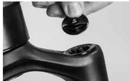
La horquilla de suspensión se desinfló por completo para el transporte. Usted debe inflar su horquilla de suspensión con la presión de aire apropiada. Abra la tapa de la válvula en el larguero izquierdo de su horquilla de suspensión. Encontrará más información sobre la horquilla de suspensión en el capítulo "Horquilla de suspensión" en su extenso manual Canyon de bicicletas específico del tipo.
