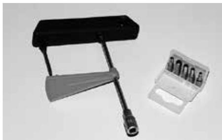
Canyon considera imprescindible el uso de una llave dinamométrica para fijar dos componentes de la forma más segura posible.
