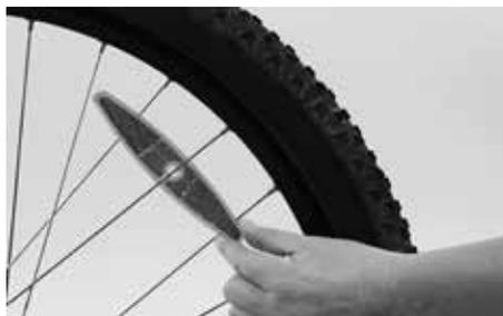
Además deberá montar los reflectantes de los radios. Monte dos reflectantes, uno frente al otro, en los radios de las ruedas delantera y trasera respectivamente.
