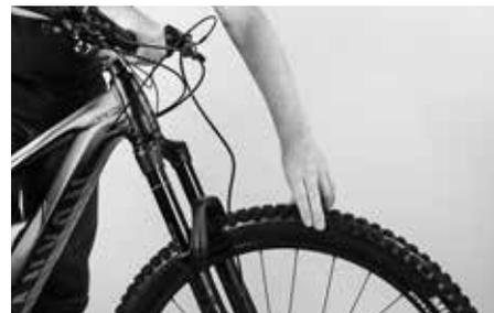
Accione varias veces la maneta de freno después de haber montado la rueda y cerrado el eje pasante o el cierre rápido y haga girar luego la rueda.
