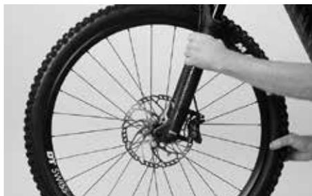
Coloque la rueda delantera en la horquilla y encaje simultáneamente el disco de freno en la pinza de freno. Alinee la rueda delantera entre las punteras y, desde la derecha, empuje el eje con la palanca de cierre rápido Maxle Ultimate abierta a través de la puntera y el buje.
