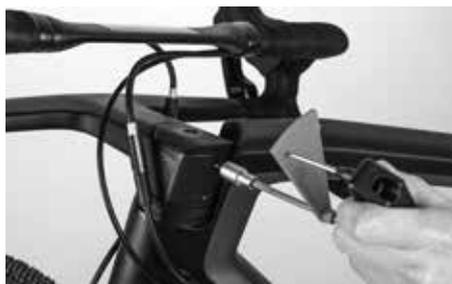
Apriete los tornillos del manillar/elementos de mando GRAIL con 7,5 Nm con la llave dinamométrica de Canyon.
