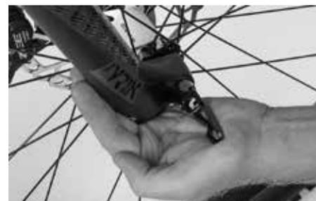
Empuje con la palma de la mano tirando con los dedos de la barra de la horquilla, pero nunca de un radio o de un disco de freno.
