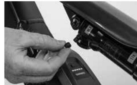
Si ha adquirido una bicicleta eléctrica todo terreno con suspensión integral (full suspension), tendrá que comprobar la presión de inflado. Abra la tapa de válvula en el amortiguador.
