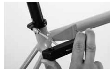
Alinee el sillín y no apriete demasiado el tornillo de fijación de la sujeción de la tija de sillín, es decir, no debe sobrepasar el par máximo de apriete permitido de máx. 8 Nm. Use la llave dinamométrica Canyon.
