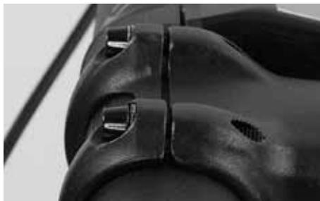
Asegúrese de que las ranuras entre la tapa de la potencia y el cuerpo de la misma sean paralelas y tengan la misma anchura arriba y abajo. Si es necesario, vuelva a soltar los tornillos de apriete y apriételes uniformemente.
