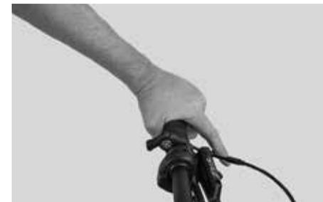
Ajuste el manillar con la rueda delantera montada y la presión de aire adaptada. En bicicletas eléctricas todo terreno listas para el rodaje, las manetas de freno apuntan ligeramente hacia abajo. Al sentarse en el sillín, el brazo extendido y los dedos forman una línea recta cuando los dedos agarran la maneta de freno.
