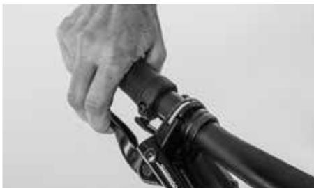
8. **Haga rebotar la Pedelec contra el suelo a poca altura.** Trate de identificar el origen de eventuales ruidos. Inspeccione los rodamientos, los tornillos y la colocación correcta de la batería si fuera necesario.
