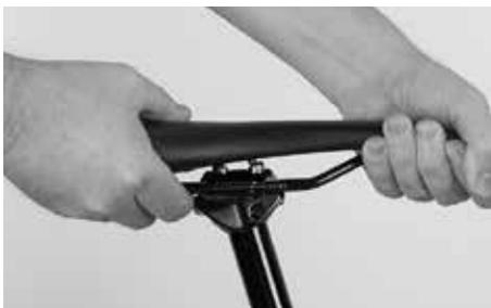
Ajuste las posiciones del sillín y de agarre y compruebe el asiento fijo del manillar, de las manetas y de la tija de sillín, tal y como se describe en el capítulo **"Adaptar la bicicleta Canyon al usuario"** de su extenso manual Canyon de bicicleta del tipo específico.
