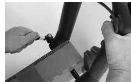
Desenrosque el eje pasante Maxle Ultimate de la horquilla y extráigalo completamente.
