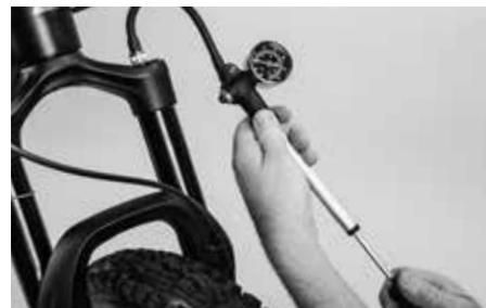
Infle la horquilla de suspensión con la bomba especial, adjunta al BikeGuard, siguiendo las recomendaciones del fabricante de la horquilla sobre el ajuste de la dureza de muelle.
