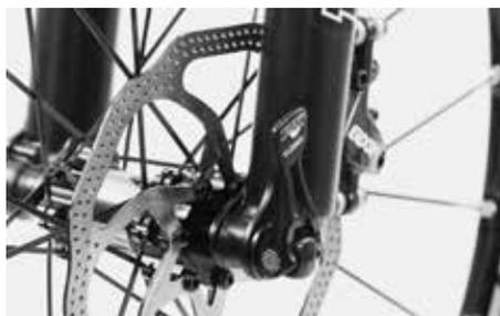
Si la palanca no se deja cerrar completamente, ábrala de nuevo y gire un poco el eje hacia la izquierda. Intente cerrar otra vez la palanca del cierre rápido.
