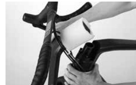
Sujete bien la combinación manillar/potencia y suelte en la potencia la cinta de velcro superior que fija el manillar.
