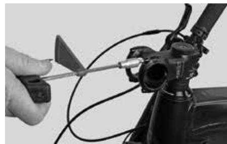
Tome la llave dinamométrica Canyon e inserte la punta que se adapte a los tornillos de la potencia.
