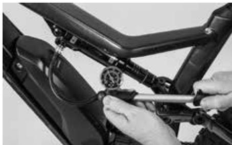
Infle el amortiguador con la bomba especial adjunta al BikeGuard, siguiendo las recomendaciones del fabricante del amortiguador.
