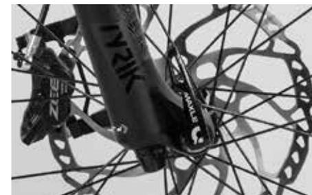
Una vez cerrada, la palanca del cierre rápido ya no debe girar. Asegúrese de que la palanca del cierre rápido no sobresalga hacia delante o hacia afuera. Lo mejor es cerrarlo delante de la botella de forma que, apuntando hacia arriba, quede en posición más o menos vertical.
