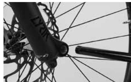
Cuando la rosca del eje encaje en la rosca de la barra izquierda de la horquilla, gire el eje hacia la derecha. El eje pasante debe girar libremente al dar las primeras vueltas.
