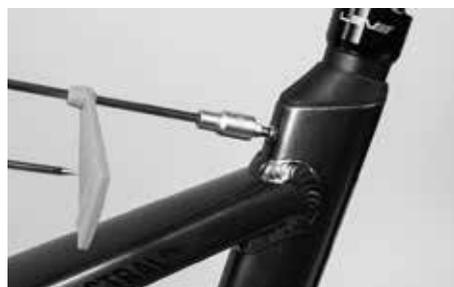
Coloque la punta correspondiente en la llave dinamométrica Canyon. Suelte el tornillo de apriete en la parte delantera del tubo del sillín. Extraiga luego la tija de sillín del tubo de sillín hasta alcanzar la altura de sentado deseada.
