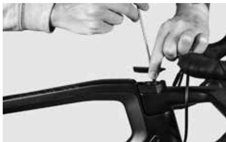
Coloque arriba la tapa que había retirado y apriete el tornillo como **máximo con 2 Nm** usando la llave dinamométrica Canyon.
