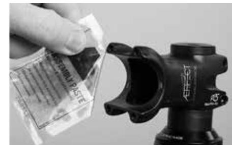
Esto es especialmente útil en las áreas de apriete del manillar y la potencia, el tubo frontal y la potencia, la tija de sillín y el tubo de sillín - tres puntos de apriete en que una fuerza de apriete excesiva puede destruir los componentes, haciendo que fallen o se pierda la garantía.
