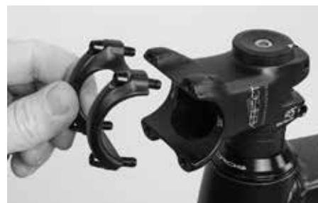
Desenrosque completamente los tornillos de apriete de la tapa de la potencia y quite la tapa.
