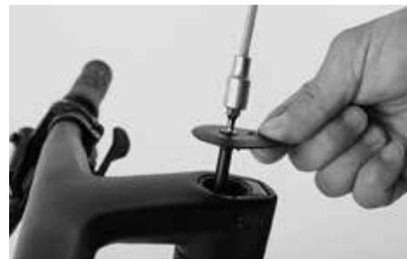
Coloque arriba la tapa que había retirado y apriete el tornillo con 2 Nm usando la llave dinamométrica suministrada.
