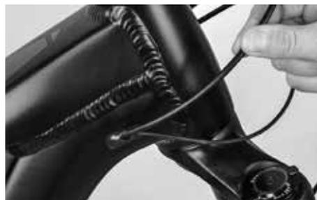
Al introducir o extraer la tija de sillín ajustable en altura tenga cuidado de que también se empujen o tiren los cables en el orificio de salida del cuadro y que no se doblen.
