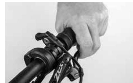
Accione varias veces la maneta de freno después de montar la rueda y de cerrar el cierre rápido y haga girar la rueda.
