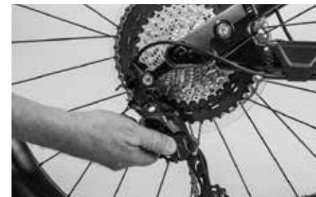
Compruebe el buen funcionamiento del sistema de cambio. Pídale a alguien que levante la Pedelec por el sillín mientras va pasando cuidadosamente de una marcha a otra.
