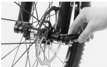
Cuando la rosca del eje encaje en la rosca de la barra derecha de la horquilla, gire el eje hacia la derecha. El eje pasante debe girar libremente al dar las primeras vueltas. Gire un poco el eje pasante y después gire un tercio de vuelta hacia atrás.
