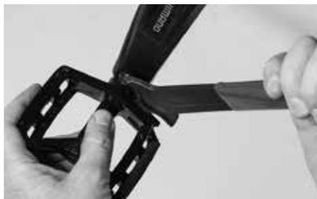
Algunos tipos de pedales requieren siempre una llave Allen para su montaje.
