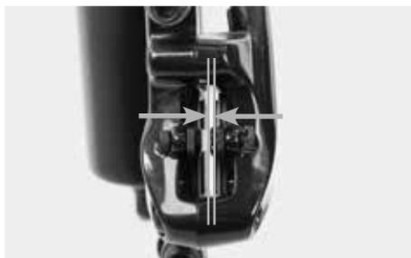
En caso de frenos de disco, compruebe antes de montar la rueda que las pastillas vayan colocadas exactamente en sus asientos en la pinza de freno. De ser así, la ranura entre las pastillas es paralela.
