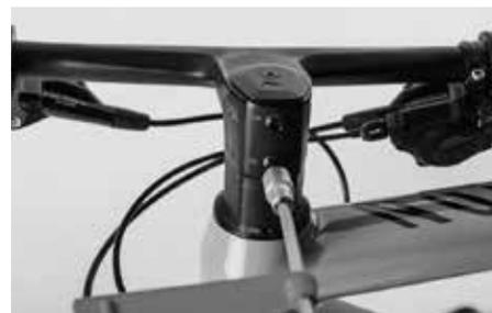
Coloque la punta correspondiente en la llave dinamométrica Canyon. Primero apriete ligera y uniformemente los tornillos de apriete de la potencia. Asegúrese de que la ranura transcurra uniformemente. Por último, apriete los tornillos con el par de apriete indicado (5 Nm).
