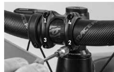
Gire uniformemente y en cruz los tornillos de apriete de la tapa de la potencia hasta que el manillar quede ligeramente apretado.
