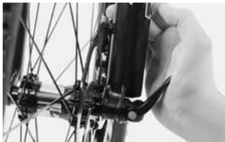
Cierre la palanca del cierre rápido E-Thru de igual manera que una palanca de cierre rápido normal.
