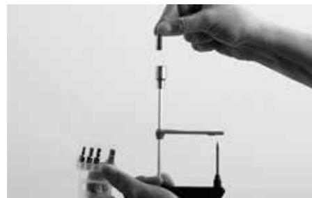
Coloque la punta correspondiente en la llave dinamométrica Canyon.
