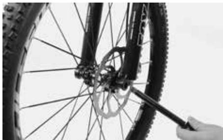
Coloque la rueda delantera en la horquilla y encaje simultáneamente el disco de freno en la pinza de freno. Alinee la rueda delantera entre las punteras y, desde la izquierda, empuje el eje con la palanca de cierre rápido E-Thru abierta a través de la puntera y el buje.
