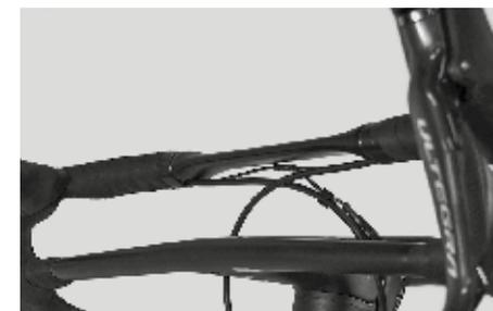
Coloque luego la combinación manillar/potencia en el cuello de la horquilla. Asegúrese de que los cables de freno y las tuberías hidráulicas se encuentren por encima de la unidad de la potencia, no se tuercen o doblen y que lleguen en radios uniformes a los topes o al freno.
