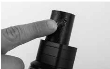
Suelte el tornillo arriba en la potencia y retírelo junto con la tapa. Abra una esquina de la bolsa de pasta de montaje Canyon. Aplique una fina capa de pasta de montaje Canyon tanto en la cara interior de la zona de apriete de la potencia como en la zona de sujeción del cuello de la horquilla.
