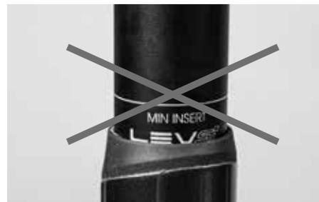
Alinee el sillín y no apriete demasiado el tornillo de fijación de la sujeción de la tija de sillín, es decir, no debe sobrepasar el par máximo de apriete permitido. Use la llave dinamométrica Canyon.
