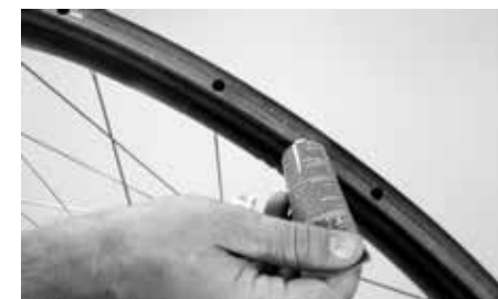
Nanoszenie kleju bezpośrednio z tubki
