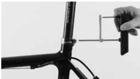
Nie dokręcać zbyt mocno śruby zacisku rury podsiodłkowej
