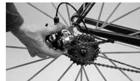
W celu wymontowania koła należy przerzutkę tylną pociągnąć nieznacznie do tyłu
