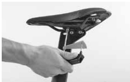
Dokręcić śrubę kluczem dynamometrycznym Canyon
