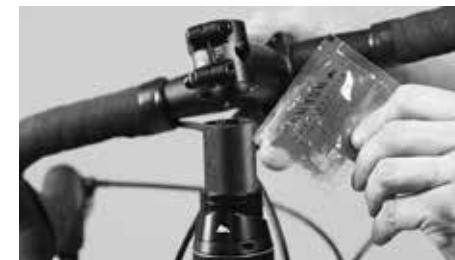
Na rurę widelca w razie potrzeby nałożyć nieco pasty montażowej do karbonu
