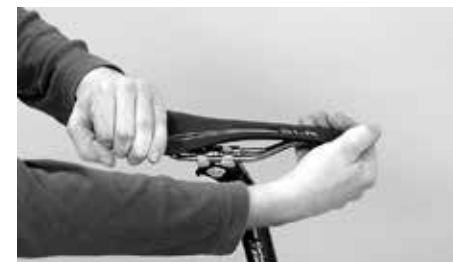
Spróbować przekręcić siodełko względem ramy
