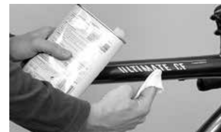
Konserwacja lakieru i powierzchni metalowych twardym woskiem
