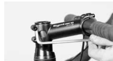
Odkręcić śruby z boku wspornika kierownicy
