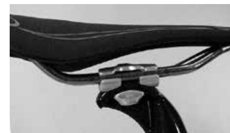
Ustawić siodełko tak, aby stelaż zaciśnięty był w zakresie obszaru zaznaczenia
