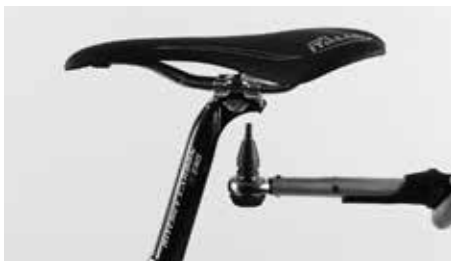
Dokręcić śruby nie jednocześnie oraz równomiernie, nigdy nie przekraczaj dopuszczalnego maksymalnego momentu dokręcania
