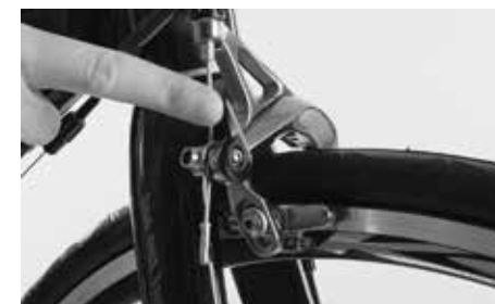
Otworzyć dźwignię zwalnającą przy hamulcu
