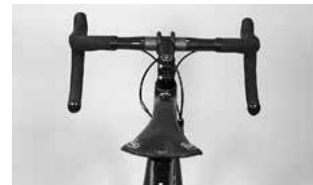
Spójrz od siodełka wzdłuż rury górnej i sprawdź czy nie jest ono przekręcone
