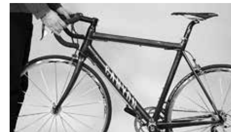
Spróbować przekręcić kierownicę względem przedniego koła oraz względem wspornika
