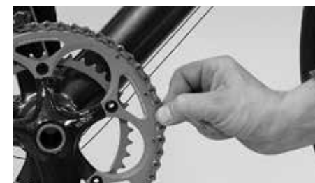
Po zakończeniu czyszczenia nasmarować łańcuch
