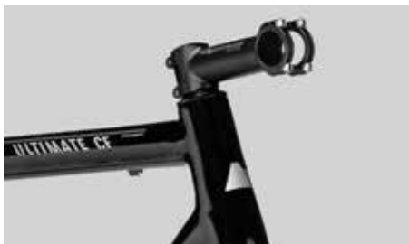
Zamontowane i ustawione stery ze wspornikiem oraz widelcem
