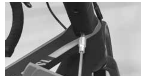
Odkręć śrubę płytki
