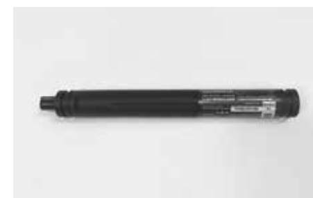
Bateria Di2 może również być ukryta i wbudowana w rurę dolną
