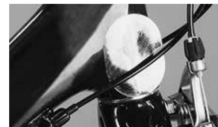
Specjalne naklejki chronią karbon przed uszkodzeniami
