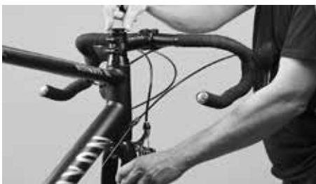
Nałożyć nakrętkę górną, przycisnąć ją w kierunku trzymanego ręką widelca a następnie dokręcić ponownie ustawiony wspornik kierownicy uwzględniając zalecany moment dokręcania
