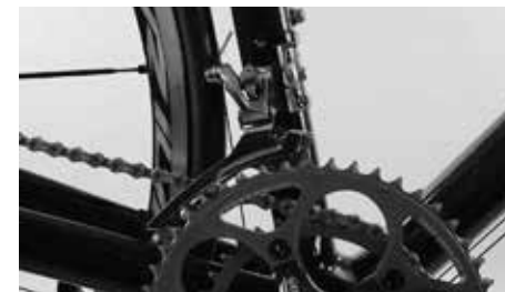
Ustawianie zakresu obrotu przerzutki przedniej
