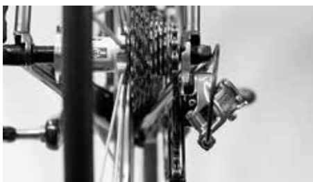
Sprawdzić, czy łańcuch nadal umieszczony jest na kołach łańcuchowych i zębatkach
