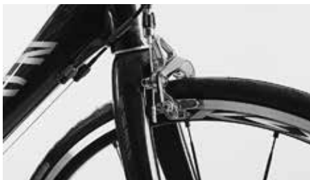
Sprawdzanie ruchu obrotowego na podstawie okładzin hamulcowych
