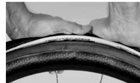
Naciskać na oponę w kierunku bocznym aż do powstania szczeliny
