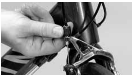
Przy pomocy nakrętki radełkowanej ustawić odpowiedni skok dźwigni hamulca
