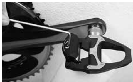
Ustawianie poziomu intensywności wypinania buta w pedale
