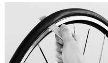
Za pomocą łyżki montażowej można wyważyć oponę
