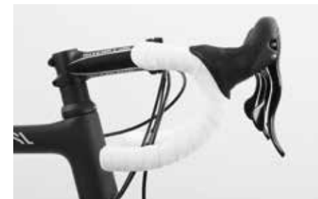
Prosty odcinek dolnej części kierownicy powinien być ustawiony równoległe do podłoża lub być skierowany lekko w dół
