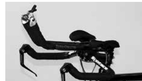
Manetki końcowe sterują przerzutką tylną i przednią
