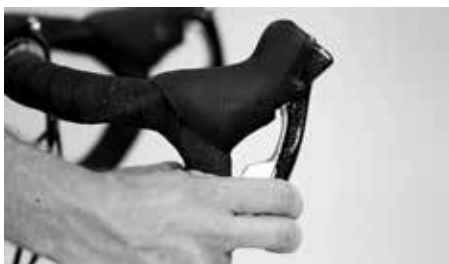
Po przyciągnięciu dźwignia hamulca nie powinna stykać się z kierownicą
