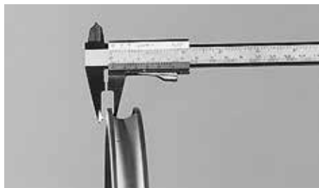
Należy zlecić specjalistom sprawdzenie grubości ścianek obręczy najpóźniej po zużyciu drugiego zestawu okładzin hamulcowych
