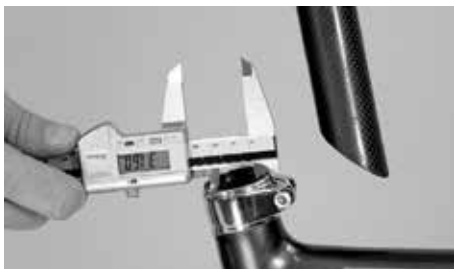
Zwróć uwagę na to, aby sztyca bezsprzecznie dopasowana była do ramy
