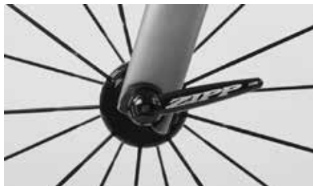
W położeniu krańcowym dźwignia musi być ustawiona prostopadle do osi szybkozamykacza
