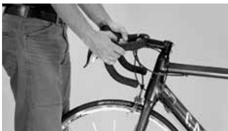
Spróbować przekręcić kierownicę względem przedniego koła
