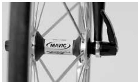
Dźwignia szybkozamykacza musi być ustawiona w miarę równoległe do roweru i nie może odstawać na bok
