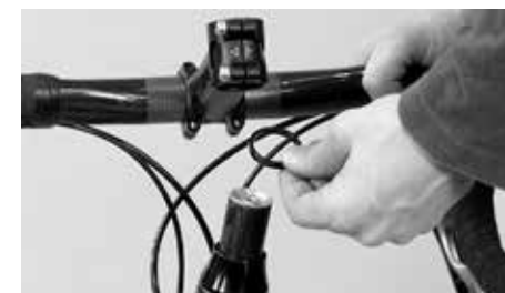
Wyjąć pierścienie dystansowe a następnie włożyć je z powrotem powyżej wspornika kierownicy
