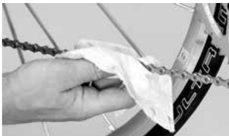
Oczyszczają łańcuch ścierką z osadzającego się brudu oraz oleju
