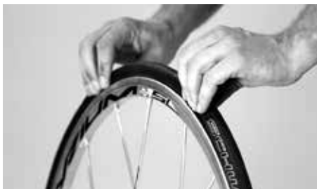
Naciskać na oponę po obu stronach w celu uzyskania pewności, że dętka nie została zaciśnięta
