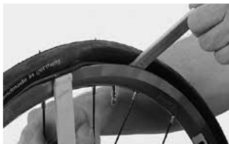
Przykładanie łyżki do opon i ściąganie brzegu opony z krawędzi obręczy
