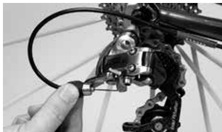
Dociąganie linki przerzutek przy śrubie nastawczej na przerzutce tylnej
