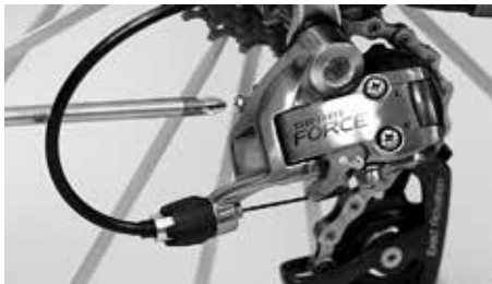
W celu ustawienia odstępu między kółkiem a wieńcem przekręcić śrubę znajdującą się na przedniej stronie haka widelca
