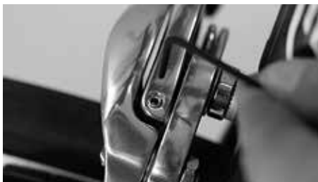
Kręcić śrubką aż do ustawienia po lewej i prawej stronie tego samego odstępu okładzin do obręczy
