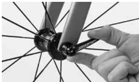
Sprawdź pozycję próbując przekręcić zamkniętą dźwignię
