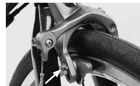
W celu przestawienia wysokości dokręcić śrubę mocującą zalecanym momentem dokręcania
