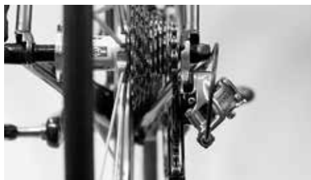
Spójrz od tyłu na kasetę rowerową i sprawdź, czy kółka prowadzące przerzutki tylnej znajdują się dokładnie pod szpicami odpowiedniej zębatki
