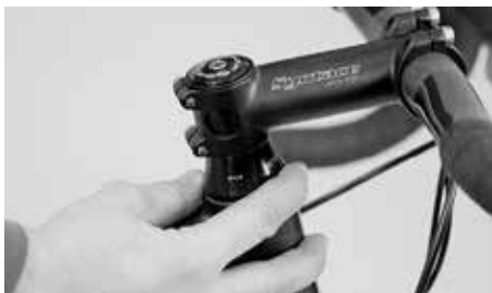
Sprawdzić luz w łożysku sterowym poprzez położenie palców wokół powłoki łożyska i popchanie roweru Canyon do przodu i do tyłu
