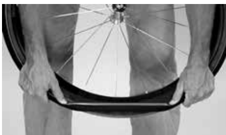
Oponę przeciśnąć kciukami przez krawędź obręczy
