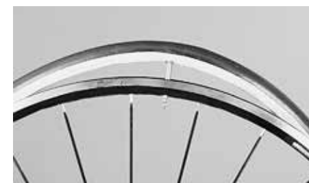
Zawór lekko napompowanej opony włożyć w dziurkę na zawór obręczy
