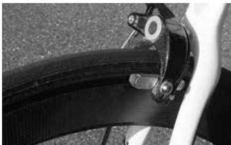
Obręcze z karbonu wymagają specjalnych okładzin hamulcowych zgodnie z instrukcją producenta koła
