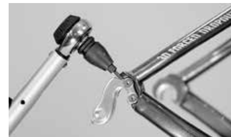
Przy wymianie wymiennego haka do przerzutek w żadnym wypadku nie przekraczać momentu dokręcania wynoszącego 1,5 Nm
