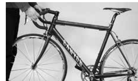
Spróbować przekręcić kierownicę względem przedniego koła
