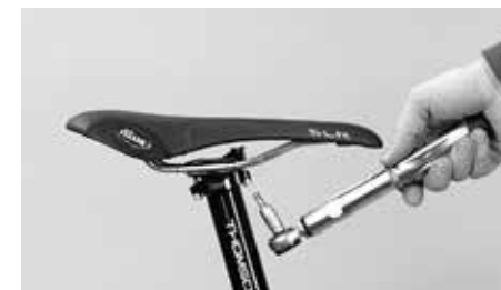
Dokręcić śruby nie jednocześnie i równomiernie zalecanym momentem dokręcania
