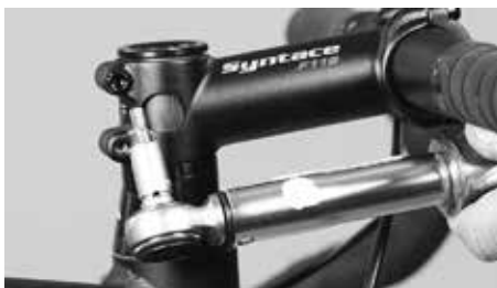
Wszystkie śruby zaciskowe wspornika kierownicy dokręcić kluczem dynamometrycznym zgodnie ze wskazówkami
