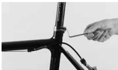
W celu ustawienia wysokości siodełka należy odkręcić śrubę sztycy zacisku siodełka
