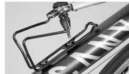
Przy uchwycie na bidon przestrzegać maksymalnego momentu dokręcania wynoszącego 5 Nm
