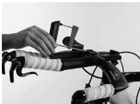
Montaż kierownicy przy pomocy klucza dynamometrycznego Canyon
