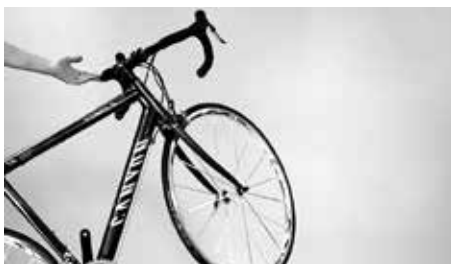
Sprawdzić łatwość poruszania łożyska poprzez podniesienie koła przedniego i sprawdzenie, czy da się ono poruszać w bardzo swobodny sposób
