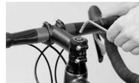
Po odkręceniu bocznych śrub zaciskowych ustaw luz łożyska przy pomocy wkręconej na górze śruby nastawczej
