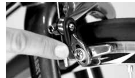
Sprawdzić ruch obrotowy za pomocą okładzin hamulcowych
