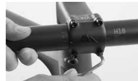
Odkręć śrubę(y) sześciokątną na przedniej stronie wspornika
