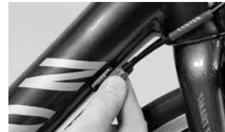
Dociąganie linki przerzutek przy śrubie nastawczej przy ramie
