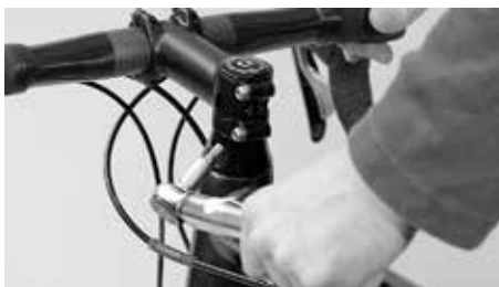
Dokręcić wspornik uwzględniając zalecany moment dokręcania
