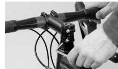
Odkręcić śruby z boku wspornika kierownicy
