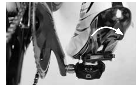
Połączenie pedałów zatraskowych odcepią się poprzez odchylenie pięty na zewnątrz
