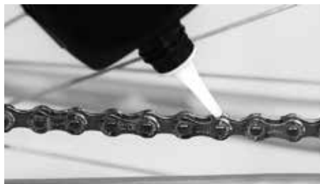
できるだけきれいな状態のチェーンのコマに、チェーンオイルを塗布してください
