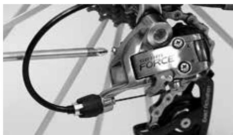
プーリケージとスプロケットの距離を調節するには、ドロップアウトの正面側を押さえるボルトを廻します
