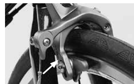
高さを調整したらブレーキシューの固定ボルトを規定のトルクで締め付けてください
