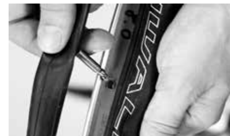
バルブをリムの孔に差し込む
