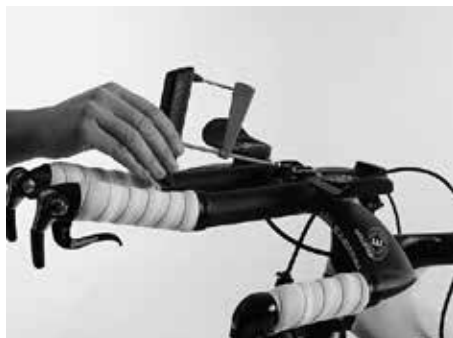
ハンドルの取り付けには Canyon のトルクレンチを使う
