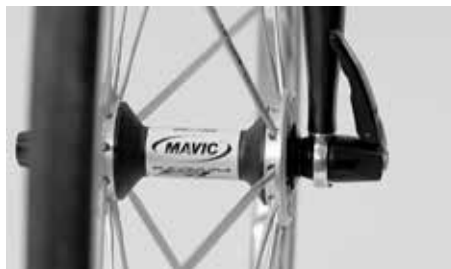
ホイールがまだしっかりとフォークエンドおよびドロップアウトに固定されていることを確認してください。
