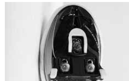
靴底に組み込まれた小さな固定プレート (クリート)
