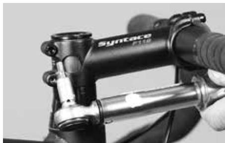
側面にあるステムのクランプボルトが表示の規定トルクで締められているかトルクレンチで確認してください
