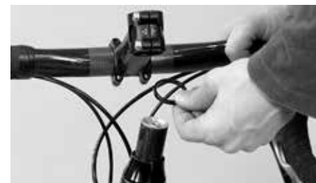
スペーサーを外してステムを取り付け、外したスペーサーはステムの上に乗せます
