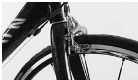
ブレーキシューとの距離を見てホイールの振れを点検
