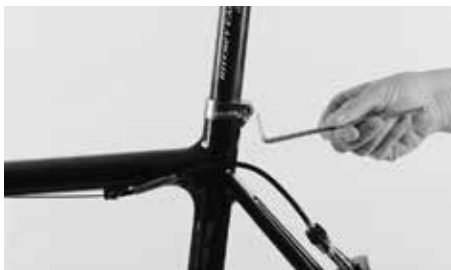
サドルの高さを調整するには、シートクランプのボルトを緩めます
