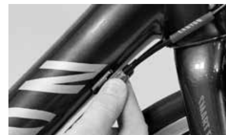
フレームについているアジャスターボルトでシフトケーブルのテンションを調整
