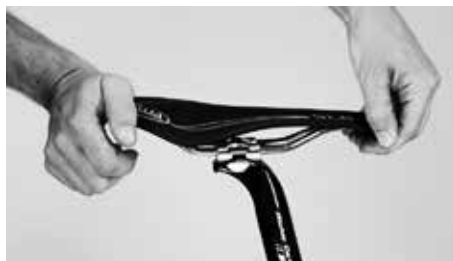
ボルトを締めたら、サドルが傾かないか確認してください
