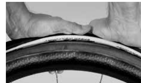
隙間ができるようにタイヤを横に押します
