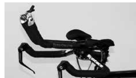
バーエンドシフターでリアとフロントのディレイラーを制御
