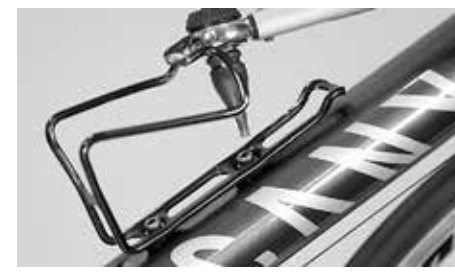
ボトルケージの取り付け時には最大締め付けトルク 5 Nm を守ってください
