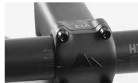
上側の隙間が完全に閉じるまで締める
