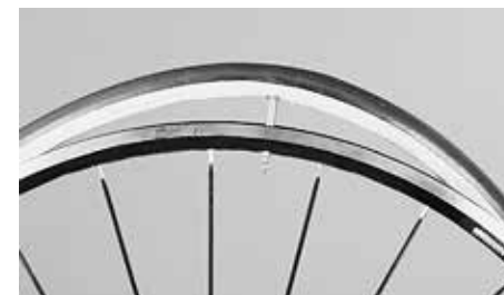
軽くエアを入れたタイヤのバルブをリムのバルブ用の孔に挿入します
