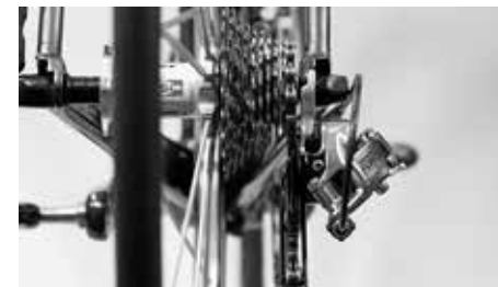
後輪を取り外す前に一番小さなスプロケットに切り替える
