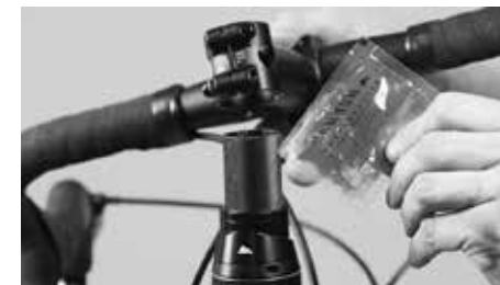
うまく固定できない場合にはステアリングコラムないしハンドルにカーボンアッセンブリーペーストを塗ります
