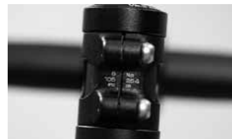
所定の締め付けトルクを必ず守ってください
