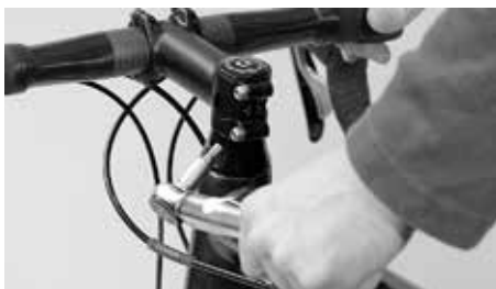
そしてステムを規定の締め付けトルクで締めます
