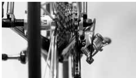
スプロケットを後ろから見た時に、リアディレイラーのガイドプーリが、正しいスプロケットの歯の真下にあるかどうかを確認します
