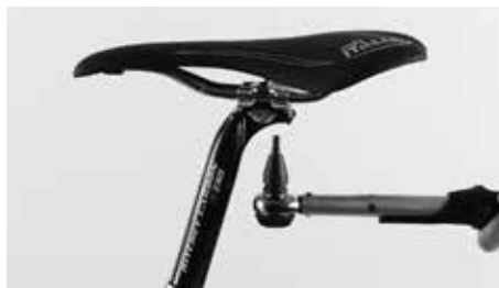
2 本のボルトを交互に均一に締めてゆき、最大許容締め付けトルクを絶対に超えないようにしてください
