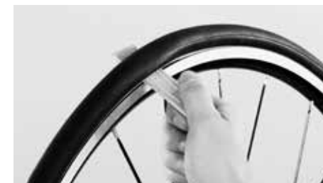
タイヤレバーを使えばタイヤが外れます
