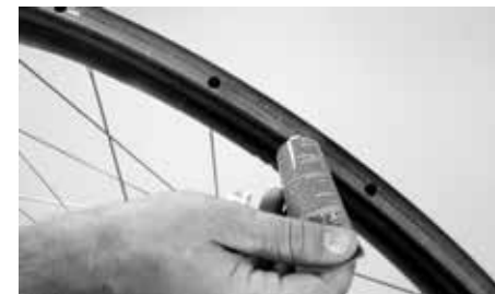
チューブから直接リムセメントを塗る
