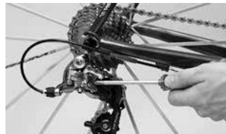
ディレイラーの可動範囲をアジャスターボルトで限定してください
