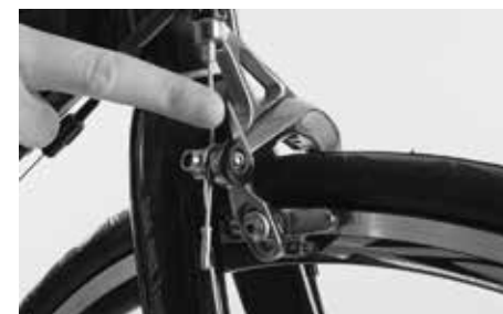
ブレーキのクイックリリースレバーを開きます
