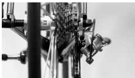
チェーンがまだチェーンリングとスプロケットにかかっているかどうかを点検します。
