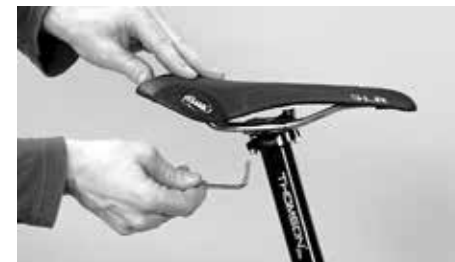
両方のボルトを 2 ～ 3 回転だけ緩めます
