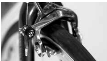
ブレーキを使ってタイヤの振れを点検
