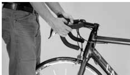
前輪を押さえてハンドルをひねることができるか試してみよう
