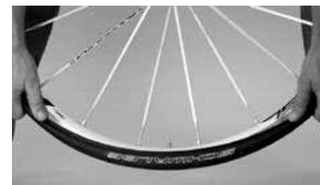
タイヤを手でリムに押し込む
