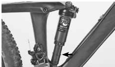
Der verschobene O-Ring auf dem Dämpfer zeigt den ausgenutzten Federweg an
