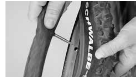
Ventil in das Felgenloch stecken
