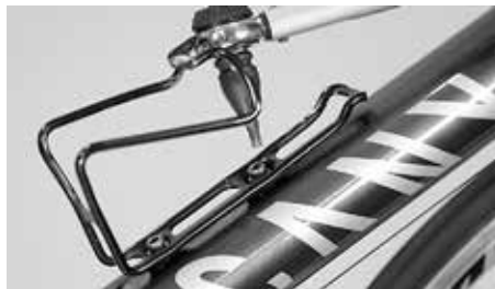
Halten Sie sich beim Flaschenhalter an ein maximales Drehmoment von 5 Nm
