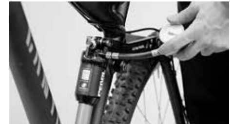
Bei Luftfederungen regelmäßig den Luftdruck überprüfen
