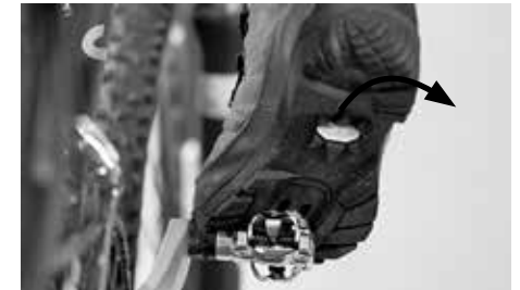
Die Verbindung der Klickpedale wird durch Drehen der Ferse nach außen gelöst
