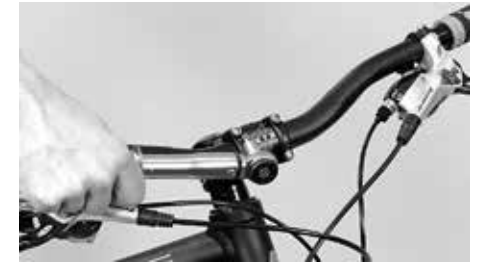
Ziehen Sie die Schrauben mit dem vorgeschriebenen Drehmoment wieder fest
