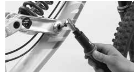
Überprüfen Sie regelmäßig den festen Sitz aller Hinterbau-Verschraubungen gemäß den vorgegebenen Drehmomenten
