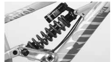
Federbein mit Stahlfederelement
