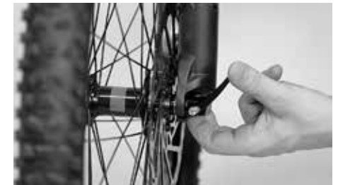
Achten Sie auf den korrekten Sitz des Schnellspanners
