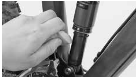
Reinigung des Federbeins mit einem Schwamm und Wasser
