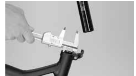
Achten Sie darauf, dass die Sattelstütze einwandfrei zum Rahmen passt
