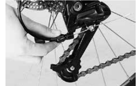
Nachspannen des Schaltzuges an der Stellschraube am Schaltwerk
