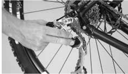
Prüfen Sie, dass das Schaltwerk nicht mit den Speichen in Kontakt kommen kann
