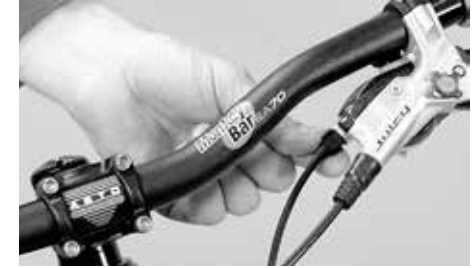
Spannen Sie den Schaltzug an der Stellschraube nach
