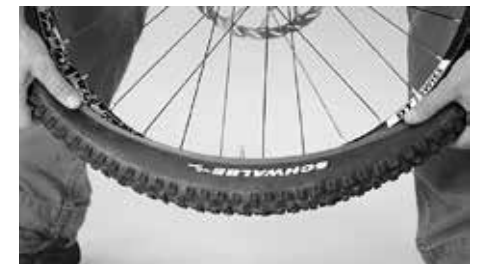
Reifen per Hand in die Felge drücken
