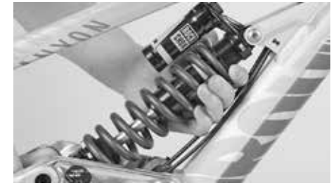
Bei Stahlfedern drehen Sie den gerändelten Einstellring um die Federvorspannung zu ändern
