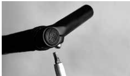
Ziehen Sie die Schrauben mit dem benötigten Drehmoment wieder fest
