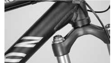
Der Gabelkopf muss sich berührungsfrei unter dem Rahmen drehen lassen
