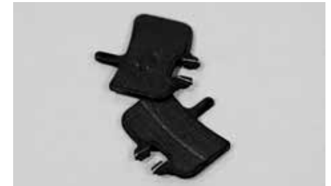
Bremsbeläge, deren Belagsstärke unter einem Millimeter liegt, müssen gegen Original-Ersatzteile ausgetauscht werden
