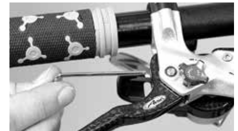
Einstellen der Griffweite des Bremshebels
