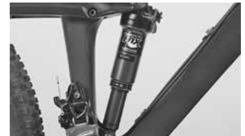
Federbein mit Luftfederelement
