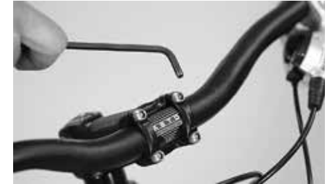
Öffnen Sie die Schrauben vorne am Vorbau
