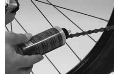
Schmieren Sie die Kette nach Abschluss der Reinigungsarbeiten
