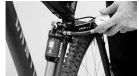
Bei Luftdämpfern wird zum Anpassen der Luftdruck variiert
