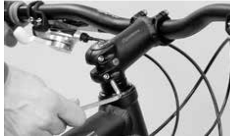
Lösen Sie die Schrauben seitlich am Vorbau
