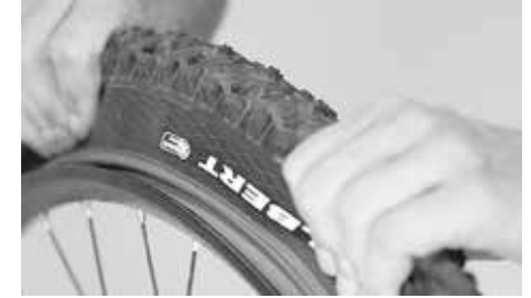
Drücken des Schlauchlos-Reifens in die Felgenmitte
