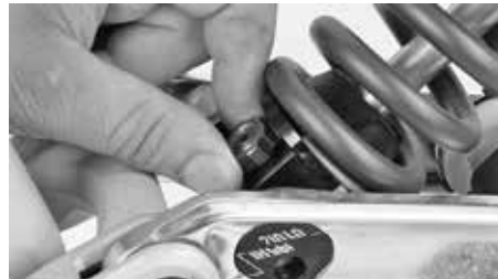
Zugstufendämpfung am Federbein
