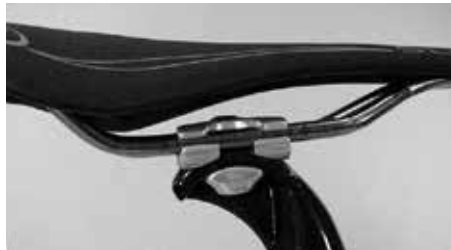
Richten Sie den Sattel so aus, dass das Gestell innerhalb der Markierungen geklemmt wird
