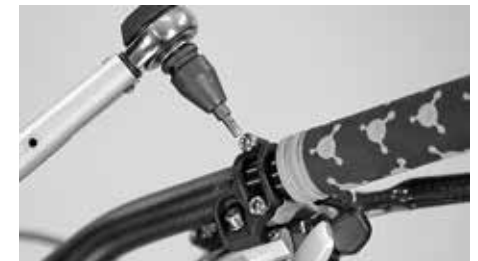
Schrauben Sie die Brems- und Schaltgriffe mit dem vorgeschriebenen Drehmoment fest
