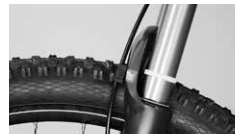
Anhand des verschobenen Kabelbinders können Sie den genutzten Federweg erkennen
