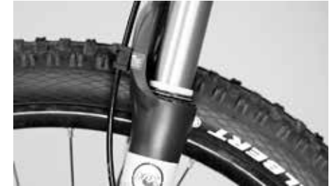
Ziehen Sie einen Kabelbinder über das Standrohr
