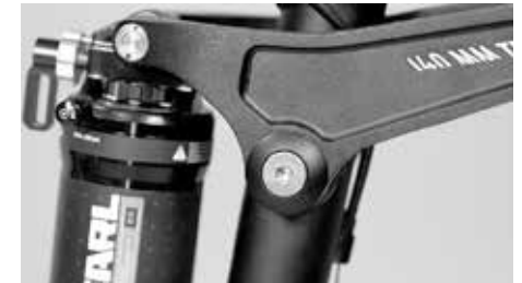
Lager unterliegen einem gewissen Verschleiß
