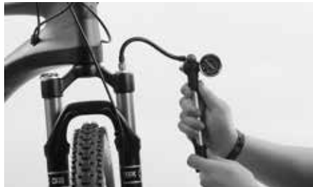
Bei Luftfederungen regelmäßig den Luftdruck überprüfen
