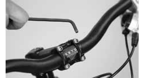
Öffnen Sie die Innensechskantschraube(n) an der Vorderseite des Vorbaus
