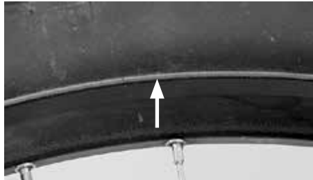
Kontrollring an der Reifenflanke
