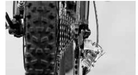
Schauen Sie von hinten auf das Zahnkranzpaket und prüfen Sie, ob die Leitrollen des Schaltwerkes genau unter den Zahnspitzen des passenden Ritzels liegen
