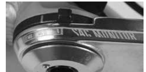
Negativfederweg – „sag“ an der Hinterbaufederung
