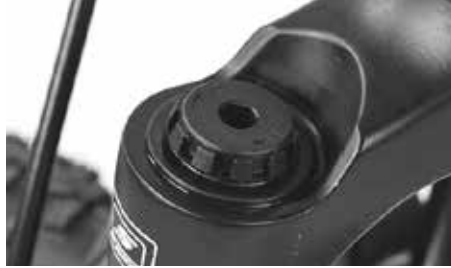
Vorspannung Gabel mit Stahlfeder
