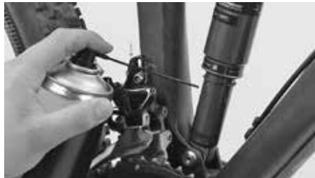
Nach Reinigung etwas freigegebenes Schmiermittel auftragen
