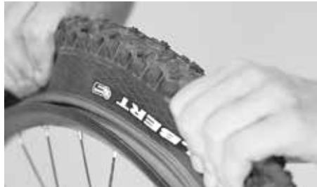
Drücken des Reifens in die Felgenmitte
