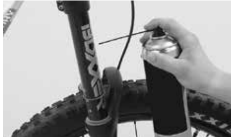
Nach der Reinigung etwas freigegebenes Schmiermittel auftragen
