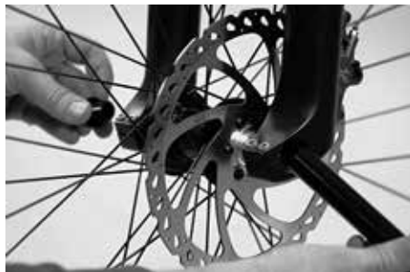
Befestigung mit Steckachsen
