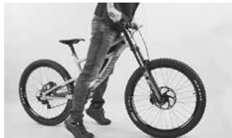
Drücken Sie die Gabel bei gezogener Vorderradbremse nach unten
