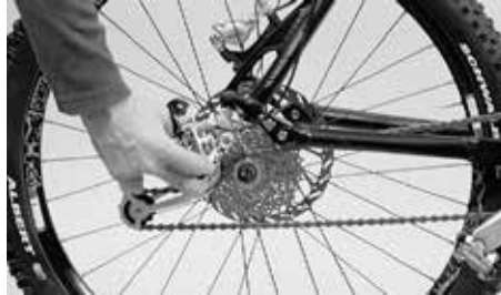
Zum Ausbau des Hinterrades ziehen Sie das Schaltwerk etwas nach hinten
