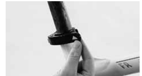
Ziehen Sie den Schnellspanner nicht zu fest an
