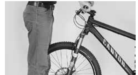
Versuchen Sie den Lenker gegenüber dem Vorderrad zu verdrehen
