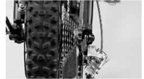
Vor der Demontage des Hinterrades auf das kleinste Ritzel schalten
