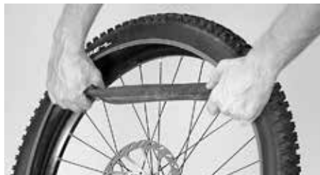
Schlauch aus dem Reifen ziehen
