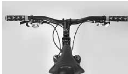
Peilen Sie über den Sattel entlang des Oberrohres, um sicherzustellen, dass er nicht verdreht ist
