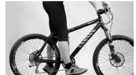
Wenn die Ferse auf dem Pedal steht, welches sich in der untersten Position befindet, muss das Bein ganz durchgestreckt sein
