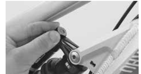
Druckstufendämpfung am Federbein
