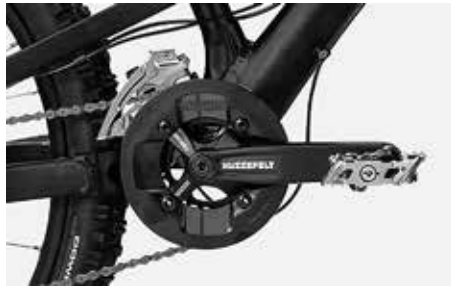
Überschreiten Sie die Drehmomente der Lagerhersteller nicht
