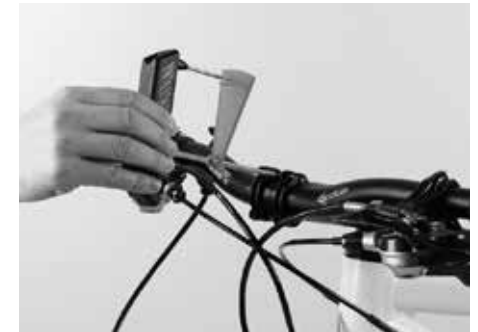
Lenkermontage mit dem Canyon Drehmomentschlüssel
