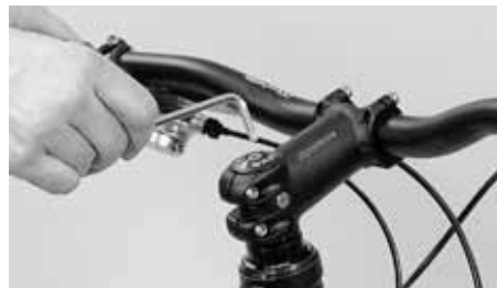
Stellen Sie das Lager neu ein und ziehen Sie dann den Vorbau wieder fest
