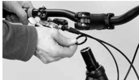
Nehmen Sie die Zwischenringe heraus und stecken Sie diese dann oberhalb des Vorbaus wieder auf
