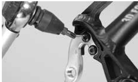
Beim Austausch des wechselbaren Schaltauges dürfen sie keinesfalls das maximale Drehmoment von 1,5 Nm überschreiten
