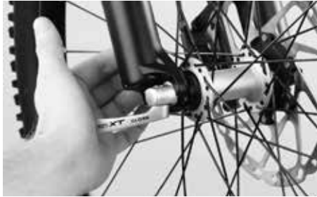
Schließen des Schnellspanners mit dem Daumenballen
