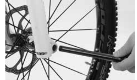
RockShox Maxle- und Maxle-Lite-Steckachsensystem 15 bzw. 20 mm
