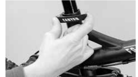
Um die Sitzhöhe einzustellen, müssen Sie den Schnellspanner der Sattelmöbel lösen
