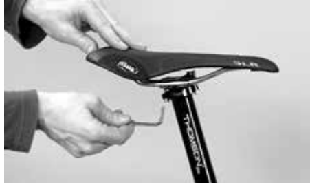
Lösen Sie die beiden Schrauben zwei bis maximal 3 Umdrehungen
