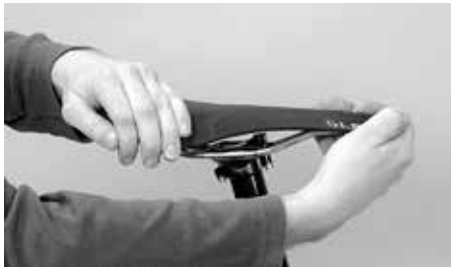
Versuchen Sie den Sattel gegenüber dem Rahmen zu verdrehen
