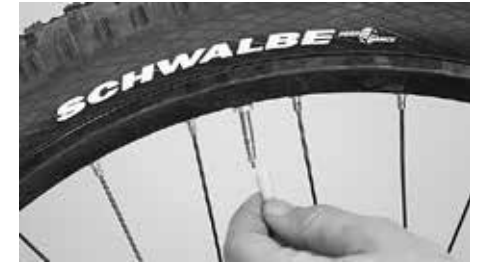
Abschrauben der Kunststoff-Abdeckkappe
