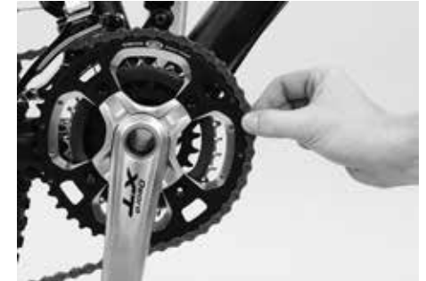
Überprüfen des Kettenzustandes
