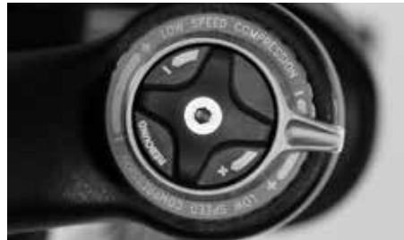
Druckstufendämpfung verzögert das Einfedern
