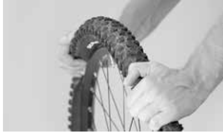
Drücken Sie den Reifen nach beiden Seiten um sicher zu gehen, dass der Schlauch nicht eingeklemmt ist
