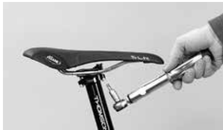
Ziehen Sie die Schrauben abwechselnd und gleichmäßig mit dem vorgeschriebenen Drehmoment wieder fest
