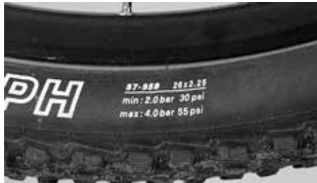
Luftdruckangabe auf der Reifenflanke
