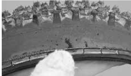
Benetzen Sie den Reifenfuß vor der Montage mit Seifenwasser
