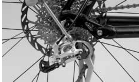
Begrenzen Sie den Schwenkbereich des Schaltwerkes durch die Endanschlagschrauben
