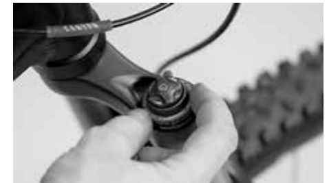
Verstellmöglichkeiten der Druckstufendämpfung
