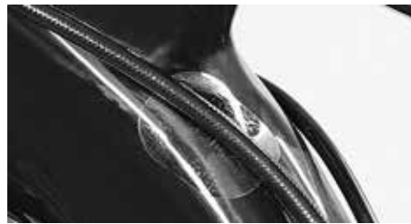
Spezielle Aufkleber schützen Carbon vor Beschädigungen
