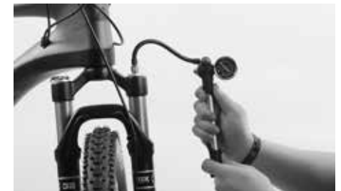
Einstellung der Federhärte mit einer Dämpferpumpe
