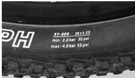
Dimension und Luftdruckbereiche des Reifens
