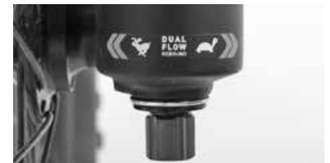
Zugstufendämpfung verzögert das Ausfedern
