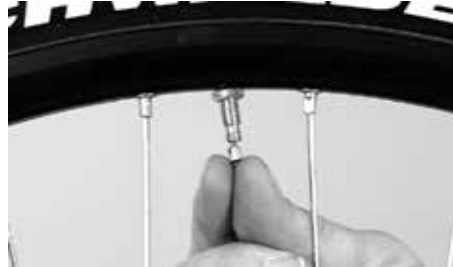
Beim Renn- oder Sclaverandventil muss das Ventil aufgeschraubt werden
