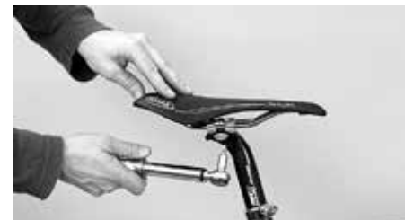
Drehen Sie beide Schrauben abwechselnd und gleichmäßig an, überschreiten Sie niemals das maximal zulässige Drehmoment
