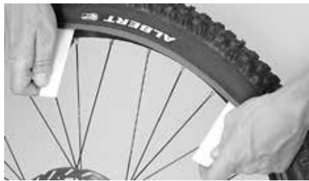
Ansetzen des Montierhebels und Hebeln der Reifenflanke über den Felgenrand
