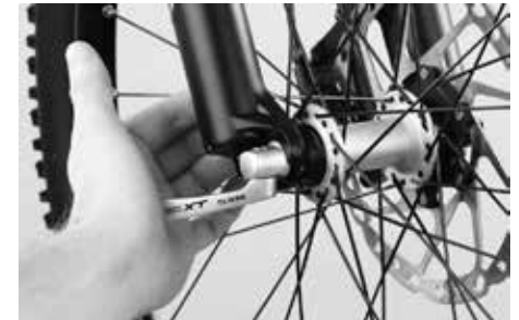
Prüfen Sie, ob die Laufräder noch sicher geklemmt sind
