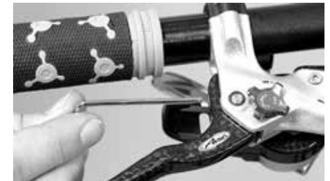
Einstellen der Griffweite des Bremshebels
