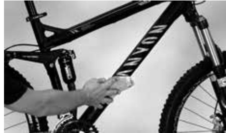
Reinigen mit Wasser und weichem Lappen
