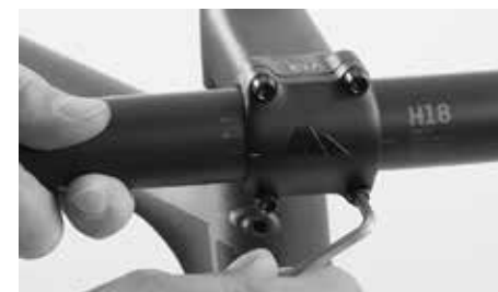
Solte o(s) parafuso(s) de sextavado interior na parte da frente do avanço
