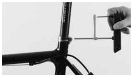
Não aperte o parafuso de fixação do espigão do selim com demasiada força
