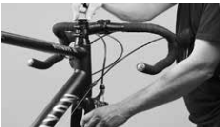
Coloque a tampa terminal, carregue-a de encontro ao garfo, agarrando-o, e aperte depois o avanço ajustado com os binários de aperto prescritos
