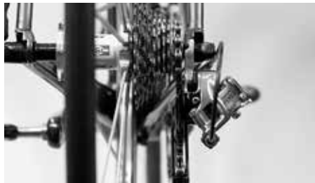
Verifique se a corrente ainda se encontra sobre os pratos da corrente e sobre os pinhões
