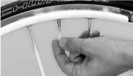
Desenroscar da tampa de plástico
