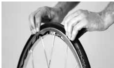
Pressione o pneu, para ter a certeza que a câmara de ar não está entalada
