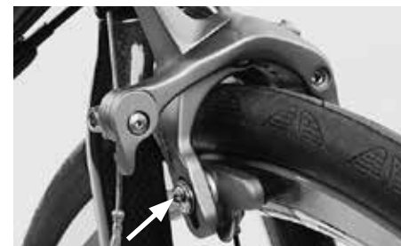
Para o ajuste em altura, aperte o parafuso de fixação do calço com o binário de aperto prescrito
