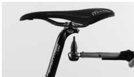
Aperte os dois parafusos alternadamente e de forma homogênea, não exceda jamais o binário de aperto máximo prescrito
