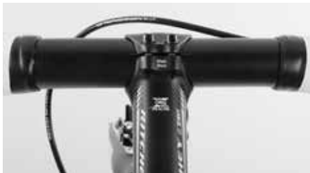
As ranhuras entre a tampa do avanço e o corpo do avanço devem ficar paralelas e apresentar a mesma largura em cima e em baixo
