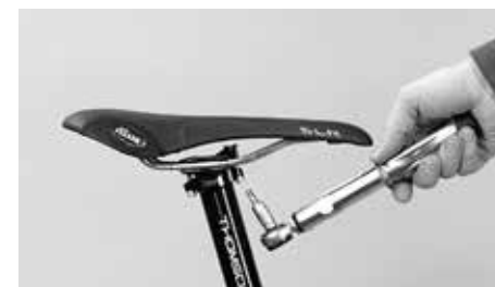
Aperte os parafusos, alternadamente e de forma homogênea, com os binários de aperto prescritos
