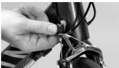
Ajuste o curso necessário da manete no guiador com a porca serrilhada
