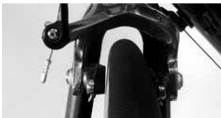
Controle da concentricidade com os travões
