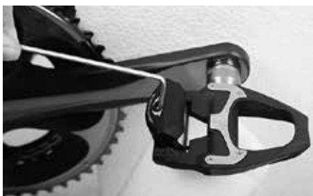
Ajuste da força de encaixe dos pedais
