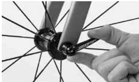
Verifique a fixação, tentando torcer a alavanca na posição de fechada
