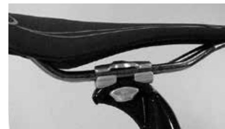
Posicione o selim de tal maneira, que a armação seja fixada dentro da marcação
