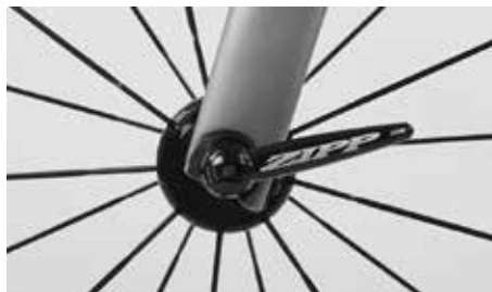
Na sua posição final a alavanca tem de ficar perpendicular ao eixo de aperto rápido
