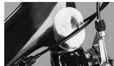
Autocolantes especiais protegem o carbono de danos
