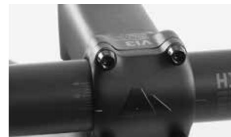
A ranhura superior tem de ficar completamente fechada
