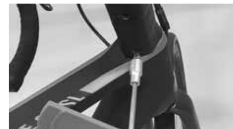
Aperte o parafuso da placa de transição
