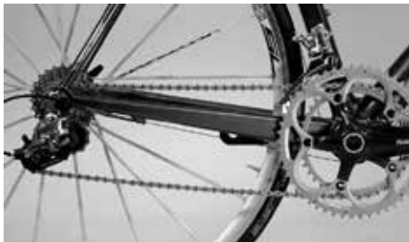
Guardar a bicicleta com a corrente no pinhão menor e no prato menor
