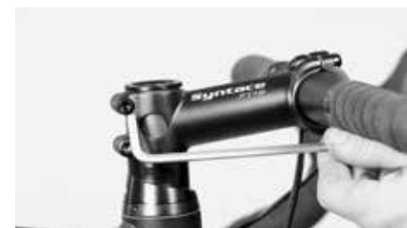
Solte os parafusos laterais do avanço
