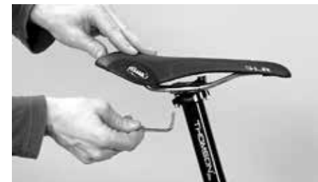
Desaperte os dois parafusos, dando no máximo 2 a 3 voltas
