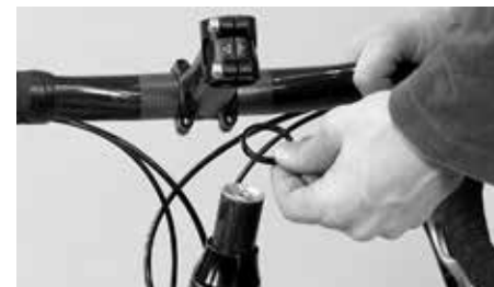
Extraia as anilhas espaçadoras e coloque-as de novo na parte superior do avanço
