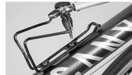
Siga um binário de aperto máximo de 5 Nm, ao instalar o suporte para garrafas
