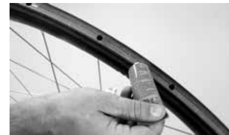
Aplicação da cola cimento para pneus, diretamente com o tubo
