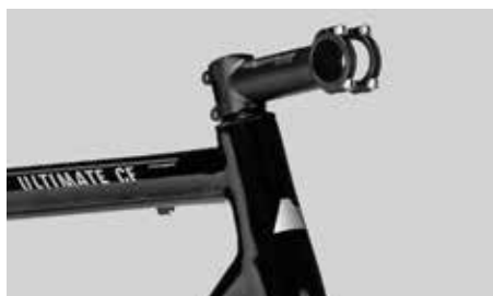
Caixa de direção afinada e montada com avanço e garfo
