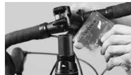
Aplique, se necessário, massa de carbono para montagem no tubo do garfo ou no guiador
