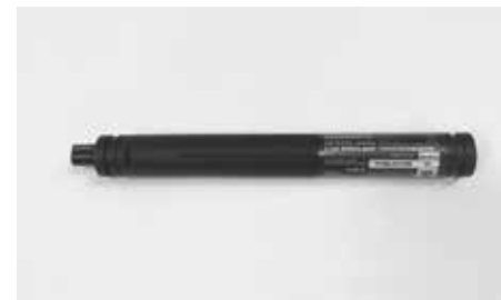
A bateria da Di2 também pode estar montada no tubo inferior de forma camuflada
