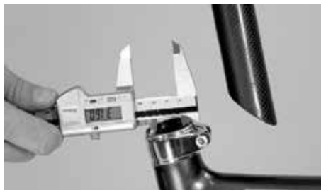
Certifique-se de que o espigão do selim se adapta exatamente ao quadro
