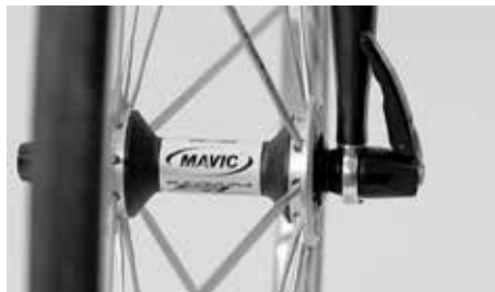
A alavanca do aperto rápido deve estar mais ou menos paralela relativamente à roda e não deve ficar em pé lateralmente
