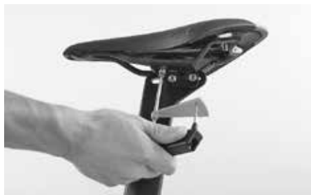
Aperte o parafuso com uma chave dinamométrica Canyon
