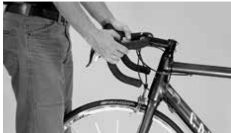
Tente rodar o guiador contra a roda dianteira
