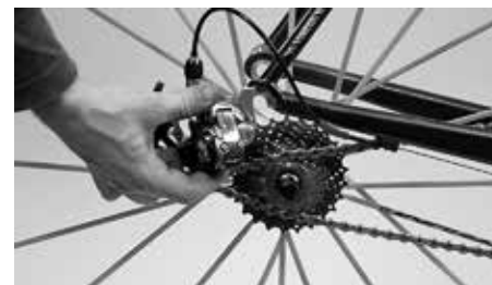
Na desmontagem da roda traseira, puxar o desviador traseiro um pouco para trás
