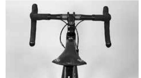
Examine o selim e o tubo superior atentamente com o olhar, para garantir que o selim não está desalinhado
