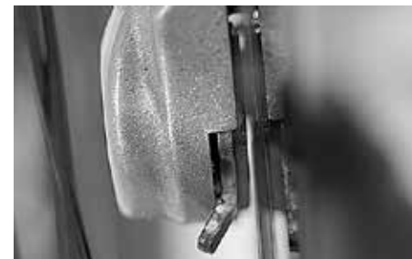
Controlo do desgaste das pastilhas
