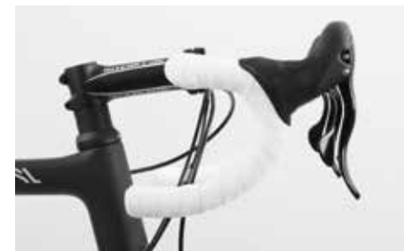
A parte direita da barra inferior deve estar, ou paralela ao chão, ou levemente inclinada para baixo
