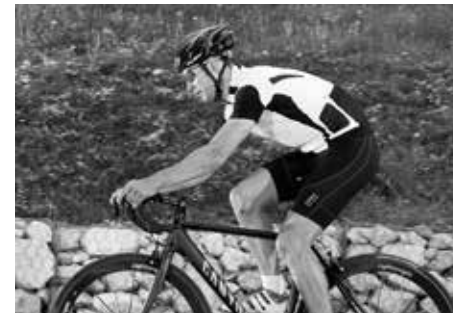
A distância entre os punhos do guiador e o selim tem influência sobre a inclinação das costas
