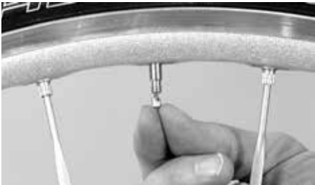
Na válvula Presta a válvula tem que ser desenroscada
