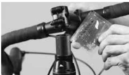
Espalhe massa de carbono para montagem sobre o tubo do garfo
