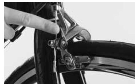
Abertura da alavanca de libertação rápida do travão
