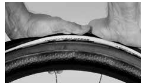
Empurre o pneu para o lado até se formar um intervalo
