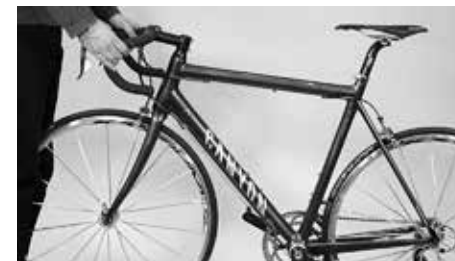
Tente rodar o guiador contra a roda dianteira e contra o avanço
