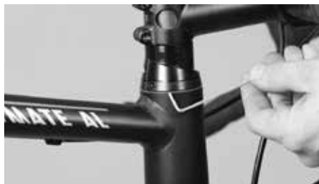
Ajuste a folga dos rolamentos com o parafuso lateral de ajuste
