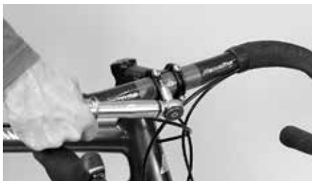
Aperte novamente os parafusos com os binários de aperto prescritos
