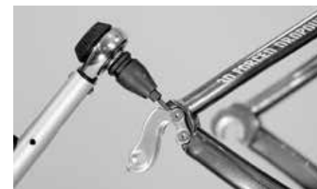
Quando troca de dropout substituível, não deve ultrapassar de forma alguma o binário de aperto máximo de 1,5 Nm
