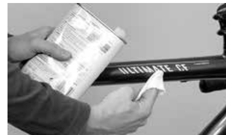
Tratamento do verniz e das superfícies metálicas com cera dura
