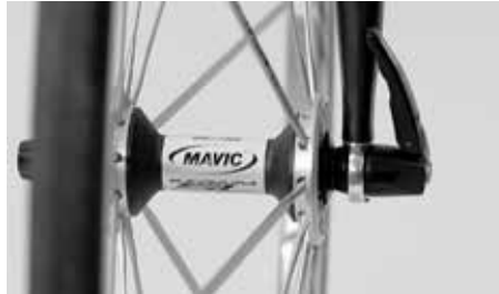
Verifique se as rodas ainda estão bem fixadas nas ponteiras
