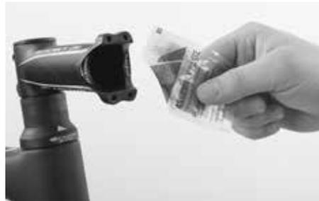
Das ist besonders in den Klemmbereichen von Lenker und Vorbau, Gabelschaftrohr und Vorbau, Sattelstütze und Sitzrohr sinnvoll – drei Klemmbereichen, bei denen zu hohe Klemmkraft die Bauteile zerstören kann, wodurch diese versagen können oder die Garantie erlischt. Mit Canyon Montagepaste wird durch die Verringerung der Klemmkraft der eventuellen Zerstörung der Carbonfasern vorgebeugt. Außerdem wird häufig vorkommendes Knacken an den Klemmstellen verhindert.
