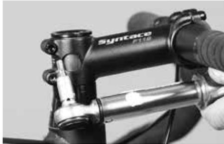
Kontrollieren Sie die seitlichen Vorbau-Klemmschrauben mit dem Drehmomentschlüssel gemäß den aufgedruckten Angaben
