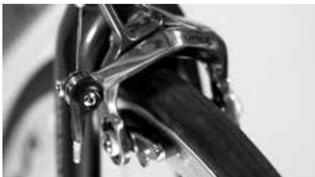
Prüfen des Rundlaufs mit Hilfe der Bremse
