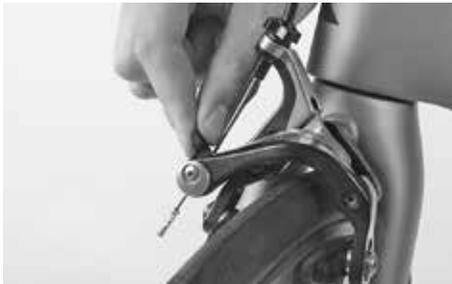
Schließen Sie den Entspannhebel an der Bremse (Shimano, SRAM) sofort wieder oder schieben Sie den Stift am Brems-/Schalthebel bei leicht gezogenem Bremshebel zurück (Campagnolo).
