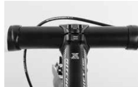
Kontrollieren Sie bei allgemeinen Aheadset®-Vorbauten mit Frontdeckel, ob die Schlitz zwischen Vorbaudeckel und Vorbaukorpus in sich parallel und oben und unten gleich breit sind. Lösen Sie ggf. die Klemmschrauben und drehen Sie sie gleichmäßig leicht an.
