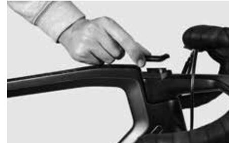
Stecken Sie dann die Zwischenringe (Spacer) je nach gewünschter Sitzposition oberhalb oder unterhalb des Vorbaus auf. Achten Sie darauf, dass immer alle Spacer verbaut werden. Sie können die Spacer zu einem späteren Zeitpunkt wieder von oben nach unten tauschen; nur weglassen können Sie keinen der Spacer.
