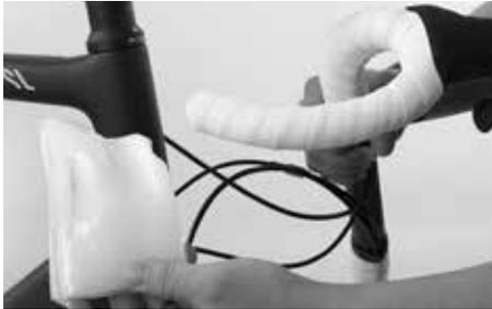
Entfernen Sie die Schutzfolie und die Schutzhüllen von der Lenker-Vorbaukombination. Versuchen Sie dies grundsätzlich von Hand. Wenn dies nicht gelingt, verwenden Sie bevorzugt eine Schere, nur zur Not ein Teppichschneidemesser. Lassen Sie die Lenker-Vorbaukombination vorsichtig herunterhängen.
