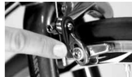
Prüfen des Rundlaufs mit Hilfe der Bremsbeläge
