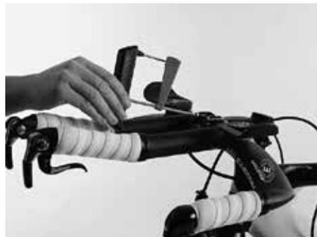
Lenkermontage mit dem Canyon Drehmomentschlüssel
