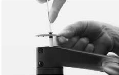
Legen Sie den abgenommenen Deckel oben auf und drehen Sie die Schraube mit dem Canyon-Drehmomentschlüssel mit 2 Nm fest. Positionieren Sie die Lenker-Vorbaukombination mittig. Peilen Sie über die Lenker-Vorbaukombination zum Vorderrad, um die Ausrichtung des Lenkers quer dazu bzw. die des Vorbaus parallel dazu auszurichten.
