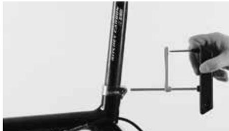
Ziehen Sie die Schraube der Sattelstützenklemme nicht zu fest an
