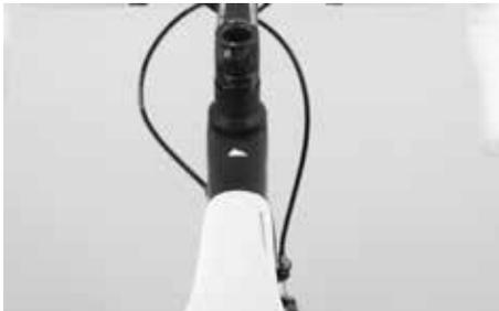
Kontrollieren Sie, dass der Sattel mittig ausgerichtet ist. Peilen Sie über den Sattel auf das Ober- und Unterrohr des Rahmens.
