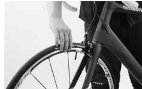
Versetzen Sie beide Laufräder in Drehbewegung und kontrollieren Sie, ob das Rad rund läuft.
