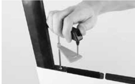
Drehen Sie die Innensechskantschraube der Sattelstützenklemmung mit dem angegebenen Drehmoment von 4 Nm bis maximal 6 Nm an.
