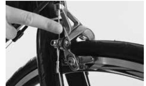
Öffnen des Entspannhebels an der Bremse
