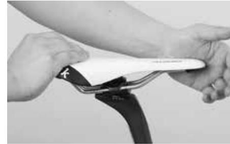
Kontrollieren Sie den festen Sitz der Sattelstütze auf sicheren Sitz. Versuchen Sie, die Bauteile zu verdrehen.
