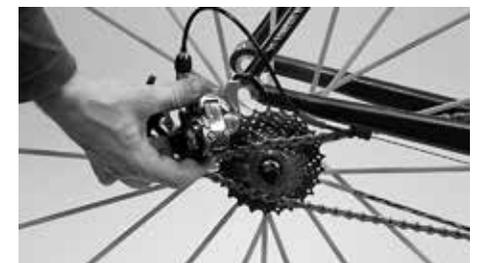
Zum Ausbau des Hinterrades das Schaltwerk etwas nach hin- tenziehen
