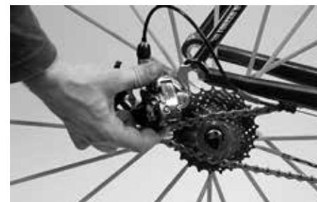
Betätigen Sie den rechten Schalthebel so oft, bis das Schaltwerk ganz außen steht. Ziehen Sie das Schaltwerk etwas nach hinten, positionieren Sie die Kette auf dem äußersten Zahnrad der Zahnkranzkassette und bauen Sie das Hinterrad ein. Achten Sie darauf, dass das Laufrad korrekt in den Ausfallenden sitzt.
