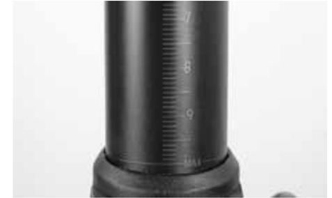
Schieben Sie die Sattelstütze bis zur benötigten Sitzhöhe in das Sattelrohr ein. Ihre Sattelstütze muss mindestens bis unterhalb des Oberrohres bzw. bis zur MAX-Markierung der Stütze im Rahmen stecken. Die Klemmung darf nur im auf der Sattelstütze markierten Bereich erfolgen. Richten Sie den Sattel samt Sattelstütze aus und drehen Sie die Schraube der Sattelrohrklemmung mit dem Canyon Drehmomentschlüssel leicht an.
