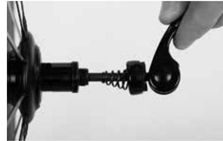
Auf jeder Seite der Nabe muss jeweils eine Feder platziert werden. Achten Sie darauf, dass die Feder mit dem kleinen Durchmesser auf beiden Seiten des Schnellspanners zur Nabenachse zeigt.
