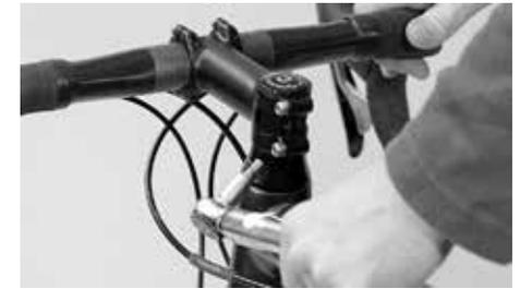
Ziehen Sie die seitlichen Vorbau-Klemmschrauben mit dem Drehmomentschlüssel wieder an
