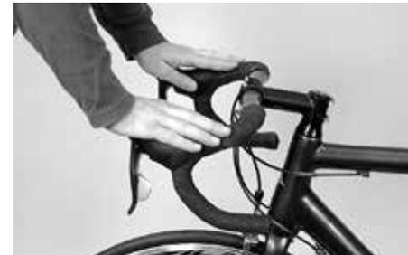
Kontrollieren Sie den festen Sitz des Lenkers und der Brems-Schaltgriffe auf sicheren Sitz. Versuchen Sie, die Bauteile zu verdrehen. Der Lenker darf sich auch bei einem kräftigen Ruck nicht nach unten verdrehen. Ziehen Sie die Klemmschraube(n) ggf. vorsichtig nach.
