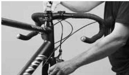
Setzen Sie die Abschlusskappe auf, drücken Sie diese zur festgehaltenen Gabel hin und ziehen Sie dann den ausgerichteten Vorbau mit dem vorgeschriebenen Drehmoment wieder fest
