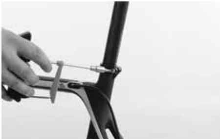
Richten Sie den Sattel aus und drehen Sie die Schraube der Sattelrohrklemmung nicht zu fest, d.h. nicht über das maximal zulässige Drehmoment an. Verwenden Sie den Canyon Drehmomentschlüssel.
