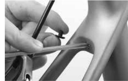
Nehmen Sie die Schutzkappe bzw. den Gummistopfen hinten vom Sattelrohr im Bereich, in dem die Streben auf das Rohr treffen. Öffnen Sie die Schraube an der Sattelrohrklemmung einige Umdrehungen. Sie müssen die Schraube nicht ganz herausdrehen. Die Sattelstütze muss ohne Drücken oder Drehen leicht in den Rahmen gleiten. Sollte dies nicht gelingen, öffnen Sie die Sattelrohrklemmung etwas mehr.
