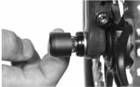
Ziehen Sie den RWS-Spannhebel leicht heraus, um diesen in eine günstige Position zu bringen. Drehen Sie den RWS-Spannhebel dann in die gewünschte Position und schieben Sie den RWS-Spannhebel wieder zur Nabe hin.
