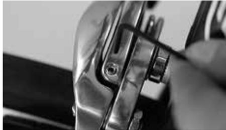
Drehen Sie an der kleinen Schraube, bis die Beläge links und rechts den gleichen Abstand zur Felge haben
