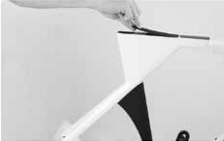
Alle Canyon Modelle mit integrierter Klemmung (z.B. Speedmax CF) haben eine aerodynamisch geformte Sattelstütze. Die Montage einer anderen als der serienmäßigen Sattelstütze ist dadurch nicht möglich.
