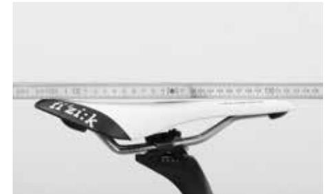
Kontrollieren Sie, ob der Sattel bei waagrecht stehendem Fahrrad ebenfalls waagrecht ausgerichtet ist.
