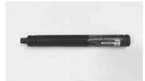
Die Di2-Batterie kann auch im Unterrohr verborgen montiert sein
