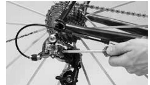
Begrenzen Sie den Schwenkbereich des Schaltwerkes durch die Endanschlagschrauben
