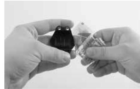
Weiterhin garantiert es maximalen Schutz vor Korrosion und verhindert diese wirkungsvoll auch unter nassen Bedingungen. Canyon Montagepaste kann für alle Carbon- und Aluminiumverbindungen verwendet werden. Sie ist für diesen Zweck ideal, da sie nicht aushärtet.
