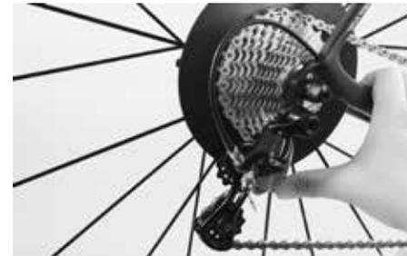
Schalten Sie alle Gänge durch und prüfen Sie, ob sichergestellt ist, dass das hintere Schaltwerk nicht mit den Speichen in Kontakt geraten kann, wenn die Kette auf dem größten Zahnrad läuft.
