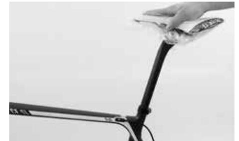
Die Sattelstütze muss ohne Drücken oder Drehen leicht in den Rahmen gleiten. Sollte dies nicht gelingen, öffnen Sie die Sattelrohrklemmung etwas mehr.
