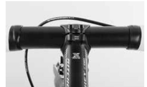
Drehen Sie die Klemmschrauben des Vorbaudeckels gleichmäßig und über Kreuz an, bis der Lenker leicht klemmt.
