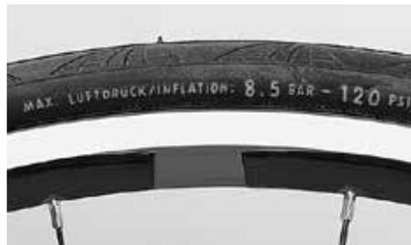
Luftdruckbereich des Reifens
