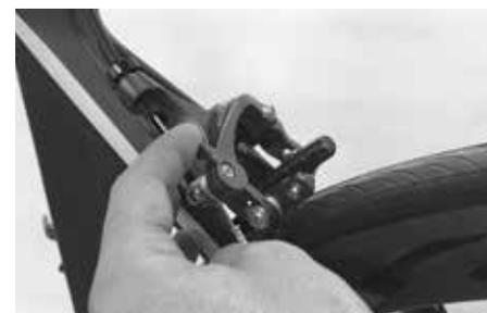
Öffnen Sie die Hinterrad-Bremse durch Lösen des Entspannhebels an der Bremse (Shimano, SRAM) oder indem Sie den Stift im Bremshebel verschieben (Campagnolo), so dass der Hebel etwas nach hinten kippen kann.
