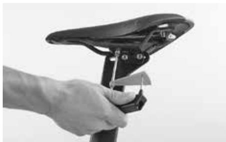
Drehen Sie die Schraube mit einem Canyon Drehmomentschlüssel fest
