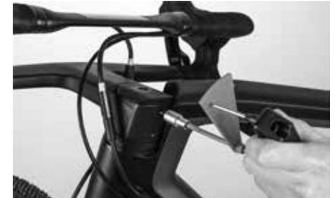
Drehen Sie die Schrauben des ausgerichteten GRAIL-Cockpits mit dem Canyon Drehmomentschlüssel mit **7,5 Nm** fest.
