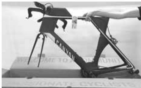
Einige Rennrad Modelle mit größerem Rahmen werden mit ausgebautem Hinterrad ausgeliefert.
