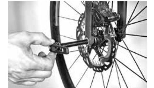
Richten Sie das Vorderrad zwischen den Radaufnahmen aus und schieben Sie die Steckachse mit geöffnetem Schnellspannhebel von links durch die Radaufnahme und die Nabe.
