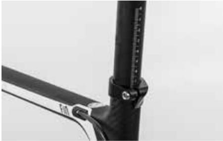
Schieben Sie die Sattelstütze bis zur benötigten Sitzhöhe in das Sitzrohr ein.
