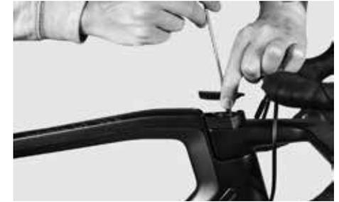
Legen Sie den Deckel oben auf und drehen Sie die Schraube mit dem Canyon Drehmomentschlüssel mit **maximal 2 Nm** fest.
