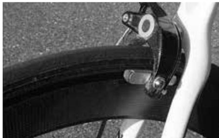
Carbonfelgen brauchen spezielle Bremsbeläge gemäß der Anleitung des Laufradherstellers
