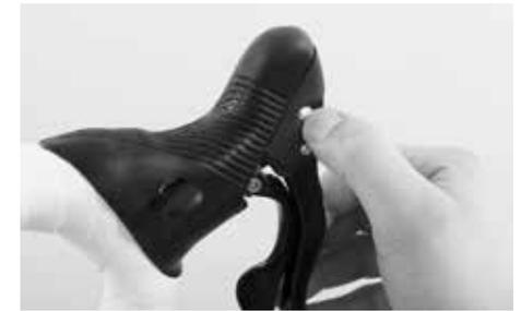
Entfernen Sie die Schutzfolie am Brems-/Schalt- hebel.
