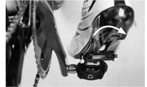
Die Verbindung wird durch Drehen der Ferse nach außen gelöst
