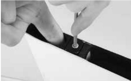
Drücken Sie innen im Sitzrohr von hinten auf den Klemmechismus und drehen Sie gleichzeitig die oben liegende Schraube etwas lose. Halten Sie ein, sobald der obere Teil der Klemmung bündig mit der Oberkante des Oberrohres ist oder maximal einen Millimeter übersteht.
