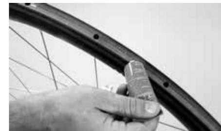
Verteilen des Reifenklebers direkt aus der Tube
