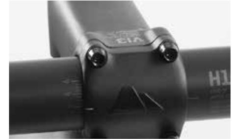
Bei Canyon Vorbauten ist der Schlitz oben vollständig geschlossen und nur unten ein Spalt erkennbar.
