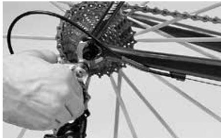
Prüfen Sie, ob sichergestellt ist, dass das hintere Schaltwerk nicht mit den Speichen in Kontakt geraten kann, wenn die Kette auf dem größten Zahnrad läuft. Drücken Sie aktiv gegen das Schaltwerk damit eine Kollision ausgeschlossen ist und versetzen Sie das Laufrad in langsame Drehbewegung.
