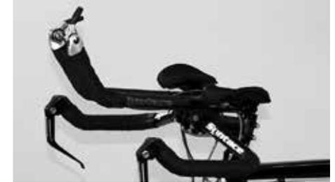
Lenkerendschalthebel steuern Schaltwerk und Umwerfer an
