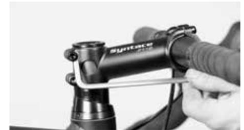
Lösen Sie die Schrauben seitlich am Vorbau
