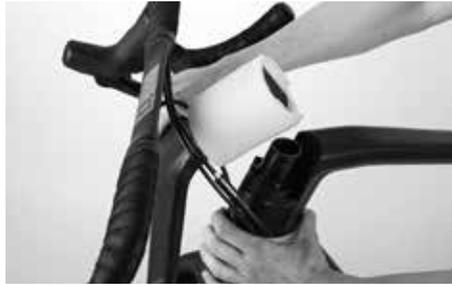
Halten Sie die Lenker-Vorbaukombination fest und lösen Sie oben am Vorbau das Band mit Klettverschluss, das den Lenker fixiert.
