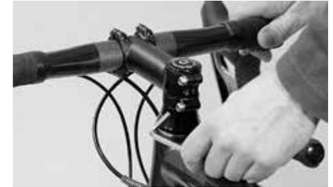
Lösen Sie die Schrauben seitlich am Vorbau
