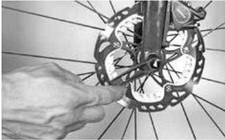
Sobald die gegenüberliegende Seite erreicht ist, drehen Sie die Steckachse im Uhrzeigersinn in die Mutter der rechten Seite. Wenden Sie keine Kraft an, sondern achten Sie darauf, dass das Gewinde der Achse sauber in die Mutter der anderen Seite greift.
