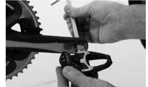
Drehen Sie die Pedale von Hand die ersten zwei bis drei Umdrehungen in die Gewinde der Kurbeln ein.
