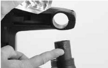
Lösen Sie die Schraube oben am Vorbau und nehmen Sie diese mit dem Deckel ab. Öffnen Sie eine Ecke der Canyon Montagepaste. Drücken Sie etwas Montagepaste heraus und bestreichen Sie sowohl das Vorbaauge innen als auch den Klemmbereich des Gabelschaftes dünn mit Canyon Montagepaste.
