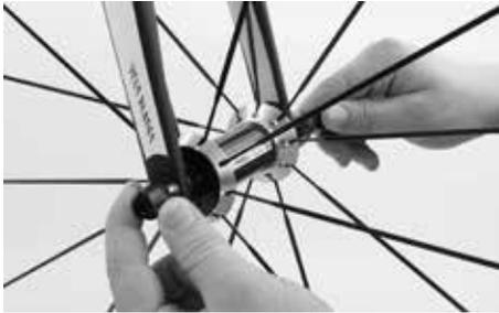
Drehen Sie die Gegenmutter bei geöffnetem Schnellspannhebel zu, bis der Hebel beim Schließen Kraft aufbaut. Achten Sie darauf, dass sich der geschlossene Hebel eng an die Gabel schmiegt und keinesfalls zur Seite oder nach vorne hin absteht.
