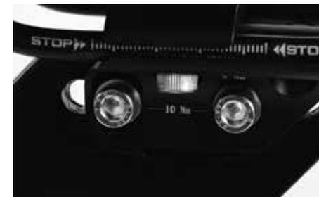
Ein Überschreiten des maximalen Drehmomentes an den Klemmschrauben (z.B. am Vorbau, Gabelschaft, Lenker oder Sattelstütze) führt zu einer zu hohen Klemmkraft. Diese kann das Versagen des Bauteils mit sich bringen und birgt daher ein hohes Unfallrisiko. Darüber hinaus wird in diesem Fall die Produktgarantie unwirksam. Zu lockere oder übermäßig festgedrehte Schrauben können zu einem Versagen und deshalb zu einem Unfall führen. Halten Sie sich genau an die Drehmomentangaben von Canyon.
