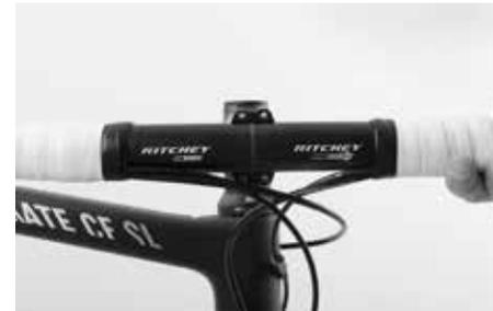
Stecken Sie den passenden Bit in die Aufnahme des Canyon Drehmomentschlüssels. Drehen Sie die Klemmschrauben des Vorbaudeckels heraus und nehmen Sie den Deckel ab.
