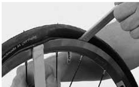
Ansetzen des Montierhebels und Hebeln der Reifenflanke über den Felgenreand
