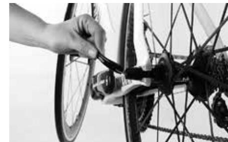
Schließen Sie den Schnellspanner oder die Steckachse so, dass das Laufrad sicher befestigt ist. Lesen Sie die Kapitel „Umgang mit Schnellspannern und Steckachsen“ und „Montage des Vorderrades“.
