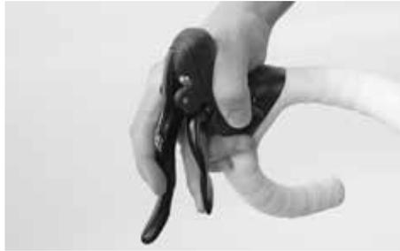
Kontrollieren Sie die Schaltungsfunktion. Bitten Sie einen Helfer, das Fahrrad am Sattel hochzuheben und schalten Sie vorsichtig alle Gänge durch.
