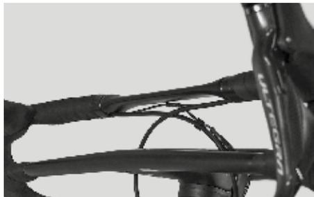
Schieben Sie dann die Lenker-Vorbaukombination auf den Gabelschaft. Achten Sie dabei darauf, dass die Hydraulikleitungen und Bremszüge oberhalb der Vorbaueinheit verlaufen, nicht verdreht oder abgeknickt sind und in gleichmäßigen Radien zu den Anschlüssen oder der Bremse verlaufen.
