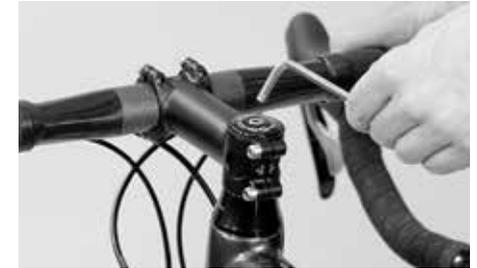
Stellen Sie, nach dem Lösen der seitlichen Klemmschrauben, mit der oben versenkt liegenden Einstellschraube das Lagerspiel ein
