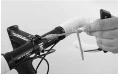
Drehen Sie die Schrauben abschließend gleichmäßig und über Kreuz an und mit dem aufgedruckten Drehmoment fest.
