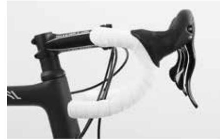
Kontrollieren Sie, ob die oberen Griffbereiche der Brems-Schaltgriffe waagrecht positioniert sind. Richten Sie die Lenkerenden im Winkel des Oberrohrs aus.
