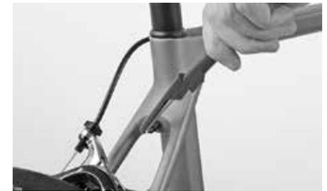
Verwenden Sie den beiliegenden Drehmomentschlüssel und drehen Sie bis zum erforderlichen Drehmoment fest. Überschreiten Sie das maximal zulässige Drehmoment von 5 Nm nicht. Kontrollieren Sie den festen Sitz der Sattelstütze im Rahmen indem Sie den Sattel vorne und hinten packen und versuchen diesen zu verdrehen. Drücken Sie den Gummistopfen wieder in den Kopf der Innensechskantschraube im Sitzrohr.
