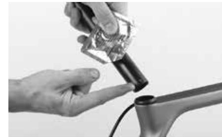
Ziehen Sie die Sattelstütze nochmals heraus. Verteilen Sie nun etwas Canyon Montagepaste auf dem unteren Teil der Sattelstütze und innen am Sitzrohr des Rahmens bzw. auf dem Klemmbereich der Sattelstütze.
