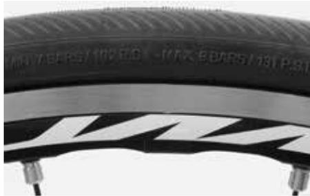
Pumpen Sie beide Reifen maximal mit dem auf der Reifenflanke ausgewiesenen Druck auf. Mehr zum Thema „**Reifen und Schläuche**“ finden Sie im Kapitel „**Die Laufräder – Reifen Schläuche und Luftdruck**“ in Ihrem Fahrradhandbuch Rennrad auf der beiliegenden CD.
