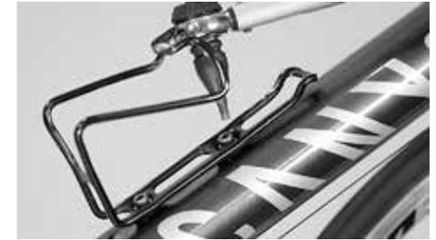
Halten Sie sich beim Flaschenhalter an ein maximales Drehmoment von 5 Nm
