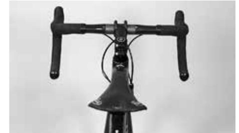
Peilen Sie über den Sattel entlang des Oberrohres, um sicherzustellen, dass er nicht verdreht ist
