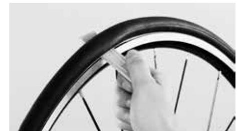
Mit einem Montierhebel lässt sich der Reifen herunterhebeln
