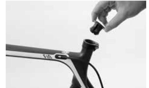
Nehmen Sie die Schutzkappe am oberen Ende des Sitzrohres ab. Öffnen Sie die Schraube an der Sattelrohrklemmung. Lesen Sie zuvor das Kapitel „Anpassen des Canyon Rennrades an den Fahrer“ in Ihrem Fahrradhandbuch Rennrad und auf der beiliegenden CD.
