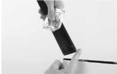
Verteilen Sie etwas Canyon Montagepaste auf dem unteren Teil der Sattelstütze und innen am Sattelrohr des Rahmens. Schieben Sie die Sattelstütze bis zur gewünschten Sitzhöhe in das Sattelrohr. Ihre Sattelstütze muss mindestens bis unterhalb des Oberrohres bzw. bis zur MAX-Markierung der Stütze im Rahmen stecken. Die Klemmung darf nur im auf der Sattelstütze markierten Bereich erfolgen.
