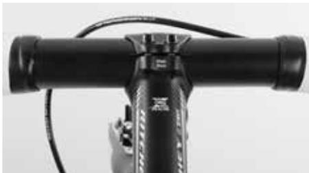
Die Schlitzlöcher zwischen Vorbaudeckel und Vorbaukörper müssen in sich parallel und oben und unten gleich breit sein
