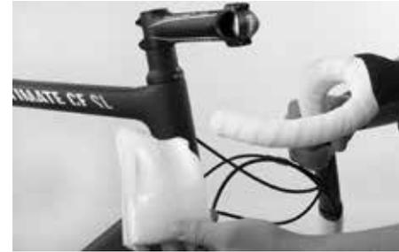
Entfernen Sie die Schutzfolie und die Schutzhüllen am Lenker. Versuchen Sie dies grundsätzlich von Hand. Wenn dies nicht gelingt, verwenden Sie bevorzugt eine Schere, nur zur Not ein Teppichschneidemesser.
