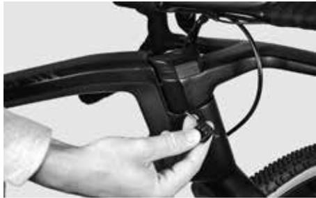
Um das Lenkungslager zu justieren, muss diese Transitionplate genauso gelöst werden wie die Gabelschaftklemmung am GRAIL-Cockpit.
