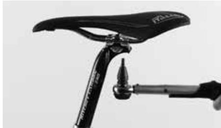
Drehen Sie beide Schrauben abwechselnd und gleichmäßig an, überschreiten Sie niemals das maximal zulässige Drehmoment
