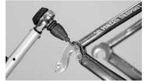
Beim Austausch des wechselbaren Schaltauges dürfen sie keinesfalls das maximale Drehmoment von 1,5 Nm überschreiten
