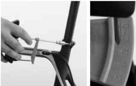
Drehen Sie langsam am Griff des Canyon Drehmomentschlüssels. Wird die Schraube fest, wandert der Zeiger über die Skala. Beenden Sie die Drehbewegung, sobald der Zeiger auf der Zahl des vorgegebenen Drehmomentes steht.
