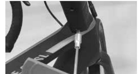
Drehen Sie die Schraube der Transitionplatte an
