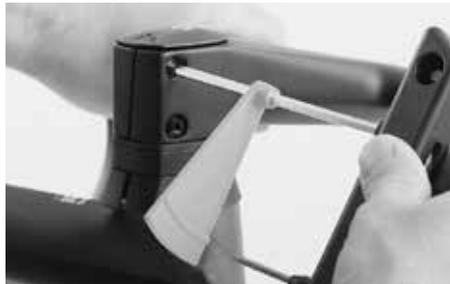
Stecken Sie den passenden Bit in die Aufnahme des Canyon Drehmomentschlüssels. Drehen Sie die Klemmschrauben des Vorbaus zuerst gleichmäßig leicht an. Kontrollieren Sie, dass der Schlitz gleichmäßig verläuft. Drehen Sie die Schrauben abschließend mit dem aufgedruckten Drehmoment (5 Nm) fest.
