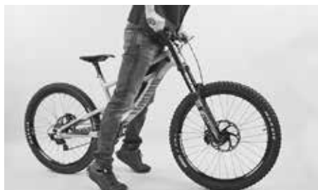
Paina etuhaarukkaa alaspäin etupyörän jarrun ollessa vedettynä
