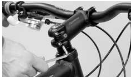
Avaa ohjainkannattimen sivulla olevat ruuvit
