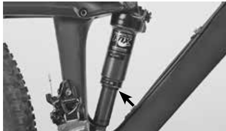
Takajousituksen O-rengas aivan ylhäällä
