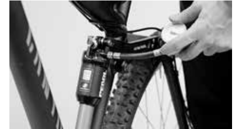
Tarkasta ilmanpaine säännöllisesti ilmajousitusten yhteydessä
