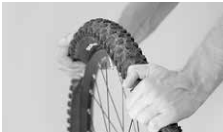
Purista rengasta molemmilta puolilta varmistaaksesi, ettei sisärenkas ole jäänyt puristuksiin
