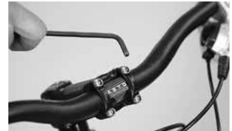
Avaa ohjainkannattimen etuosassa olevat ruuvit
