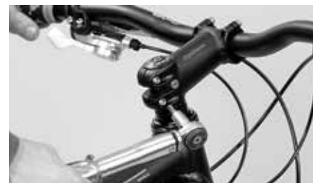
Kiristä sivuilla olevat ohjainkannattimen kiinnitysruuvit jälleen momenttiavaimella
