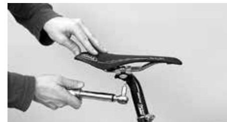
Kiristä molemmat ruuvit vuorotellen ja tasaisesti, älä missään tapauksessa ylitä suurinta sallittua kiristysmomenttia
