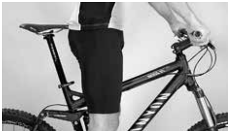
Vaakaputken korkeuden tarkastus
