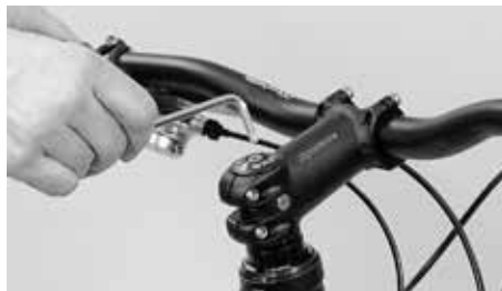
Säädä laakeri uudelleen ja kiristä ohjainkannatin tämän jälkeen jälleen
