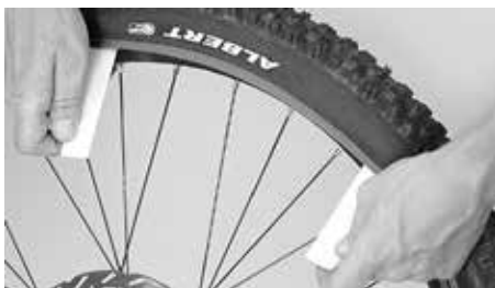
Asennusvivun asettaminen paikalleen ja renkaan reunan nostaminen vanteen reunan päälle
