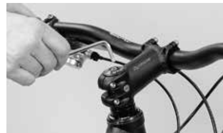
Säädä laakerin vällys ylhäällä olevalla upotetulla säätöruuvilla avattuasi sivulla olevat kiinnitysruuvit
