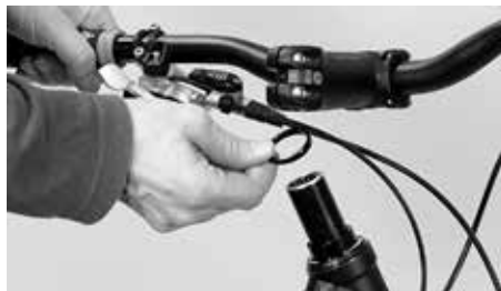
Poista välirenkaat ja työnnä ne takaisin paikalleen ohjainkannattimen yläpuolelle
