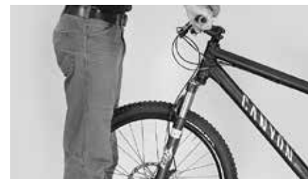
Yritä kääntää ohjaustankoa etupyörää vastaan
