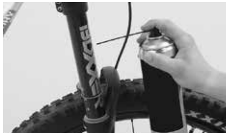
Levitä osiin puhdistuksen jälkeen hieman hyväksyttyä voiteluainetta
