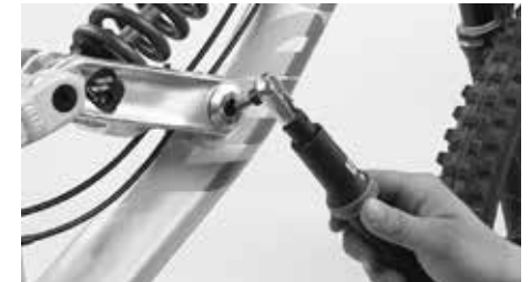
Tarkasta säännöllisesti kaikkien takarakenteen ruuvien tiukka kiinnitys määrättyjen vääntömomenttien mukaisesti
