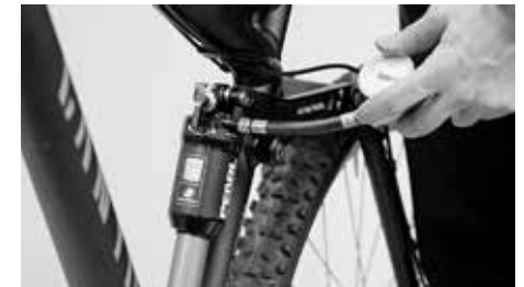
Ilmajouskunvaimentimien kohdalla säätö tehdään ilmanpainetta muuttamalla
