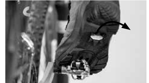
Click-polkimien kiinnitys avataan kääntämällä kantapäää ulospäin
