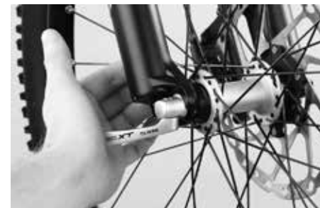
Tarkasta, ovatko kiekot vielä tiukasti kiinnitettyinä
