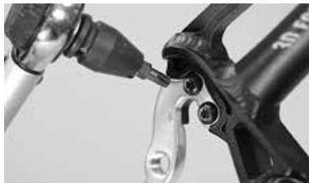
Jos vaihdat vaihtajankorvakkeen, älä missään tapauksessa ylitä suurinta sallittua 1,5 Nm:n kiristysmomenttia
