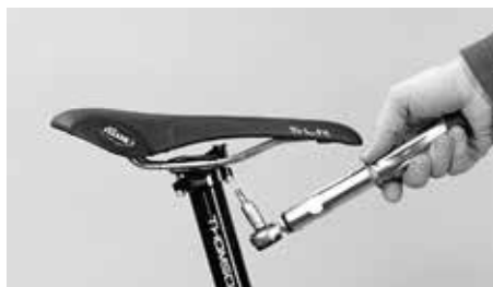
Kiristä ruuvit vuorotellen ja tasaisesti ohjeenmukaiseen kiristystiukuuteen
