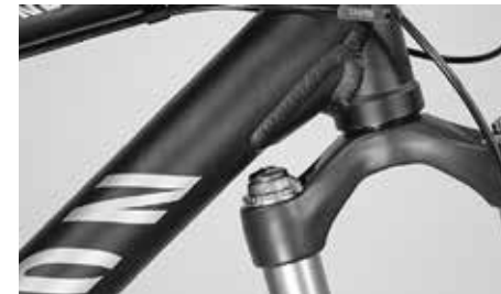
Kruunua on voitava kiertää kosketuksettomasti rungon alla
