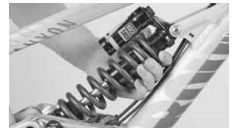
Teräsjousien kohdalla on käännettävä pyällettyä säätörengasta jousen jännityksen muuttamiseksi
