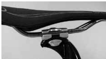
Kohdista satula niin, että satularunko kiinnitetään merkintöjen välille
