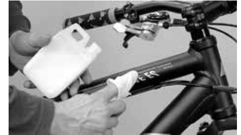
Maali- ja metallipintojen suojaaminen kovavahalla
