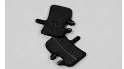
Jarrupalat, joiden paksuus on alle yhden millimetrin, on vaihdettava alkuperäisiin varaosiin
