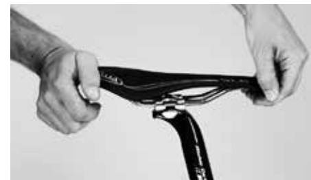
Kokeile, ettei kiinnitetty satula kallistu
