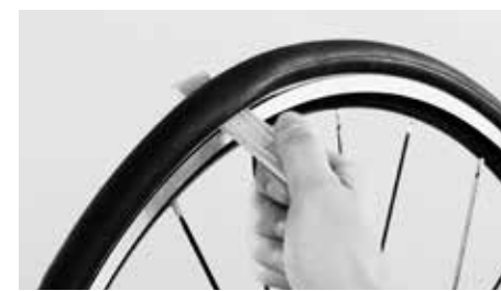
Il est possible de décoller le boyau en le soulevant à l'aide d'un démonte-pneu
