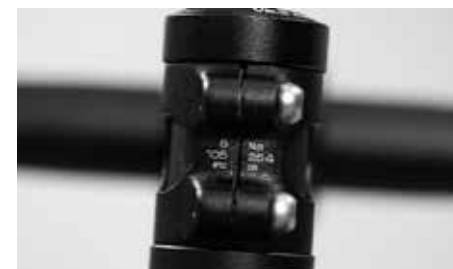
Tenez toujours compte des couples de serrage indiqués
