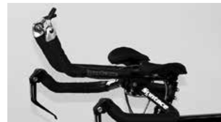
Les manettes de commande de vitesses montées sur prolongateur actionnent les dérailleurs avant et arrière
