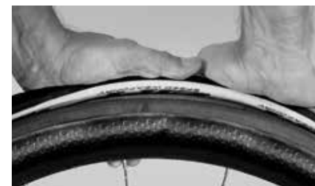
Appuyez de côté sur le boyau jusqu'à ce qu'il commence à se décoller
