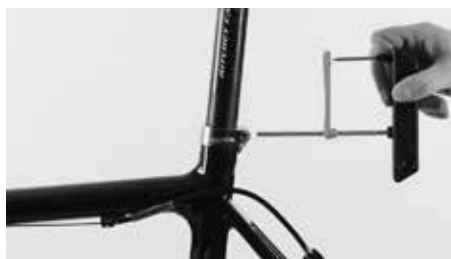
Ne serrez pas trop fort la vis de fixation de tige de selle sur le tube de selle
