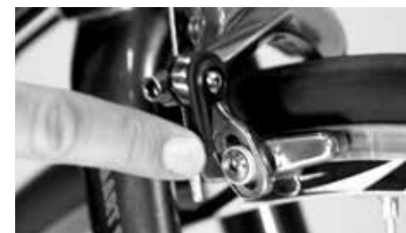
Vérification de l'absence de voile à l'aide du frein
