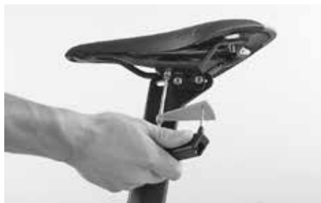
Serrez la vis à l'aide d'une clé dynamométrique Canyon
