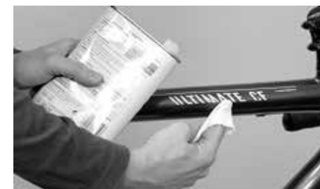
Entretien des surfaces peintes et métalliques avec de la cire dure
