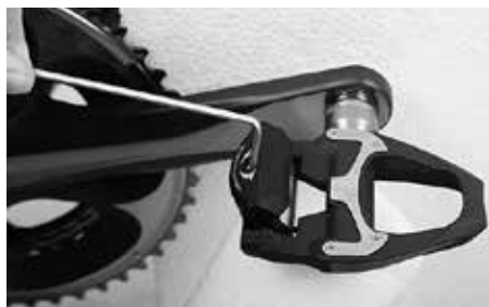
Réglage du seuil de déclenchement de la pédale
