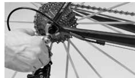
Vérifiez si le dérailleur arrière peut toucher les rayons
