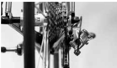
Vérifiez si la chaîne est encore engagée sur les plateaux et les pignons
