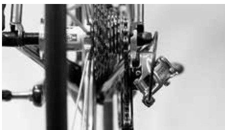
Examinez le jeu de pignons de derrière et vérifiez si les galets du dérailleur sont exactement sous les dents du pignon engagé
