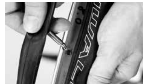
Introduction de la valve dans le trou de la jante
