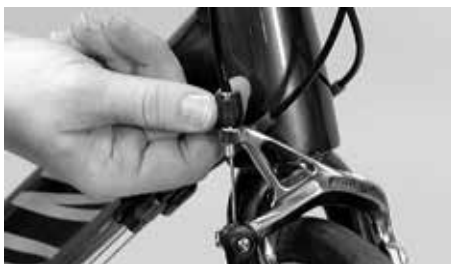
Ajustez la course requise du levier de frein à l'aide du barillet qui se trouve sur l'étrier
