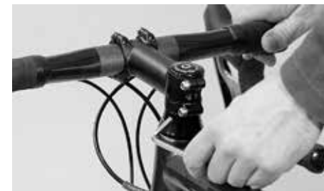
Desserrez les vis qui pincient la potence sur le pivot
