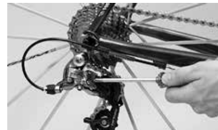
Limitez le débattement du dérailleur arrière à l'aide des vis de butée
