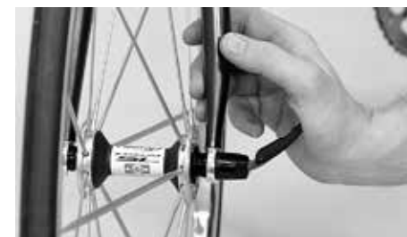
Serrage de l'attache rapide
