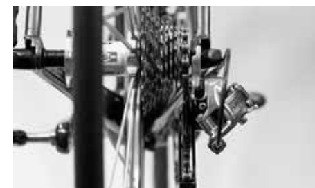
Passez sur le petit pignon avant de procéder au démontage de la roue arrière
