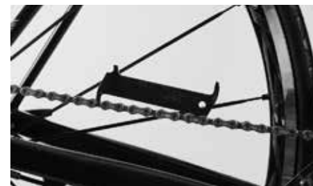
Vérification de l'état d'usure avec un outil professionnel
