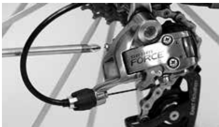
Pour régler l'écart entre la chape du dérailleur arrière et la denture, tournez la vis qui s'appuie sur le côté de la patte de fixation du dérailleur
