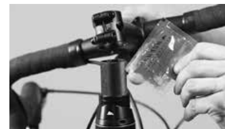
Appliquez éventuellement un peu de pâte de montage spéciale pour composants carbone sur les surfaces de contact du pivot de fourche ou du cintre avec la potence
