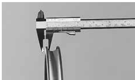
Faites contrôler l'épaisseur des parois de jante au plus tard après le remplacement du deuxième jeu de patins
