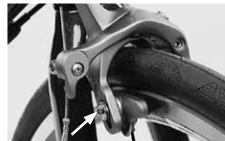
Après avoir ajusté la hauteur des patins, serrez les vis de fixation des porte-patins au couple de serrage prescrit
