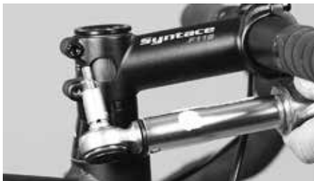
Vissez toutes les vis de fixation de la potence à l'aide d'un clé dynamométrique, en respectant les couples de serrage recommandés
