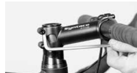
Desserrez les vis qui fixent la potence sur le pivot
