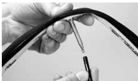
Montage du prolongateur de valve
