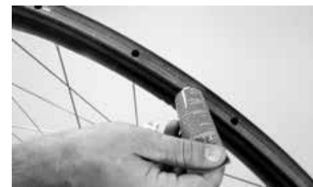
Encollage de la jante avec un tube de colle à boyau
