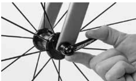
Pour contrôler la fiabilité du serrage, essayez de faire tourner le levier en position fermée
