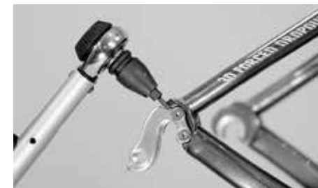
Lors du remplacement de la patte de dérailleur, ne dépassez en aucun cas le couple de serrage maximum de 1,5 Nm
