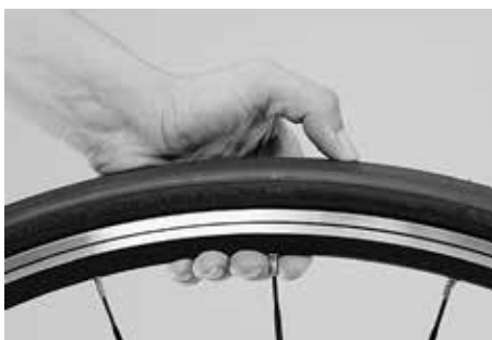
Contrôlez régulièrement la pression des pneumatiques
