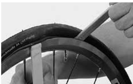
Introduction du démonte-pneu sous le talon du pneu et basculement du flanc de pneu par dessus le rebord de jante
