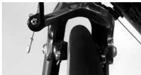
Vérification du centrage correct du boyau à l'aide du frein
