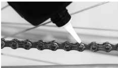
Appliquez du lubrifiant pour chaîne sur les maillons nettoyés
