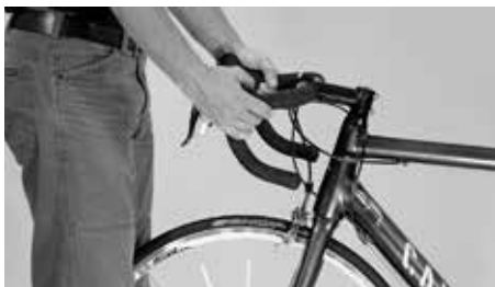
Essayez de faire pivoter le cintre par rapport à la roue avant
