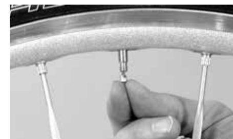
Sur les valves Presta ou Sclaverland, l'écrou moleté de la valve doit être desserré pour permettre le gonflage
