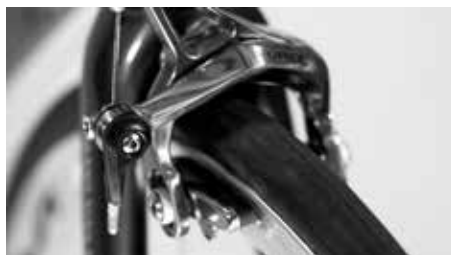
Vérification du centrage correct du boyau à l'aide du frein
