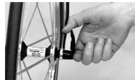
Desserrage de l'attache rapide
