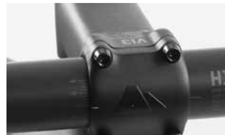
La fente supérieure doit se fermer complètement
