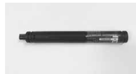
La batterie Di2 peut être installée de manière invisible dans le tube diagonal
