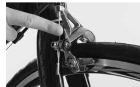
Ouverture du levier de détente sur l'étrier de frein
