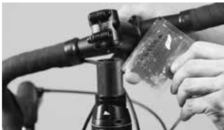
Appliquez un peu de pâte de montage spéciale pour carbone sur le pivot de fourche
