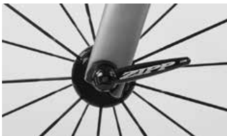
En position finale, le levier doit être perpendiculaire à l'axe de l'attache
