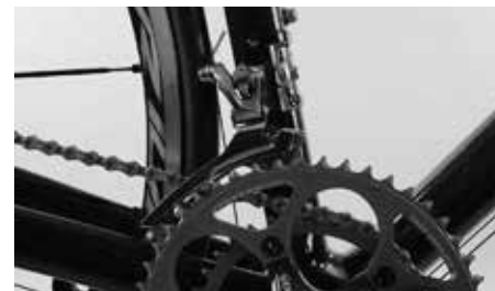
Réglage du débattement du dérailleur avant
