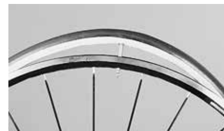
Introduisez la valve du boyau légèrement gonflé dans le trou de valve de la jante
