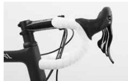
La partie basse et droite du cintre doit être parallèle au sol ou légèrement inclinée vers le bas
