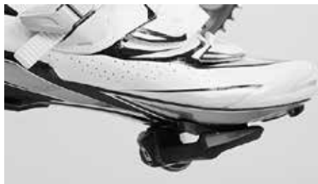
La cale ne doit pas empêcher le pied d'adopter une position naturelle en pédalant
