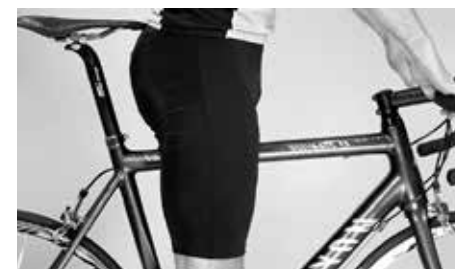
Veillez à un écart suffisant entre le tube supérieur et votre entre-jambes
