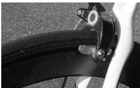
Les jantes en carbone nécessitent des patins de frein spéciaux conformes aux recommandations du fabricant de roues
