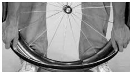
Logement du boyau dans le fond de jante
