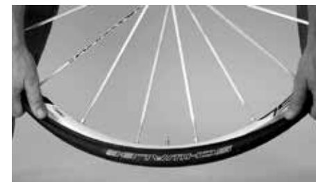
Introduction du pneu dans la jante
