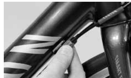
Réglage de la tension du câble sur le barillet de réglage sous le tube diagonal
