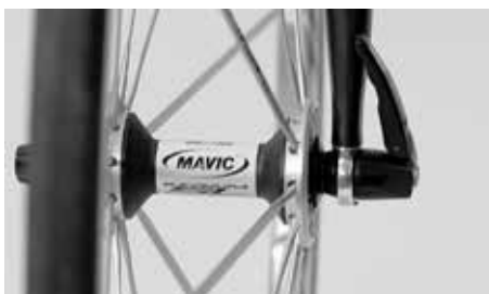
Le levier de l'attache rapide doit se trouver à peu près parallèle à la roue et ne doit pas faire saillie
