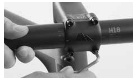
Desserrez les vis à six pans creux sur l'avancée de la potence
