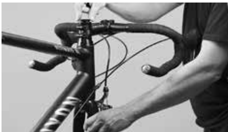
Remettez le capuchon de potence en place, appuyez dessus en maintenant la fourche en position, puis resserrez la potence correctement positionnée au couple de serrage prescrit
