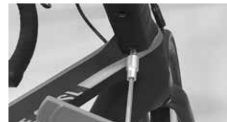
Serrez la vis de la plaque de transition
