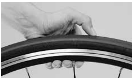
Vérifiez la pression des pneus
