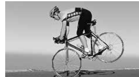
Lors du freinage, le poids du cycliste se déplace de l'arrière vers l'avant
