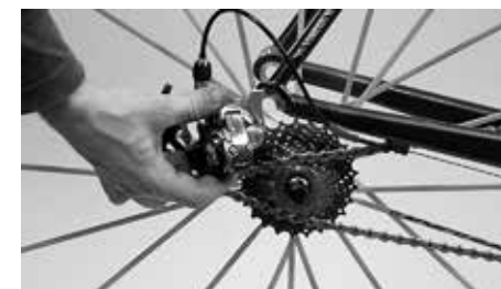
Pour faciliter le retrait de la roue arrière, tirez le dérailleur légèrement vers l'arrière
