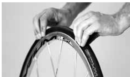
Appuyez sur le pneu pour vous assurer que la chambre à air ne s'est pas coincée entre le pneu et la jante
