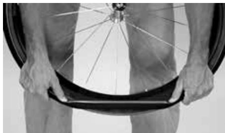
Basculement du boyau par-dessus le rebord de la jante avec les pouces
