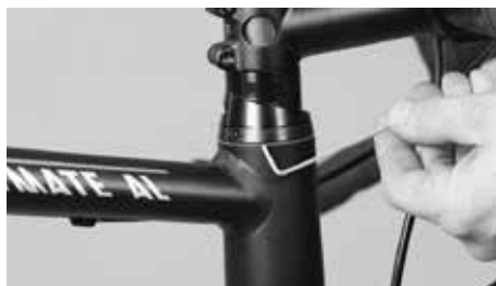
Procédez au réglage du jeu de la direction à l'aide de la vis de réglage latérale
