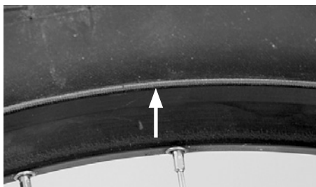
Anillo de control para el asiento del neumático
