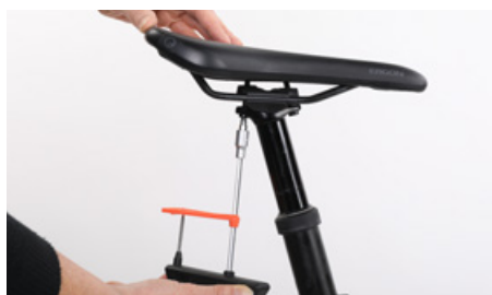
Aprieta de nuevo los tornillos de forma uniforme y alternada con el par de apriete prescrito
