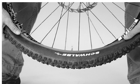
Empujar con las manos el neumático en la llanta
