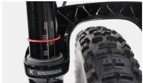
Recorrido negativo (sag) en la horquilla de suspensión
