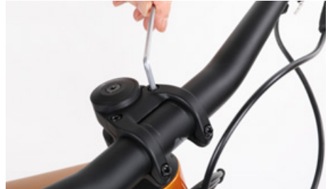
Suelta los tornillos en la parte delantera de la potencia
