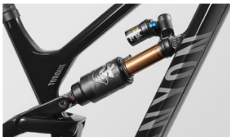
Amortiguador con elemento de suspensión neumático
