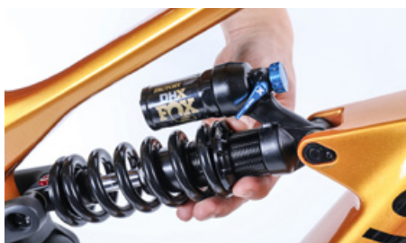
En muelles de acero, gira la ruedecilla de ajuste moleteada para aumentar la precarga del muelle
