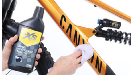
Conservación de la pintura y las superficies metálicas con cera dura
