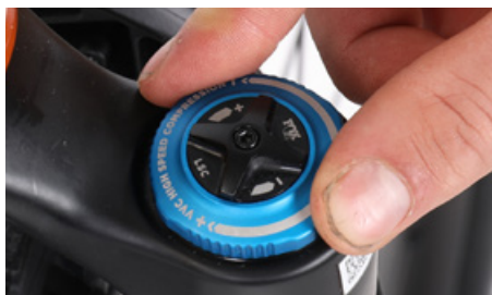
Activación del lockout
