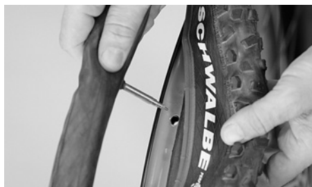
Colocación de la válvula en el orificio de la llanta
