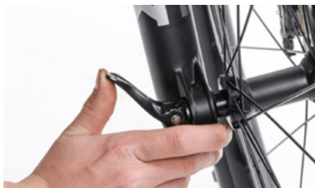
Cierre de la palanca del cierre rápido
