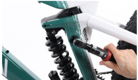
Comprueba regularmente el asiento de todas las uniones atornilladas de la parte trasera conforme a los pares de apriete indicados
