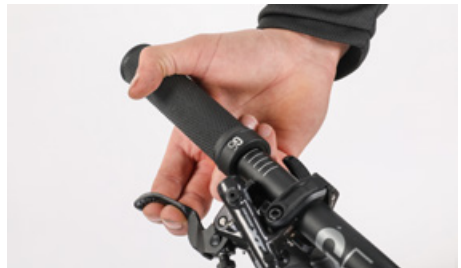
Las manetas de freno no deben llegar hasta el manillar
