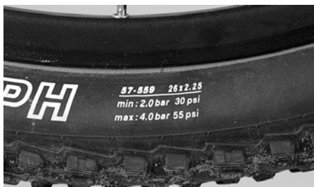
La presión de inflado está grabada en el flanco del neumático
