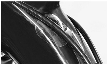
Unas etiquetas autoadhesivas especiales protegen el carbono de posibles daños
