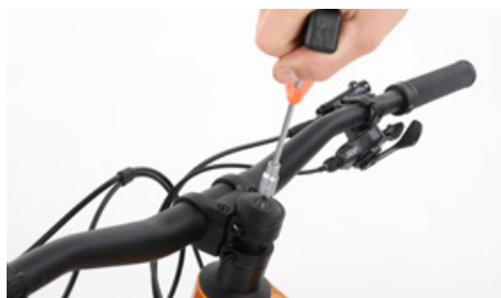
Reajusta el juego de dirección y aprieta de nuevo la potencia
