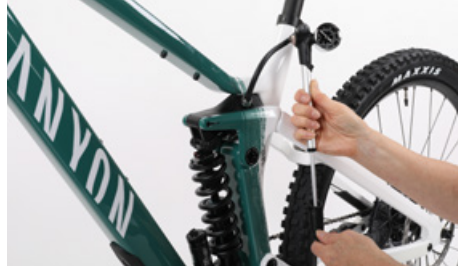
Comprueba regularmente la presión del aire en los sistemas de suspensión neumática
