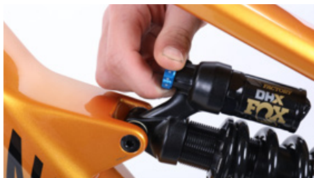
Amortiguación de compresión en el amortiguador
