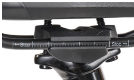
Coloca el sillín de manera que las varillas del bastidor queden fijas dentro de las marcas
