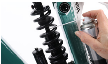
Después de la limpieza, aplica un lubricante homologado
