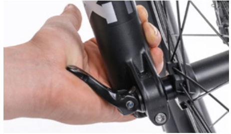
Cierra el cierre rápido con la base del pulgar
