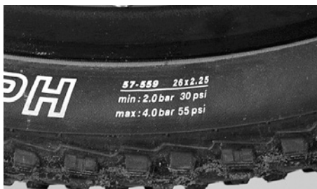
Dimensión y margen de la presión de inflado del neumático
