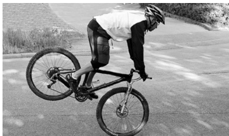
No se aconseja un accionamiento excesivo del freno delantero
