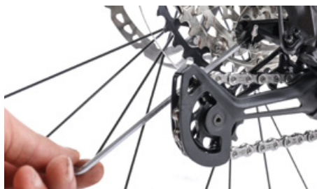
Retesado del cable del cambio trasero: Afloja primero el tornillo que mantiene el cable bajo tensión
