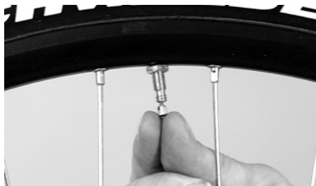
En el caso de la válvula Sclaverand, es necesario aflojar la válvula
