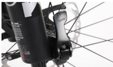
Comprueba la colocación correcta del cierre rápido
