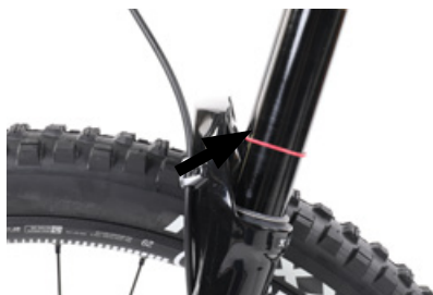
Horquilla de suspensión – Ajuste del recorrido del muelle
