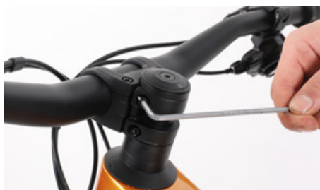
Suelta los tornillos laterales de la potencia
