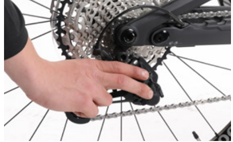
Asegúrate de que el cambio trasero no toque los radios
