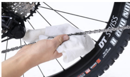
Limpia con un trapo la suciedad y el aceite que se pegan a la cadena
