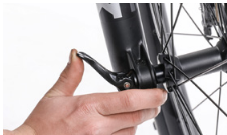
Cierre de la palanca del cierre rápido
