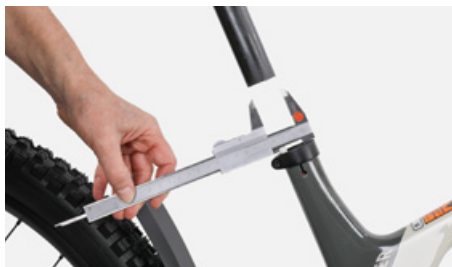
Asegúrate de que la tija de sillín sea compatible con el cuadro
