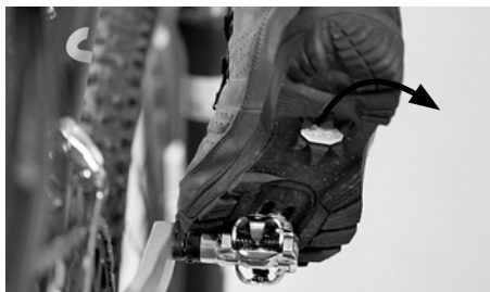
Basta girar el talón hacia fuera para soltar la fijación de los pedales automáticos
