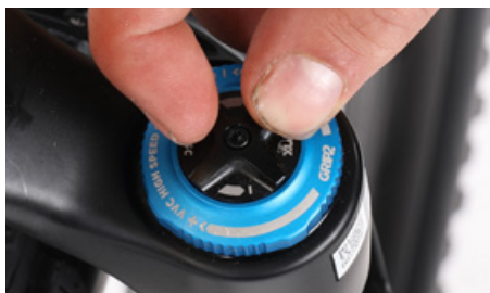
Posibilidades de ajuste de la amortiguación de compresión
