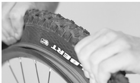
Empuja el neumático sin cámara hacia el centro de la llanta
