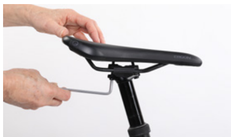
Suelta los dos tornillos dando dos o tres vueltas como máximo
