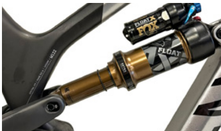
El anillo tórico desplazado indica el recorrido del muelle utilizado
