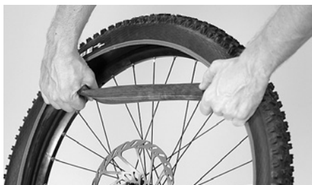
Saca la cámara del neumático
