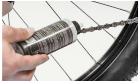
Engrasa la cadena después de terminar la limpieza
