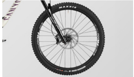
Comprueba el centrado de las llantas
