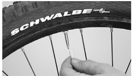
Desenroscado de la caperuza protectora de plástico
