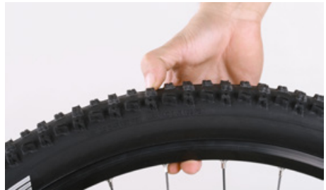
Comprueba la presión de inflado
