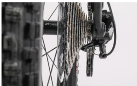
Observa el cassette desde atrás observando si las ruedecillas del cambio trasero quedan exactamente debajo de los dientes del piñón correspondiente
