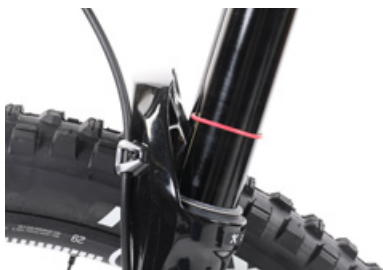
Según se desplace la brida sujetacables, podrás constatar el recorrido usado
