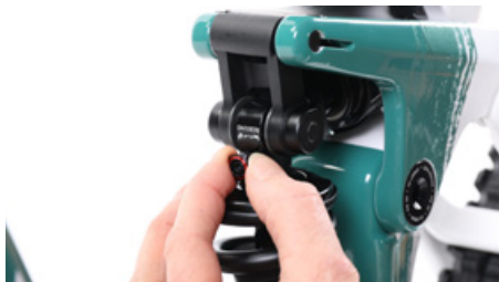
Amortiguación de rebote en el amortiguador
