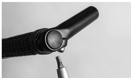
Aprieta de nuevo los tornillos con el par de apriete requerido
