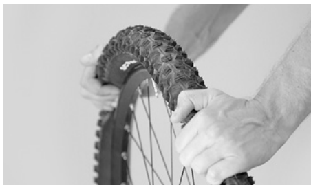
Presiona el neumático hacia ambos lados para evitar aplastar la cámara
