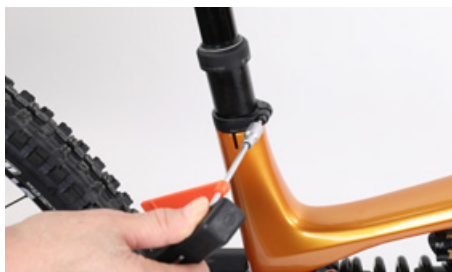
Respetar el par de apriete especificado para la sujeción de la tija de sillín
