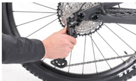
Para desmontar la rueda trasera, tira el cambio trasero un poco hacia atrás
