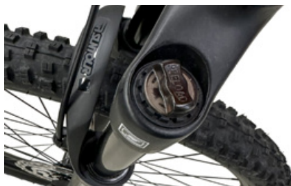
Precarga de la horquilla con muelle de acero
