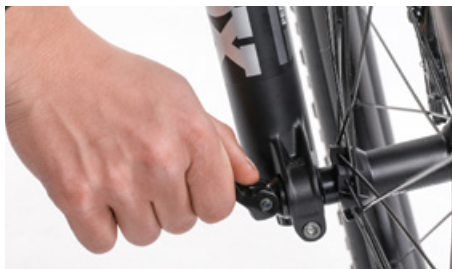
Apertura de la palanca del cierre rápido
