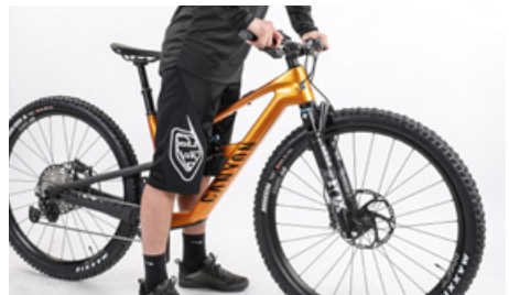
Presiona hacia abajo la horquilla con el freno delantero accionado
