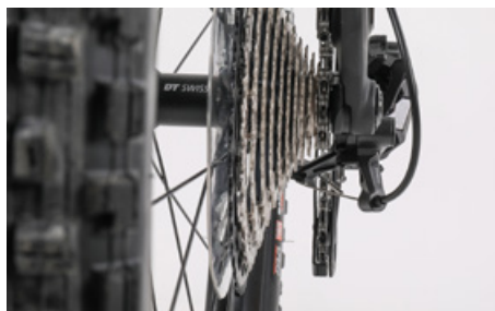
Cambia al piñón más pequeño antes de desmontar la rueda trasera
