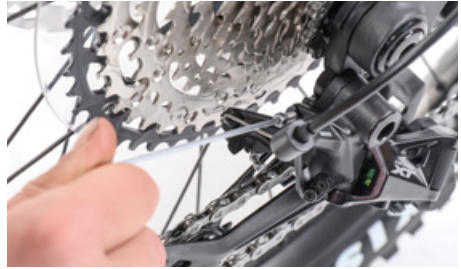
Para ajustar la distancia entre el balancín y el casete, gira el tornillo que se apoya en la cara frontal de la puntera
