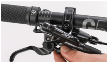
Ajuste de la apertura de la maneta de freno
