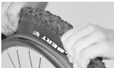
Presiona el neumático hacia el centro de la llanta
