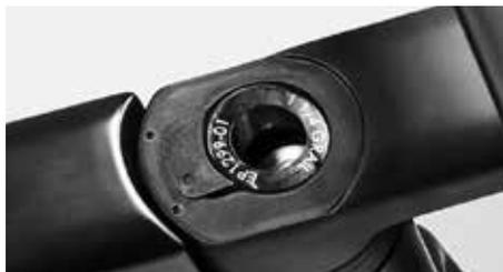
Las combinaciones manillar/potencia GRAIL CF y algunos otros modelos están equipados con una sujeción por cuña en la potencia.
