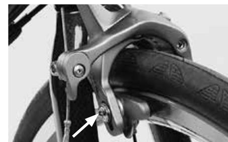
Después de ajustar la altura, apriete el tornillo de fijación de la zapata con el par de apriete prescrito
