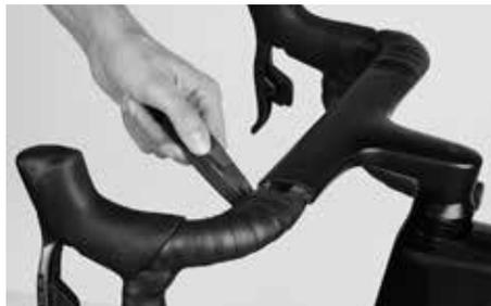
Si es necesario, suelte la cinta de manillar en el área del cuerpo de la potencia del manillar superior y desenróllela unas cuantas vueltas.
