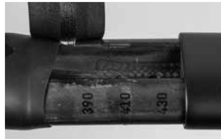
Existen tres opciones de ajuste de la anchura del manillar: 390, 410 y 430 mm. Las marcas correspondientes aparecen impresas en los laterales del manillar.
