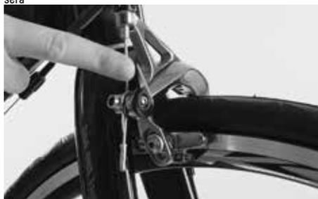
Abra la palanca de desacople rápido en el freno
