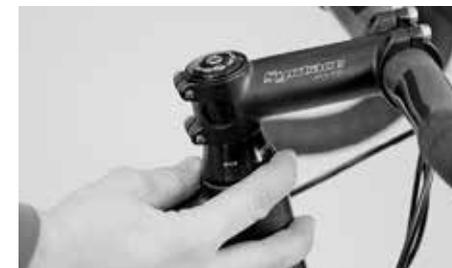
Compruebe la holgura del juego de dirección colocando los dedos alrededor de la cazoleta y moviendo su bicicleta Canyon mediante un tira y empuje, con el freno accionado
