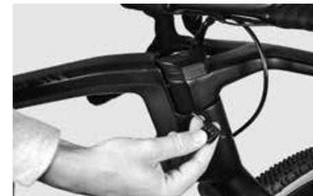
Para ajustar el juego de dirección debe soltar esta placa de transición al igual que la sujeción del cuello de la horquilla en el manillar/elementos de mando GRAIL.
