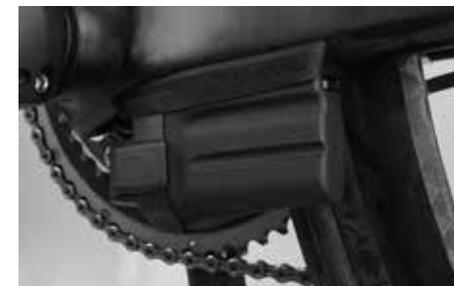
Batería del sistema de cambio Di2
