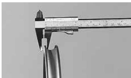
Haga revisar el espesor de las paredes de las llantas a más tardar después de reponer el segundo juego de zapatas
