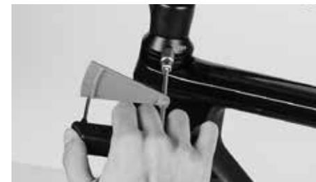
Afloje los tornillos solo dos o tres vueltas y nunca los extraiga completamente
