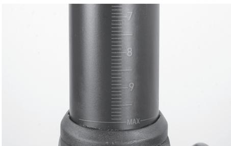
Introduzca la tija de sillín en el tubo vertical hasta alcanzar la altura de sentado deseada. La tija de sillín debe introducirse en el cuadro por lo menos hasta por debajo del tubo superior o hasta la marca MAX de la tija de sillín.
