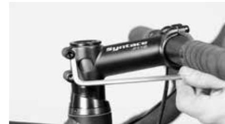
Suelte los tornillos laterales de la potencia
