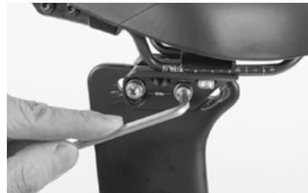
Primero suelte de dos a tres vueltas los dos tornillos Allen horizontales que sujetan el carro a la tija de sillín. Si fuera necesario, bloquee la contratuerca del lado opuesto con otra llave Allen.
