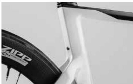
Afije una a dos vueltas como máximo el tornillo de la sujeción de la tija de sillín. No es necesario desenroscar el tornillo por completo pues, de lo contrario, se desintegrará el mecanismo.
