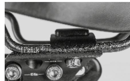
Al mismo tiempo, asegúrese de posicionar las varillas del sillín de modo que la sujeción de la tija de sillín quede dentro de la zona especificada. Si no hay una zona marcada en las varillas del sillín, éstos no deberán fijarse en las curvaturas delanteras o traseras sino únicamente en su parte recta. **¡Peligro de rotura!**
