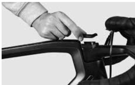
Coloque luego los espaciadores (spacer) en función de la posición sentada deseada por encima o por debajo de la potencia. Preste atención a emplear siempre todos los espaciadores. Puede cambiar más tarde la posición de los espaciadores hacia arriba o hacia abajo, si bien jamás debe omitir un espaciador.
