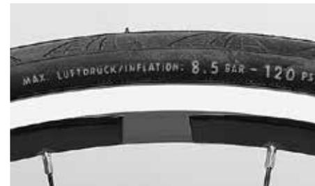
Margen de la presión de inflado del neumático
