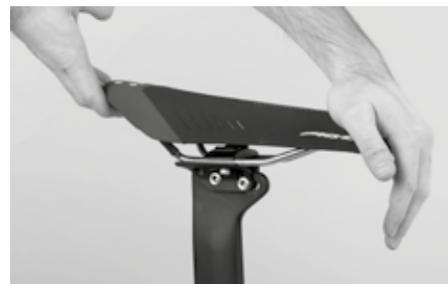
Ajuste el sillín horizontalmente o ligeramente inclinado hacia delante. Si ajusta el sillín muy inclinado hacia delante, no podrá adoptar una postura de pedaleo relajada y tendrá que apoyarse continuamente en el manillar para mantenerse en el sillín.
