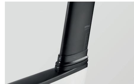
Algunas bicicletas de carretera Canyon están provistas de una tija de sillín Aero (forma aerodinámica) con sujeción integrada, por ejemplo, el modelo Aeroad.
