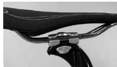
Coloque el sillín de manera que las varillas del bastidor queden fijas dentro de las marcas
