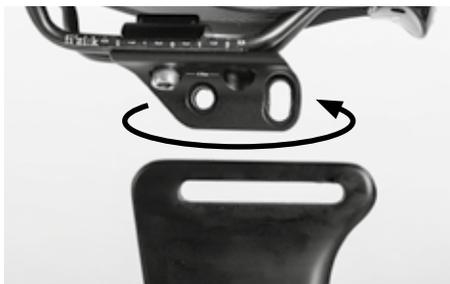
Si el margen de ajuste aún no es suficiente, desenrosque completamente los dos tornillos Allen horizontales. Retire el carro de la tija de sillín, gírelo 180° y vuélvalo a colocar. Después también deberá girar el sillín.
