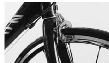
Control del centrado mediante las zapatas
