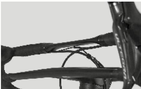
Coloque luego la combinación manillar/potencia en el cuello de la horquilla. Asegúrese de que los cables de freno y las tuberías hidráulicas se encuentren por encima de la unidad de la potencia, no se tuerquen o doblen y que lleguen en radios uniformes a los topes o al freno.
