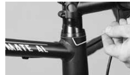
Ajuste la holgura del juego de dirección con el tornillo de ajuste lateral
