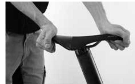
Para modificar la inclinación del sillín, es necesario soltar el mecanismo de sujeción del cabezal de la tija de sillín.
