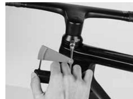
Montaje con la llave dinamométrica de Canyon
