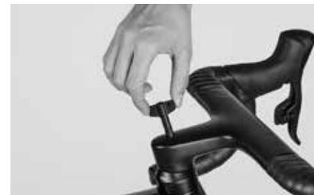
A continuación, inserte la herramienta especial en el orificio de la parte superior del cuerpo de la potencia. La herramienta especial se encuentra en el cartón de las piezas pequeñas. Apriete ligeramente el ajuste interior con la herramienta especial, es decir, con 2 Nm. Esta herramienta también se usa para ajustar la holgura del juego de dirección. Para obtener más información al respecto, consulte el capítulo «Juego de dirección» y la guía Quick Start Guide.
