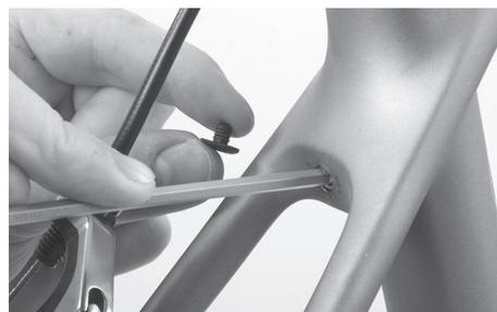
Retire la tapa protectora o el tapón de goma de la parte posterior del tubo vertical, en el área donde los tirantes traseros convergen con el tubo. Afloje una a dos vueltas como máximo el tornillo de la sujeción de la tija de sillín. No es necesario desenroscar el tornillo por completo pues, de lo contrario, se desintegrará el mecanismo.
