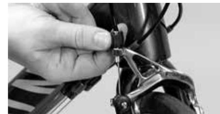
Con la tuerca moleteada se puede ajustar el recorrido en vacío del freno
