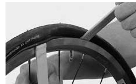
Coloque el desmontable y haga palanca en el borde de la llanta para sacar el neumático
