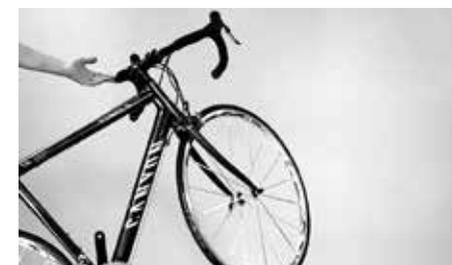
Compruebe el funcionamiento suave del juego de dirección levantando ligeramente la rueda delantera: debe girar con suavidad
