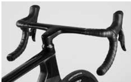
El cockpit consta del cuerpo de la potencia con manillar superior y dos extremos de manillar.
