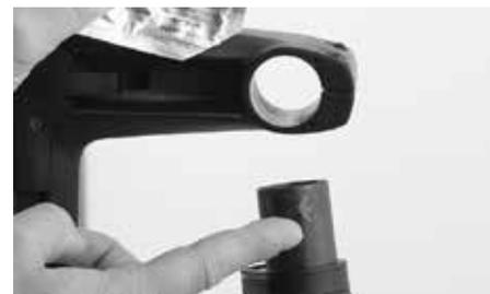
Esto es especialmente útil en las áreas de apriete del manillar y la potencia, el tubo frontal y la potencia, la tija de sillín y el tubo vertical – tres zonas de apriete en que una fuerza de apriete excesiva puede destruir los componentes, haciendo que estos fallen o se pierda la garantía. Con la pasta de montaje Canyon se previene la eventual destrucción de las fibras de carbono mediante la reducción de la fuerza de apriete. Además se evitan los crujidos en las zonas de apriete.
