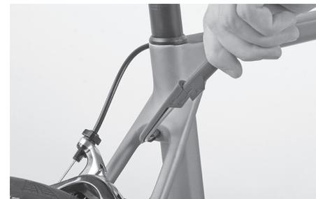
Compruebe el asiento fijo de la tija de sillín en el cuadro agarrando el sillín por delante y por detrás e intentando girarlo. Coloque otra vez el tapón de goma en la cabeza del tornillo Allen del tubo vertical.
