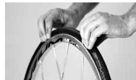
Presione el neumático para evitar que la cámara quede aplastada
