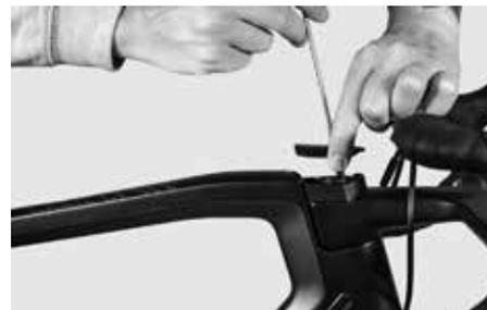
Coloque la tapa en la parte superior y apriete el tornillo con un par de **2 Nm** como máximo, usando la llave dinamométrica Canyon.
