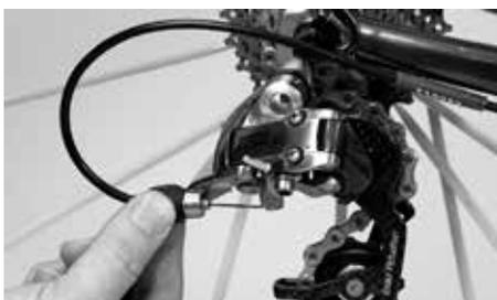
Vuelva a tensar el cable en el tornillo de ajuste en el cambio trasero
