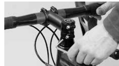
Suelte los tornillos laterales de la potencia
