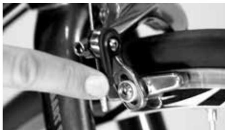
Control del centrado mediante las zapatas
