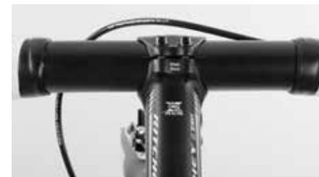
Asegúrese de que las ranuras entre la tapa de la potencia y el cuerpo de la misma sean paralelas y tengan la misma anchura arriba y abajo
