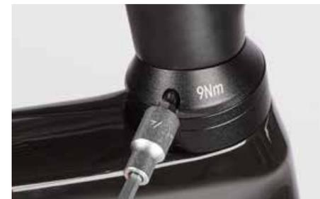
Vaya acercándose en pequeños pasos al par máximo de apriete prescrito (medios newton metros) y compruebe una y otra vez la sujeción segura del manillar. Nunca sobrepase el par de apriete máximo indicado. A continuación, extraiga la herramienta especial y vuelva a colocar la cubierta de goma superior del cuerpo de la potencia.
