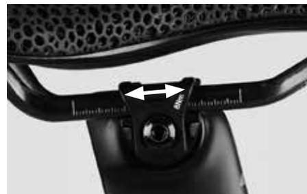
Desplace el sillín a su gusto, hacia delante o hacia atrás. Con frecuencia un pequeño golpe en el sillín facilita la operación. Observe las marcas en las varillas del bastidor del sillín y no las sobrepase.
