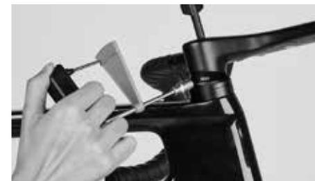
Gire el tornillo de la parte posterior de la tapa del juego de dirección con el par de apriete indicado de 9 Nm
