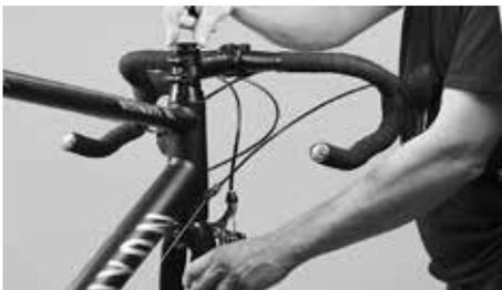
Coloque el tapón, empujelo hacia la horquilla que mantiene sujeta y vuelva a apretar la potencia alineada con el par de apriete prescrito
