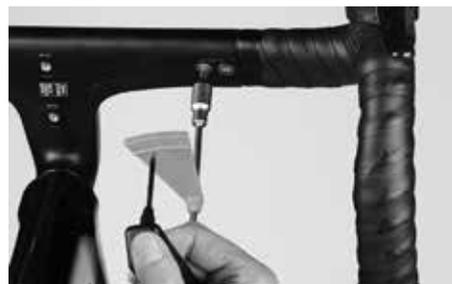
Desenrosque completamente, de cada lado del manillar, los dos tornillos Torx situados en la parte inferior del cuerpo de la potencia.
