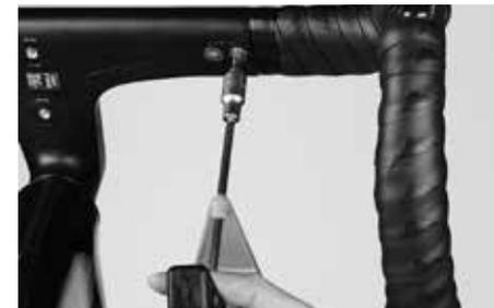
Después de ajustar el manillar a la anchura deseada, inserte los dos tornillos Torx, a cada lado del manillar, en la parte inferior del cuerpo de la potencia. Ahora deberá darles unas cuantas vueltas con los dedos.
