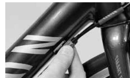
Reajuste de la tensión del cable en el tornillo de ajuste del cuadro
