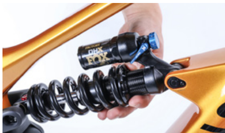
Teräsjousissa jousen jännitystä säädetään kiertämällä pyällettyä säätörengasta
