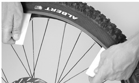
Asennusvivun asettaminen paikalleen ja renkaan reunan nostaminen vanteen reunan päälle
