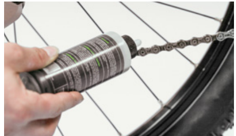
Voitele ketju puhdistuksen jälkeen
