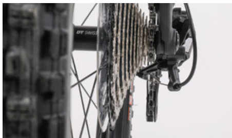
Tarkastele rataspakkaa takaa päin ja tarkasta, ovatko takavaihtajan ohjausrullat tarkalleen kyseisen takarattaan hampaankärkien alapuolella
