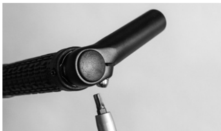
Kiristä ruuvit takaisin tarvittavaan kiristysmomenttiin
