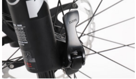
Varmista, että pikalinkku on oikein paikallaan
