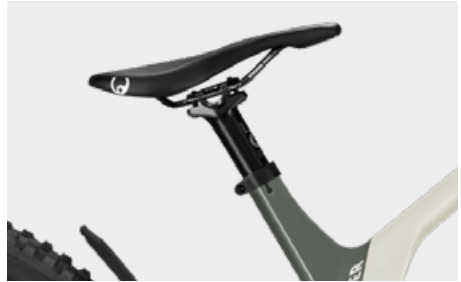
Freeride-pyöräilyssä ja vastaavassa satula on yleensä kallistettu taaksepäin
