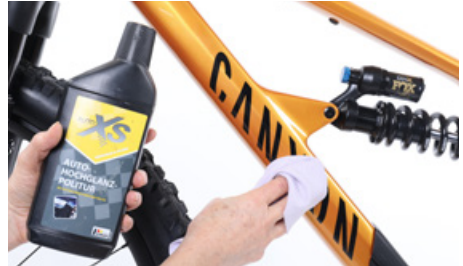
Maali- ja metallipintojen suojaaminen kovavahalla
