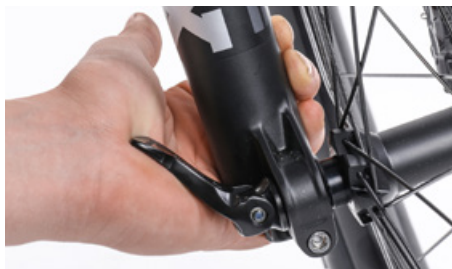
Pikalinkun kiristysvivun sulkeminen peukalopäkiällä
