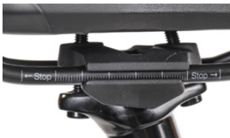
Kohdista satula niin, että satularunko kiinnittyy merkintöjen väliä
