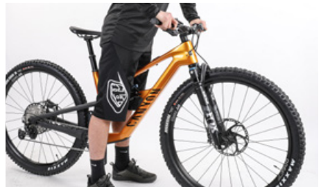
Paina etuhaarukkaa alaspäin etujarrun ollessa puristettuna
