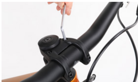
Avaa ohjainkannattimen etuosassa olevat ruuvit
