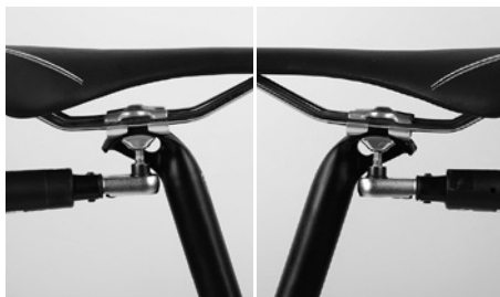
Kiristä molemmat ruuvit vuorotellen ja tasaisesti, älä missään tapauksessa ylitä suurinta sallittua kiristysmomenttia
