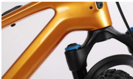
Kruunua on voitava kiertää kosketuksettomasti rungon alla
