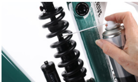
Levitä osiin puhdistamisen jälkeen hieman hyväksyttyä voiteluainetta
