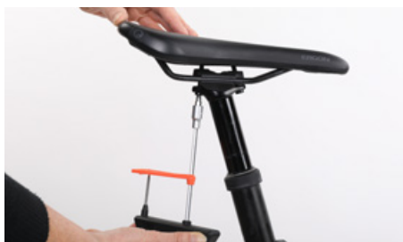
Kiristä ruuvit vuorotellen ja tasaisesti ohjeenmukaiseen kiristystiukkuuteen
