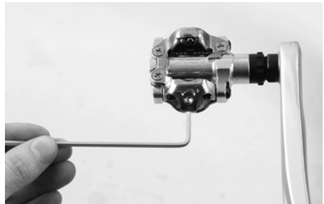
Säädä polkimen avausvoima sopivaksi
