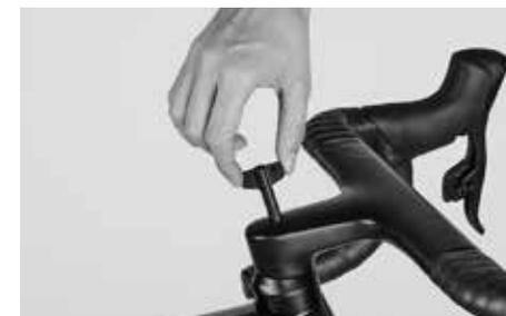
Puis insérez l'outil spécial dans l'ouverture sur le haut du corps de potence. L'outil spécial se trouve dans le carton avec les pièces détachées.
