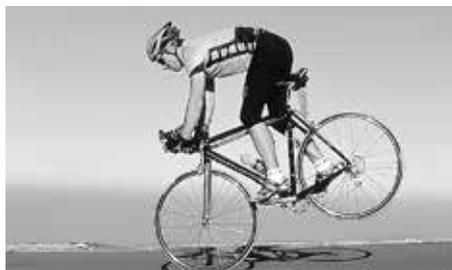
Freinage à fond sur la roue avant : risque de culbute
