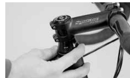
Vérifiez l'absence de jeu dans le jeu de direction en passant les doigts autour de la cuvette, puis en tirant et poussant sur le Canyon après avoir freiné la roue avant
