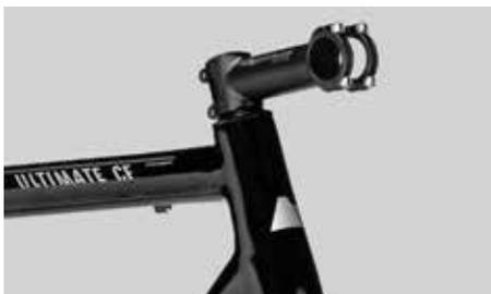
Jeu de direction monté et réglé avec potence et fourche
