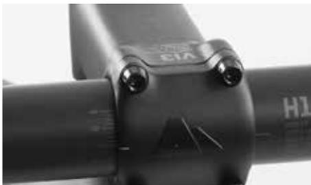
La fente supérieure doit être entièrement fermée
