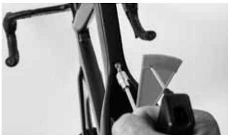
Ne dépassez pas le couple de serrage maximal indiqué
