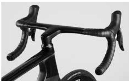
Le cockpit est dans ce cas composé d'un corps de potence avec prolongateur et de deux extrémités de cintre.
