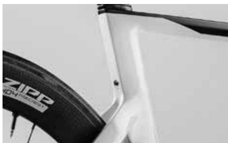
Desserrez de deux à trois tours maximum la vis sur la fixation du tube de selle. Ne dévissez pas complètement la vis, sinon le mécanisme se disloquerait.
