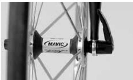
Vérifiez si les deux roues sont toujours correctement serrées dans leurs pattes de fixation
