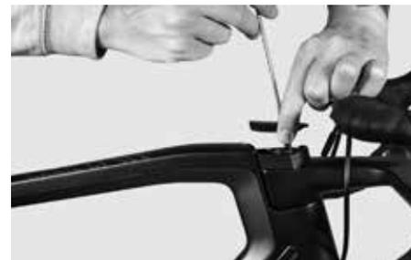
Remplacez le capuchon sur le haut et serrez la vis avec la clé dynamométrique Canyon à un couple **maximum de 2 Nm**.
