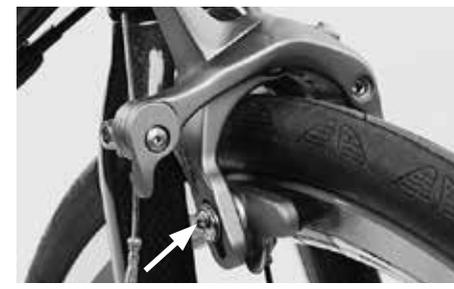
Pour régler la hauteur, serrez la vis de fixation des porte-patins au couple de serrage prescrit
