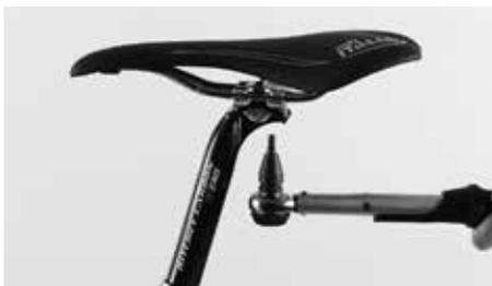
Resserrez les deux vis en alternance et progressivement, sans jamais dépasser le couple de serrage maximum autorisé
