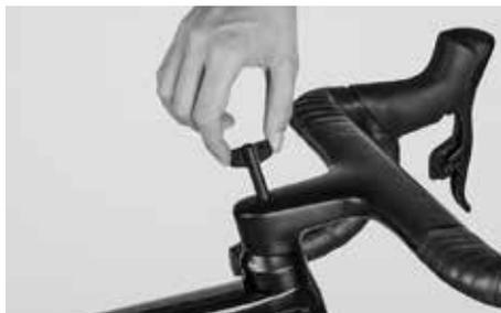
Retirer le recouvrement central en caoutchouc sur le haut du corps de potence et dégager l'ouverture dédiée à la mise en place de l'outil spécial.
