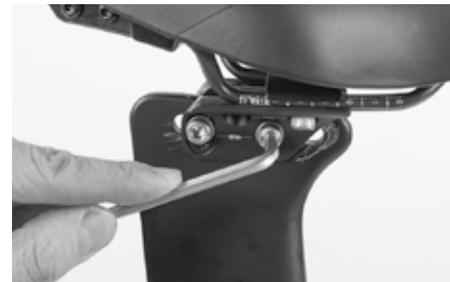
Desserrez tout d'abord de deux ou trois tours les deux vis à six pans creux de fixation du chariot de selle, placées horizontalement. Éventuellement, maintenez les vis en position à l'aide d'une seconde clé Allen sur le côté opposé.
