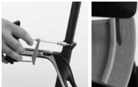
Tournez lentement la poignée de la clé dynamométrique Canyon. Le serrage opérant fait se déplacer l'aiguille de la clé sur l'échelle graduée. Cessez de tourner la poignée dès que l'aiguille atteint le chiffre correspondant au couple de serrage prescrit.
