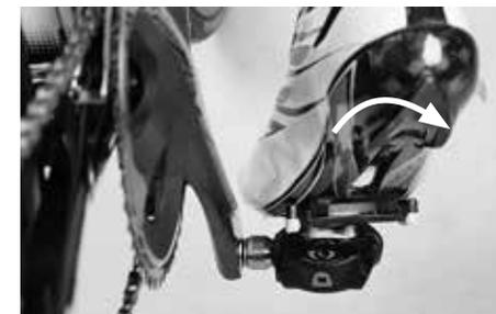
Le décrochage de la chaussure sur la pédale est obtenu par le pivotement du talon vers l'extérieur
