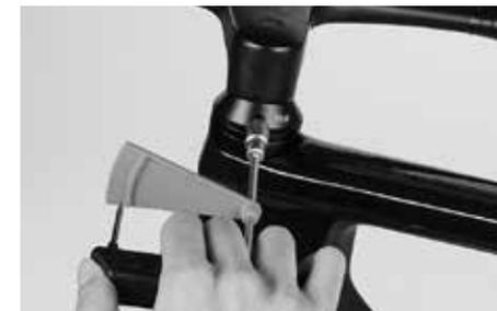
Le réglage du jeu du palier de commande est sécurisé par la plaque de transition.
