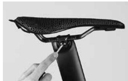
Desserrez la vis sous la tête de la tige. Pour y arriver, desserrez la vis d'un, deux ou maximum trois tours. Ne dévissez pas complètement la vis car c'est un élément essentiel du système de serrage.
