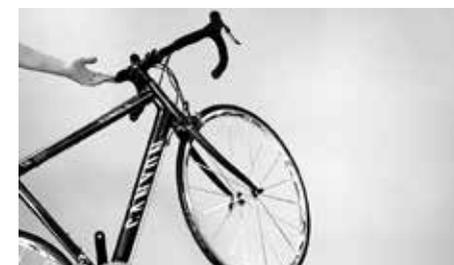
Vérifiez la souplesse de la direction en soulevant la roue avant et en vérifiant si le cintre peut pivoter très facilement sur son angle de braquage
