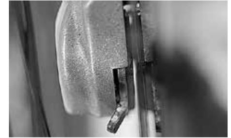
Contrôle d'usure des plaquettes
