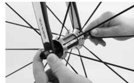
Levier de serrage et écrou de réglage
