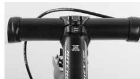
Les fentes du capot de la potence et la potence doivent être parallèles et présentent la même largeur constante en haut et en bas
