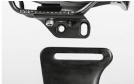
Les possibilités de réglage offertes, en particulier celle de retourner le chariot de selle, permettent d'obtenir une plage de réglage étendue de 0 mm à 85 mm de distance par rapport au milieu du pédalier.
