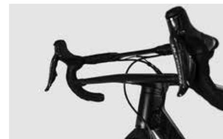
La plaque de transition représente donc simplement une aide au montage. Vous trouverez des astuces pour régler et contrôler le jeu de direction et sur les contrôles de sécurité à effectuer ensuite dans le chapitre « **Jeu de direction** ». Observez le couple de serrage indiqué pour les vis de 1 Nm.
