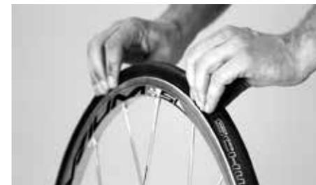
Appuyez sur le pneu pour vous assurer que la chambre à air ne s'est pas coincée entre le pneu et la jante
