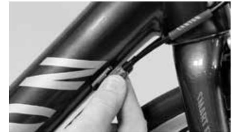
Réglage de la tension du câble sur le barillet de réglage sous le tube diagonal
