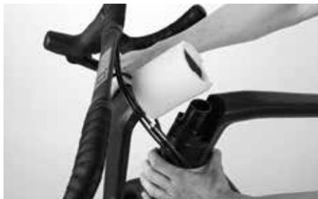
Maintenez la combinaison cintre-potence en position et en haut sur la potence, détachez le ruban avec fermeture velcro fixant le cintre.
