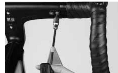
Après avoir réglé le cintre à la largeur souhaitée, réinstallez les deux vis Torx en bas sur le corps de potence sur chaque côté du cintre. Vissez-les de plusieurs tours avec les doigts en faisant attention.
