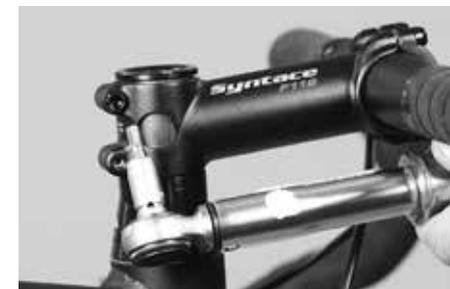
Contrôlez les vis de serrage de la potence à l'aide d'une clé dynamométrique, en tenant compte des couples de serrage indiqués sur la potence
