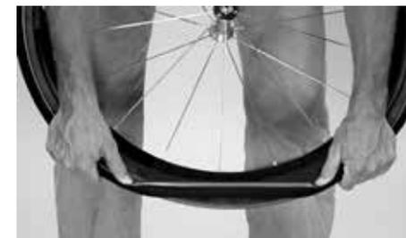
Basculement du boyau par-dessus le rebord de la jante avec les pouces
