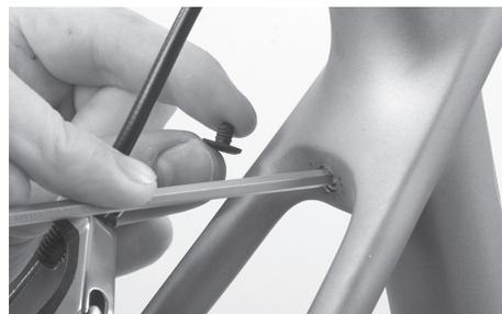
Retirez le capuchon de protection ou le bouchon en caoutchouc de l'arrière du tube de selle à l'endroit où les bases croisent le tube. Desserrez de deux à trois tours maximum la vis sur la fixation du tube de selle. Ne dévissez pas complètement la vis, sinon le mécanisme se disloquerait.
