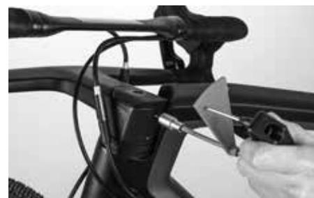
Avec le cockpit GRAIL aligné, serrez les vis au couple de 7,5 Nm avec votre clé dynamométrique Canyon.
