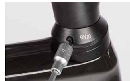
Effectuez le serrage du composant progressivement, en vous rapprochant par petits paliers d'un demi-newton du couple de serrage maximum prescrit et en contrôlant régulièrement le serrage du cintre. Ne dépassez pas le couple de serrage maximal indiqué !
