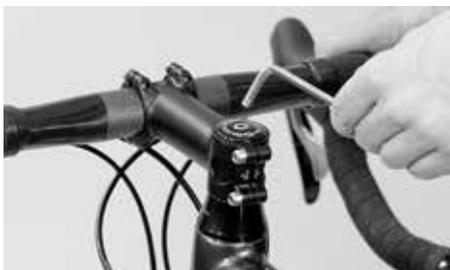
Après avoir desserré les vis de serrage de la potence sur le pivot, réglez le jeu de direction avec la vis de réglage noyée dans le capuchon
