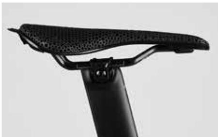
Sur ces tiges de selle, le chariot permettant le réglage de l'inclinaison et du recul de la selle est fixé sur la tête de la tige par une vis à six pans creux installée horizontalement, à la transversale du sens de marche.
