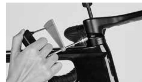
Vissez la vis au dos du capuchon du palier de commande au couple de serrage indiqué de 9 Nm
