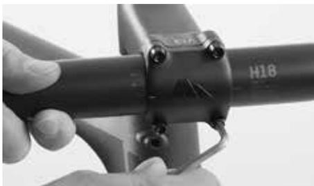
Desserrez la ou les vis à six pans creux situées sur l'avancée de la potence
