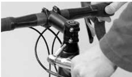
Resserrez les vis de serrage de la potence sur le pivot avec la clé dynamométrique
