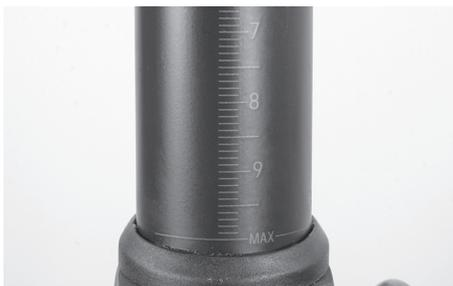
Introduisez la tige de selle dans le tube de selle jusqu'à la hauteur requise pour la selle. Votre tige de selle doit être enfoncée dans le tube de selle au minimum jusqu'en dessous du tube supérieur et ne doit pas être retirée du tube de selle au-delà de la limite d'extraction MAX indiquée sur la tige.
