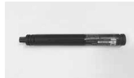
La batterie Di2 peut être installée de manière invisible dans le tube diagonal
