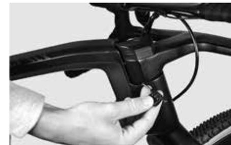
Pour ajuster le jeu de direction, il faut desserrer cette plaque de transition ainsi que le serrage du pivot de fourche sur le cockpit GRAIL.
