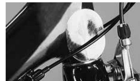
Autocollants spéciaux de protection pour le carbone
