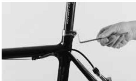
Pour régler la hauteur de la selle, vous devez desserrer la vis de fixation de la tige de selle sur le tube de selle
