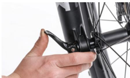
Chiusura della leva di bloccaggio rapido
