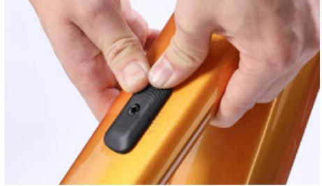
Dopo aver effettuato la regolazione, stringi la vite a esagono incassato del sistema K.I.S. sul tubo superiore della tua bicicletta con la chiave dinamometrica Canyon e una punta da 4 mm a 4 Nm.
