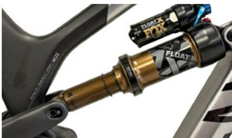
L'0-Ring spostato sull'ammortizzatore indica la corsa della sospensione
