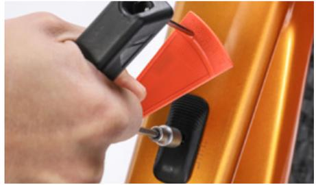
Controlla il funzionamento del sistema K.I.S. sollevando la ruota anteriore e girando il manubrio spostandolo a mano leggermente dalla posizione centrale. Quindi lascia andare il manubrio e continua a tenere sollevata la bicicletta davanti. Il sistema K.I.S. è regolato correttamente se il manubrio si riporta automaticamente al centro.
