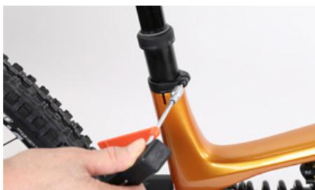
Montaggio con la chiave dinamometrica Canyon
