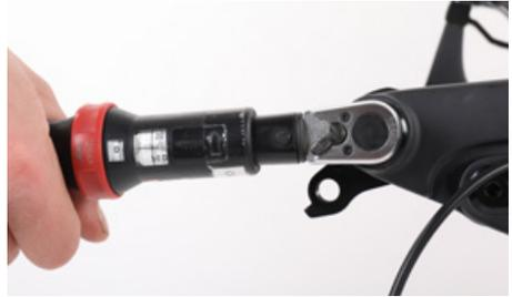
Quando sostituisci il forcellino del cambio sostituibile non superare mai la coppia di bloccaggio massima
