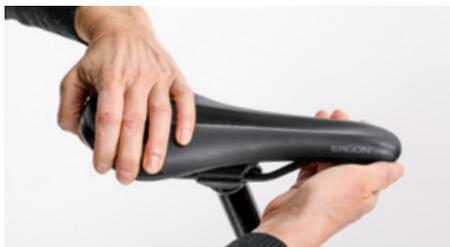
Prova a ruotare la sella rispetto al telaio
