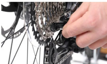
Successivamente puoi tirare il cavo Bowden e metterlo in tensione manualmente
