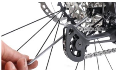
Regolazione del cavo del cambio sul cambio posteriore: svita prima la vite che tiene in tensione il cavo Bowden
