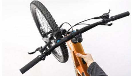
Se è tutto a posto, appoggia di nuovo la ruota anteriore sul terreno. Quindi serra la vite a camma con la chiave dinamometrica Canyon a 1,5 Nm.
