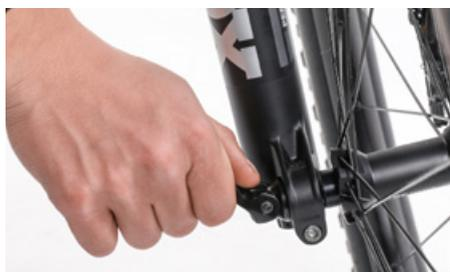
Apertura della leva di bloccaggio rapido
