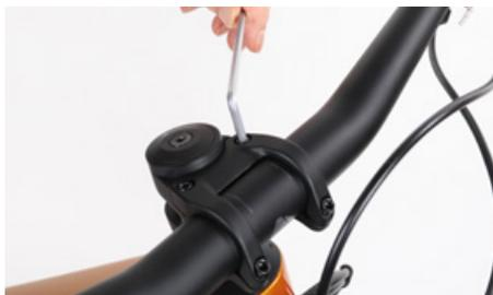
Svita la vite (le viti) a esagono incassato sul lato anteriore dell'attacco manubrio
