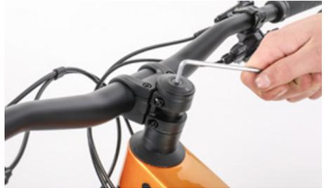
Dopo aver allentato le viti di bloccaggio laterali, regola il gioco del cuscinetto con la vite di registrazione incassata in alto
