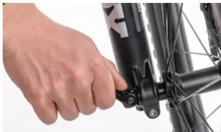
Apertura della leva di bloccaggio rapido
