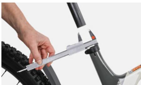
Verifica che il reggisella sia perfettamente compatibile con il telaio
