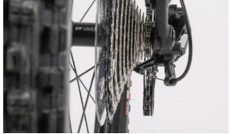
Da dietro, osserva la cassetta e verifica che le pulegge del cambio posteriore si trovino esattamente sotto le punte dei denti del relativo pignone
