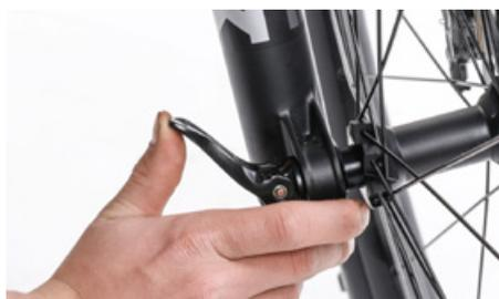
Chiusura della leva di bloccaggio rapido
