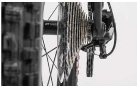
Da dietro, osserva la cassetta e verifica che le pulegge del cambio posteriore si trovino esattamente sotto le punte dei denti del relativo pignone
