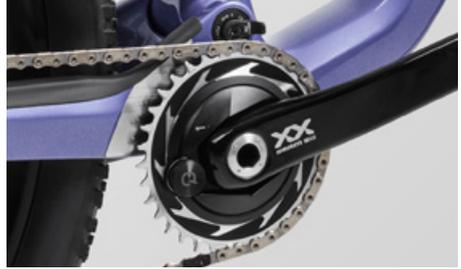
Non superare le coppie di bloccaggio del produttore del movimento centrale
