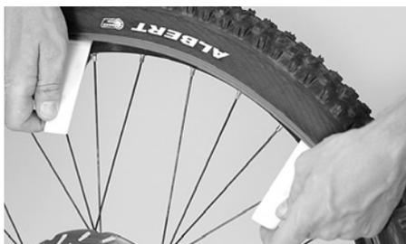
Collocazione della leva di montaggio e sollevamento del fianco della copertura facendo leva sul bordo del cerchio
