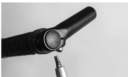
Serra di nuovo le viti alla coppia di bloccaggio necessaria
