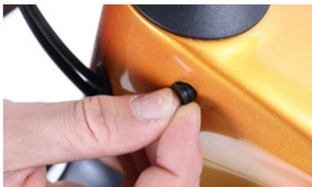
Svita la vite a camma sul lato del tubo di sterzo per al massimo un giro o un giro e mezzo. Non svitare mai completamente la vite a camma, altrimenti il meccanismo all'interno potrebbe aprirsi.
