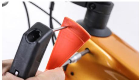
Infine chiudi la copertura laterale sul tubo di sterzo.
