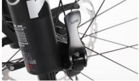
Controlla il corretto montaggio del bloccaggio rapido
