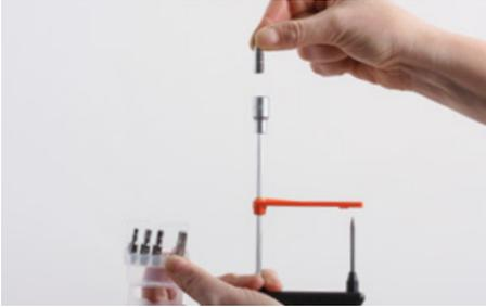
Inserisci la punta adeguata nel portautensile della chiave dinamometrica Canyon. Inserisci completamente la punta con testa a brugola nella testa della vite.
