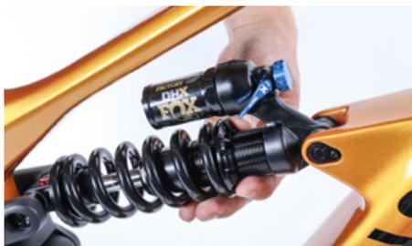
Il precarico delle molle in acciaio viene modificato girando l'anello di registrazione zigrinato
