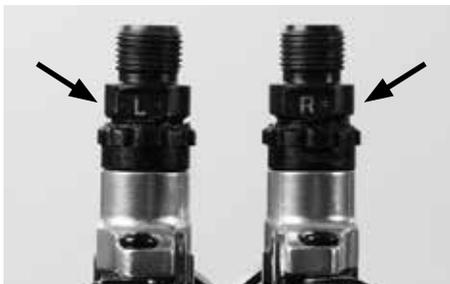
Prima di montare i pedali leggere la dicitura riportata sugli assi. La "R" indica il pedale destro mentre la "L" il pedale sinistro. Tenere conto che il pedale sinistro è dotato di un filetto sinistrorso, ciò significa che dovrà essere avvitato in senso antiorario e quindi in senso inverso rispetto al fissaggio abituale.
