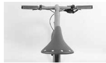
Verificare che la sella non sia storta fissando la punta lungo il tubo orizzontale
