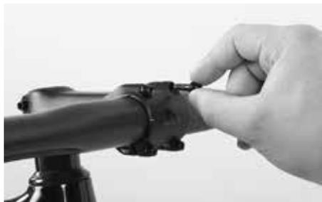
Se per far scorrere il manubrio nella zona di bloccaggio dell'attacco manubrio dovesse essere necessario usare la forza o se tra i due componenti dovesse esserci del gioco, contattate la hotline di assistenza Canyon +39 045515527 per verificare che i due componenti siano compatibili.
