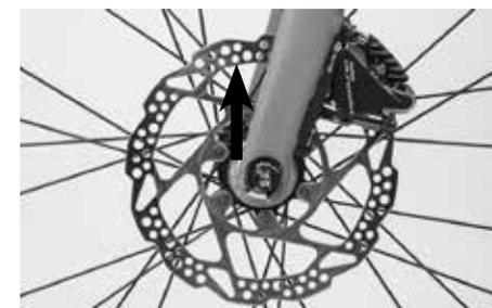
Nel caso di freni a disco, prima di montare la ruota, verificare se le pastiglie si trovano esattamente nelle predisposizioni della pinza freno. La fessura tra le pastiglie è parallela in tutte le sue parti e gli indicatori di usura si trovano nella posizione prevista. Assicuratevi che il disco del freno scorra tra i pattini.
