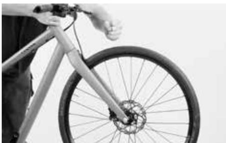
Sollevare infine la ruota di alcuni centimetri dal suolo e dall'alto dare un colpo leggero al pneumatico. Una ruota fissata stabilmente resta nei forcellini del telaio o della forcella e non produce rumori.
