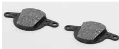
I pattini con spessore inferiore ad un millimetro devono essere sostituiti con ricambi originali
