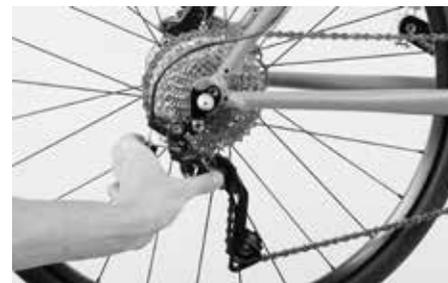
Se la bicicletta Urban è equipaggiata con il cambio a catena, accertatevi che il cambio posteriore non entri in contatto con i raggi quando la catena si trova sulla ruota dentata più grande. Premere attivamente contro il cambio per scongiurare la possibilità di collisione e fare girare lentamente la ruota.
