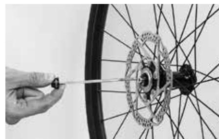
Spingere l'asse filettato nell'asse cavo della ruota. Accertarsi che il dado di bloccaggio (Hexnut) si trovi sempre sul lato opposto rispetto al cambio.
