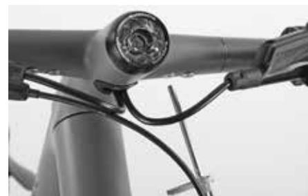
Serrare dal basso le viti del morsetto di fissaggio, due per ciascuna lato del manubrio, avvitando in modo uniforme con la chiave dinamometrica Canyon con una coppia massima di serraggio di 4 Nm. Non superare la coppia di serraggio massima!
