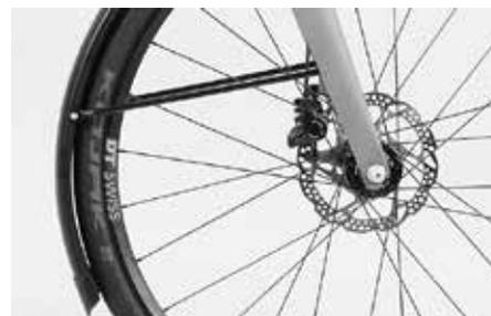
Sulla ruota anteriore il parafrango deve essere avvitato al fissaggio sulla forcella. Serrare le viti con la chiave dinamometrica Canyon rispettando le indicazioni impresse sul componente.
