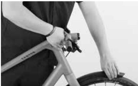
Tirare più volte la leva del freno dopo aver montato la ruota e averla chiusa correttamente. Quindi far girare la ruota.
