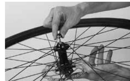
Avvitare il dado di bloccaggio (Hexnut) a mano per un paio di giri sull'asse filettato e montare la ruota anteriore.
