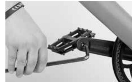
Nel caso di alcuni pedali sarà necessario serrare i pedali con l'ausilio di una punta con testa Allen.
