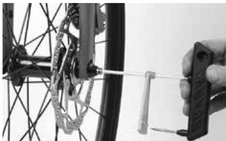
Avvitare il dado di bloccaggio (Hexnut) con la chiave dinamometrica Canyon e la punta da 5 mm adatta e alla coppia di serraggio indicata di 7 Nm. Non superare la coppia di serraggio indicata!
