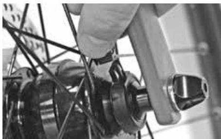
Se avete acquistato una bicicletta Urban di Canyon con dinamo a mozzo, durante il montaggio assicuratevi che la presa per il cavo sia rivolta verso il basso e verso l'alto. Collegare la dinamo a mozzo alla spina del cavo del fanale. Eseguire un controllo del funzionamento.
