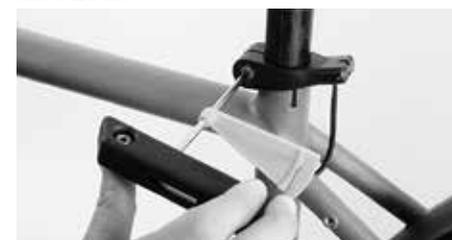
Serrare i dadi di bloccaggio con la chiave dinamometrica Canyon rispettando le indicazioni riportate sul componente
