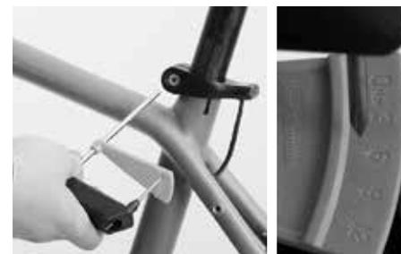
Girare lentamente tenendo la chiave dinamometrica Canyon dall'impugnatura. Quando la vite è serrata, l'indicatore sulla scala si sposta. Sospendetevi di girare la chiave non appena l'indicatore raggiunge il valore della coppia di serraggio prescritta.
