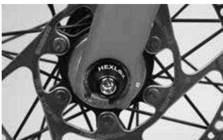
Le ruote della bicicletta Canyon Urban, anziché montare i bloccaggi rapidi, sono equipaggiate con un asse filettato (Hexlox).
