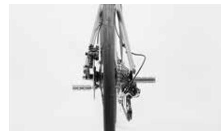
Da dietro guardate il pacchetto pignoni e verificate che le pulegge guida del cambio si trovino esattamente sotto le punte dei denti del rispettivo pignone
