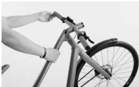
Per verificare la scorrevolezza della serie sterzo, sollevate con una mano il telaio in modo che la ruota anteriore non sia più a contatto con il suolo. La ruota anteriore deve oscillare da un estremo all'altro in maniera scorrevole e senza bloccarsi. Toccando leggermente il manubrio, la forcella deve spostarsi automaticamente dalla posizione centrale.
