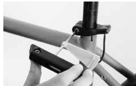
Regolare la sella e avvitare la vite sul bloccaggio rapido del reggisella senza serrare troppo, ovvero senza superare la coppia di serraggio consentita pari a max. 8 Nm. Eseguire questa operazione utilizzando la chiave dinamometrica Canyon.
