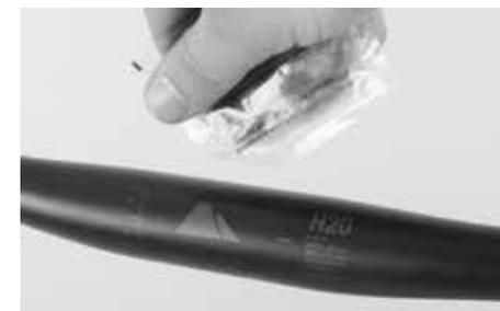
Questo accorgimento è utile soprattutto nelle zone di bloccaggio del manubrio e dell'attacco manubrio, del cannotto della forcella e dell'attacco manubrio o del reggisella e del piantone, tre zone di bloccaggio in cui le forze di serraggio eccessive possono rovinare i componenti causandone il cedimento o la perdita della garanzia.
