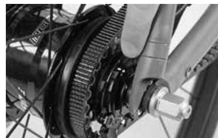
Sulle biciclette Urban con trasmissione a cinghia per una corretta impostazione devono essere posizionate due marcature gialle di allineamento a destra del mozzo regolando il cavo del cambio direttamente sulla leva del cambio, come con un cambio a catena.
