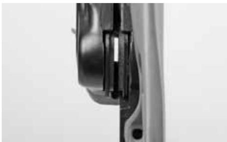
Nel caso di freni a disco, prima di montare la ruota, verificare se le pastiglie si trovano esattamente nelle sedi della pinza del freno. La fessura tra le pastiglie deve essere parallela.
