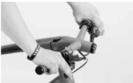
Tirare più volte la leva del freno dopo aver montato la ruota e chiuso l'asse filettato. Quindi far girare la ruota. Il disco del freno non deve strisciare né sulla pinza né, in genere, contro le pastiglie.
