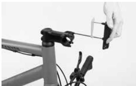
Posizionare la forcella e l'attacco manubrio in direzione di marcia. Svitare completamente le viti di fissaggio del coperchio dell'attacco manubrio.
