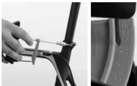
Girate lentamente tenendo la chiave dinamometrica Canyon dall'impugnatura. Quando la vite è serrata, l'indicatore sulla scala si sposta. Smettete di girare la chiave non appena l'indicatore raggiunge il valore della coppia di bloccaggio prescritta.
