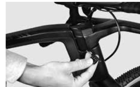
Per regolare nuovamente la serie sterzo è necessario allentare questa piastra di transizione allo stesso modo del morsetto del canotto della forcella sul cockpit GRAIL.
