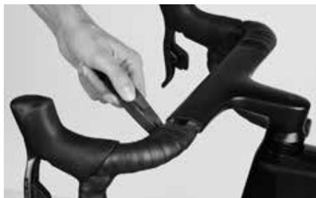
Se necessario, staccate il nastro del manubrio nella zona del corpo dell'attacco manubrio e del manubrio superiore e srotolatelo per alcuni giri.
