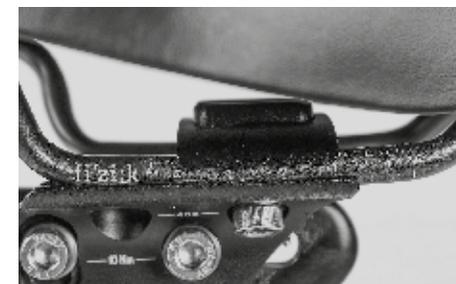
Fate in modo che il telaio della sella sia posizionato in modo tale che sia bloccato all'interno della zona specificata. Se non dovesse essere presente alcuna marcatura sul telaio della sella, il bloccaggio deve fissare solamente la parte diritta e in nessun caso la zona curva anteriore o posteriore. **Pericolo di rottura!**
