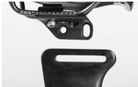
Con le possibilità di regolazione, in particolare con la rotazione del carrello, si ottiene un ulteriore campo di regolazione da 0 mm a 85 mm di distanza dal centro del movimento centrale.
