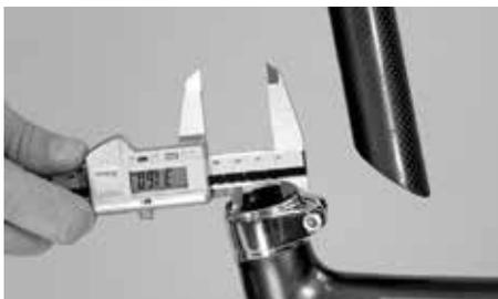
Verifichi che il reggisella sia perfettamente compatibile con il telaio
