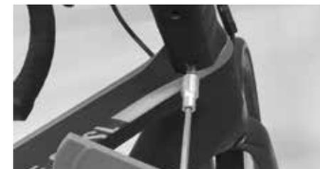
Riavviti la vite di registrazione della piastra di transizione
