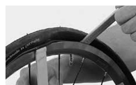
Collocazione della leva di montaggio e sollevamento del fianco della copertura facendo leva sul bordo del cerchio
