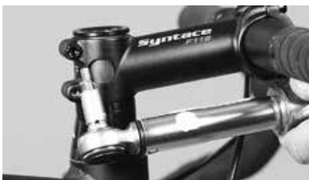
Avviti tutte le viti di fissaggio dell'attacco manubrio con una chiave dinamometrica attenendosi alle indicazioni
