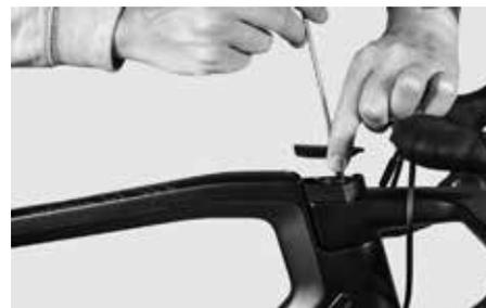
Appoggiare in alto il coperchio e serrare la vite con la chiave dinamometrica Canyon a una coppia di bloccaggio di **massimo 2 Nm**.
