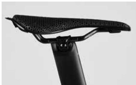
Con questi reggisella, la testa, che consente di fissare l'inclinazione e la posizione orizzontale della sella, è sostenuta da una vite ad esagono incassato orizzontale e posta trasversalmente rispetto alla direzione di guida.
