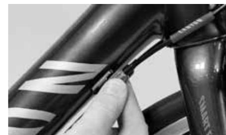
Regolazione del cavo del cambio con la vite di registrazione sul telaio
