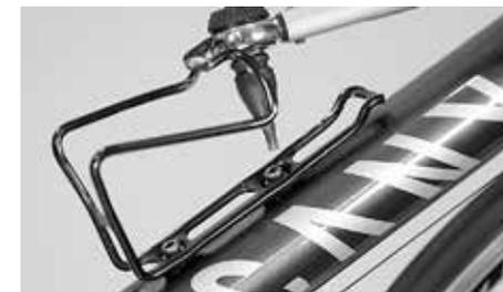
Nel caso del supporto borracce si attenga alla coppia di bloccaggio massima di 2 Nm
