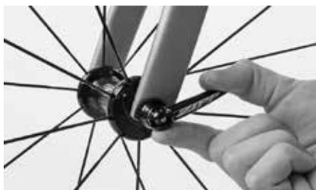
Verificate che la sede sia stabile provando a ruotare la leva chiusa
