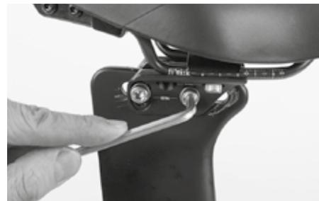
Per prima cosa allentate di due-tre giri le viti ad esagono incassato del carrello poste in orizzontale. Se necessario, bloccate le viti sul lato opposto servendovi di un'altra chiave a brugola.
