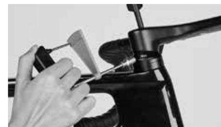
Serri la vite sul retro del tappo della serie sterzo alla coppia di bloccaggio indicata di 9 Nm
