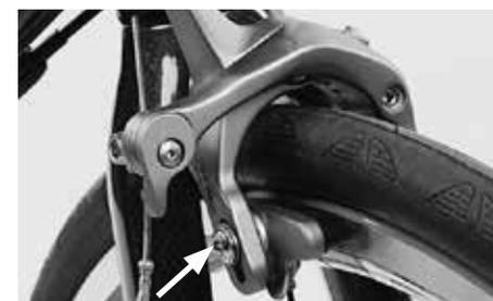
Per regolare l'altezza stinga le vite di bloccaggio del pattino rispettando la coppia di bloccaggio indicata
