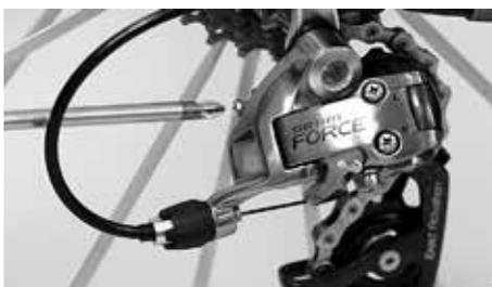
Per regolare la distanza tra bilanciante delle pulegge e cassetta giri la vite che si appoggia sul lato frontale del forcellino
