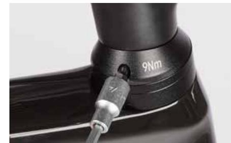
Iniziate sempre a serrare a piccoli passi (mezzo newton metro per volta) partendo dalla coppia di bloccaggio più bassa per poi raggiungere la coppia massima e verificate più volte che il manubrio sia ben fissato. Non superare la coppia di bloccaggio massima indicata!
