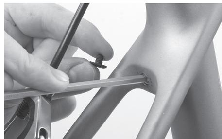
Prendere il cappuccio protettivo o i tappini di gomma dietro al piantone vicino a dove i bracci confluiscono nel piantone. Allentare di due-tre giri la vite del bloccaggio del reggisella. Non è necessario svitare completamente la vite; in caso contrario, il meccanismo si scompone nelle sue singole parti.
