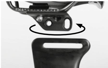
Se lo spazio di regolazione non dovesse essere ancora sufficiente, svitate completamente le viti ad esagono incassato poste in orizzontale ed estraetele. Estraiete dal reggisella il carrello rimontandolo girato di 180°. Successivamente è necessario girare anche la sella.
