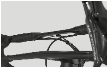
Inserire quindi il cockpit sul canotto della forcella. Controllare che i tubi idraulici e i cavi dei freni passino al di sopra del manubrio integrato, non siano storti o piegati e che scorrano con raggi uniformi fino ai fine corsa o al freno.
