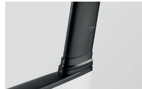
Alcune biciclette da corsa Canyon sono dotate di un reggisella Aero (forma aerodinamica) con bloccaggio integrato, p. es. il modello Aeroad.
