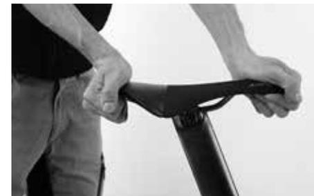
Per cambiare l'inclinazione della sella, è necessario allentare il meccanismo di bloccaggio sulla testa del reggisella.
