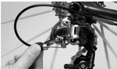
Regolazione del cavo del cambio con la vite di registrazione sul cambio posteriore
