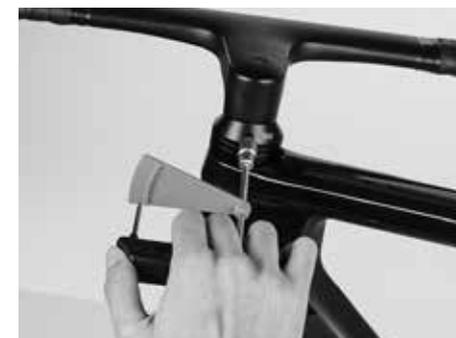
Montaggio con la chiave dinamometrica Canyon
