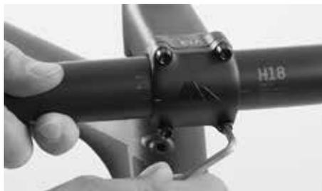
Sviti la vite (le viti) ad esagono incassato sul lato anteriore dell'attacco manubrio
