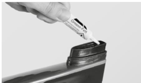
Rilubrificazione della guarnizione
