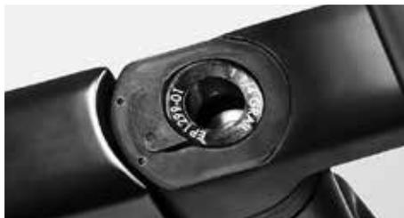
Il cockpit GRAIL CF e alcuni altri modelli sono dotati di un bloccaggio a cuneo sull'attacco manubrio.
