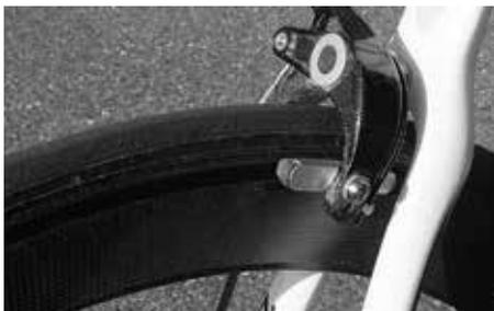
I cerchi in carbonio necessitano di particolari pattini, secondo le indicazioni del produttore di ruote
