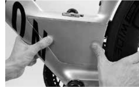
インテグレートドボトムブラケットストレージ(BBはボトムブラケットの略)にはパンク修理に必要なアクセサリを収納することができます。
