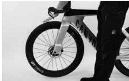
前輪を取り付けてスルーアクスルを閉じたら、ブレーキレバーを引いてみてください。そしてブレーキレバーを再び開放します。自転車を持ち上げて前輪を回転させてみます。その時にブレーキディスクがキャリアやブレーキパッドに擦れないことを確認します。
