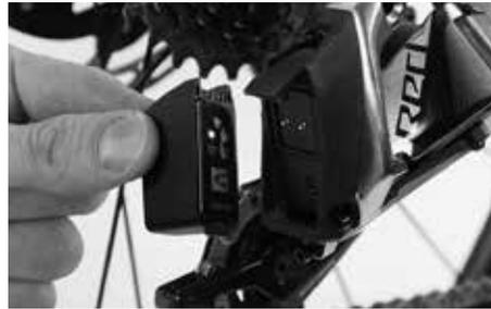
バッテリーの接点が上になるようにしてバッテリーを取り付けてください。
