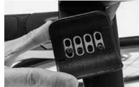
また、水平面内のアームレストの角度も、長穴内のボルト位置によって一定の範囲内で変えられます。
