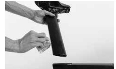
これは特に、ハンドルとステムやステアリングコラムとステム、シートポストとシートチューブなどの三箇所締め付けに重要で、締め付け力が強すぎると部品が破損する恐れがあり、また保証が受けられなくなります。
