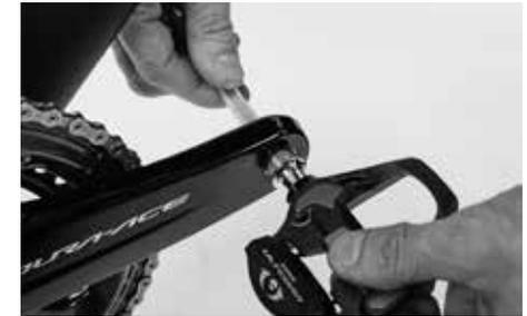
最初の二三回は手でペダルをクランクのネジ穴にねじ込みます。それからペダルレンチを使ってペダルが固定されるまで回します。
