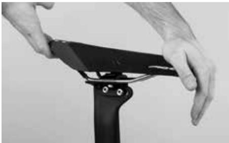
サドルを水平または前方に軽く傾斜させて調節します。サドルが前方に傾きすぎていると、リラックスした状態でペダリングできません。常にハンドルで身体を支えていないと、サドルから滑り落ちてしまうからです。
