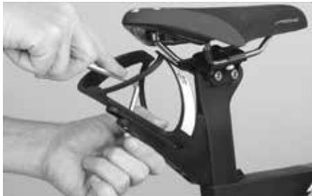
ボトルケージをアダプターにつけて二つあるアダプターのネジ穴にそれぞれ固定ボルトを差し込んで指定の締め付けトルク3Nmで締めます。
