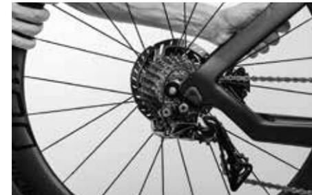
リアステイの間で後輪の位置を合わせ、左側から受けとハブを通してスルーアクスルを差し込みます。スルーアクスルを手で数回転時計回りに廻します。
