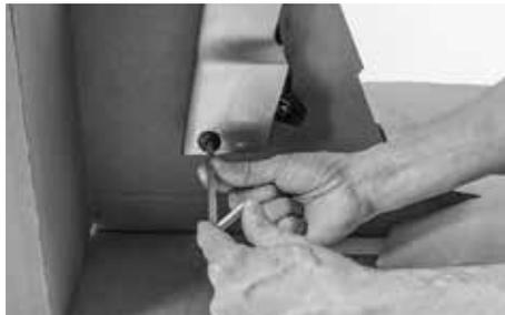
Speedmaxが倒れないようにしっかりと持ってください。そして前輪のスルーアクスルを六角棒レンチで緩め、スルーアクスルを反時計回りに廻します。
