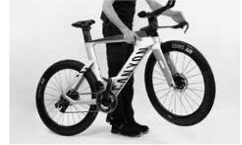
ステアリングヘッドが滑らかに回ることを確認するには、前輪を持ち上げてスムーズに動くかどうかを確認めます。持ち上げた状態で中央位置のハンドルを指で軽くたたいただけで前輪が横に回転するような状態ではなくはなりません。
