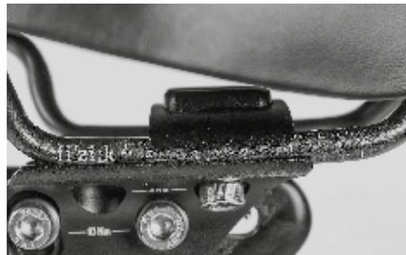
シートポストのクランプがサドルレールの規定の範囲内に位置していることを確認してください。規定範囲のマークがサドルレールについていない場合には、必ずサイドレールの直線部分に固定するようにして、前後の湾曲部には絶対に固定しないでください。**折れる危険があります。**
