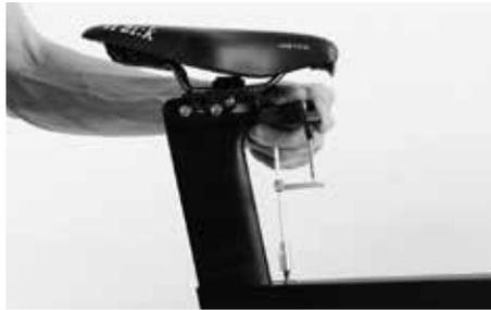
シートポストクランプ/固定装置の六角穴ボルトを廻して最大4Nmで締めます。
