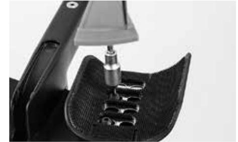
二本の固定ボルトをできる限り離してネジ穴に差し込み、指定締め付けトルクの2.5Nmまで締めます。
