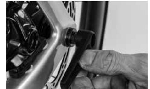
レバーをバネの力に逆らって外側に引き出します。レバーを引っ張っている間は、レバーを廻して所望の位置に方向を合わせることができます。
