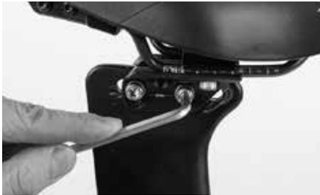
まずサドルクランプの水平方向に配置された二本の六角穴ボルトを二～三回転廻して緩めます。もう一本六角棒レンチを使って反対側でボルトをpushさえておくとも良いかも知れません。
