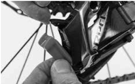
フロントディレイラーおよびリアディレイラーの電気接点は赤いカバーで保護されています。ロックを上を持ち上げて開き、このカバーを取ります。
