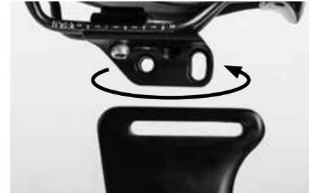
それでもまだ調整可能な範囲が足りない場合には、水平方向に配置された二つの六角穴ボルトを緩めて完全に抜き取ります。シートポストクランプをシートポストから外し、180°回転させて付け直します。
