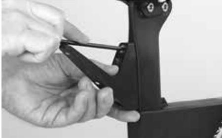
このアダプターを使うとサドルの後ろ/下に1~2個のボトルケージを取り付けることができます。取り付ける前にシートポスト裏側のゴムカバーを外してください。指定の締め付けトルク3Nmで固定ボルトを締めます。
