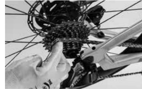
ディスクブレーキの場合には、輸送用のパッドスペーサーを抜き取ります。チェーンを後ろに引っ張って一番小さいスプロケットに掛けます。そしてホイールを後方からドロップアウト (Speedmaxのドロップアウトは水平方向になっています) に押し込みます。
