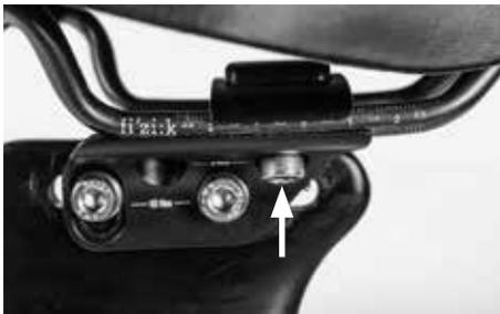
それだけではサドルクランプがまだ動かない場合には、両側のほぼ垂直方向のボルトも少し緩めますが、その時にサドルがサドルクランプ内で動いてしまわないようにします。
