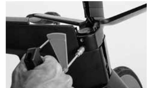
クランプリングのT6ボルトを規定の締め付けトルクで締め直します。
