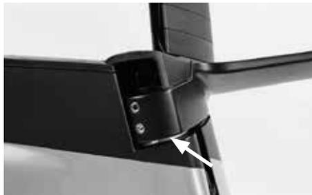
ハンドルを右か左に切ります。二本のクランプボルトを少しずつ交互に緩め、ステムの下にあるクランプリングも緩めます。リングを緩めるにはT6トルクスドライバー（小型パーツ箱に入っています）を左側からあてます。どのボルトも二～三回転だけ反時計回りに廻して緩めてください。完全に抜き取らないでください。
