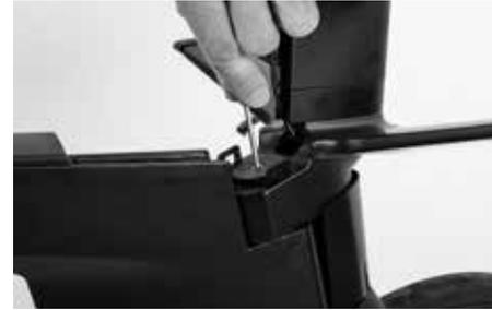
センターの調整ボルトを3mmの六角棒レンチで力を加減しながら時計回りに廻します。最初は半回転ずつ廻してゆきましょう。
