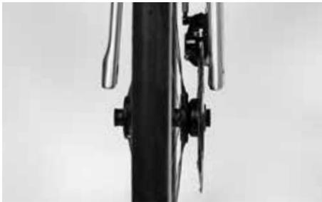
ディスクブレーキの場合には、輸送用のパッドスペーサーを抜き取ります。前輪をフォークに嵌めてブレーキディスクがキャリアに入るようにします。両側の受けの間で前輪の位置を合わせ、左側から受けとハブを通してスルーアクスルを差し込みます。スルーアクスルを手で数回転時計回りに回します。
