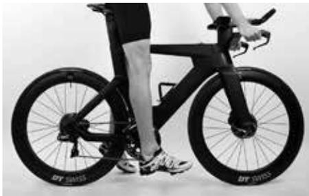
サドルの高さを調整するには、トップチューブ上面のシートポストクランプについている六角穴ボルトを緩めます。
