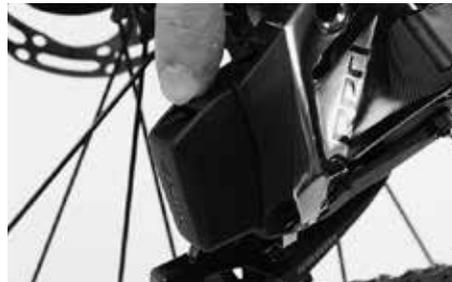
ロックを再び閉じてバッテリーを固定します。ロックがカチッと嵌まるのを確認してください。
