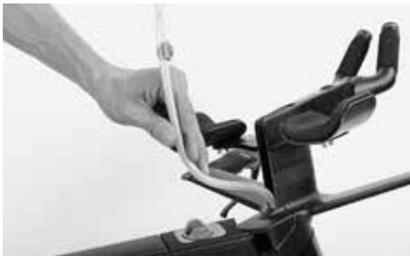
軸受の遊び調整ボルトに触れるには、まずモノエクステンションとスペーサーの間のガイドからドリンクチューブを外す必要があります。ハンドリングしやすいようにハイドレーションパック全体を外してしまうのが最善策です。「インテグレートッドハイドレーションシステム」の項参照。
