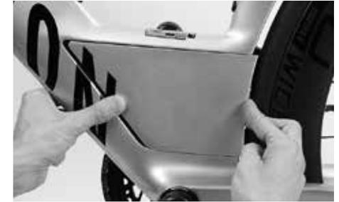
カバーをフレームに取り付けるには、カバーを少し後方にずらして嵌めてから前方にスライドさせます。
