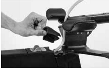
次にステムの上についているカバーを外します。このカバーはクリップ式で着脱できます。左右の側面を外側に広げながらカバーを上を持ち上げてください。ハンドルを切ると外しやすくなります。
