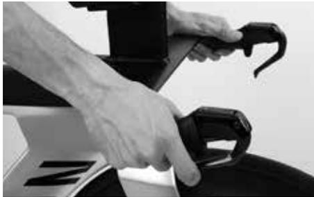
後輪を取り付けてスルーアクスルを閉じたら、ブレーキレバーを引いてみてください。そしてブレーキレバーを再び開放します。自転車を持ち上げて、クランクを手で数回転回し後輪を回転させます。そうするとチェーンがカセットスプロケットの一段にきれいに嵌まります。また、その時にブレーキディスクがキャリアやブレーキパッドに擦れないことを確認できます。
