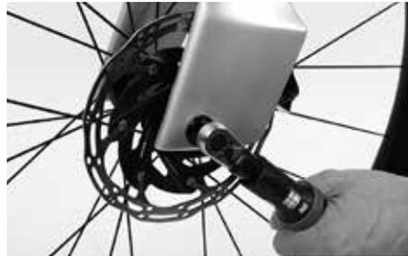
アクスルのネジ山がフォークの右側レグのネジ山と嵌合したら、スルーアクスルをさらに時計回りに回します。最初の数回転はスルーアクスルが楽に回らないといけません。その後アクスルをCanyonトルクレンチを使って15Nmのトルクで締めます。
