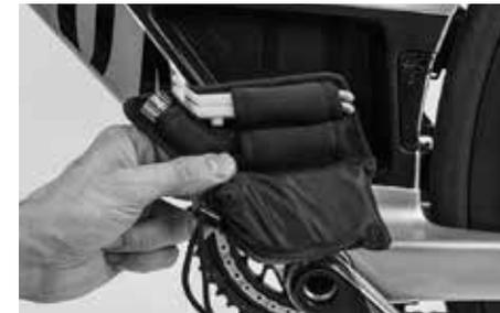
インテグレートドボトムブラケットストレージ収納アイテム: 1対のタイヤレバー、CO<sub>2</sub>カートリッジ用バルブ1個、交換用チューブ1本(2個までのCO<sub>2</sub>カートリッジは各自購入)
