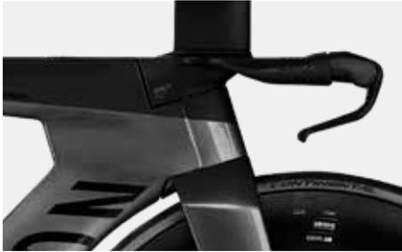
走行中やブレーキ時にSpeedmaxからカタカタと音がする場合には、ステアリングヘッドを点検してみましょう。ロードバイク取扱説明書の「ステアリングヘッド」の項の説明に従って、外からは見えない位置にあるステアリングヘッドの点検を行います。
