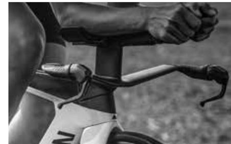
ベースバーは二種類の長さとし二種類の高さ、モノエクステンションは三種類の長さが基本仕様となっています。
