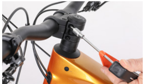
ステムの横についているクランプボルトをトルクレンチで締め直す
