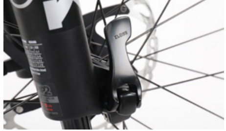
クイックリリースがしっかりと固定されていることを確認する
