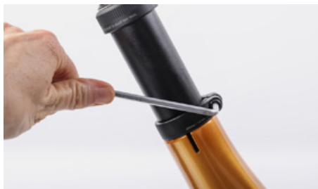
サドルの高さを調整するには、シートクランプを緩める
