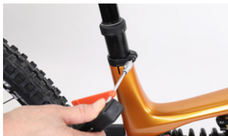
シートポストクランプは指定の締め付けトルクを守ってください
