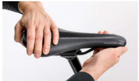
フレームに対してサドルをひねることができるか試してみよう
