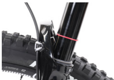
ケーブルタイの動いた距離を見れば、使用したストロークがわかる
