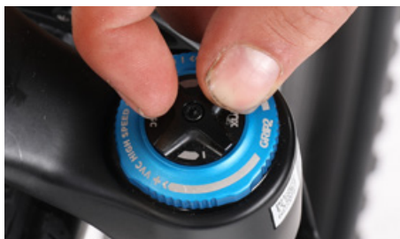
コンプレッションダンピングの調整ボタン
