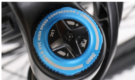
コンプレッションダンピングがばねの縮むスピードを遅くする
