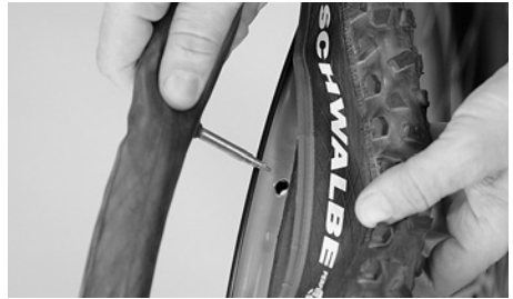
バルブをリムの孔に差し込む
