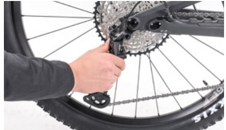
後輪を取り外す時は、リアディレイラーを手で軽く後ろに引く
