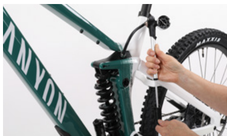
空気ばねの空気圧を定期的に点検
