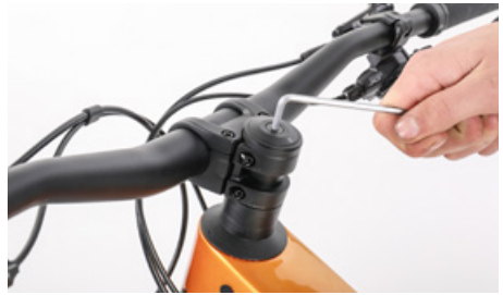
横についているクランプボルトを緩めてから上面に埋め込まれている調整ボルトで遊びを調整する
