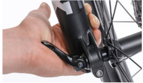
クイックリリースレバーを母指球で押して閉じる
