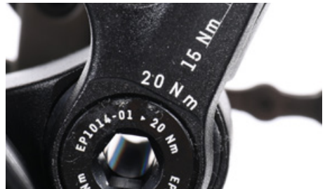
所定の締め付けトルクを必ず守ってください
