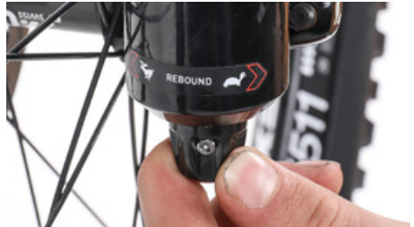
リバウンドダンピングがばねの伸びるスピードを遅くする
