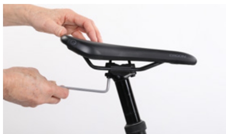
両方のボルトを2〜3回転だけ緩める
