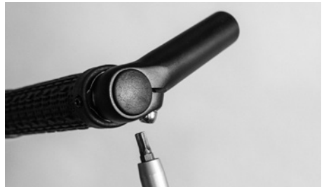
ボルトを必要な締め付けトルクで締める
