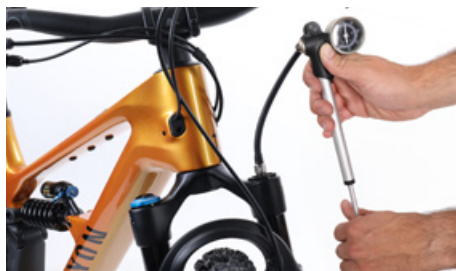
サスポンプを使ってスプリングレート进行调整
