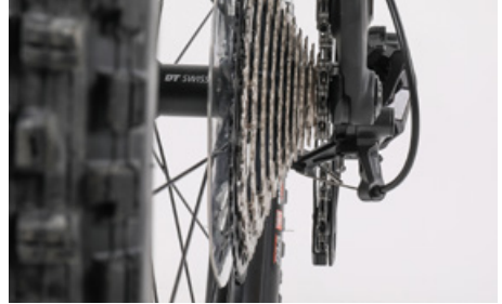
後輪を取り外す前に一番小さなスプロケットに切り替える
