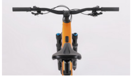
サドルの向きをトップチューブに合わせて、ねじれていないことを確認します
