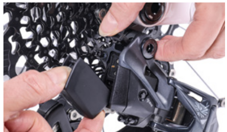
SRAMのバッテリーを取り外して充電
