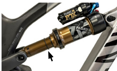
ダンパーのOリングが動いた距離が使用したストロークを示す
