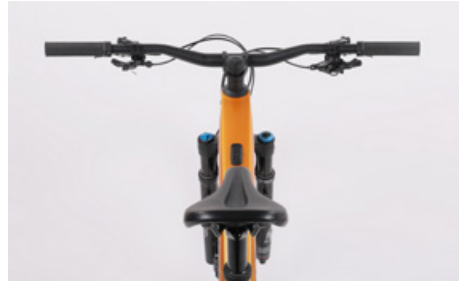
サドルの向きをトップチューブに合わせて、ねじれていないことを確認します
