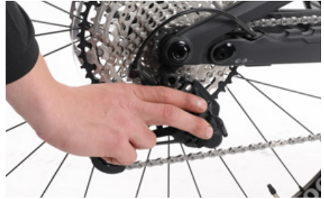
リアディレイラーがスポークに絶対に触れないことを確認してください
