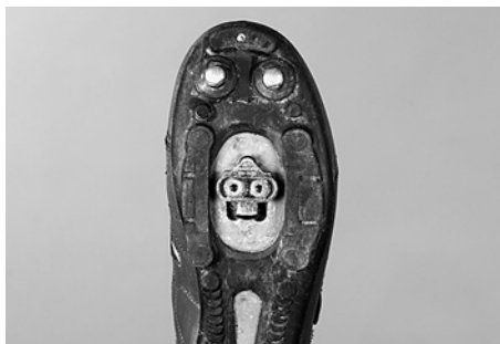
靴底に組み込まれた小さな固定プレート（クリート）
