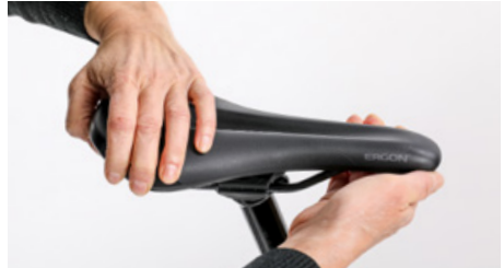
フレームに対してサドルをひねることができるか試してみよう
