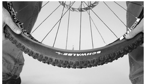
タイヤを手でリムに押し込む
