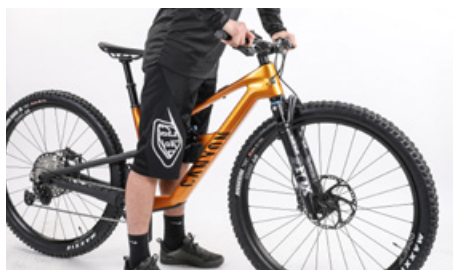
前輪のブレーキをかけながらフォークを押し下げる
