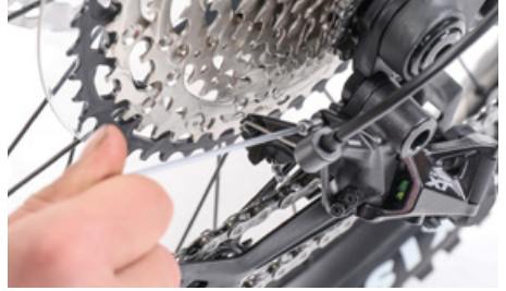
プーリageとスプロケットの距離を調節するには、ドロップアウトの正面側を押さえるボルトを廻す
