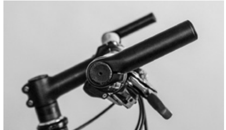
バーエンドバーをつけると、ハンドルの持ち方のパターンが増えます
