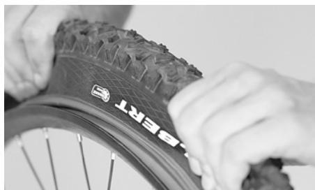
タイヤをリムの中央に向けて押し込む
