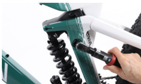
リアサスペンション・後輪ステイのボルトがすべてしっかりと所定のトルクで締まっているかどうか定期的に点検
