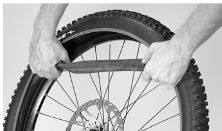
タイヤからチューブを抜き取る
