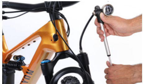
空気ばねの空気圧を定期的に点検
