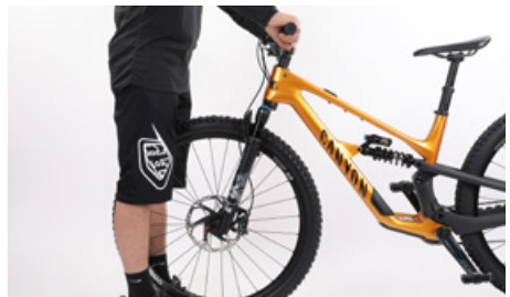
前輪を押さえてハンドルをひねることができるか試してみる
