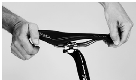
ボルトを締めたら、サドルが傾かないか確認
