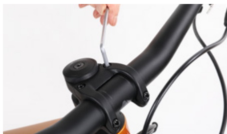
ステムの前にあるボルトをすべて外します
