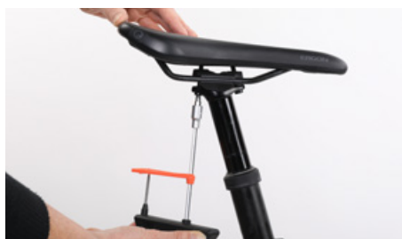
両方のボルトを交互かつ均一に規定の締め付けトルクで締める
