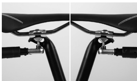
2本のボルトを交互に均一に締めてゆき、最大許容締め付けトルクを絶対を超えないようにする
