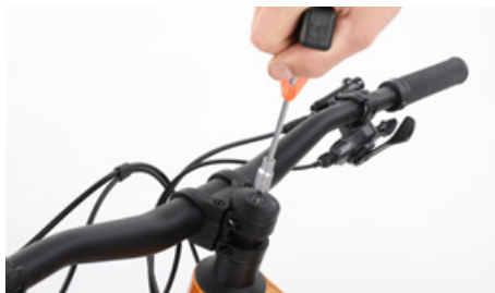
軸受を改めて調整直したら、ステムのボルトをしっかり締めます
