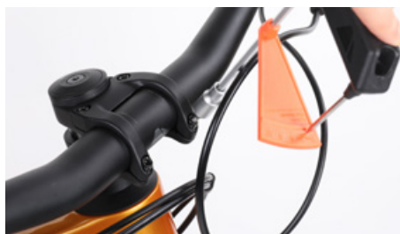
両方のボルトを規定の締め付けトルクで締める
