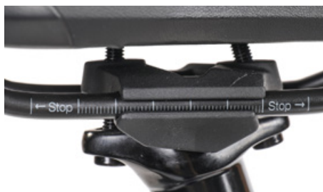
レールのマークされている範囲内で固定するように位置を調整
