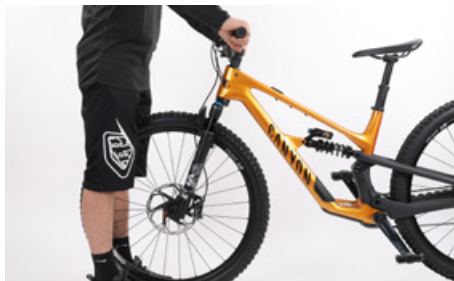
前輪を押さえてハンドルをひねることができるか試してみる
