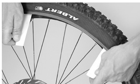
タイヤレバーを差し込んでタイヤのビードをリムの外に出す
