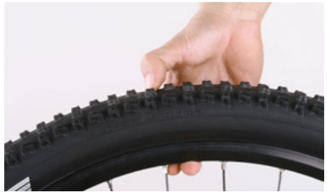
タイヤの空気圧を点検する
