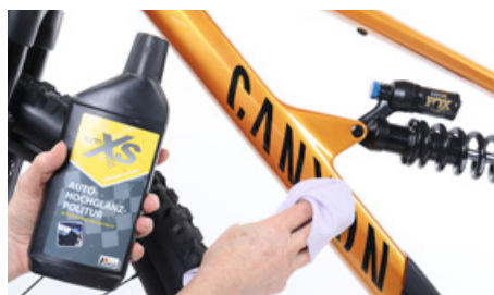
塗装面と金属面にワックスを塗る
