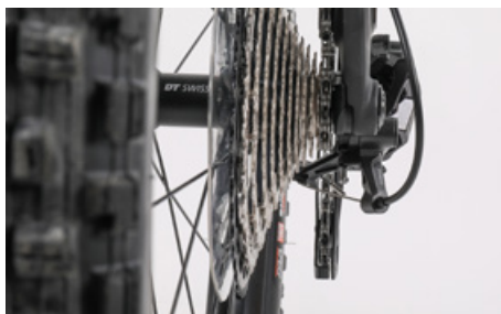
スプロケットを後ろから見た時に、リアディレイラーのガイドブリーが、正しいスプロケットの歯の真下にあるかどうかを確認
