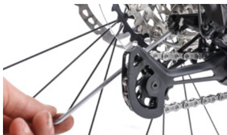
リアディレイラーのシフトケーブルのテンションを調整：まずシフトケーブルを張っているボルトを緩めます
