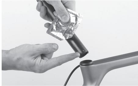
시트 포스트를 다시 빼냅니다. 시트 포스트의 하단 부분과 시트 튜브 내부에 캐니언 조립 접착제를 조금 바르거나 시트 포스트의 클램프 부분에 접착제를 조금 바르십시오.
