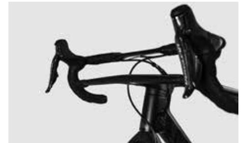
트랜지션 플레이트는 조립을 도와주는 기능을 합니다. 베어링 유격 점검 및 설정에 관한 사항과 안전 점검에 관한 사항은 “헤드셋” 본문 내용을 참고하십시오. 1 Nm으로 명시되어 있는 조임 토크를 준수하십시오.
