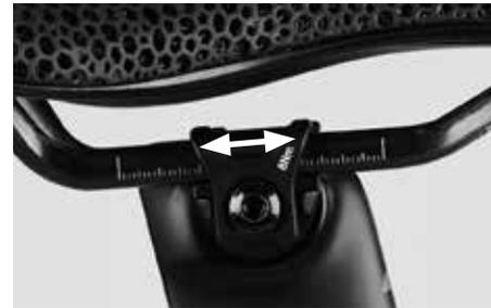
안장의 위치를 원하는 대로 앞쪽 및 뒤쪽으로 조절합니다. 이때 종종 안장을 움직이기 위해 안장을 약하게 손으로 한 번 정도 쳐야 합니다. 안장 레일 위의 표시기호에 주의하고 이를 초과하지 않도록 합니다.
