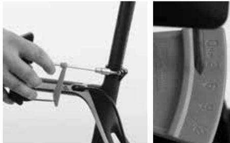
캐니언 토크 렌치의 손잡이를 천천히 돌립니다. 볼트가 고정되면, 표시 바늘이 눈금 위로 올라갑니다. 표시 바늘이 규정된 토크값 숫자 위에 오게 되면, 돌리는 동작을 멈춥니다.
