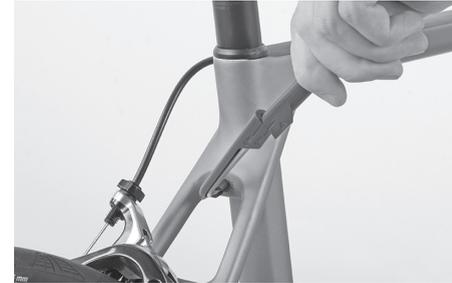
시트 포스트가 프레임에 단단히 고정되었는지 점검하기 위해 손으로 안장의 앞과 뒤를 잡고 안장을 돌려 보십시오. 고무 마개를 다시 시트 튜브의 육각 구멍 볼트 헤드 부분으로 끼우십시오.
