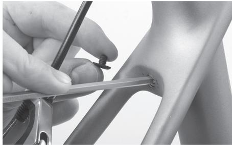
스트럿이 파이프와 만나는 지점의 뒤쪽 안장 튜브로부터 보호 캡 또는 고무 마개를 빼내십시오. 시트 포스트 바인더의 나사를 최대 세 바퀴까지, 두 세 바퀴 돌려서 여십시오. 매커니즘이 개별 부품으로 분리되지 않도록 나사를 완전히 빼내지 말아야 합니다.
