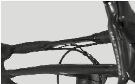
그런 다음 핸들바-스텝 콤비네이션을 핸들 스텝 위로 미십시오. 이때 유압 라인 및 브레이크 케이블이 핸들 스텝 유닛 위로 지나가면서 잘 못 돌아가거나 아래로 꺾이지 않도록 유의합니다. 아울러 블록이나 브레이크에 대해 동일한 반경을 유지할 수 있게 하십시오.
