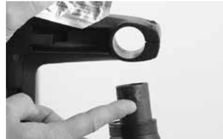
접착제의 사용은 특히 핸들 바 및 스템 사이의 조임, 스티어러 튜브 파이프 및 스템 사이의 조임, 그리고 안장 기둥 및 스템 사이의 조임에 있어 효과적입니다. 이러한 영역에서 조이는 힘을 너무 과도하게 주게 되면, 해당 구성부품이 손상되기 쉽고, 그 결과 부품의 고장 및 보증 내역에서 제외되는 경우가 발생하게 됩니다. 이 때 캐니언 조립 접착제를 사용함으로써 조이는 힘을 더 적게 가하게 되므로, 탄소 섬유 파이프를 막을 수 있습니다. 그 밖에도 조여진 부위에서 자주 발생하는 딱딱거리는 소음 또한 방지됩니다.
