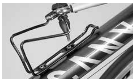
Houd u zich bij de drankhouder aan een maximaal draaimoment van 5 Nm
