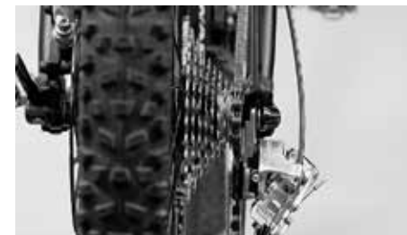
Voor de demontage van het achterwiel op het kleinste rondsel schakelen
