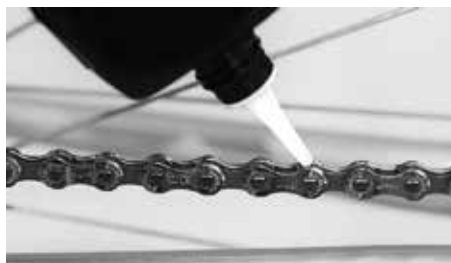
Smeer de liefst blanke kettingschakels met kettingolie in
