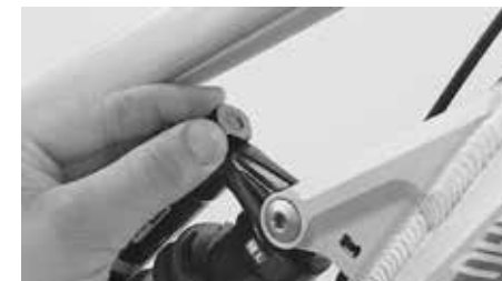
Compressiedemping aan de demper
