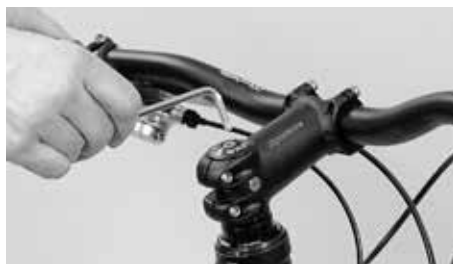
Stel het lager opnieuw af en draai de stuurpen weer vast
