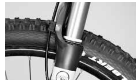
Trek een kabelbinder over de binnenpoot
