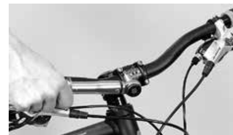
Draai de bouten weer vast met het vereiste aandraaimoment
