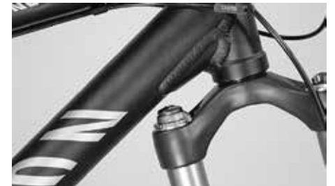
De kop van de vork moet zonder iets aan te raken onder het frame kunnen draaien
