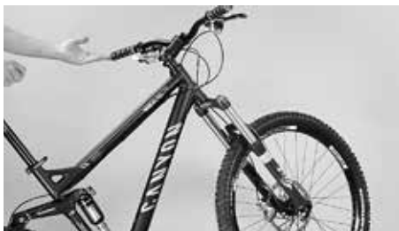
Controleer de lichte loop van het lager door het voorwiel van de grond te tillen en controleer of het heel gemakkelijk draait
