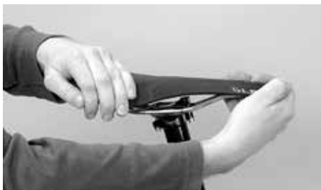
Probeer het zadel ten opzichte van het frame te verdraaien
