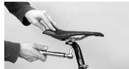
Draai de beide moeren afwisselend en gelijkmatig aan, overschrijd nooit het maximaal toegelaten draaimoment
