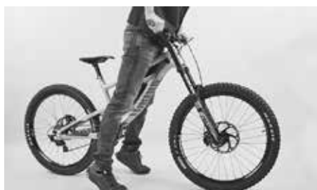
Druk de vork bij aangetrokken voorwielrem omlaag
