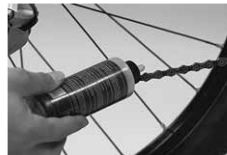
Smeer de ketting na afloop van de onderhoudswerkzaamheden
