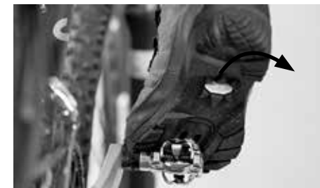
De verbinding van de klikpedalen wordt geopend door de hiel naar buiten te draaien
