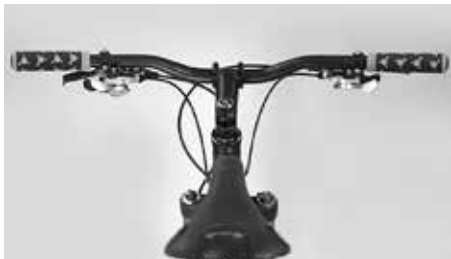
Vergewis u ervan dat het zadel niet is verdraaid door over het zadel heen langs de bovenbuis te peilen
