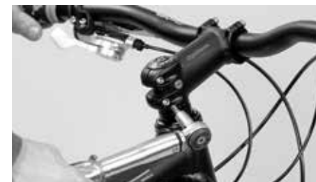
Trek de klemschroeven aan de zijkant van de stuurpen weer aan met de momentsleutel
