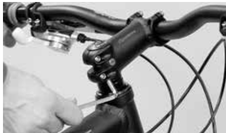
Maak de bouten aan de zijkant van de stuurpen los
