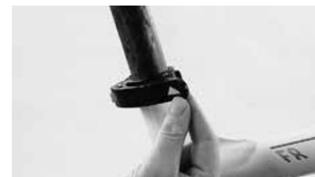
Trek de snelspanner niet al te vast aan
