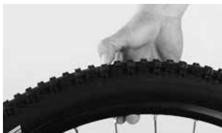
Controleer de bandenspanning
