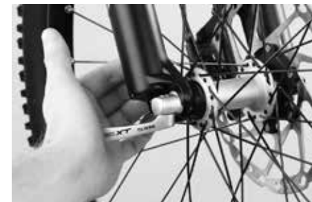
Controleer of de wielen nog veilig zijn vastgeklemd
