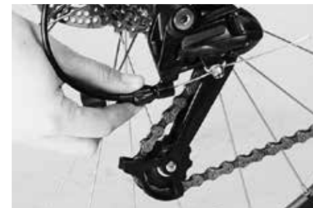
Naspannen van de versnellingskabel met de stelbout op de achterderailleur
