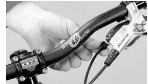
Span de versnellingskabel met de stelbout na
