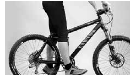
Wanneer de hak op het pedaal rust, dat in de onderste positie staat, moet het gehele been volledig gestrekt zijn
