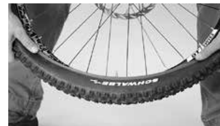
Band met de hand in de velg drukken
