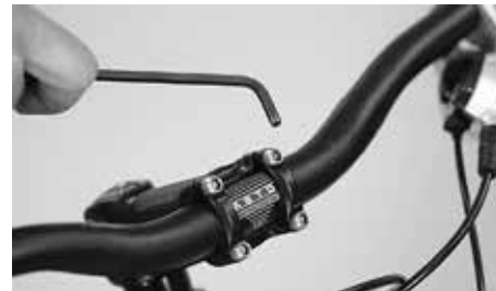
Maak de bouten aan de voorkant van de stuurpen los
