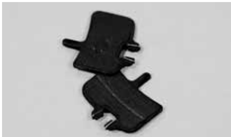
Indien bij remblokjes de dikte minder als een millimeter bedraagt, dienen deze door originele onderdelen te worden vervangen
