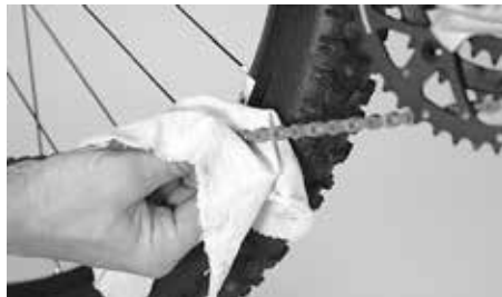
Reinig de ketting met een lap van vuil en olie
