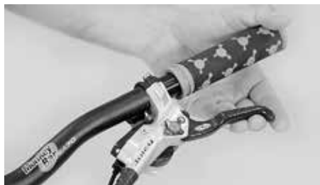
U mag de remgreep niet tot aan het stuur kunnen doortrekken
