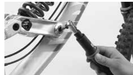
Controleer regelmatig of alle schroefverbindingen van de achtersvork goed vastzitten volgens de voorgeschreven aanhaalmomenten
