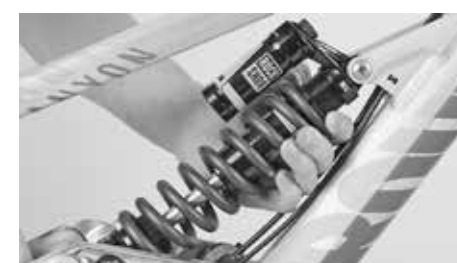
Bij stalen veren draait u aan de gekartelde instelling om de veerspanning te wijzigen
