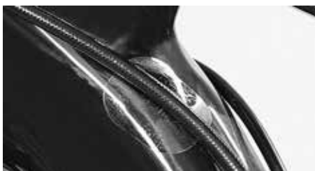
Speciale stickers beschermen carbon voor beschadiging
