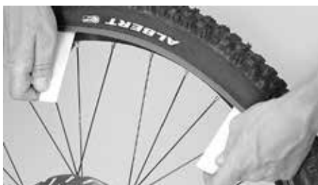
Plaatsen van de bandenlichter en lichten van de zijkant van de band over de rand van de velg
