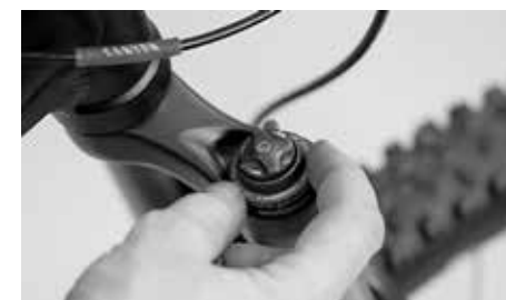
Verstel mogelijkheden van de compressiedemping
