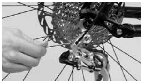
Voor het instellen van de afstand tussen de wieljesbehuizing en de krans verdraait u de moer die aan de voorkant van de uitvalpad stut
