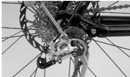
Beperk het draaibereik van de derailleur met de eindaanslagbouten
