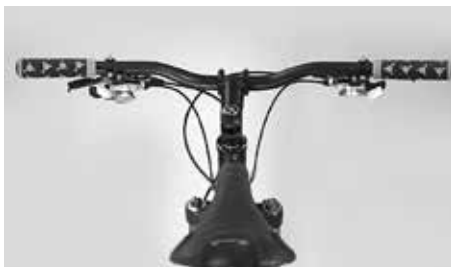
Vergewis u ervan dat het zadel niet is verdraaid door over het zadel heen langs de bovenbuis te peilen
