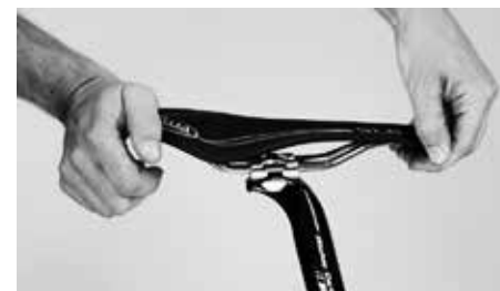
Controleer of het weer vastgeschroefde zadel kantelt
