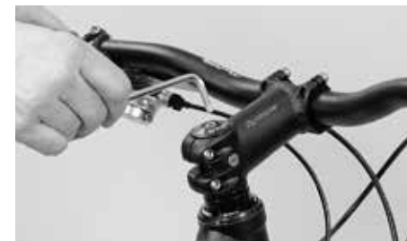
Stel de speling van het lager met de boven verzonken liggende instelbout in nadat u de klembouten opzij heeft losgemaakt
