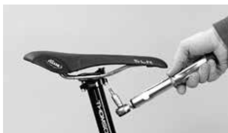
Draai de bouten afwisselend en gelijkmatig aan met het voorgeschreven draaimoment
