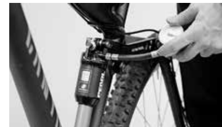
Bij luchtdempers wordt voor de afstelling de luchtdruk aangepast
