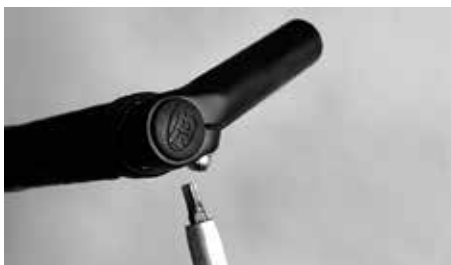
Draai de bouten weer vast met het vereiste draaimoment
