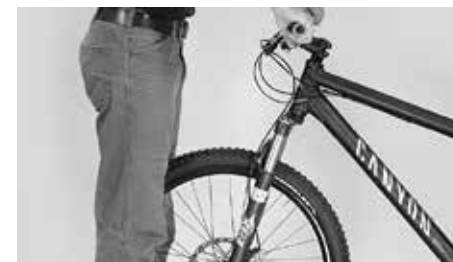
Probeer het stuur ten opzichte van het voorwiel te verdraaien
