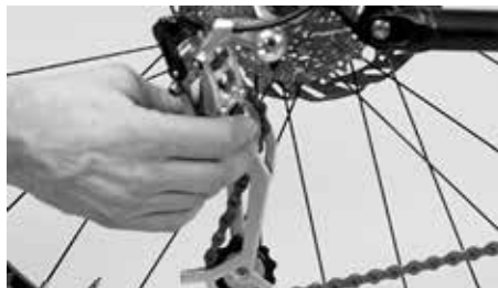
Controleer of de derailleur tussen de spaken terecht kan komen
