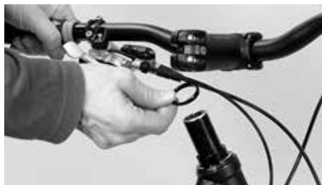
Neem de tussenringen er uit en steek deze vervolgens boven de stuurpen weer op
