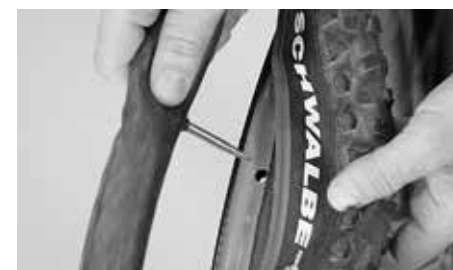
Ventiel in het ventielgat steken
