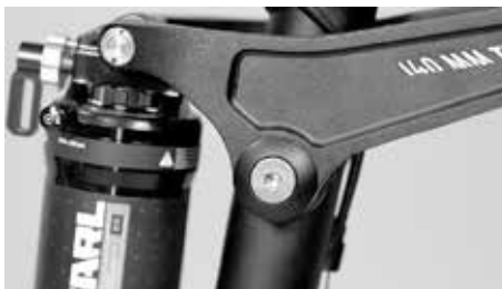
Lagers zijn aan een bepaalde slijtage onderhevig
