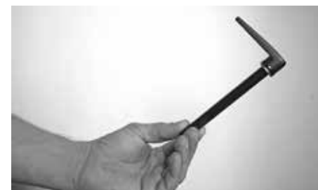
RWS-system fra DT Swiss for racersykler
