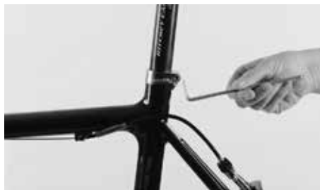
For å kunne stille inn sittehøyden, må du løsne setepinneskruen på seteklemmingen
