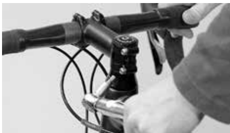
Trekk til klemskruene på siden av styrestemmet igjen med momentnøkkelen
