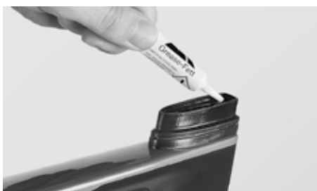
Ettersmøring av pakning
