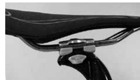
Rett inn setet slik at stativet blir klemt innenfor markeringene
