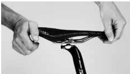
Kontroller om det fastskrudd setet vipper
