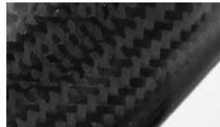
Kontroller komponentene av karbon spesielt nøye og skift dem for sikkerhets skyld ut hvis du er i tvil
