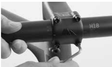
Åpne unbrakoskrue(e) på forsiden av styrestemmet
