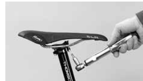
Trekk til skruene igjen vekselvis og jevnt med foreskrevet tiltrekkingsmoment
