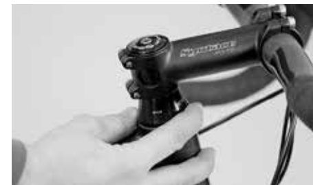
Kontroller klaringen i styrelageret ved å legge fingrene rundt lagerskålen og skyv Canyon med tiltrukket brems fram og tilbake
