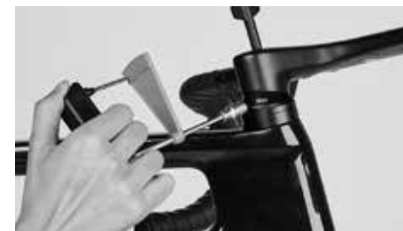
Trekk til skruen på baksiden av hetten til styrelageret med det angitte tiltrekkingsmomentet på 9 Nm
