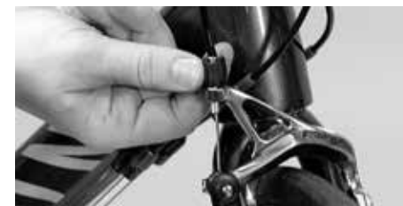
Bremsens dødgang stilles inn med fingermutteren
