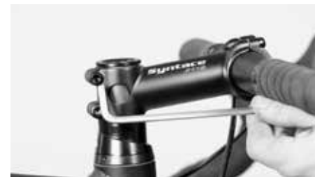
Løsne skruene på siden av styrestemmet
