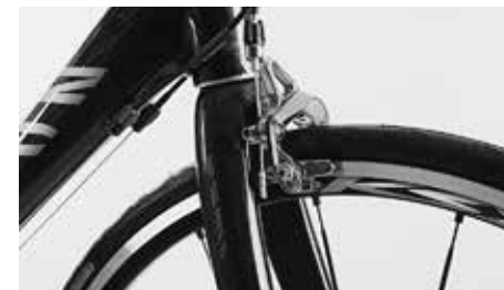
Kontroller kastfritt løp ved hjelp av bremseklossene
