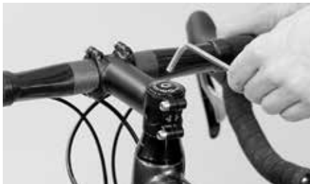
Still inn lagerklaringen med den nedsenkede stillskruen oppe etter at du har løsnet klemskruene på siden
