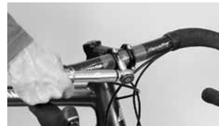
Trekk til skruene igjen med foreskrevet tiltrekingsmoment
