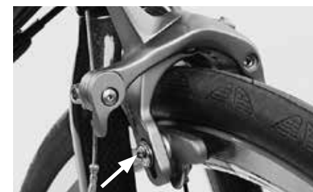
Juster høyden ved å trekke til festeskruen til bremseklossen med foreskrevet tiltrekkingsmoment
