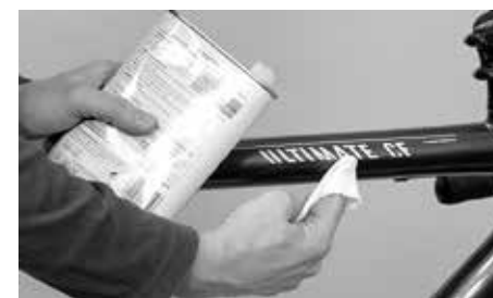
Konservering av lakk og metalloverflater med hardvoks
