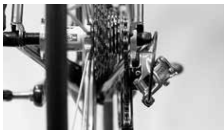
Se på drevkassetten bakfra og kontroller om trinsejehlulene til girmekanismen ligger nøyaktig under tannspissene på det passende drevet
