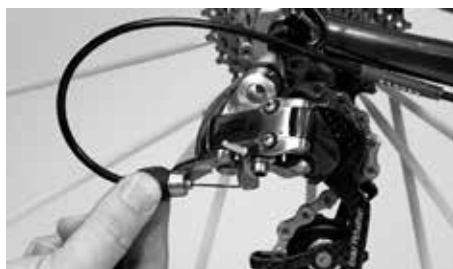
Etterstramming av girvaieren med stillskruen på girmekanismen
