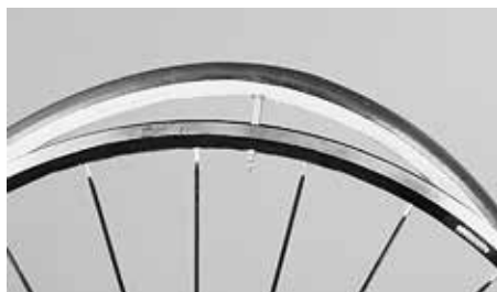
Stikk ventilen på det litt oppumpede dekket inn i ventilhullet i felgen
