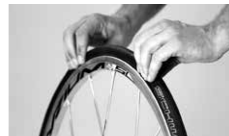
Trykk dekket mot begge sider for å sikre at slangen ikke er inne-klempt
