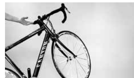
Kontroller om lageret går lett ved å løfte forhjulet opp og prøve om det lar seg bevege meget lett
