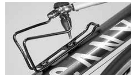
Hold deg til et maksimalt tiltrekkingsmoment på 2 Nm for flaskeholderen
