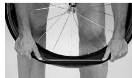
Trykk dekket med tommelfingrene over felgkanten
