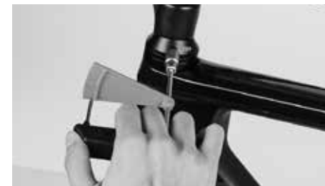
Du skal bare løsne skruene én til to omdreininger, og ikke i noe tilfelle skru dem helt ut
