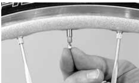
På racer- eller Sclaverand-ventiler må ventilen skrues opp
