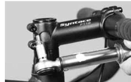
Kontroller klemskruene på siden av styrestemmet med momentnøkkelen iht. de påtrykte opplysningene
