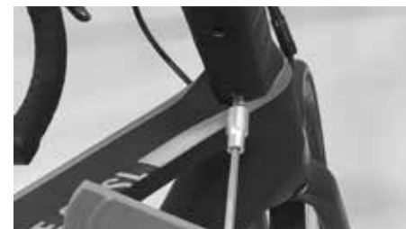
Skru inn skruen til overgangsplaten
