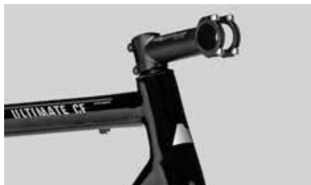
Ferdig montert og innstilt styresett med styrestem og gaffel
