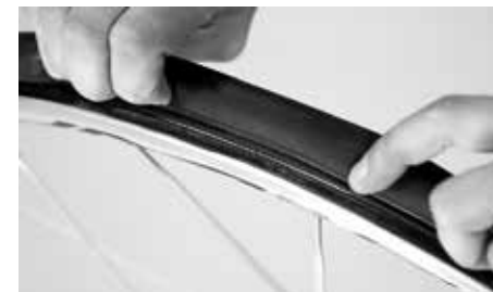
Trykk dekket mot midten av felgen
