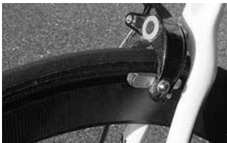
Karbonfelger trenger spesielle bremseklosser iht. hjulprodusentens anvisninger
