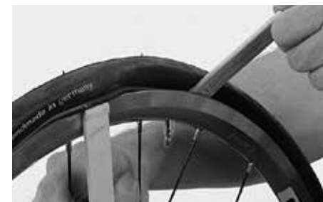
Sett på monteringsspaken og løft dekket over felgkanten
