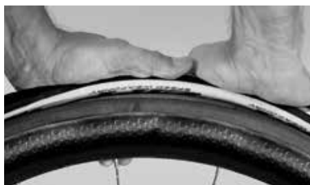
Trykk dekket til side til det dannes en sprekke
