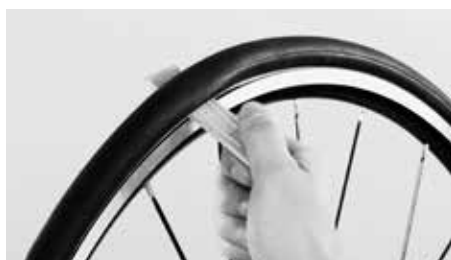
Dekket kan trekkes av med en monteringspak
