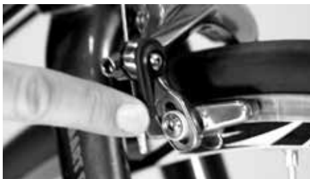
Kontroll av kastfritt løp ved hjelp av bremseklossene
