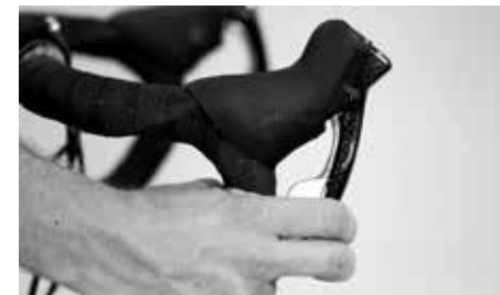
Bremsespaken må ikke kunne trekkes helt inn til styret
