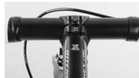
Slissene mellom styrestemdeksel og styrestem må være parallelle og like brede oppe og nede
