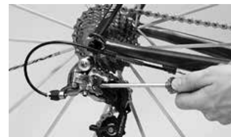
Begrens girmekanismens svingområde med endeanslagsskruene
