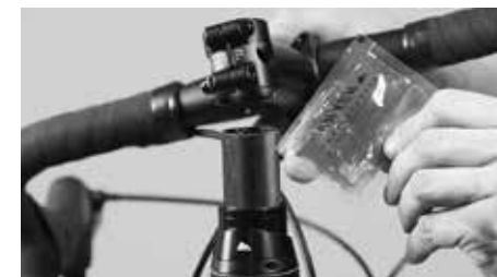
Fukt gaffelskaftet med karbonmonteringspasta
