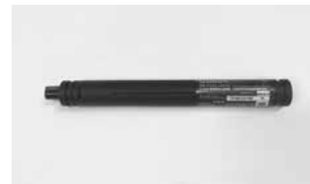
Di2-batteriet kan også monteres skjult i underrøret
