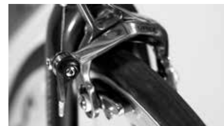
Kontroll av kastfritt løp ved hjelp av bremsen
