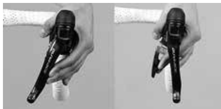
Gir-/bremsespak fra Shimano
