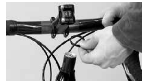
Ta ut mellomringene og sett dem på igjen på oversiden av styrestemmet
