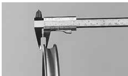
Få veggtykkelsen på felgene kontrollert senest etter det 2. bremsekloss-settet
