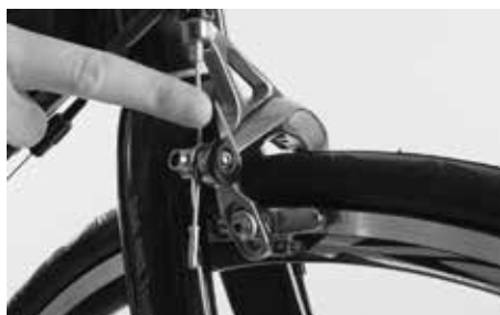
Åpne løsespaken på bremsen
