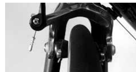
Kontroll av kastfritt løp ved hjelp av bremsen
