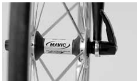
Spaken for hurtigkoblingen må ligge nesten parallelt med hjulet og må ikke stå ut til siden
