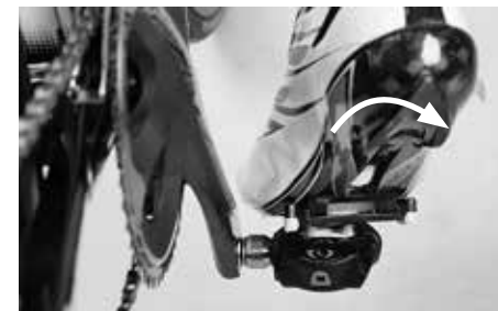
Klikkpedalenes forbindelse løsnes ved å vri hælen utover
