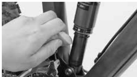
Czyszczenie kolumny resorującej wodą i gąbką
