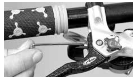
Ustawianie odległości do dźwigni hamulca
