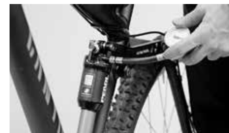
W amortyzatorach powietrznych przy dostosowywaniu zmienia się ciśnienie
