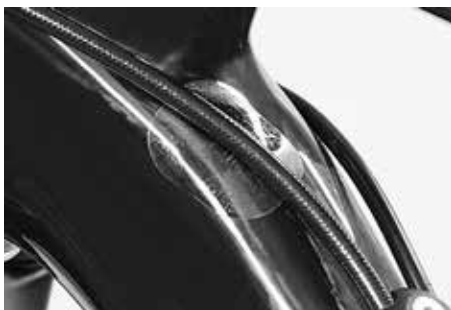
Specjalne naklejki chronią karbon przed uszkodzeniami
