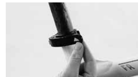
Nie dokręcać za mocno szybkozamykacza
