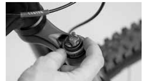
Możliwości przestawiania tłumienia przy ugięciu amortyzatora
