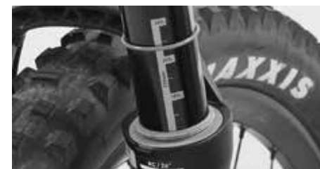
Wstępne ugięcie – „sag” przy widelcu amortyzowanym widelcu
