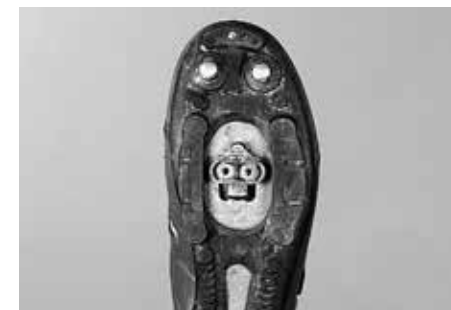
W podeszwach umieszczone są małe płytki (cleats)
