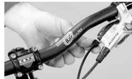
Naciągnąć linkę przerzutek śrubą nastawczą
