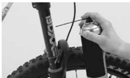
Po czyszczeniu nałoż trochę zalecanego smaru
