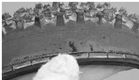
Stopkę opony przed montażem zwilżyć wodą z mydłem
