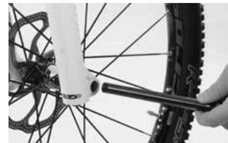
System osi wtykanych Rock Shox Maxle i Maxle-Lite 15 lub 20 mm
