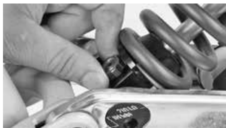
Tłumienie przy rozciąganiu amortyzatora u kolumny resorującej
