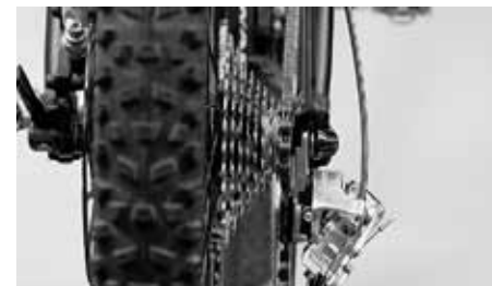
Przed demontażem koła tylnego przełączyć na najmniejszą zębatkę
