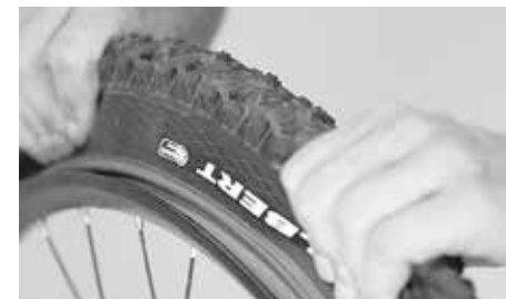
Przeciskanie opony bezdętkowej na środek obręczy
