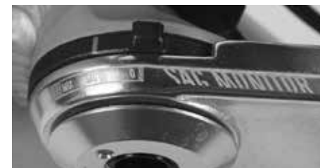
Wstępne ugięcie – „sag” przy amortyzacji tylnego trójkąta
