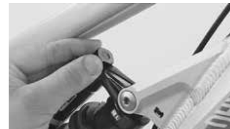
Tłumienie przy ugięciu amortyzatora u kolumny resorującej
