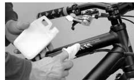
Konserwacja lakieru i powierzchni metalowych twardym woskiem
