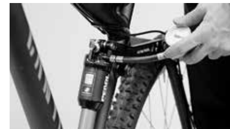
W przypadku amortyzacji pneumatycznej regularnie sprawdzaj ciśnienie powietrza
