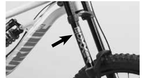
Amortyzujący widelec – ustawienie ugięcia sprężyny
