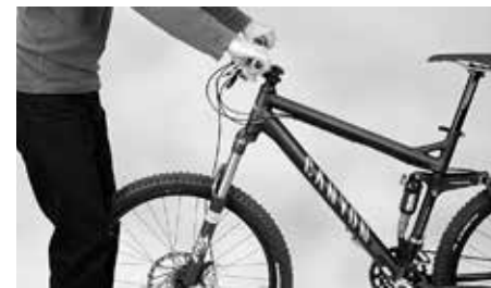
Spróbować przekręcić kierownicę względem przedniego koła
