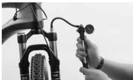
W przypadku amortyzacji pneumatycznej regularnie sprawdzaj ciśnienie powietrza
