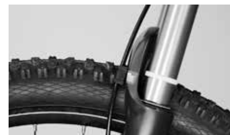
Na podstawie przesunięcia opaski zaciskowej określić można ugięcie sprężyny
