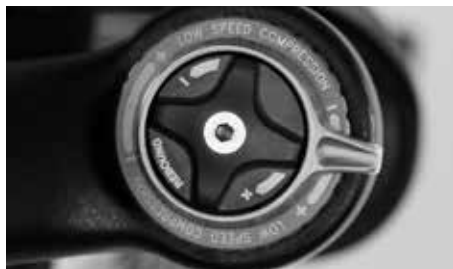
Tłumienie przy ugięciu amortyzatora opóźnia ugięcie
