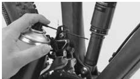
Po czyszczeniu nałóż trochę zalecanego smaru
