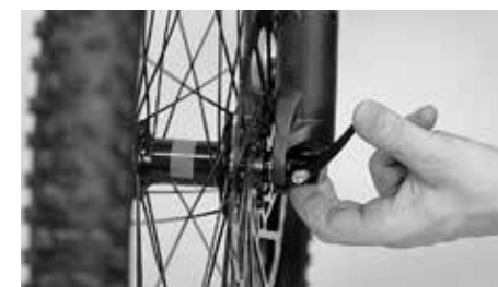
Zwróć uwagę na poprawne osadzenie szybkozamykacza
