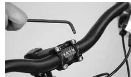
Odkręcić śruby z przodu wspornika kierownicy
