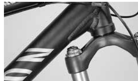
Głowica widelca musi mieć możliwość przekręcenia się bez styczności pod ramą
