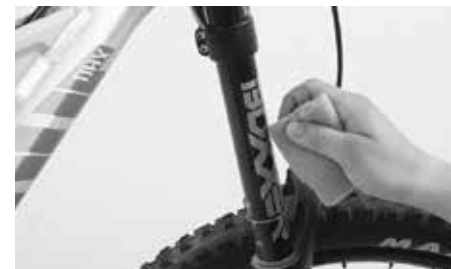
Golenie górne widelca utrzymywać zawsze w czystości
