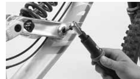
Sprawdzaj regularnie mocne osadzenie wszystkich połączeń śrubowych tylnego trójkąta według wytycznych
