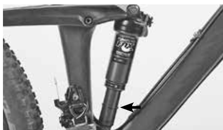
Przesunięty O-ring na górę amortyzatora pokazuje zużyte ugięcie sprężyny
