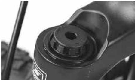
Napięcie wstępne widelec ze stalową sprężyną
