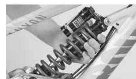
W sprężynach stalowych przekręcasz radełkowy pierścień nastawczy, aby zmienić napięcie sprężyny
