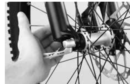
Sprawdzić, czy koła nadal są bezpiecznie zaciśnięte
