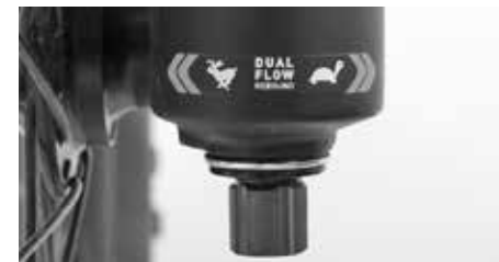
Tłumienie przy rozciąganiu amortyzatora opóźnia rozprężanie
