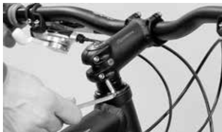
Odkręcić śruby z boku wspornika kierownicy
