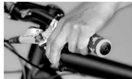
Odległość do dźwigni w hamulcach
