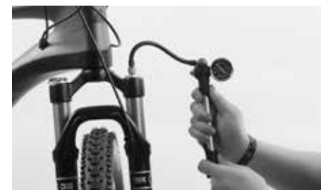
Ustawianie twardości amortyzacji za pomocą pompki do widełców amortyzowanych
