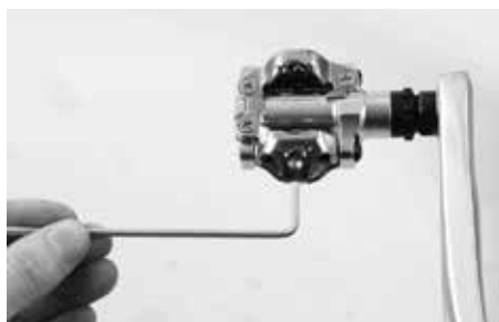
Poziom intensywności wypinania buta ustawić należy pod kątem Twoich potrzeb
