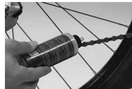
Po zakończeniu czyszczenia nasmarować łańcuch
