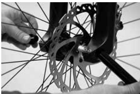
Mocowanie koła za pomocą osi wtykanych
