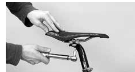
Dokręcić śruby nie jednocześnie oraz równomiernie, nigdy nie przekraczając dopuszczalnego maksymalnego momentu dokręcania
