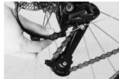
Dociąganie linki przerzutki przy śrubie nastawczej na przerzutce tylnej
