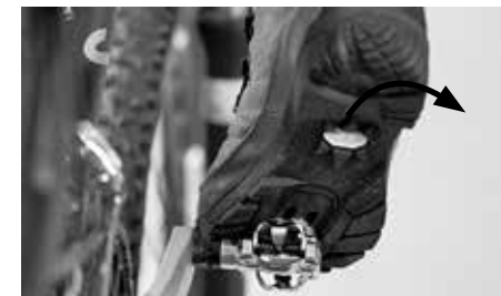
Połączenie pedałów zatrzaskowych odczepia się poprzez odchylenie pięty na zewnątrz
