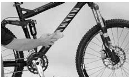
Czyszczenie roweru Canyon wodą i ścierką
