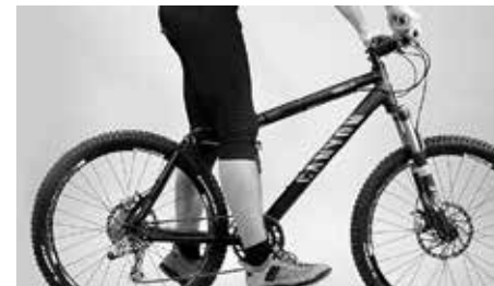
Jeśli pięta położona jest na znajdującym się w najniższej pozycji pedale, noga musi być całkowicie wyprostowana
