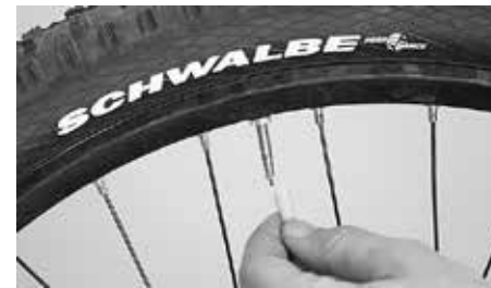
Odkręcania nakładki z tworzywa sztucznego
