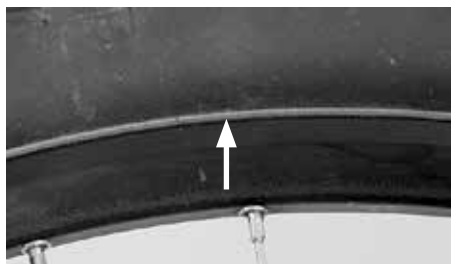
Pierścień kontrolny na ścianie bocznej opony
