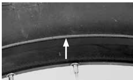
Pierścień kontrolny do osadzenia opony
