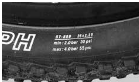
Rozmiar oraz zakresy ciśnienia powietrza opony
