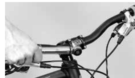
Dokręcić śruby zalecanym momentem dokręcania
