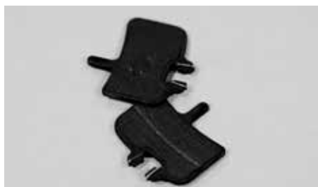
Okładziny hamulcowe o grubości poniżej jednego milimetra trzeba wymienić na oryginalne części zamienne
