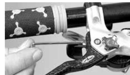
Ustawianie odległości do dźwigni hamulca
