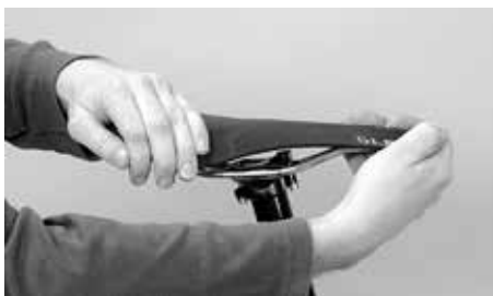
Spróbować przekręcić siodełko względem ramy
