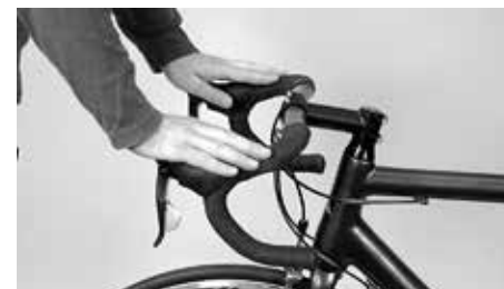
Przy gwałtownym nacisku kierownica nie ma prawa się przekręcić
