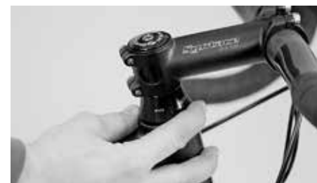
Następnie ponownie przeprowadź sprawdzenie luzu
