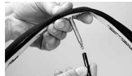
Montaż przedłużenia zaworu
