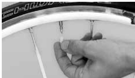
Odkręcanie nakładki z tworzywa sztucznego
