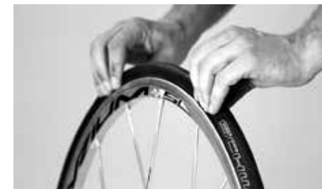
Naciśnij oponę, aby się upewnić, że dętka nie jest ściśnięta
