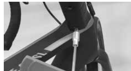
Odkręć śrubę płytki
