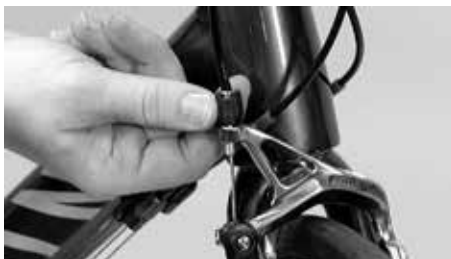
Przy pomocy nakrętki radełkowej ustawić odpowiedni skok dźwigni hamulca
