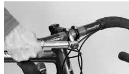
Dokręć śruby zalecanym momentem dokręcania
