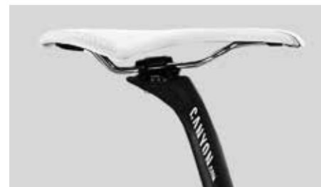
Siodełko w żadnym wypadku nie powinno być pochylone do tyłu
