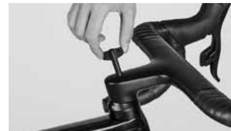
Użyj w tym celu specjalnego narzędzia, które znajduje się w kartonie z częściami drobnymi
