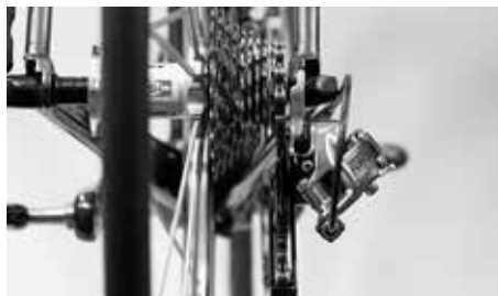
Przed demontażem koła tylnego przełączyć na najmniejszą zębatkę
