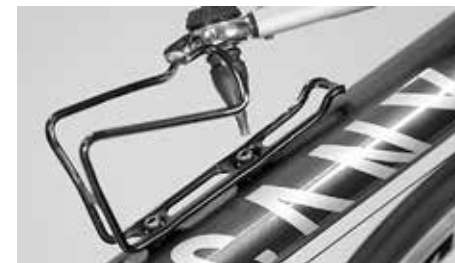
Przy uchwycie na bidon przestrzegać maksymalnego momentu dokręcania wynoszącego 2 Nm
