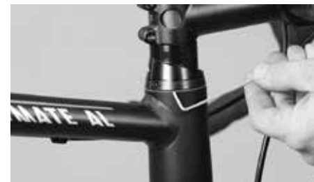
Luz łożyska ustawić przy pomocy znajdującej się z boku śruby nastawczej
