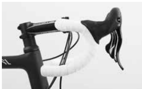
Prosty odcinek dolnej części kierownicy powinien być ustawiony równolegle do podłoża lub być skierowany lekko w dół
