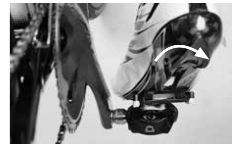
Połączenie odłącza się poprzez odchylenie pięty na zewnątrz
