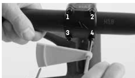
Dokręć śruby zgodnie z podanym momentem dokręcania
