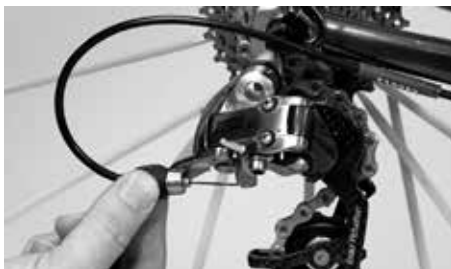
Dociąganie linki przerzutki przy śrubie nastawczej na przerzutce tylnej
