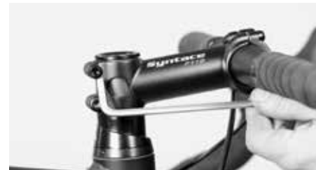
Odkręcić śruby z boku wspornika kierownicy
