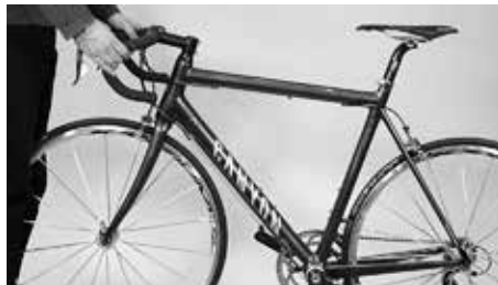
Spróbuj przekręcić kierownicę względem przedniego koła i względem wspornika
