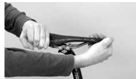
Spróbować przekręcić siodełko względem ramy
