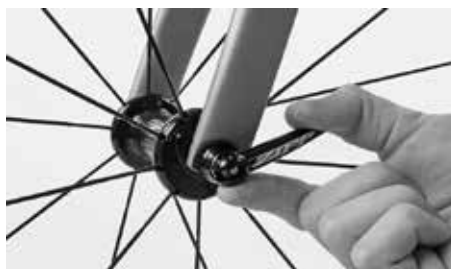
Sprawdź pozycję próbując przekręcić zamkniętą dźwignię
