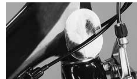
Specjalne naklejki chronią karbon przed uszkodzeniami
