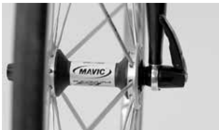
Sprawdzić, czy oba koła nadal są mocno zaciśnięte w hakach widelca
