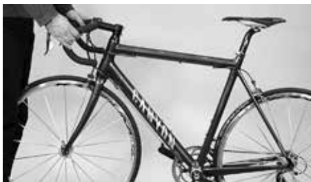
Spróbować przekręcić kierownicę względem przedniego koła
