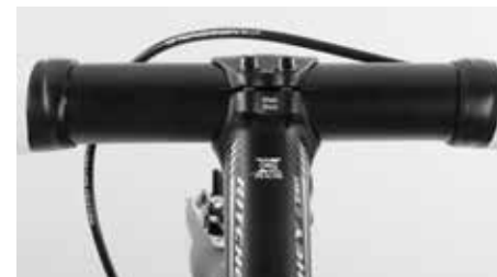
Szczeliny między pokrywą wspornika a korpusem wspornika muszą przebiegać równolegle do siebie i mieć tę samą szerokość u dołu
