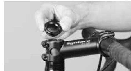
Ściągnij nakrętkę górną
