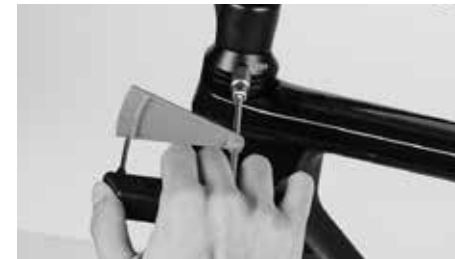
Poluzuj śruby tylko o jeden do dwóch obrotów, lecz w żadnym wypadku nie wykręcaj ich całkowicie
