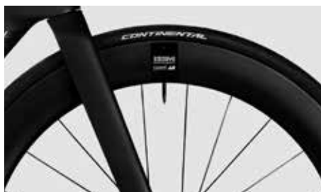
Koła z obręczami z karbonu charakteryzują się specyfiką hamowania
