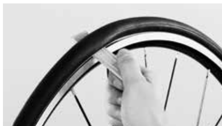
Za pomocą łyżki montażowej można wyważyć oponę
