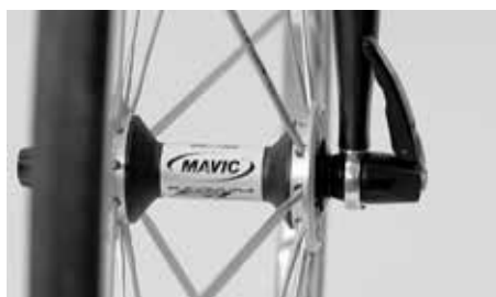
Dźwignia szybkozamykacza musi być ustawiona w miarę równolegle do roweru i nie może odstawiać na bok
