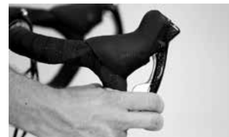
Po przyciągnięciu dźwigni hamulca nie powinna stykać się z kierownicą
