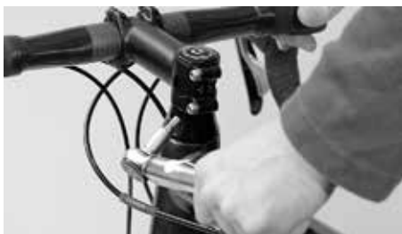
Dokręcić wspornik uwzględniając zalecany moment dokręcania
