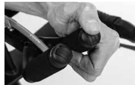
Manetki końcowe sterują przerzutką tylną i przednią
