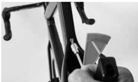
Nie należy przekraczać podanego maksymalnego momentu dokręcania
