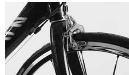
Sprawdzanie ruchu obrotowego na podstawie okładzin hamulcowych
