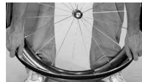
Wsunąć oponę w kanał obręczy
