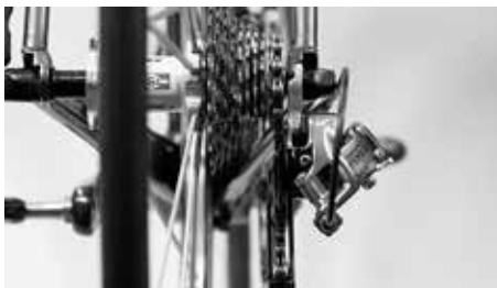
Sprawdzić, czy łańcuch nadal umieszczony jest na zębatkach przednich i tylnych
