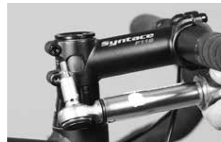
Sprawdzić śruby zaciskowe z boku wspornika kierownicy kluczem dynamometrycznym zgodnie z nadrukowanymi wskazówkami
