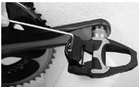
Ustawianie poziomu intensywności wypinania buta w pedale
