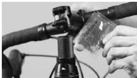
Na rurę widelca w razie potrzeby nałóż nieco pasty montażowej do karbonu
