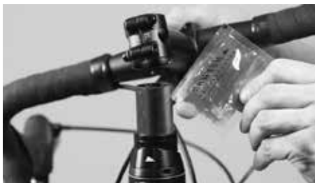
Na rurę widelca nałożyć nieco pasty montażowej do karbonu
