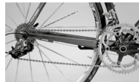
Rower odstawić z łańcuchem na najmniejszej zębatce i małym kole zębatym
