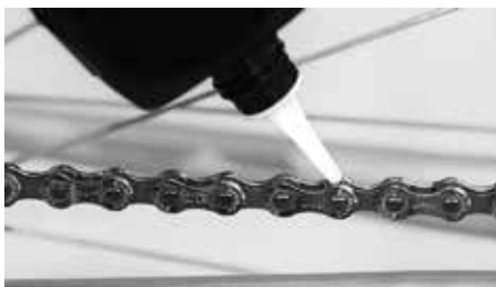
Na możliwie jak najczystsze ogniwa łańcucha nanieść należy olej do łańcucha
