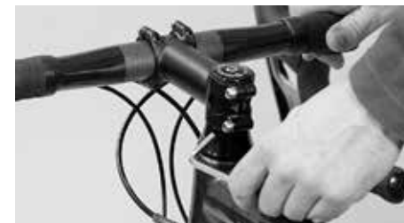
Odkręcić śruby z boku wspornika kierownicy
