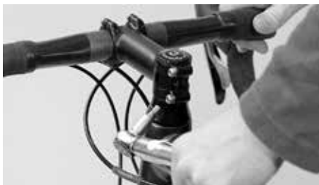
Ponownie dokręć boczne śruby zaciskowe wspornika kierownicy kluczem dynamometrycznym
