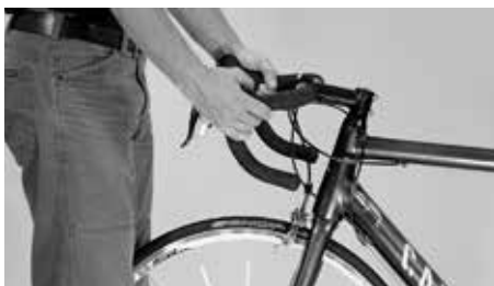
Spróbować przekręcić kierownicę względem przedniego koła
