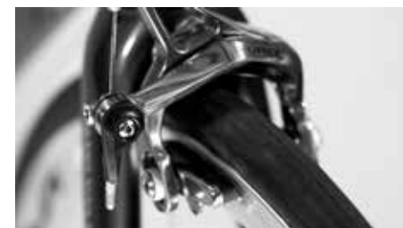
Sprawdzić ruch obrotowy za pomocą hamulca
