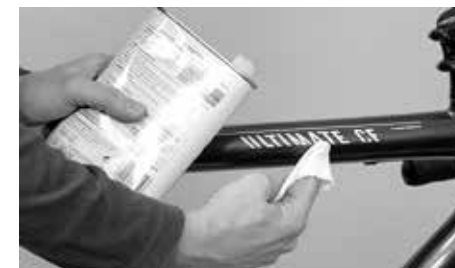
Konserwacja lakieru i powierzchni metalowych twardym woskiem
