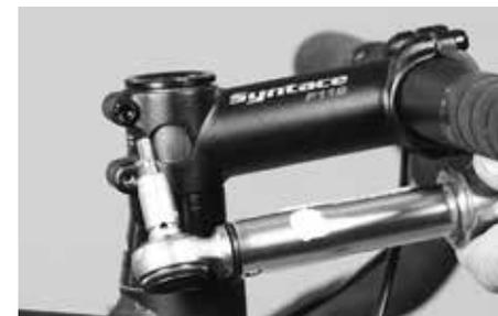
Controle os parafusos de aperto do avanço laterais com uma chave dinamométrica, segundo as indicações impressas
