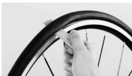
Com uma alavanca de montagem, é possível levantar o pneu
