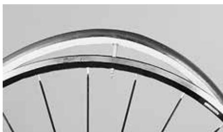
Coloque a válvula, do pneu ligeiramente cheio, no orifício do aro
