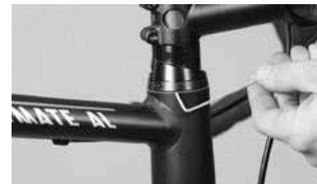
Ajuste a folga da caixa com o parafuso lateral de ajuste
