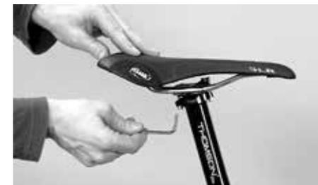
Desaperte os dois parafusos, dando no máximo duas a três voltas
