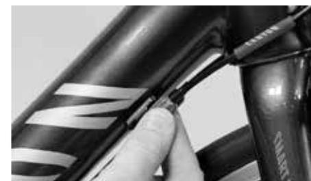
Reajuste do cabo das mudanças no parafuso de ajuste no quadro
