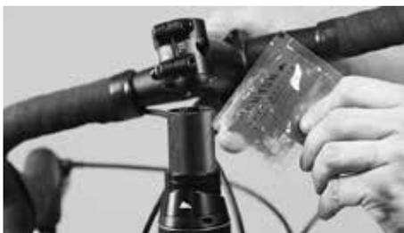
Aplique, se necessário, pasta de montagem para carbono no tubo do garfo ou no guidador
