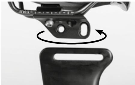
Se a margem de ajuste continuar a não ser suficiente, desaperte totalmente ambos os parafusos sextavados internos colocados na horizontal. Remova a corredeira de aperto do selim para fora do espigão do selim e volte a colocá-lo com uma rotação de 180°. Em seguida terá de rodar também o selim.
