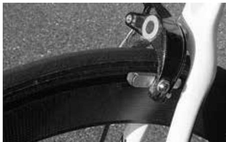
Os aros de carbono precisam de calços de travões especiais de acordo com as instruções do fabricante da roda
