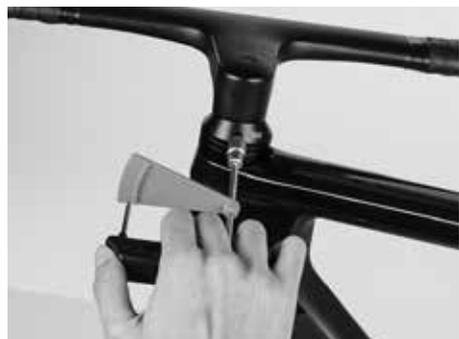
Montagem com a chave dinamométrica da Canyon
