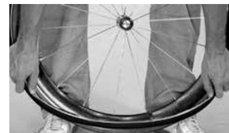
Levantar o pneu para dentro do leito do aro
