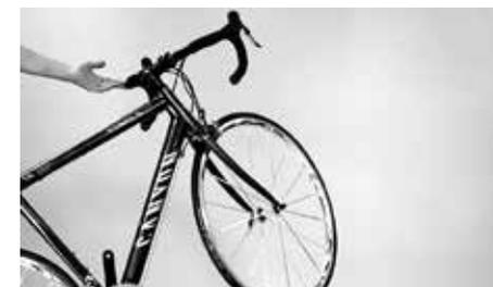
Verifique a movimentação fácil dos rolamentos, levantando a roda dianteira e verificando se esta se deixa rodar com facilidade
