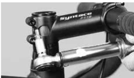
Aperte bem todos os parafusos de fixação do avanço com uma chave dinamométrica, segundo as indicações
