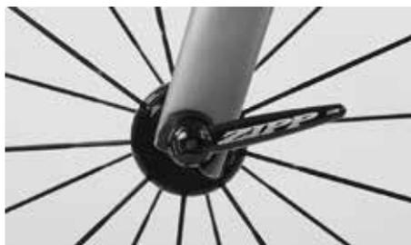
Na sua posição final a alavanca tem de ficar perpendicular ao eixo do aperto rápido
