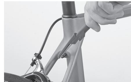
Controle a fixação segura do espigão do selim no quadro, segurando para isso o selim à frente e atrás e tentando rodá-lo. Coloque novamente o tampão de borracha na cabeça do parafuso sextavado interno no tubo do selim.
