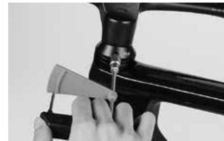
O ajuste da folga da caixa de direção é assegurado pela placa de transição.
