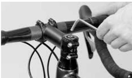
Ajuste a folga dos rolamentos com o parafuso de ajuste, introduzido por cima, após ter soltado os parafusos laterais de aperto
