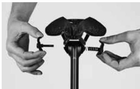
O parafuso de aperto é composto por duas peças, i. e. do lado direito tem um parafuso normal e do lado esquerdo um pino roscado.
