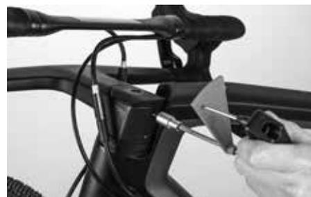
Aperte os parafusos do cockpit GRAIL alinhado com a chave dinamométrica Canyon com 7,5 Nm.
