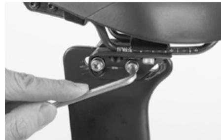
Desaperte primeiro os dois parafusos sextavados internos posicionados horizontalmente que fixam o aperto da corrediça do selim, duas a três voltas. Se necessário, prenda os parafusos no lado contrário com outra chave allen.
