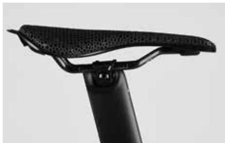
Nestes espigões de selim, a cabeça que fixa a inclinação e a posição horizontal do selim é mantida por um parafuso sextavado interno horizontal e colocado na transversal do sentido de marcha.
