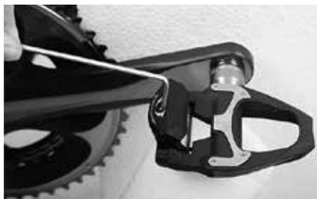
Ajuste da força de encaixe dos pedais
