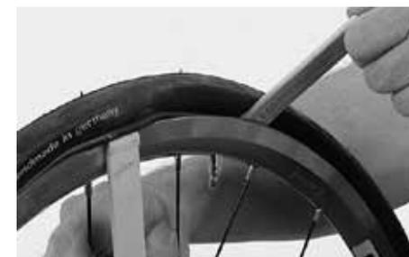
Aplicação da alavanca de montagem e levantar o flanco do pneu sobre o friso do aro
