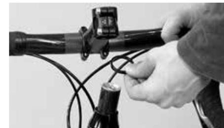
Remova os anéis espaçadores e coloque-os de novo posteriormente na parte superior do avanço
