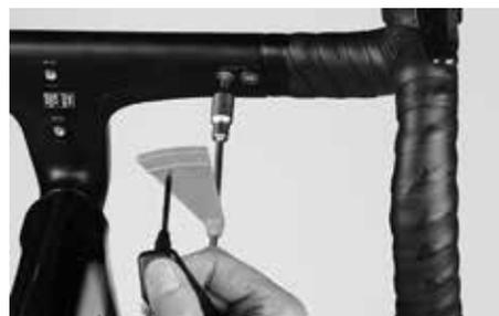
Desaperte completamente os dois parafusos Torx colocados por baixo do corpo do avanço.
