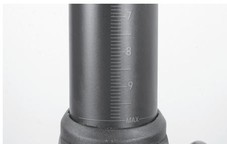
Insira o espigão do selim no tubo do selim, até atingir a altura necessária do selim. O seu espigão do selim tem de estar inserido no quadro, no mínimo até estar abaixo do tubo superior ou até à marcação MAX do espigão.
