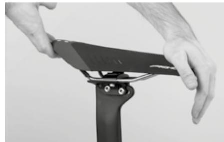
Ajuste o selim na posição horizontal ou ligeiramente inclinado para a frente. Quando o selim está demasiado inclinado para a frente, não consegue pedalar descontraidamente. Tem de se apoiar constantemente no guiador para não escorregar do selim.
