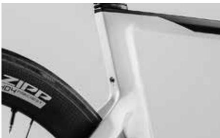
Desaperte o parafuso no aperto do tubo do selim duas no máximo três voltas. Não necessita de desapertar completamente o parafuso, caso contrário o mecanismo pode desmontar-se completamente.
