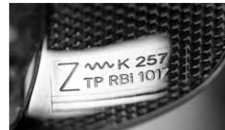
Retroreflector com marca de verificação
