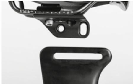
Com as possibilidades de ajuste, sobretudo através da rotação da corrediça do selim, é alcançada outra margem de ajuste com uma distância entre 0 mm e 85 mm relativamente ao centro do movimento pedaleiro.
