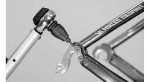
Ao trocar o dropout substituível, não deve ultrapassar de forma alguma o binário de aperto máximo de 1,5 Nm
