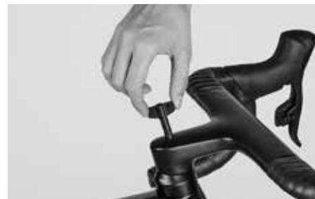
Introduza depois a ferramenta especial no orifício na parte superior do corpo do avanço. Encontrará a ferramenta especial na caixa de papelão com as peças pequenas.
