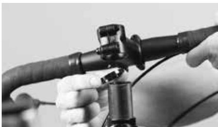
Remove os anéis espaçadores
