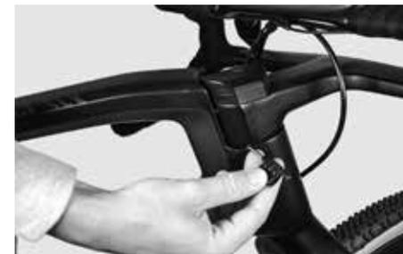
Para ajustar a caixa de direção, esta placa de transição tem de ser solta da mesma forma como o aperto do tubo do garfo no cockpit GRAIL.
