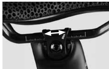
Desloque o selim como desejar para a frente ou para trás. Frequentemente é preciso, para isso, dar uma pequena pancada no selim. Tome atenção às marcações na armação e não as ultrapasse.
