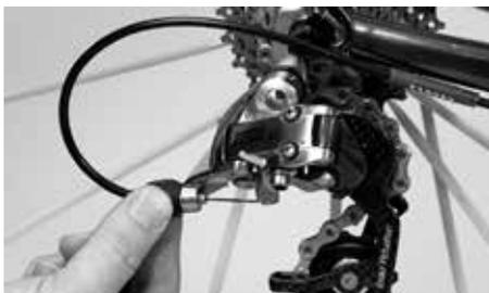
Reajuste da tensão do cabo das mudanças com o parafuso de ajuste no desviador traseiro
