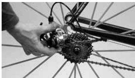
Para a desmontar a roda traseira, puxe o desviador traseiro um pouco para trás
