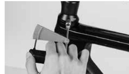
Desaperte os parafusos apenas uma a duas voltas, mas nunca totalmente
