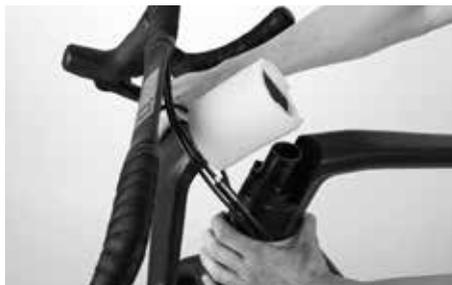
Segure bem na combinação guiador-avanço e desaperte a fita com fecho velcro em cima no avanço que fixa o guiador.
