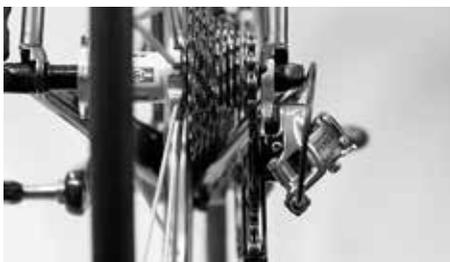
Olhe por detrás para o corpo da cassette e verifique se as roldanas do desviador se encontram exactamente por debaixo dos dentes afiados do pinhão adequado
