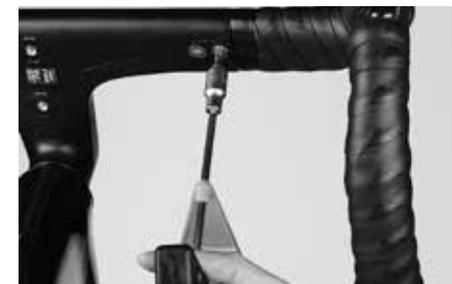
Após ter ajustado a largura desejada do guiador, coloque por lateral do guiador os dois parafusos Torx colocados por baixo do corpo do avanço. Aperte-os minuciosamente algumas voltas com os dedos.
