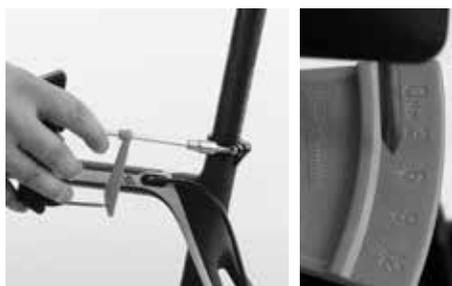
Rode devagar o punho da chave dinamométrica Canyon. Se o parafuso começar a apertar, o ponteiro vai-se deslocando sobre a escala. Termine o movimento rotativo, assim que o ponteiro estiver sobre o número do binário prescrito.
