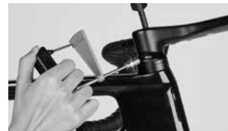
Aperte o parafuso na traseira da cobertura da caixa de direção com o binário de aperto indicado de 9 Nm
