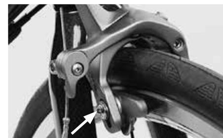
Para o ajuste da altura, aperte o parafuso de fixação do calço com o binário de aperto prescrito
