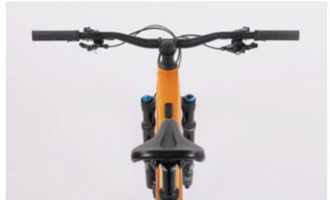
Olha por cima do selim ao longo do tubo superior para te certificares de que não está desalinhado
