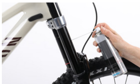
Depois da limpeza, aplica um pouco de lubrificante autorizado
