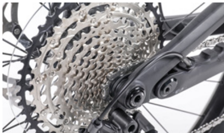
Guardar a bicicleta com a corrente no pinhão menor
