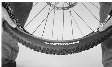
Pressionar o pneu para dentro do aro com a mão
