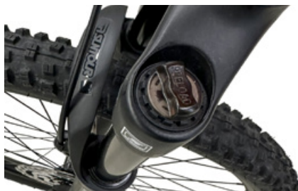
Tensão prévia garfo com mola de aço
