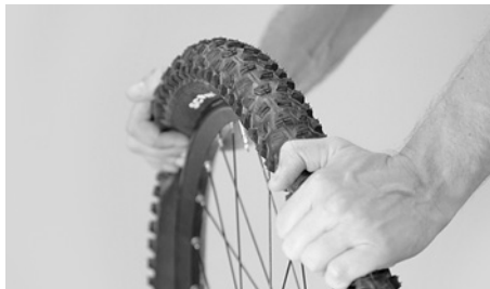
Pressiona o pneu para ambos os lados para teres a certeza de que a câmara de ar não está entalada
