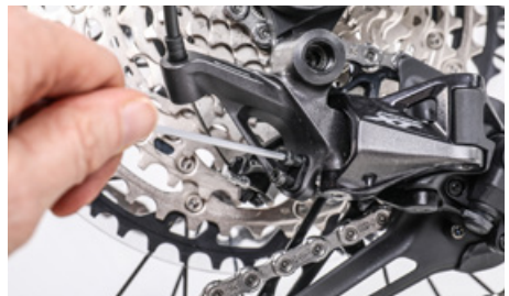
Delimita a área de rotação do desviador traseiro com os parafusos limitadores de curso
