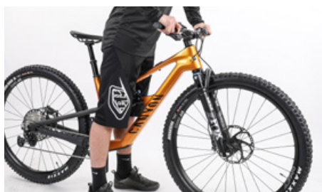
Pressiona o garfo para baixo com o travão da roda dianteira comprimido
