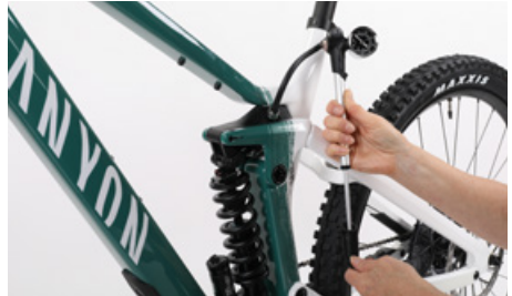
Nas molas pneumáticas, verifica a pressão do ar regularmente
