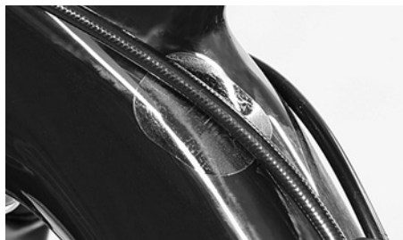
Autocolantes especiais protegem o carbono contra danos
