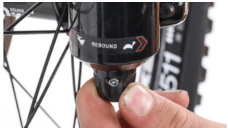
A recuperação do amortecimento retarda a descompressão
