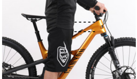
O quadro deve proporcionar altura de entrepernas suficiente
