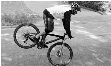
Durante a travagem, o peso é transferido de trás para frente
