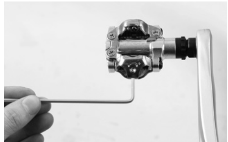
Ajusta a força de encaixe dos pedais às tuas necessidades
