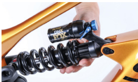
Em molas de aço, roda o anel de ajustamento serrilhado para alterar a tensão da mola
