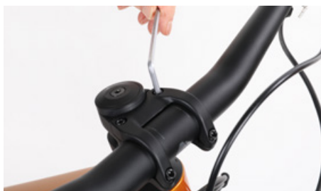
Desaperta o(s) parafuso(s) sextavado(s) interno(s) na parte dianteira do avanço
