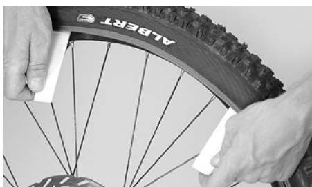
Aplicar a alavanca de montagem e levantar o flanco do pneu sobre o friso do aro
