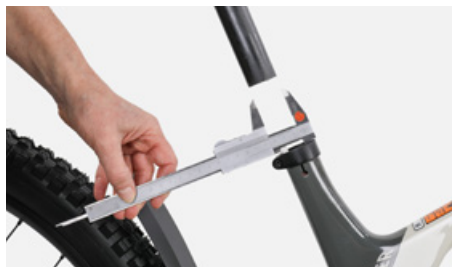
Certifica-te de que o espigão do selim se adapta exatamente ao quadro
