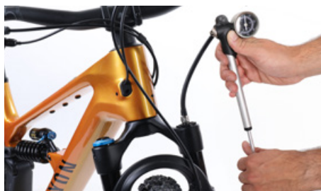
Nas molas pneumáticas, verifica a pressão do ar regularmente
