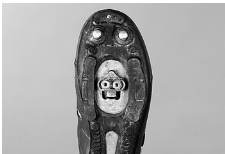
Nas solas estão embutidas pequenas plaquetas de encaixe ("cleats")
