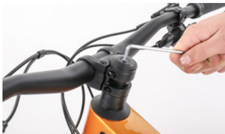
Ajusta a folga da caixa de direção com o parafuso de ajuste, introduzido por cima, após teres soltado os parafusos laterais de aperto
