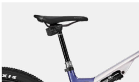
A aresta superior do selim deve ficar, se possível, na horizontal
