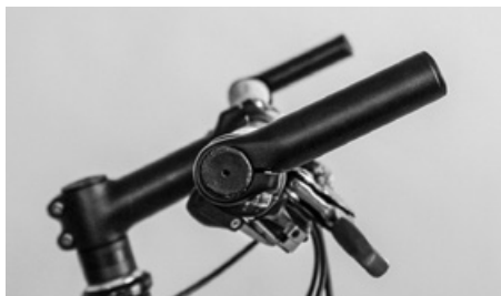
Extensores de guiador permitem uma maior variação da posição das mãos
