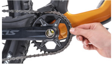
Verificação do estado da corrente
