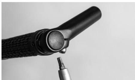
Reaperta os parafusos com o binário necessário
