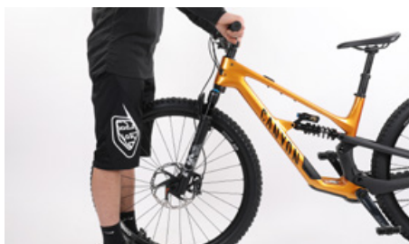
Tenta deslocar o guiador para o lado contrário à roda dianteira
