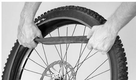
Puxar a câmara de ar para fora do pneu
