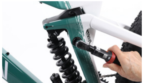
Verifica regularmente a fixação segura de todos os aparafusamentos da parte traseira, de acordo com os binários de aperto prescritos
