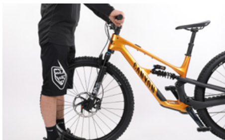
Tenta deslocar o guiador para o lado contrário à roda dianteira
