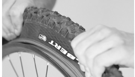
Pressionar o pneu sem câmara de ar para o meio do aro
