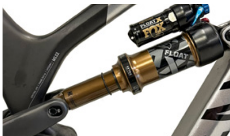
A junta circular deslocada sobre o amortecedor indica o percurso de amortecimento utilizado
