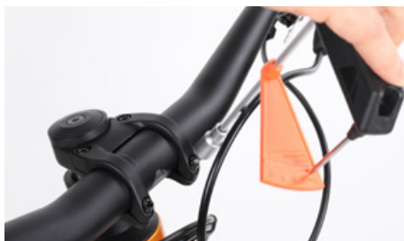
Reaperta os parafusos de forma fixa
