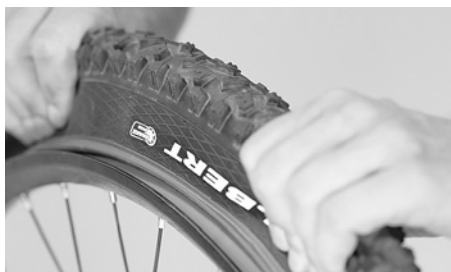
Pressionar o pneu para o centro do aro
