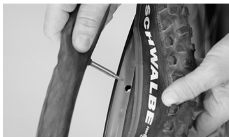
Colocar a válvula no orifício do aro
