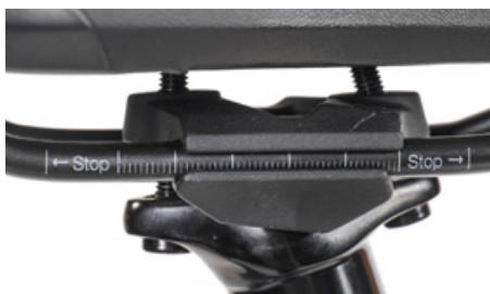
Posiciona o selim de tal forma, que a armação seja fixada dentro das marcações
