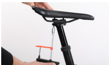
Aperta os parafusos, alternadamente e de forma homogênea, com os binários de aperto prescritos
