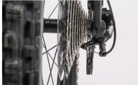
Antes da desmontagem da roda traseira, engata a corrente no pinhão menor de todos
