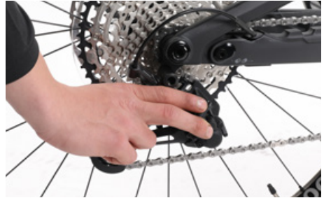
Certifica-te de que o desviador traseiro não pode entrar em contacto com os raios
