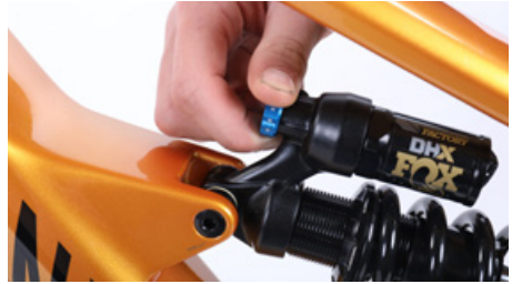
Amortecimento de compressão na perna da suspensão
