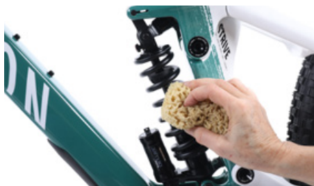
Limpeza da perna da suspensão com uma esponja e água
