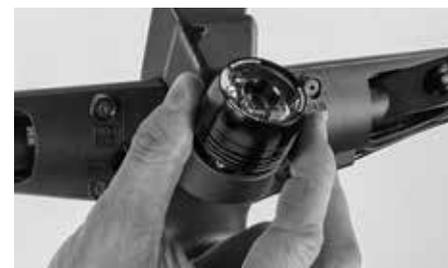
Desaperte o parafuso de fixação do farol só até o farol se deixar deslocar com a mão, para cima e para baixo, no suporte.
