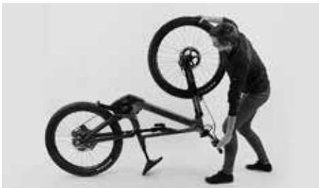
Solte o travão e pegue na roda dianteira pelo ponto mais superior. Coloque-se ao lado da sua Canyon Spectral:ON no lado oposto do acionamento de corrente. Deste modo, evita o contacto com a corrente e os pratos da corrente durante os trabalhos. Coloque o guiador cuidadosamente no solo.
