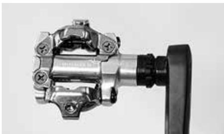
⚡ Em bicicletas de estrada E e bicicletas Gravel E só podem ser utilizados pedais de sistema ou encaixe. Pedais de plataforma e pedais duplos (de um lado um pedal de encaixe, do outro um pedal de plataforma) não podem ser utilizados.
