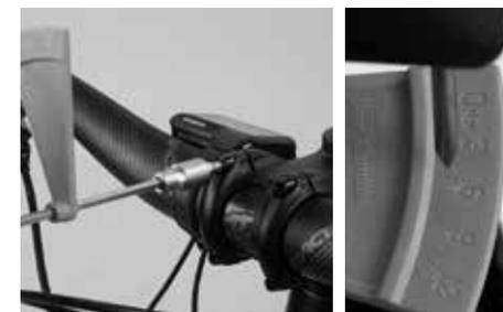
Rode devagar o punho da chave dinamométrica Canyon. Se o parafuso começar a apertar, o ponteiro vai-se deslocando sobre a escala. Termine o movimento rotativo, assim que o ponteiro estiver sobre a marcação do binário prescrito.
