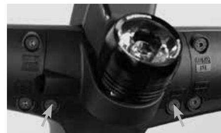
Em seguida tem de remover a cobertura do farol na parte inferior do guiador. Para este fim desaperte os dois parafusos na parte inferior do guiador com a chave allen de 3 mm.
