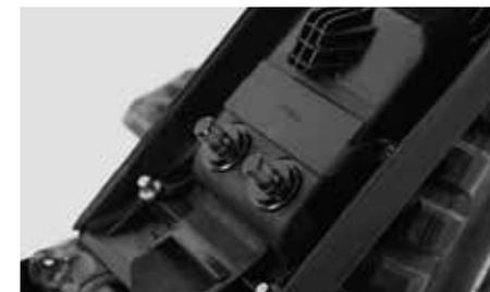
Prenda os dois parafusos desapertados nos dois pontos magnéticos de depósito no lado interior da tampa. Certifique-se de que o ponto de depósito está limpo.
