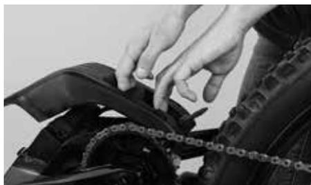
Primeiro levante levemente a tampa e puxe, em seguida, a tampa para cima transversalmente na continuação do tubo inferior.
