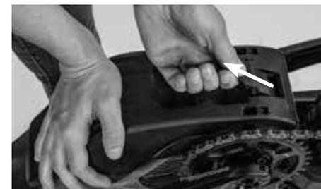
Carregue levemente sobre a parte traseira da tampa de modo que as ligações encaixem corretamente. Feche a patilha de borracha, puxando-a para a frente. Puxe a patilha de borracha para baixo e deixe os pinos da patilha de borracha encaixar no suporte.
