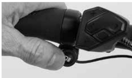
Após a ativação da iluminação, as luzes podem depois ser ligadas ou desligadas no interruptor Remote, por meio de uma pressão prolongada sobre o mesmo. Quando a iluminação está ligada, os máximos ou os médios podem ser ligados no interruptor Remote, por meio de uma breve pressão sobre o mesmo.
