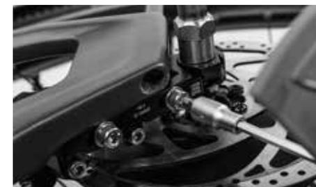
Depois de ter ajustado a tensão da correia, rode os quatro parafusos de fixação na parte inferior da escora inferior (duas de cada lado) alternadamente e pouco a pouco com 8 Nm (ver impressão).
