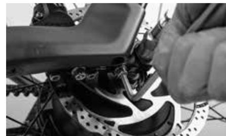
No total, cada lado ou ponteira possui dois parafusos de fixação que se encontram na parte inferior do quadro ou da escora inferior.
