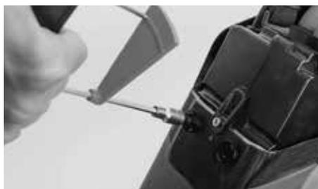
Remova os dois parafusos um a seguir ao outro dos pontos magnéticos de depósito. Certifique-se de que as roscas e os parafusos estão limpos. Coloque os parafusos com os dedos. Aperte os dois parafusos, um a seguir ao outro, algumas voltas no sentido dos ponteiros do relógio.
