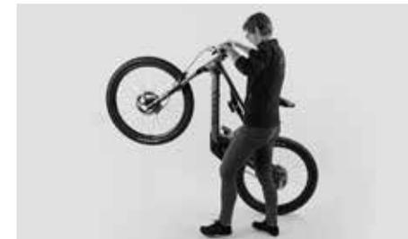
Aperte completamente o travão da roda traseira e levante a roda dianteira da sua Canyon Spectral:ON.
