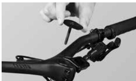
Coloque o parafuso de ajuste (parafuso Ahead) juntamente com a tampa no avanço. Aperte o parafuso de ajuste na rosca com os dedos as primeiras duas a três voltas.
