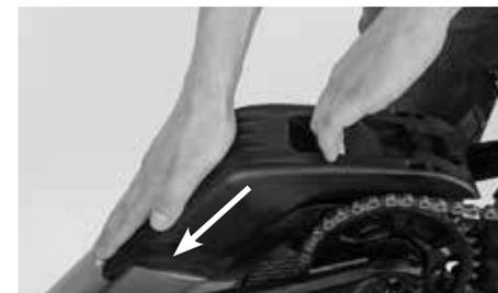
Introduza a tampa cuidadosamente sobre o tubo inferior transversalmente para baixo. Certifique-se de que as duas ranhuras na tampa deslizam sobre os parafusos anteriormente colocados.
