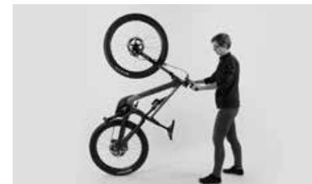
Desloque o guiador e a roda dianteira para trás, formando um movimento de semicírculo e coloque-se cuidadosamente atrás da sua Canyon Spectral:ON.
