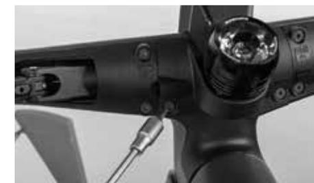
A seguir tem de voltar a montar a cobertura do farol. Aperte para isso os dois parafusos na parte inferior do guiador com 2 Nm.
