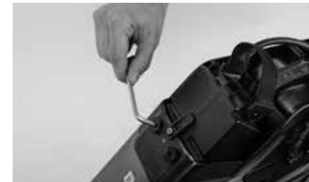
Desaperte, com uma chave allen de 5 mm ou com a chave dinamométrica Canyon fornecida, inclusa na Smallbox, os dois parafusos para fixação do acumulador no tubo inferior e desmonte completamente estes parafusos.
