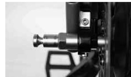
Em modelos de Pedelec com mudanças de cubo não é necessário substituir totalmente o cubo para poder utilizar o reboque Croozer. Tem apenas de substituir a porca do eixo no lado esquerdo do eixo.
