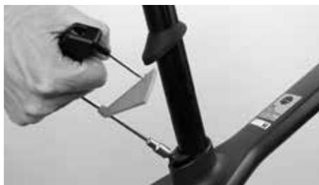
Após ter ajustado a altura correta do selim, aperte bem o parafuso sextavado interno no mecanismo de aperto com 7 a 8 Nm. Utilize uma chave dinamométrica. Por fim, volte a deslocar a cobertura de borracha sobre o mecanismo de aperto até este ficar coberto.
