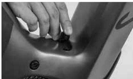
Remova a tampa de borracha que se encontra por cima do pedaleiro entre o tubo inferior e o tubo do selim.
