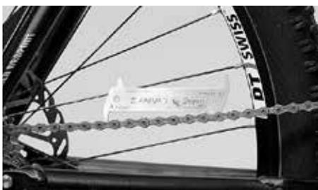
⚠ Durante a limpeza, verifique se existem rachas, riscos, deformações do material ou mudanças de cor. Em caso de dúvida, é favor entrar em contato com a nossa linha direta de assistência técnica. Mande substituir, imediatamente, peças danificadas e corrigir a pintura em pontos danificados.
