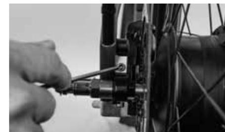
Ao alterar a tensão da correia certifique-se de que desaperta e aperta ambos os parafusos de ajuste de forma uniforme.
