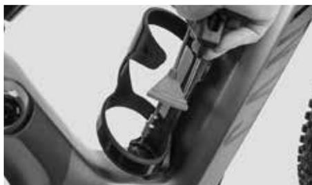
Introduza os dois parafusos compridos fornecidos nas roscas no fundo do suporte para garrafas. Aperte bem os parafusos com a chave dinamométrica Canyon e um binário de aperto de 3 Nm. Não ultrapasse o binário de aperto prescrito pela Canyon.
