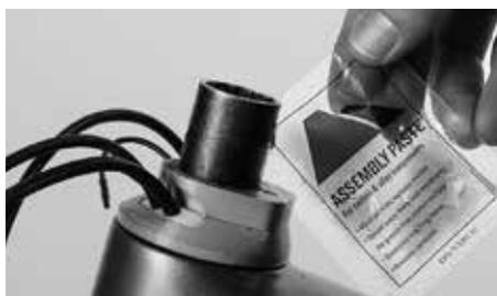
Coloque Canyon Assembly Paste na zona visível do tubo do garfo e na parte interior do aperto do avanço. Aplique uma camada fina e uniforme da pasta que aumenta o atrito.
