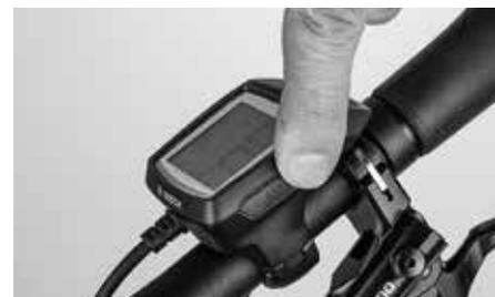
Desligue o sistema através da tecla Ligar/Desligar no visor (Bosch), através do Remote no tubo superior (Shimano) ou através do Power-Button no acumulador (Fazua).
