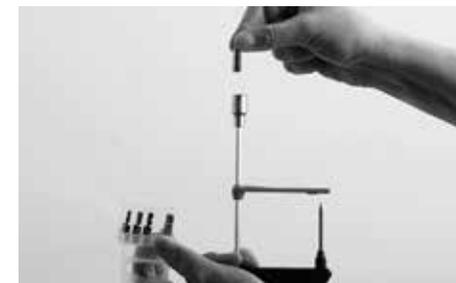
Encaixe a ponta adequada na cavidade da chave dinamométrica Canyon.
