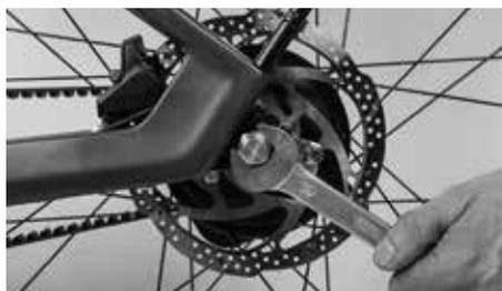
Agora desaperte as porcas do eixo ou a porca do eixo com o adaptador Croozer montado com uma chave de bocas ou eventualmente com uma chave anular no sentido contrário ao dos ponteiros do relógio. As porcas do eixo, na maioria das vezes, não precisam de ser removidas completamente, em regra é suficiente desaparafusá-las três a cinco voltas.
