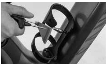
Introduza o parafuso curto fornecido na rosca superior e aperte-o com os dedos duas a três voltas. A seguir, aperte o parafuso com a chave dinamométrica Canyon com 2 Nm. Não ultrapasse o binário de aperto prescrito pela Canyon.
