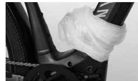
⚠ Se tiver tirado o segundo acumulador da sua Pedelec, com bateria dupla, do tubo inferior: Preste atenção para não entrar sujidade nem humidade nas ligações do acumulador. Coloque a cobertura de proteção eventualmente fornecida sobre as ligações do seu acumulador ou proteja as ligações com um saco plástico. O visor e principalmente a iluminação deixam provavelmente de estar à disposição.
