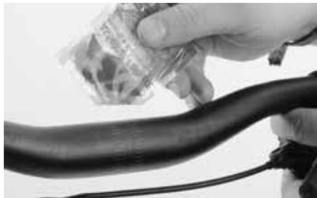
Garante ainda proteção máxima contra corrosão, impedindo-a eficazmente, mesmo em condições de humidade. A Canyon Assembly Paste pode ser utilizada em todas as ligações de carbono e de alumínio. Ela é ideal para esta finalidade, uma vez que não endurece.
