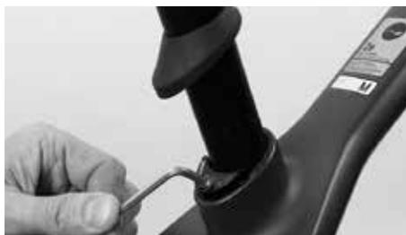
Desparafuse depois o parafuso sextavo interno no mecanismo de aperto (traseira do tubo do selim), que aperta o espigão do selim ao tubo do selim, no sentido contrário ao dos ponteiros do relógio aprox. uma volta. Não desaperte totalmente o parafuso, visto que este é um componente essencial do sistema de aperto.
