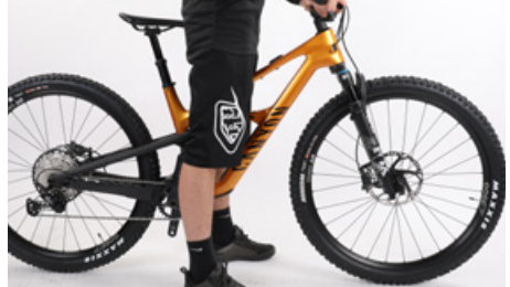
Kontroll av avståndet mellan överröret och kroppen
