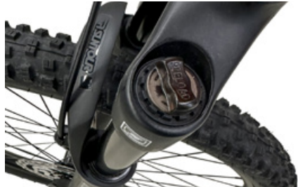
Förspänning för gaffel med stålfjäder
