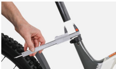
Kontrollera att sadelstolpen passar exakt till ramen
