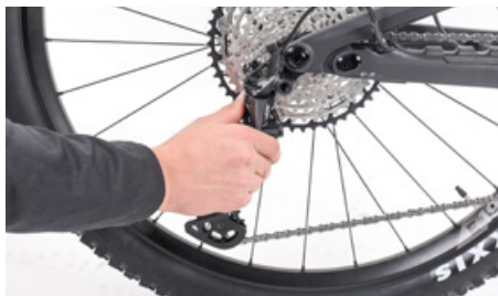
Dra bakväxeln något bakåt för att demontera bakhjulet
