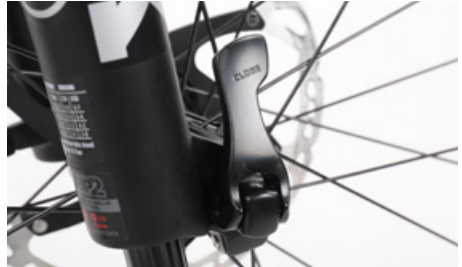
Kontrollera att snabbkopplingen sitter korrekt
