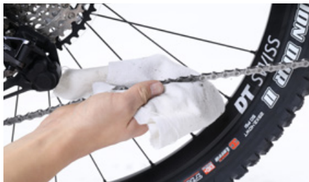
Ta bort smuts och olja från kedjan med en trasa
