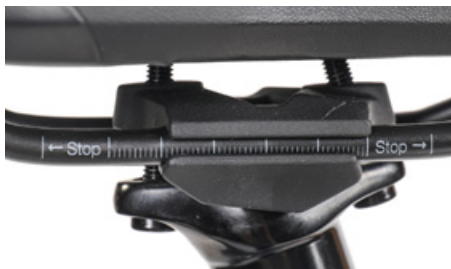
Rikta upp sadeln så att sadelrälserna kan fästas inom markeringarna
