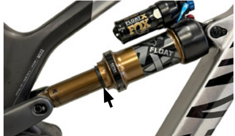
O-ringen sitter längst upp på dämparen
