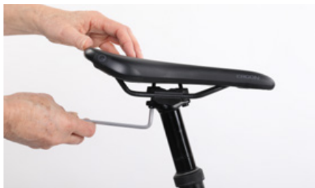
Lossa de båda skruvarna två till max. tre varv
