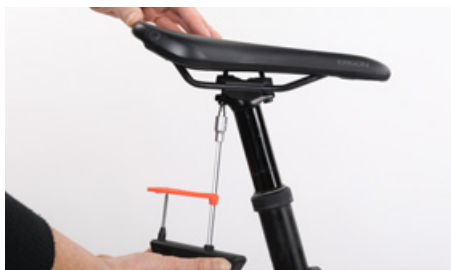
Dra fast skruvarna igen jämnt och omväxlande med det föreskrivna åtdragningsmomentet
