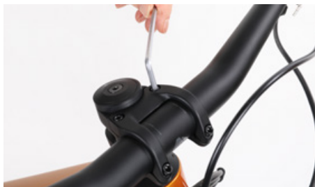
Lossa insexskruven eller -skruvarna på styrstammens framsida
