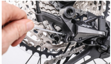
Begränsar bakväxels rörelseområde med ändlägesskruvarna
