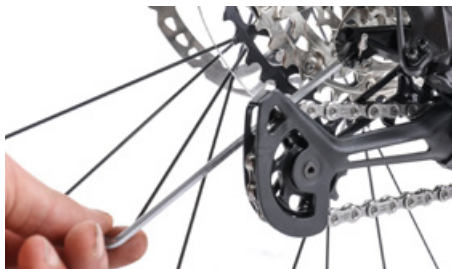
Spänn växelvajern på bakväxel genom att först lossa skruven som spänner vajern
