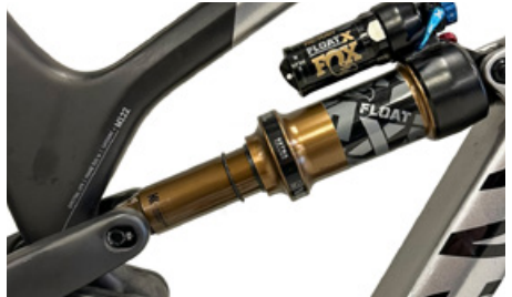
O-ringens förflyttning på dämparen visar den utnyttjade fjädringsvägen
