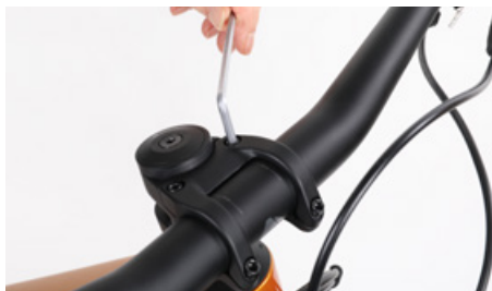
Lossa skruvarna fram på styrstammen
