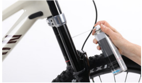
Applicera godkänt smörjmedel efter rengöringen
