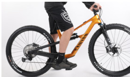
Perfekt position: När den främre trampdynan vilar på mitten av pedalen ska knäet vara lätt böjt
