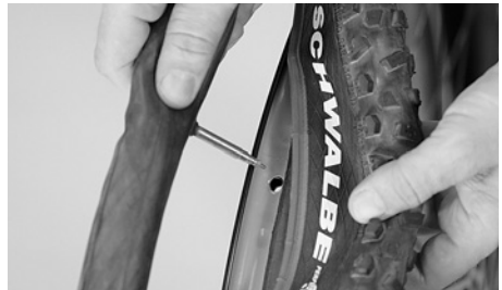
Stick in ventilen i hålet i fälgen
