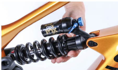
På stålfjädrar ska den räfflade inställningsringen vridas för att ändra fjäderspänningen
