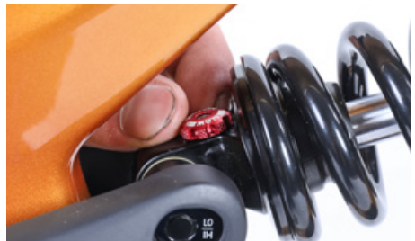
Negativ fjädringsväg – sag på det dämpade bakpartiet
