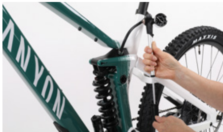
På luftstötdämpare varieras lufttrycket för att ändra inställningen
