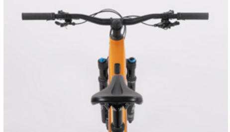
För blicken längs med sadeln och överröret för att kontrollera att den sitter rakt
