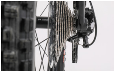
Växla till det minsta drevet innan bakhjulet demonteras
