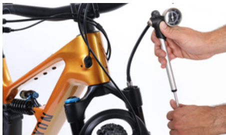
Ställ in fjäderhården med en dämparpump
