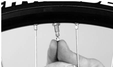
På racer- eller prestaventiler måste ventilen skruvas upp
