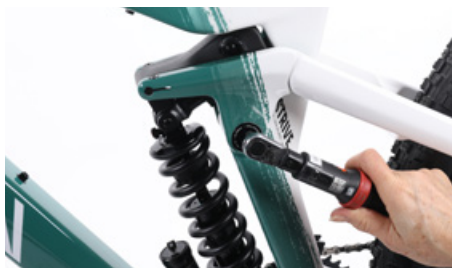
Kontrollera regelbundet att alla skruvförband på bakpartiet är korrekt åtdragna
