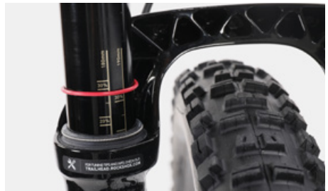
Negativ fjädringsväg – sag på den dämpade gaffeln
