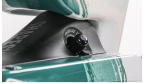
Se till att ventillocket alltid är monterat på ventilen vid cykling
