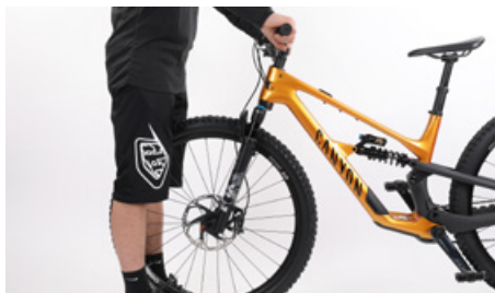
Försök att vrida styret i förhållande till framhjulet
