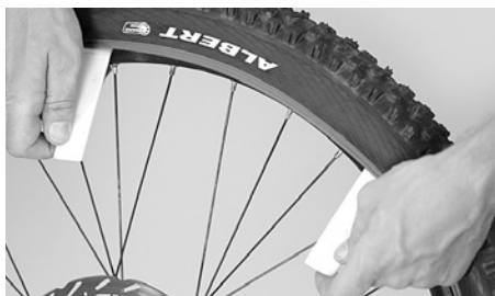
Bänd däcksidan över fälgkanten med däckjärn
