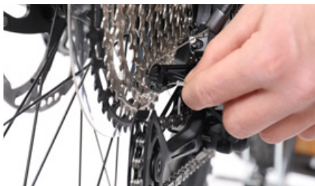
Spänn därefter vajern genom att dra i den för hand
