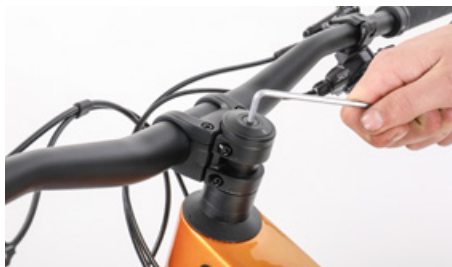
Ställ in lagerspänningen med den nedsänkta justerskruven upptill efter att klämskruvarna på sidan har lossats
