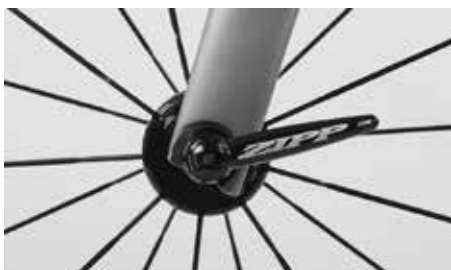
I ändläget ska spaken stå i en rät vinkel till snabbkopplingens axel
