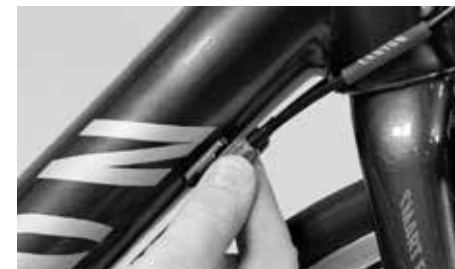
Spänna växelvajern med justerskruven på ramen
