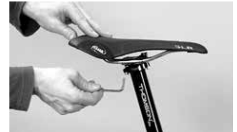
Lossa de båda skruvarna max. tre varv
