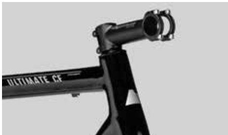
Färdigmonterat och inställt styrlager med styrcam och gaffel
