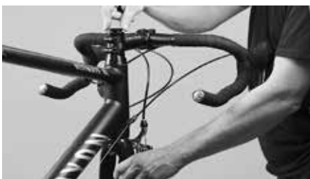
Sätt på kåpan, håll fast gaffeln och tryck på kåpan och rikta sedan upp och dra fast styrstammen med föreskrivet åtdragningsmoment
