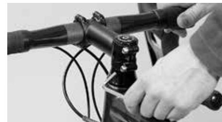
Lossa skruvarna på sidan på styrstammen
