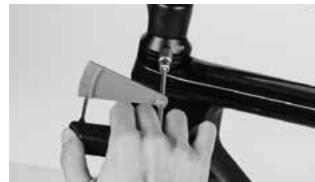
Lossa endast skruvarna med ett eller två varv och skruva inte ut dem
