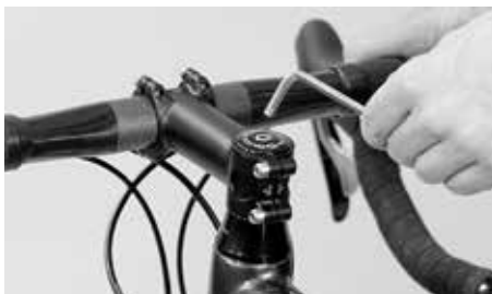
Ställ in lagerspänningen med den nedsänkta justerskruven upp-till efter att klämskruvarna på sidan har lossats
