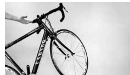
Kontrollera att lagret går lätt genom att lyfta upp framhjulet och kontrollera att det rör sig utan motstånd
