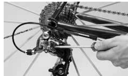
Begränsar bakväxels rörelseområde med ändlägesskruvarna
