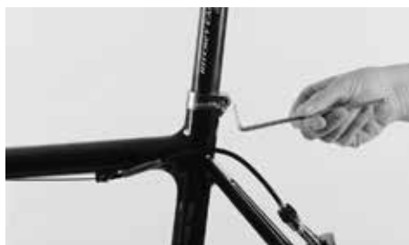
Sadelklämmans skruv på sadelstolpen måste lossas när sadelhöjden ställs in
