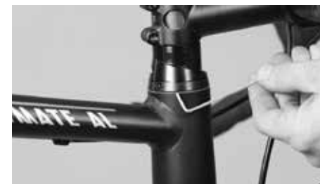
Ställ in lagerspänningen med justerskruven på sidan
