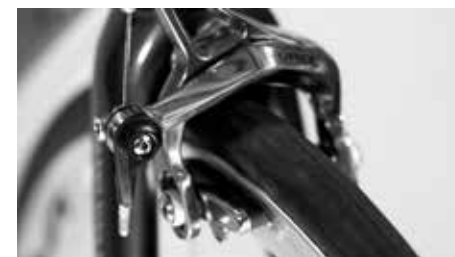
Kontrollera att däck- et är runt med hjälp av bromsen
