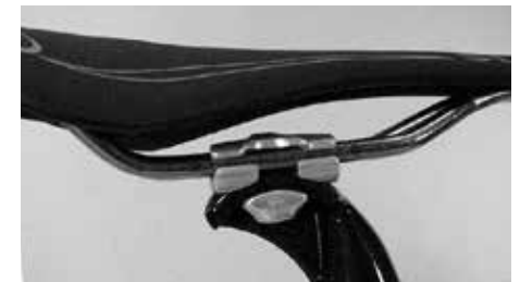
Rikta upp sadeln så att sadelrälsen kan fästas inom markeringarna
