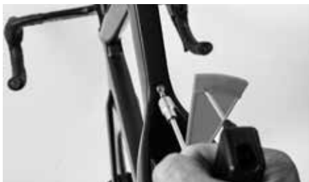
Överskrid inte angivet max. åtdragningsmoment
