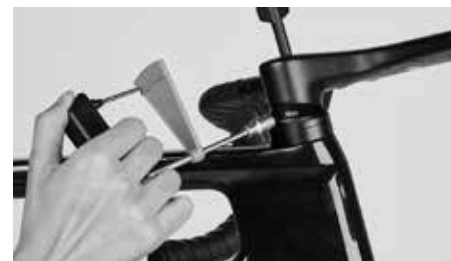
Dra åt skruven på baksidan av styrlagrets kåpa med det angivna åtdragningsmomentet 9 Nm
