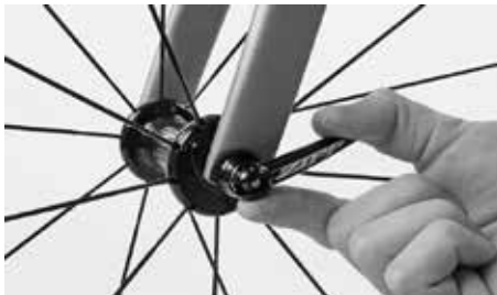
Kontrollera att kopplingen sitter fast genom att försöka vrida på den stängda spaken
