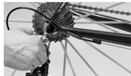
Kontrollera att bakväxeln inte kan gå in i ekrarna
