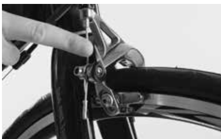
Öppna snabbfrigöringsspaken på bromsen
