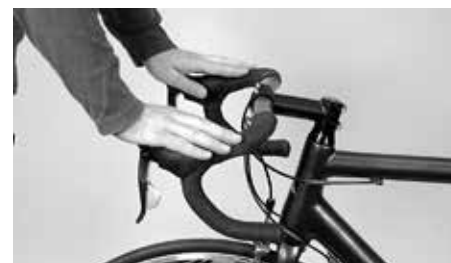
Det får inte ens gå att vrida på styret med ett kraftigt ryck
