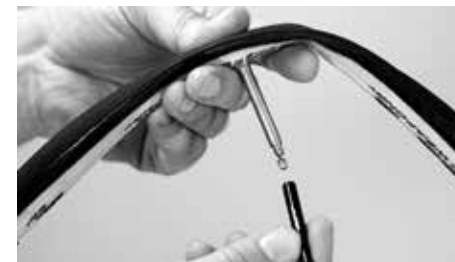
Montera en ventilförlängning
