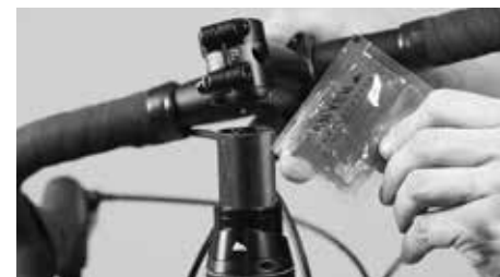
Applicera lite monteringspasta för kolfiber på gaffelröret
