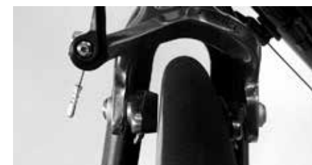
Kontrollera att däck inte är skevt med hjälp av bromsen
