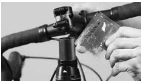
Fördela vid behov monteringspasta för kolfiber på gaffelröret och styret
