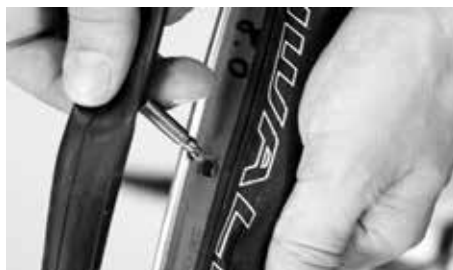
Stick in ventilen i hålet i fälgen
