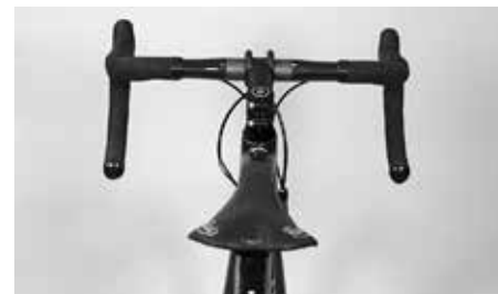
För blicken längs med sadeln och överröret för att kontrollera att den sitter rakt
