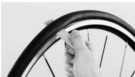
Däck- et kan bändas av med ett däckjärn
