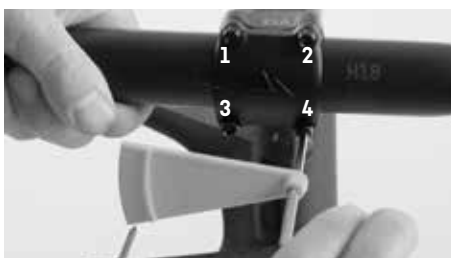
Dra sedan åt skruvarna med åtdragningsmomentet som anges på delen
