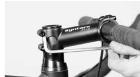
Lossa skruvarna på sidan på styrostammen
