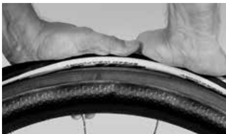
Tryck däck- et åt sidan tills det bildas en spalt
