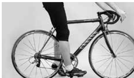
När hälen står på pedalen som är längst ner ska benet vara helt sträckt
