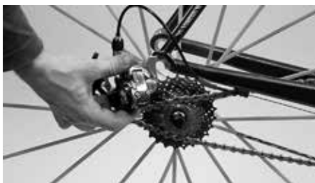
Dra bakväxeln något bakåt för att demontera bakhjulet
