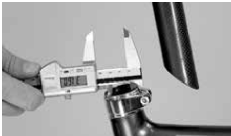
Kontrollera att sadelstolpen passar exakt till ramen
