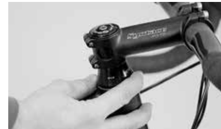
Kontrollera spelet i styrlagret genom att lägga fingrarna runt laggerskålen och flytta din Canyon framåt och bakåt med åtdragen broms
