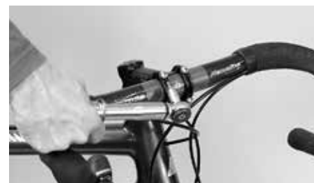
Dra fast skruvarna med angivet åtdragningsmoment igen
