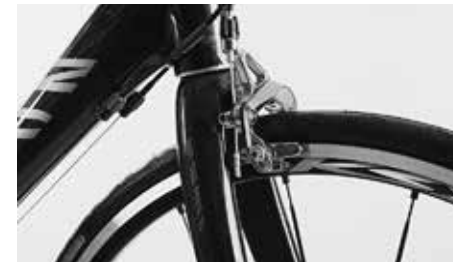
Kontrollera om däcket är skevt med hjälp av bromsbeläggen
