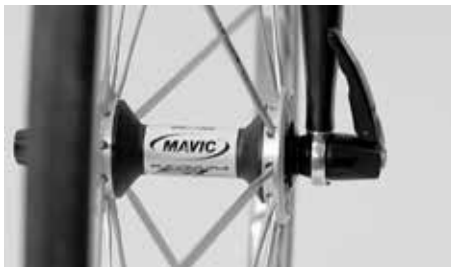
Snabbkopplingens spak ska vara så parallell som möjligt med cykeln och får inte sticka ut på sidan
