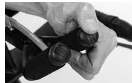
Styrändsreglagen styr bak- och framväxel
