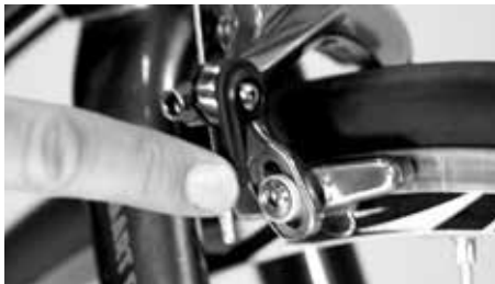
Kontrollera att däckets är runt med hjälp av bromsbeläggen
