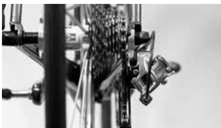
Titta bakifrån på kassetten och kontrollera att bakväxels växeltrissor står exakt under rätt drevs tandning
