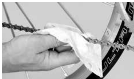
Ta bort smuts och olja från kedjan med en trasa
