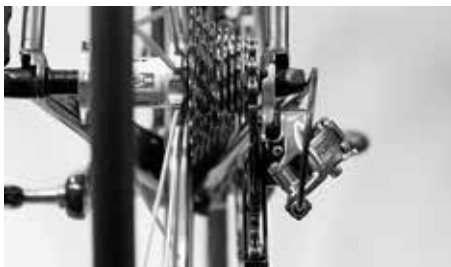
Växla till det minsta drevet innan bakhjulet demonteras
