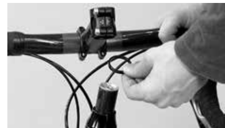
Ta bort mellanlägg och sätt sedan tillbaka dem ovanför styrstammen igen
