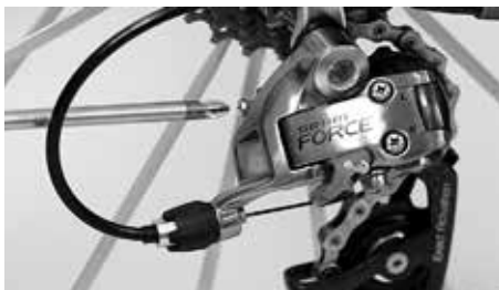
Avståndet mellan styrrullen och kassetten ställs in med skruven som sitter mot kanten på gaffeländarna
