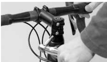
Dra fast klämskruvarna på sidan på styrcstammen igen med en momentnyckel
