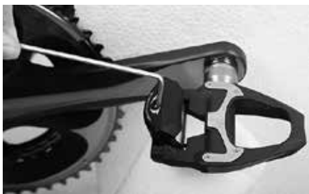
Ställa in hårdheten på pedalens låsmekanism
