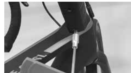
Dra åt skruven för överföringsplattan
