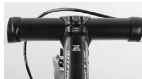
Slitsarna mellan styrcammens lock och styrcammen ska vara raka och lika breda upptill och nertill
