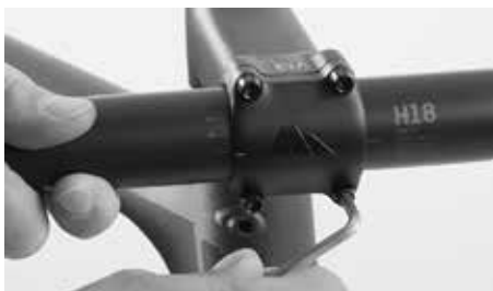
Lossa insexskruven eller -skruvarna på styrcammens framsida
