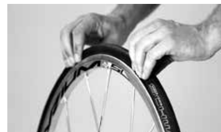
Tryck ihop hjulet för att försäkra dig om att slangen inte sitter i kläm
