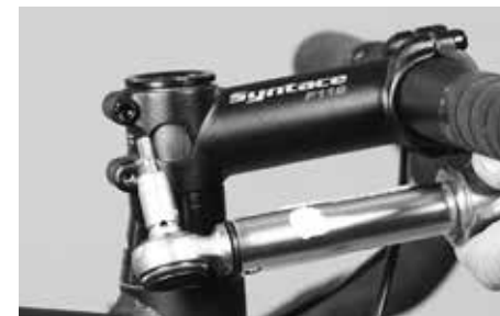
Kontrollera med en momentnyckel att klämskruvarna på sidan på styrcstammen är åtdragna med värdena som står på delen
