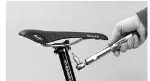
Dra fast skruvarna igen jämnt och omväxlande med det föreskrivna åtdragningsmomentet
