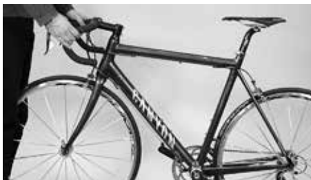
Försök att vrida på styret i förhållande till framhjulet och styrstammen
