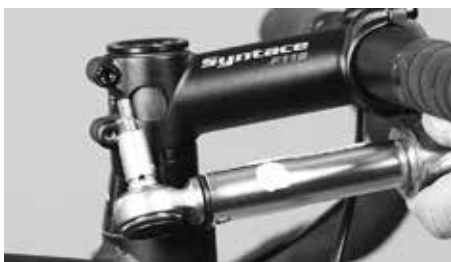
Dra åt fästskruvarna på styrstammen med föreskrivna åtdragningsmoment med en momentnyckel
