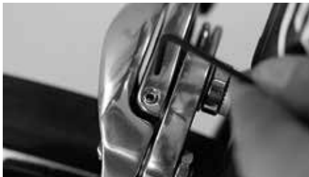
Skruva på den lilla skruven tills vänster och höger belägg har samma avstånd till fälgen
