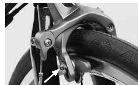
Dra åt beläggets fästskruv med föreskrivet åtdragningsmoment för höjdjustering
