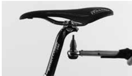
Dra fast de två skruvarna jämnt och omväxlande och överskrid aldrig det angivna maximala åtdragningsmomentet
