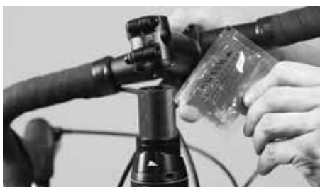
Applicera lite monteringspasta för kolfiber på gaffelröret
