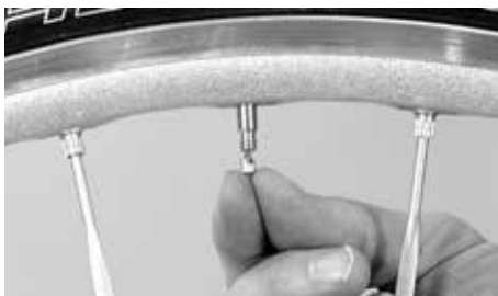
På racer- eller prestaventiler måste ventilen skruvas upp
