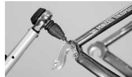
När det utbytbara växelörat byts ut får det maximala åtdragningsmomentet på 1,5 Nm aldrig överskridas
